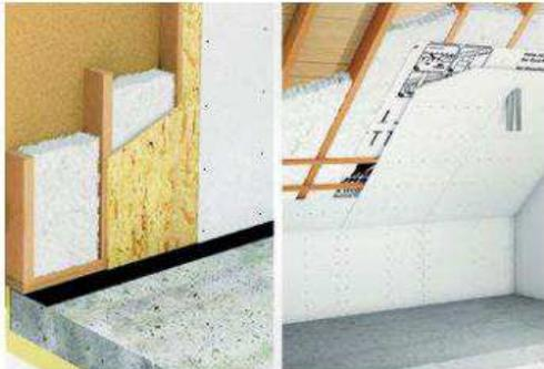
Die Pfetten-dämmung ist ein zweiteiliges System mit Hakenfalz-Verbindung und kann bei allen Steildächern ab einer Dachneigung von 5 Grad eingesetzt werden. Die passgenauen Elemente sorgen für eine wärmebrückenfreie Einbindung der Holz-Dachkonstruktion.
