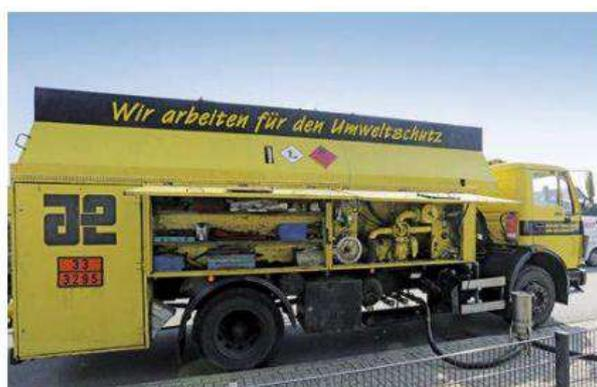
Nichts geht verloren: Bevor die alten Tanks abgebaut werden, werden diese von einem speziellen Tankschutzunternehmen leer gepumpt. Sobald die neue Anlage steht, wird das gefilterte Restöl dort eingebracht.
