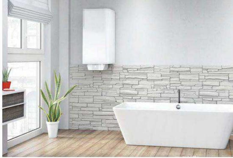
hitzer. Die gewünschte Warmwassertemperatur lässt sich hier meist stufenlos am Temperaturwähler einstellen und wird am optionalen Display angezeigt. Die Elektronik regelt die elektrische Leistungsaufnahme so, dass die eingestellte Warmwassertemperatur möglichst genau erreicht und gehalten wird.
