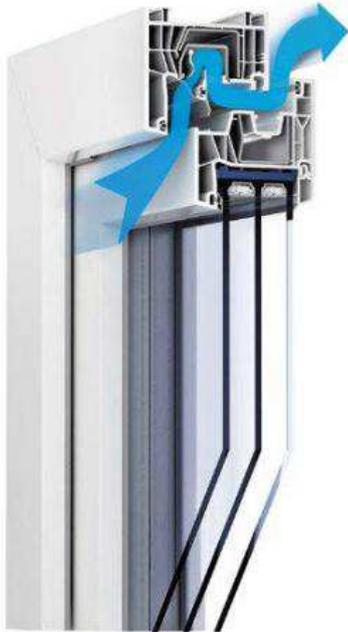
Der Lüftungsmechanismus von „ClimaTec 76“ liegt verdeckt im Blendrahmenfalz und ist kaum sichtbar, dafür aber umso wirksamer: Er sorgt für einen kontrollierten Luftaustausch ohne manuelles Lüften und benötigt keine Stromquelle. Profine
