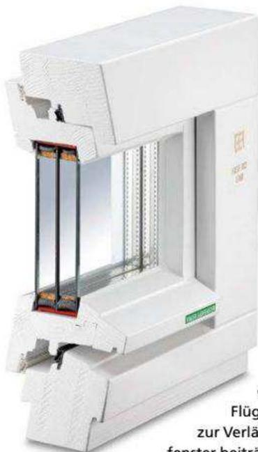
Beim „HDF 82 Stil“ wird der Wetterschenkel ohne Wartungsfuge gefertigt und in den Flügel integriert. Eine Innovation, die wesentlich zur Verlängerung der Lebensdauer der Holzdenkmalfenster beiträgt. Kneer-Südfenster
