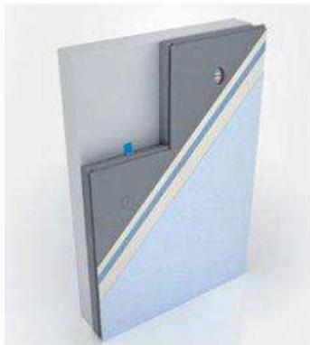
Die graphithaltigen Dämmplatten aus Polystyrol werden mit Klebschaum versehen und dann an die Außenwand gedrückt. Kleine Winkel halten die Platten zusätzlich in Position. Nach der Verdübelung folgen die Flächenarmierung und der Putzauftrag.
