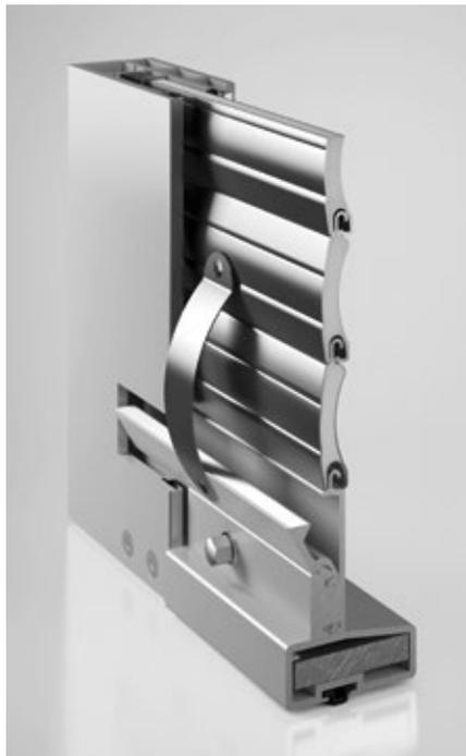
Die Endleiste mit integriertem Kippriegel sorgt für eine zusätzliche Hochschiebesicherung. Der Kippriegel fällt bei herabgelassenem Rollladen in eine Ausklinkung in der Führungsschiene und sorgt für eine zusätzliche Verriegelung.
