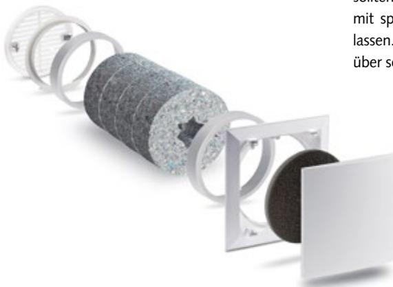
**Ein Außenluftdurchlasselement (ALD) ermöglicht die (passive) Nachströmung von Zuluft für Wohn- und Schlafräume. Dieses Modell ist für hohe Schallschutzanforderungen optimiert.**
