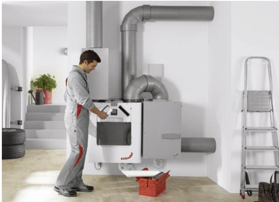
Der hier an das Lüftungsgerät angedockte Erdreichwärmetauscher (r.) hat zwei wichtige Vorteile: An kalten Tagen lässt sich mit der Erdreichwärme die kalte Außenluft vorwärmen. Und an heißen Tagen helfen die kühleren Erdreichtemperaturen dabei, die Raumlufttemperaturen etwas abzukühlen. [www.zehnder-systems.de](http://www.zehnder-systems.de)
