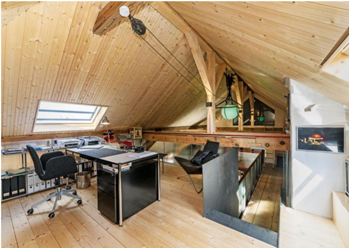
Auf der Empore entstand ein von zwei Seiten belichteter Arbeitsplatz. Die elektrisch gesteuerten Lamellenfenster liegen in der gleichen Ebene wie die Ziegeldeckung, erfüllen somit die Auflagen der Denkmalpflege. Am Firstbalken des 1906 nach einem Brand erneuerten Dachstuhls hängt der originale Heugabelmechanismus.
