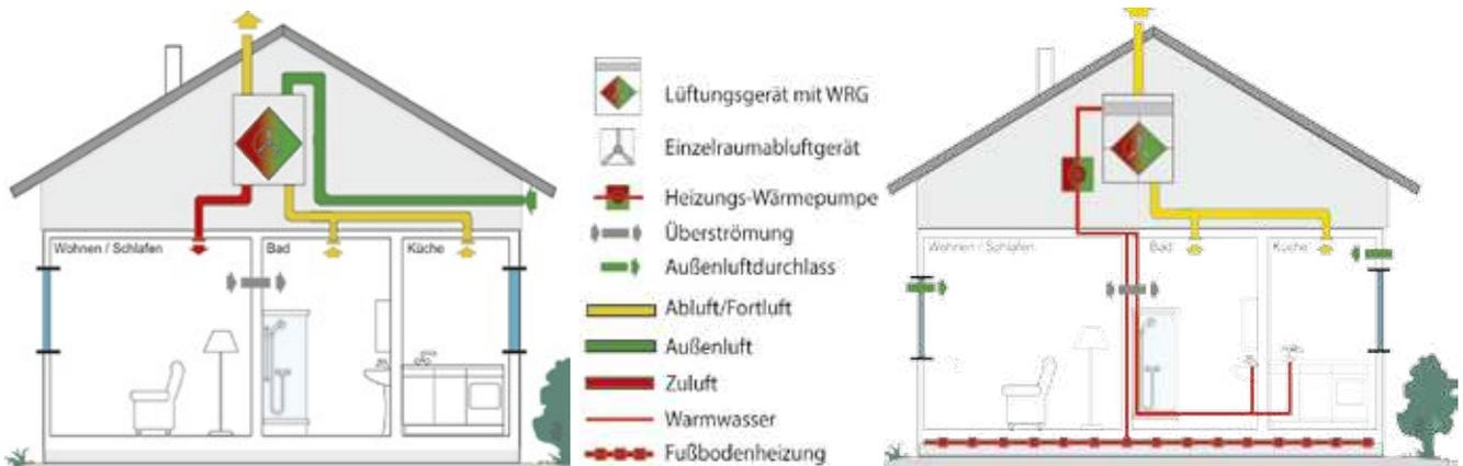
**Zentrale Wohnungslüftungssysteme gibt es in zwei Grundausprägungen: als reine Abluftanlage sowie als kombinierte Be- und Entlüftungsanlage, meist mit eingebauter Wärmerückgewinnung. Beide Arten lassen sich optional mit einer Wärmepumpe kombinieren. [www.wohnungs-lueftung.de](http://www.wohnungs-lueftung.de)**
