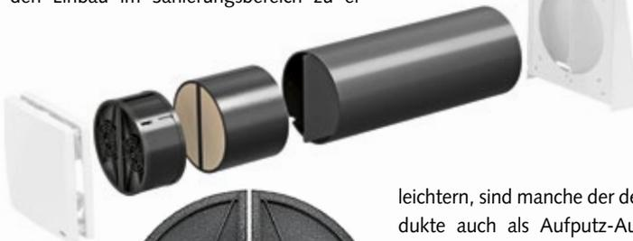
**Dieser Einzelraumlüfter besitzt zwei Ventilatoren, die parallel im Gegentakt laufen. Dabei führt ein Ventilator frische Luft zu und der andere gleichzeitig die verbrauchte Raumluft ab. Zudem verfügt er über zwei getrennte Wärmespeicherhälften.**
