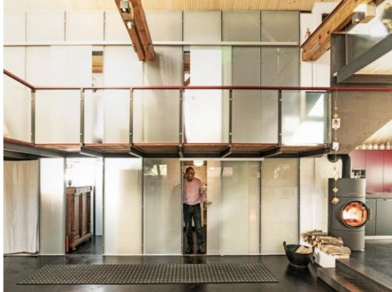
Der unbehandelte Gussasphalt ist mit einer Fußbodenheizung ausgestattet und wird mit Schmierseife gepflegt. Die Galerieebene hängt mit Gewindegangstangen an dem mächtigen Holzbinder darüber. Sie nimmt dem Raum die Höhe und verleiht ihm ein überraschend behagliches Wohngefühl. Das rote Sofa ist der Lieblingsplatz von Gaby Sutter.
