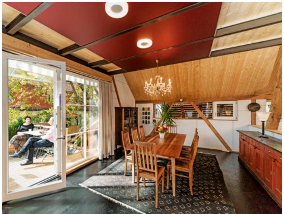
Die Größe des jetzt verglasten Feldes in Richtung Balkon war durch die alte Holzkonstruktion vorgegeben. Sprossen gliedern das Seitenfenster. Die Fugen der sehr exakt verlegten Wandverkleidung (Gipsfaserplatten) blieben bewusst sichtbar.
