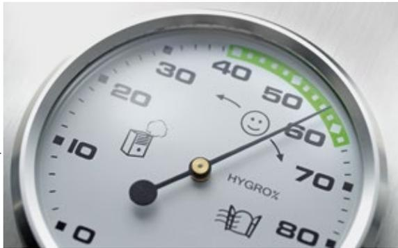
Als angenehm empfinden viele Menschen ein Raumklima mit 21 bis 22 Grad Celsius bei einer relativen Luftfeuchte zwischen 40 und 60 Prozent – prüfbar mit einem Hygrometer.
