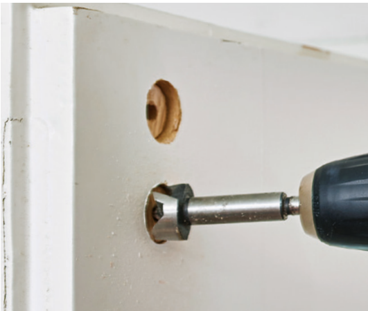
17 Denn von der Rückseite her werden zwei Sacklöcher gebohrt (20 mm Ø) und der Forstnerbohrer benötigt zum Ansetzen einen exakten Mittelpunkt.
