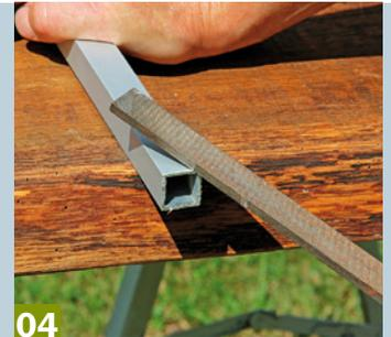
**04** Sämtliche Schneidgrate an den Vierkantprofilen müssen außen und innen sauber mit einer Metallfeile entfernt werden.
