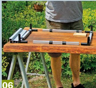
**06** Die Schlauchabschnitte als rutschfeste Auflage werden vor dem Zusammenbau über die waagerechten Auflageprofile geschoben.
