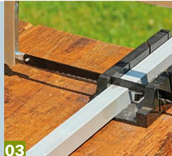
**03** Nun werden die Aluminiumprofile entsprechend abgelängt. Man benötigt dieses Konstruktionsteil insgesamt acht Mal.
