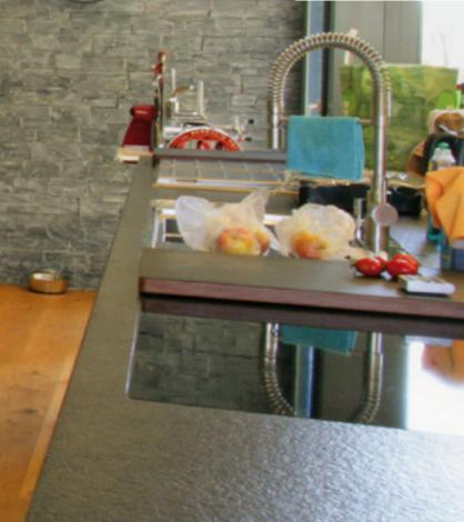
Hi-Macs Platten bestehen aus Acryl, natürlichen Mineralien und Pigmenten. Aus dieser Mischung entsteht eine glatte, porenfreie und optisch fugenlose Oberfläche, die höchste Standards in puncto Ästhetik, Funktionalität und Hygiene erfüllt (Foto: Rafael Kroetz)
