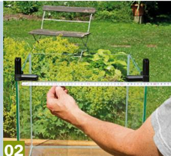
**02** Die Tragekonstruktion muss an das Aquarium angepasst werden. Man setzt die Eckverbinder auf die Glaskanten und nimmt das Profilmaß ab.
