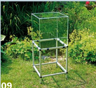
**09** So sieht die fertige Konstruktion aus: Unten das Gestell aus Aluprofilen, oben das umgedrehte Aquarium auf die Schlauchabschnitte aufgesetzt.
