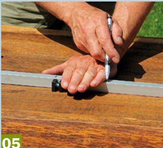
**05** Bessere Stabilität erhält das Gestell durch Querverstrebungen. Die senkrechten Streben werden durchtrennt und Rohrverbinder eingebaut.
