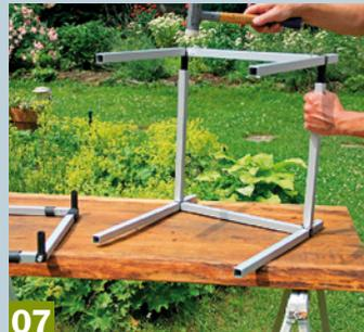
**07** Mit Hilfe der Rohrverbinder aus Kunststoff werden die Aluminiumprofile verbunden. Man verwendet hierbei einen Kunststoffhammer.
