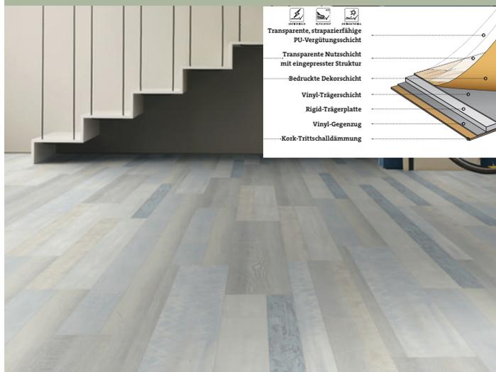
Der Multilayer-Rigid Design-Vinylboden mit RCB-Technologie (Rigid Composite Board) ist mit einer starren, feuchtraumgeeigneten Trägerplatte mit hohem Kreideanteil ausgestattet (Kategorie „Polymer“). Der phthalatfreie LVT-Layer basiert auf Bio-Weichmachern in Form von Sojabohnen-Öl. [www.terhuerne.de](http://www.terhuerne.de)
