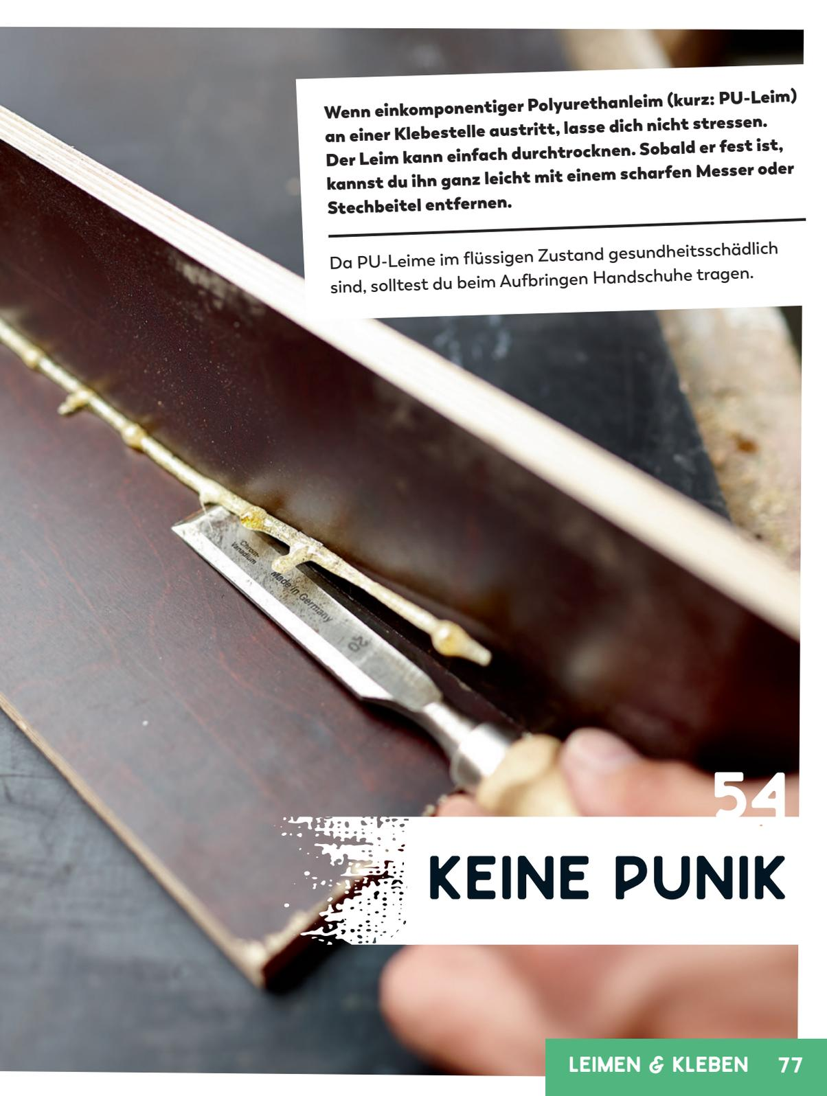
**Wenn einkomponentiger Polyurethanleim (kurz: PU-Leim) an einer Klebestelle austritt, lasse dich nicht stressen. Der Leim kann einfach durchtrocknen. Sobald er fest ist, kannst du ihn ganz leicht mit einem scharfen Messer oder Stechbeitel entfernen.**
