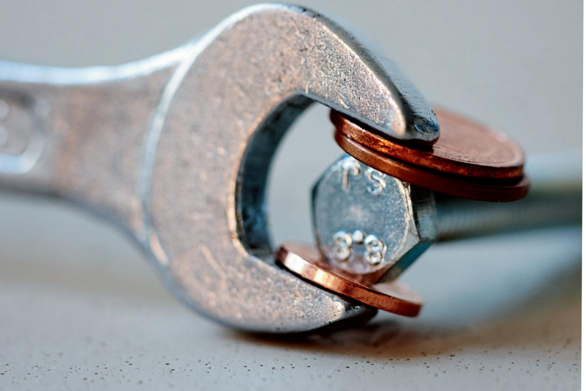
**Ist dein Schraubenschlüssel zu groß für einen zu lösenden Schraubenkopf, findest du die Lösung in deinem Portemonnaie. Suche ein paar Münzen zusammen und fülle mit ihnen die Lücke zwischen Schraubenkopf und Schlüssel.**
