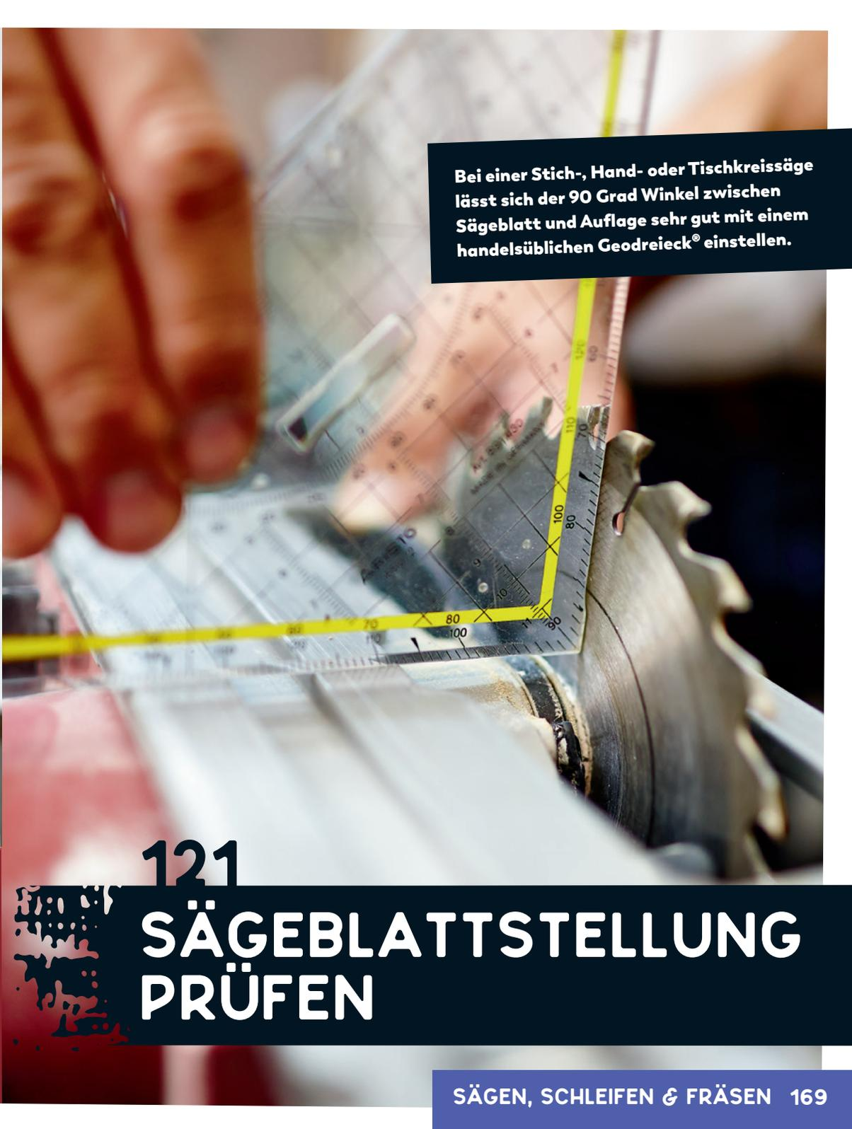
Bei einer Stich-, Hand- oder Tischkreissäge lässt sich der 90 Grad Winkel zwischen Sägeblatt und Auflage sehr gut mit einem handelsüblichen Geodreieck® einstellen.
