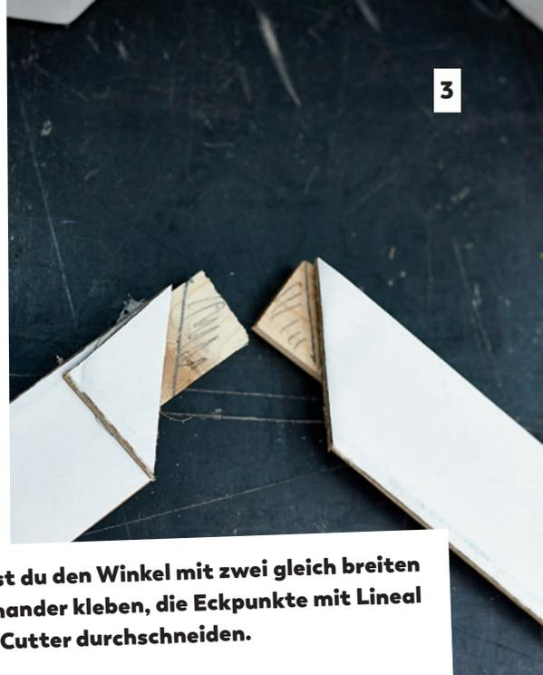
Um einen Winkel zu halbieren, nimmst du den Winkel mit zwei gleich breiten Pappstreifen ab. Pappstreifen aufeinander kleben, die Eckpunkte mit Lineal und Bleistift verbinden und mit dem Cutter durchschneiden.
