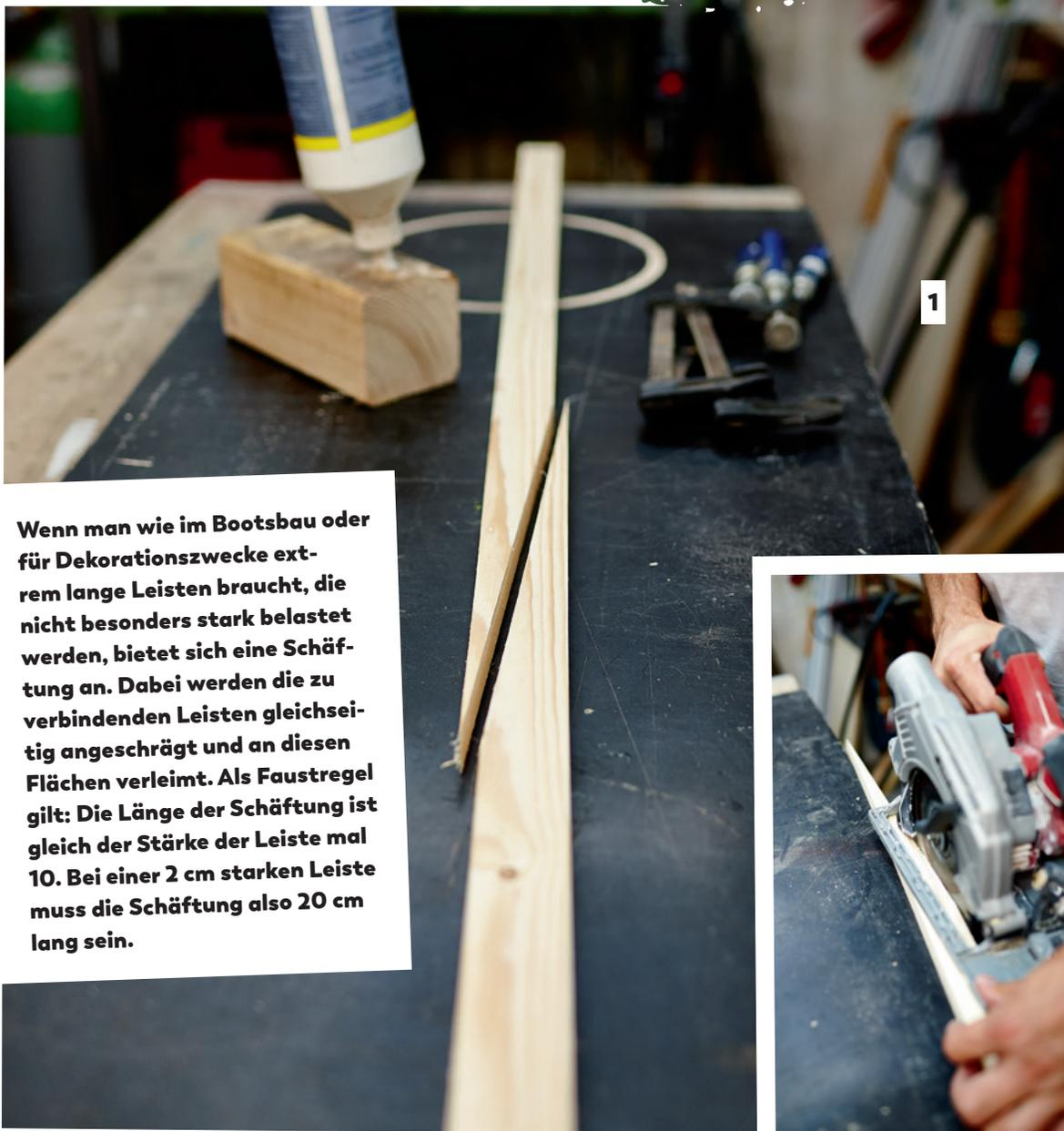
Wenn man wie im Bootsbau oder für Dekorationszwecke extrem lange Leisten braucht, die nicht besonders stark belastet werden, bietet sich eine Schäftung an. Dabei werden die zu verbindenden Leisten gleichseitig angeschrägt und an diesen Flächen verleimt. Als Faustregel gilt: Die Länge der Schäftung ist gleich der Stärke der Leiste mal 10. Bei einer 2 cm starken Leiste muss die Schäftung also 20 cm lang sein.
