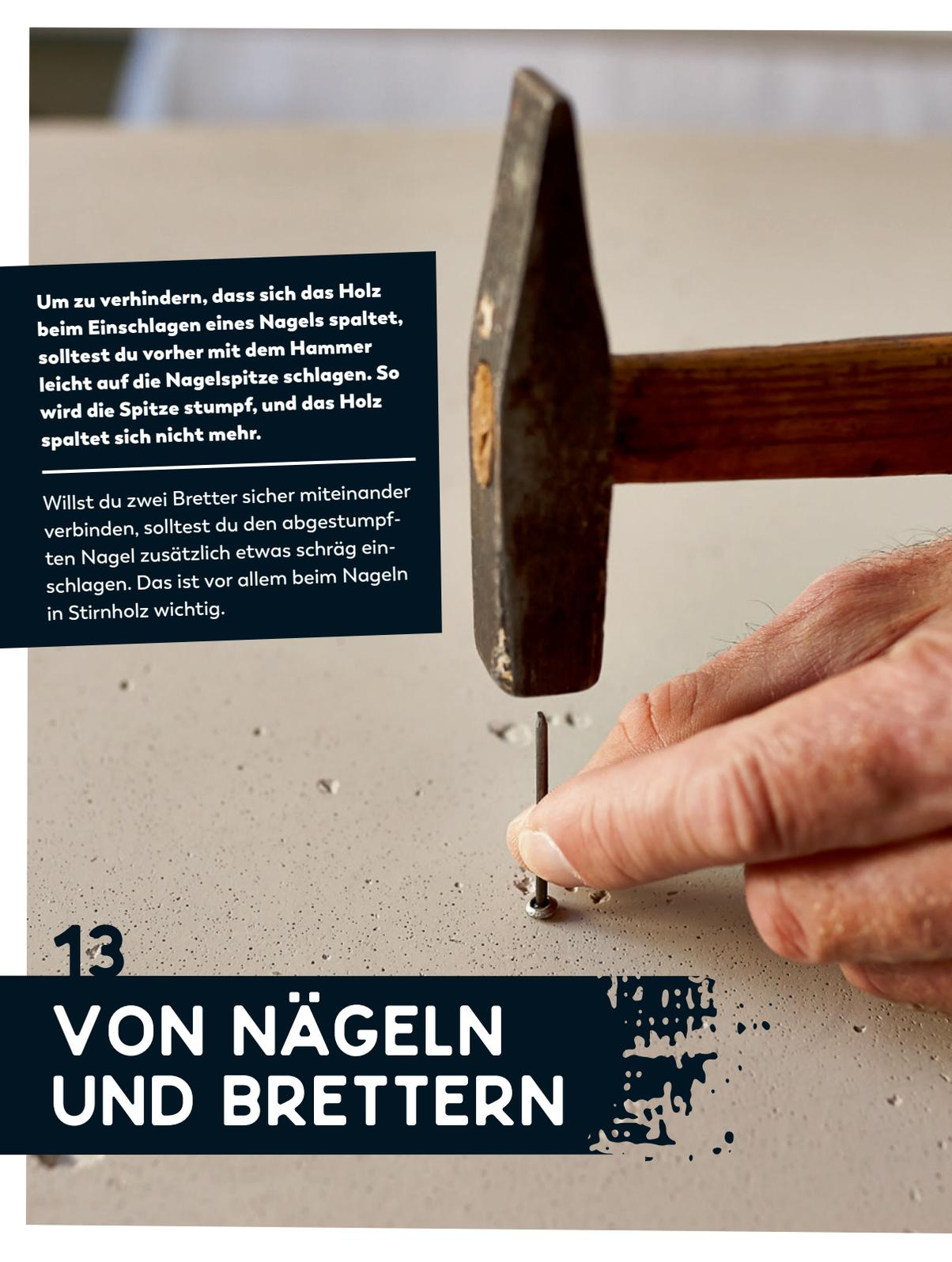
Um zu verhindern, dass sich das Holz beim Einschlagen eines Nagels spaltet, solltest du vorher mit dem Hammer leicht auf die Nagelspitze schlagen. So wird die Spitze stumpf, und das Holz spaltet sich nicht mehr.
