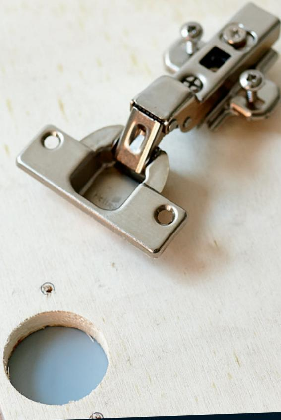
**Um Löcher für Möbelbeschläge wie Schubladenführungen oder Scharniere passgenau zu setzen, kannst du eine Schablone aus einem Sperrholzbrett anfertigen. Mit dieser Schablone lassen sich die Löcher dann ohne Probleme übertragen.**
