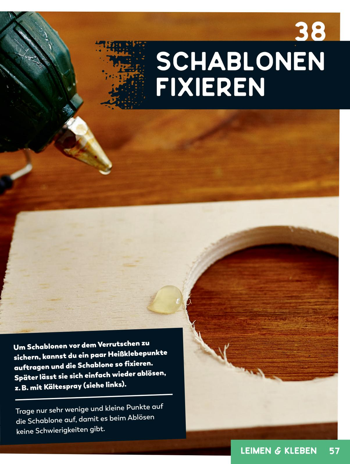
Um Schablonen vor dem Verrutschen zu sichern, kannst du ein paar Heißklebepunkte auftragen und die Schablone so fixieren. Später lässt sie sich einfach wieder ablösen, z. B. mit Kältespray (siehe links).
