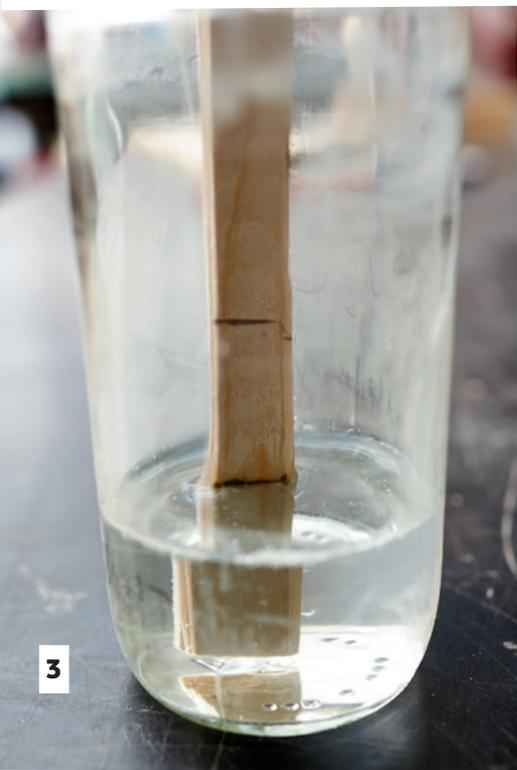
**3** Nun fülle den ersten Teil bis zur ersten Markierung ein. Anschließend gibst du den zweiten Teil bis zur zweiten Markierung in das Glas.
