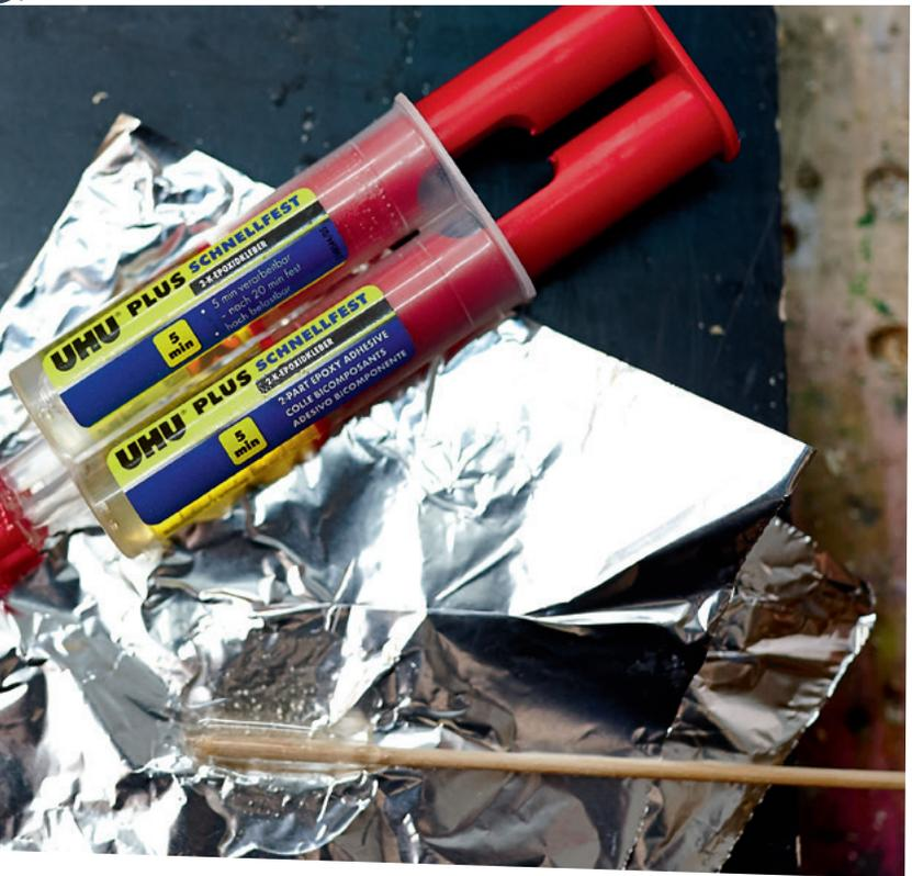
**Die beiden Komponenten vermischst du am besten mit einem Schaschlikstab. So kann der fertige Kleber besser entfernt werden als von einem Spatel.**
