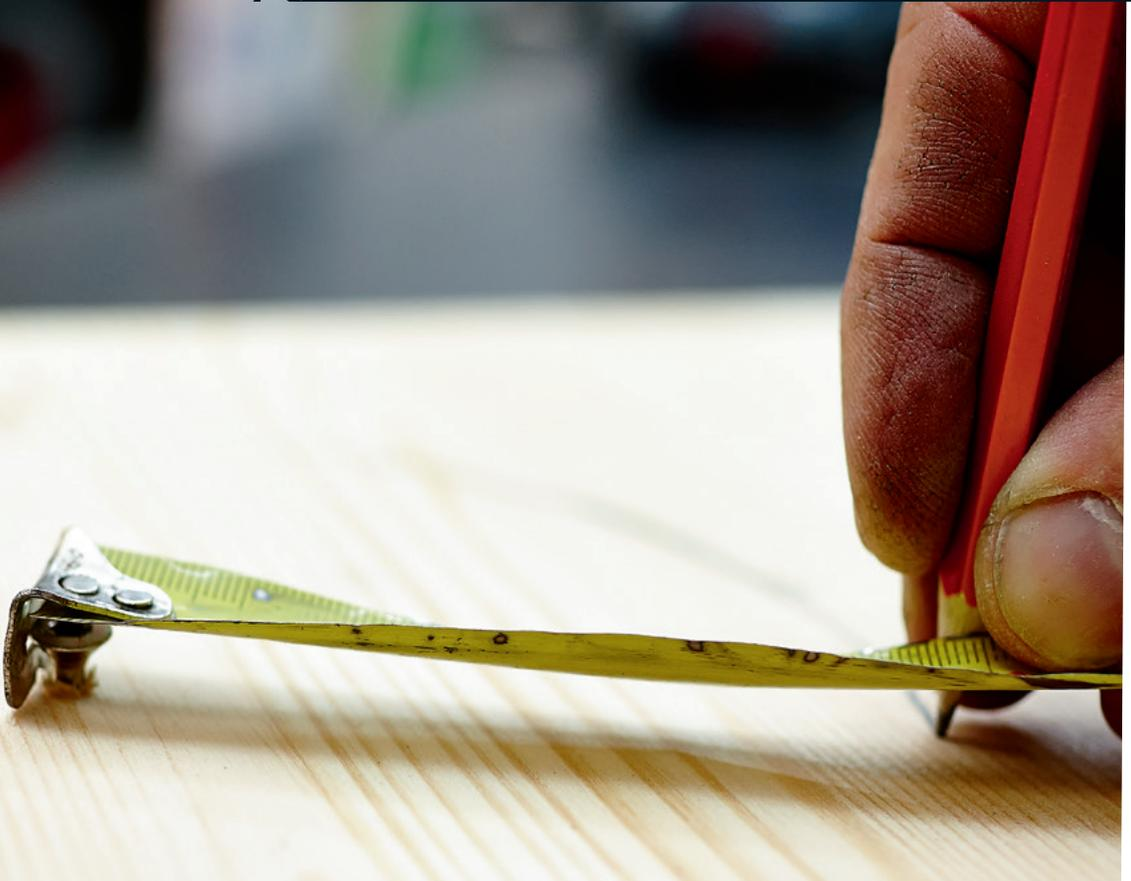
**Bei den meisten Maßbändern ist der Anschlag mit einem Schlitz versehen. Hänge diesen Anschlag in einen halb eingedrehten Schraubenkopf ein. Den Bleistift hältst du mit dem Finger an die gewünschte Position ans Maßband. So kannst du nun halten und anzeichnen.**
