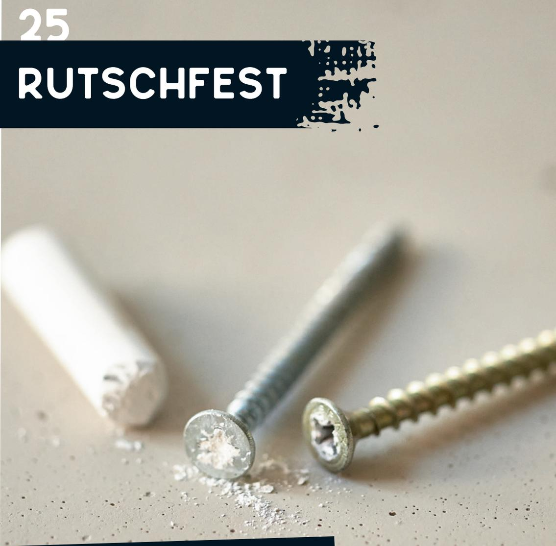
**Wenn du beim Schrauben immer wieder abrutschst, kannst du den Schraubenkopf mit etwas Kreide versehen. So rutschen die Bits nicht mehr so schnell ab.**
