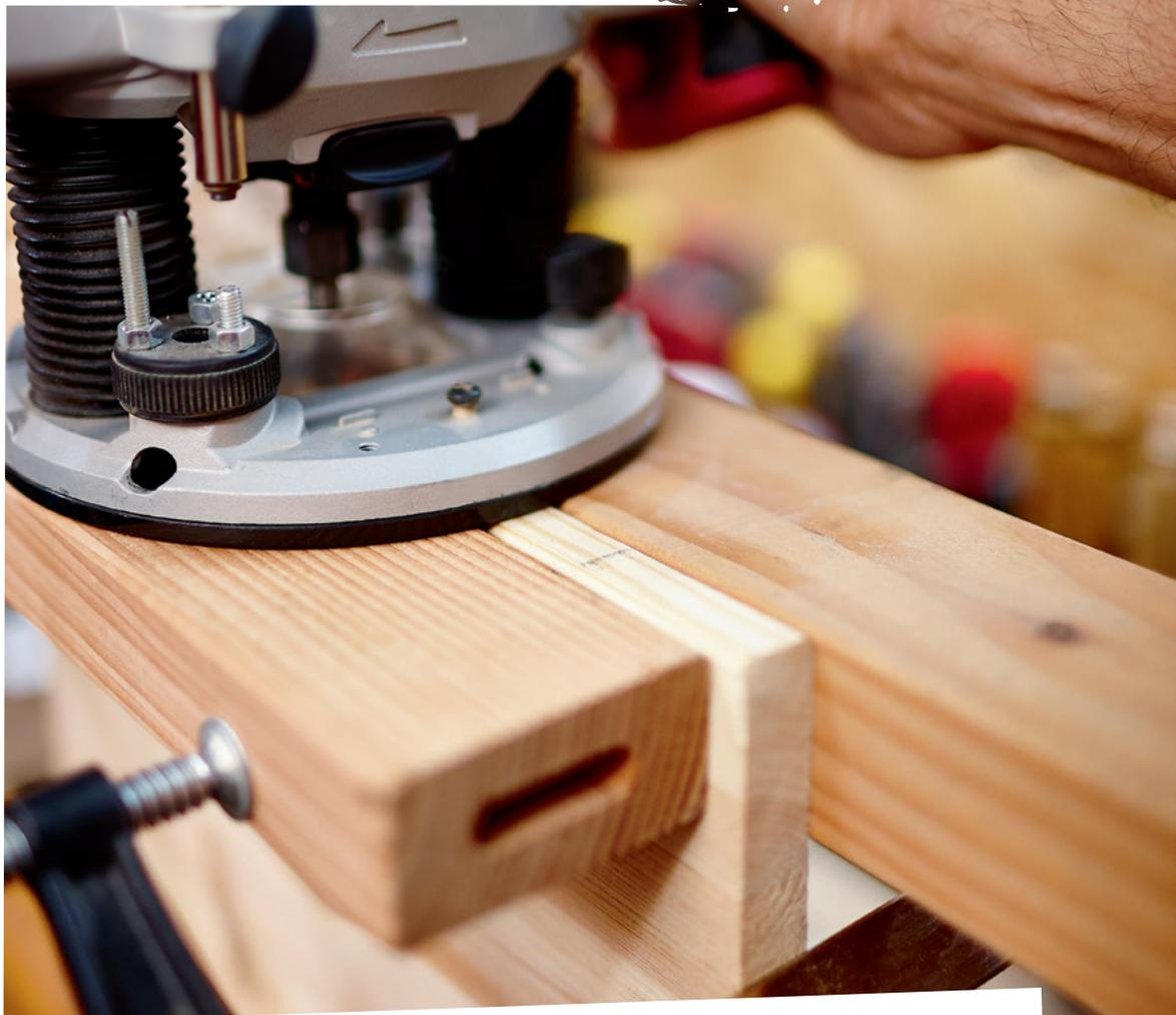
**Hochkant eingespannte Bretter, die mit der Oberfräse bearbeitet werden, lassen sich mit einer Auflagenverbreiterung besser bearbeiten. Spanne dein Werkstück mit zwei Schraubzwingen zwischen zwei Leisten (z. B. zwei Dachlatten) und richte die Oberfläche bündig aus. Jetzt sitzt die Oberfräse auf beiden Leisten und kann nicht mehr kippen.**
