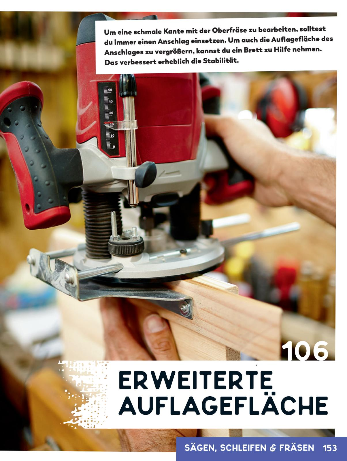
Um eine schmale Kante mit der Oberfräse zu bearbeiten, solltest du immer einen Anschlag einsetzen. Um auch die Auflagefläche des Anschlages zu vergrößern, kannst du ein Brett zu Hilfe nehmen. Das verbessert erheblich die Stabilität.
