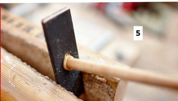
**5** Schablone fixieren und das Restholzstück drehend durch das Loch im Flacheisen drücken.
