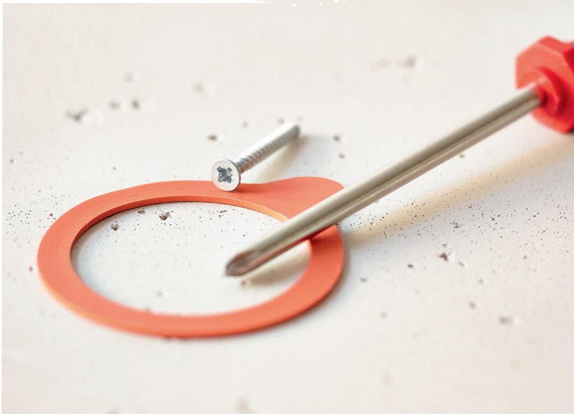
**Ist ein Schraubenantrieb ausgedreht, hilft oft ein breites Gummiband, das man zwischen Schraube und Schraubendreher legt. So fasst der Schraubendreher wieder und die Schraube kann vorsichtig rein- oder rausgedreht werden.**
