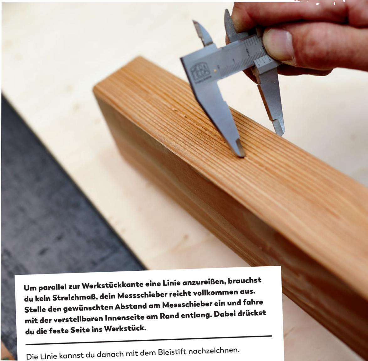
**Um parallel zur Werkstückkante eine Linie anzureißen, brauchst du kein Streichmaß, dein Messschieber reicht vollkommen aus. Stelle den gewünschten Abstand am Messschieber ein und fahre mit der verstellbaren Innenseite am Rand entlang. Dabei drückst du die feste Seite ins Werkstück.**
