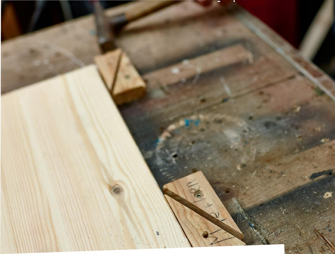
**Um lange Werkstücke zusammenzuleimen, kannst du anstatt Schraubzwingen auch einfache Keile verwenden. Auf der einen Seite schraubst du eine Leiste an den Arbeitstisch, an die du die verleimten Bretter legst. Auf der gegenüberliegenden Seite schraubst du zwei Keile an. Nun kannst du vorsichtig zwischen Brett und festem Keil kleinere Keile einschlagen, die den Druck aufbauen.**
