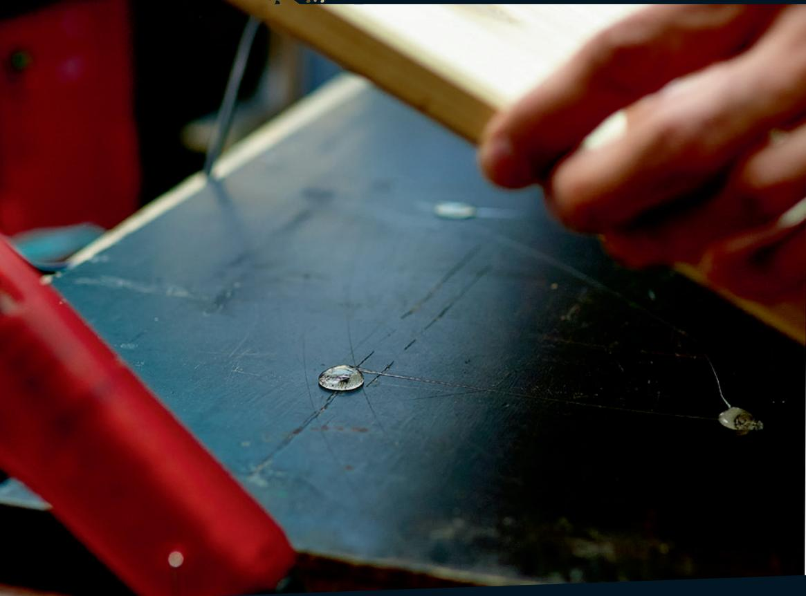
**Um beim Arbeiten mit der Oberfräse nicht durch Zwingen behindert zu werden, kannst du das Werkstück mit einigen Punkten Heißkleber auf der Arbeitsfläche fixieren.**
