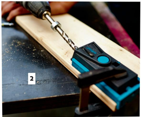
**2** Stelle die Bohrlehre nach Herstellerangaben und gemäß deines Werkstücks und der Schrauben ein. Fixiere sie mit einer Schraubzwinde. Mit dem Stufenbohrer bohrst du die Löcher.
