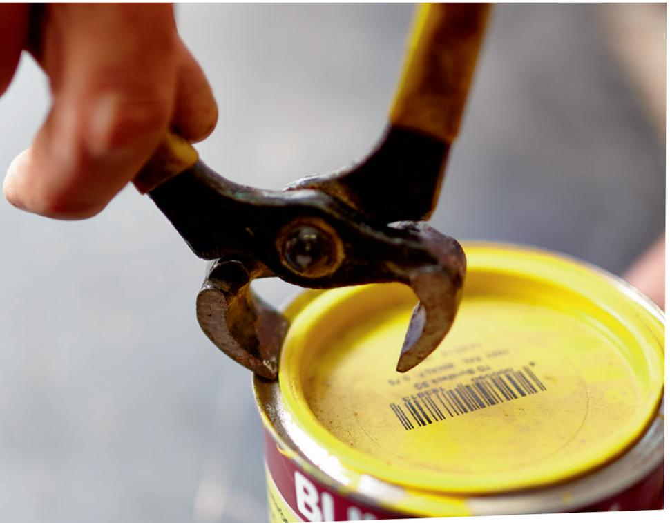
Meist werden Dosen mit Schraubendrehern geöffnet. Dabei verbiegen aber die Ränder und man muss oft ansetzen, um den Deckel aufzukriegen. Besser geht es mit einem breiteren Werkzeug, z. B. mit der Wange einer Kneifzange oder einem stabilen Spachtel.
