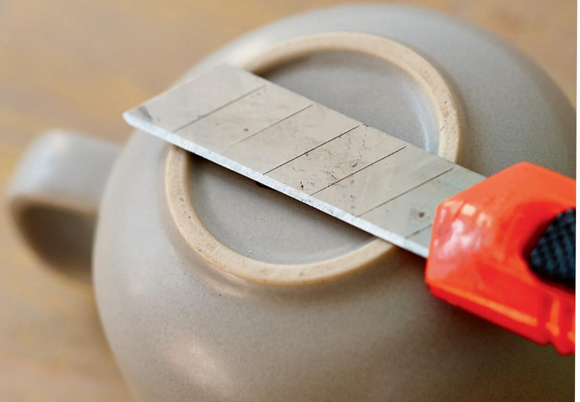
**Stumpfe Klingen eines Cuttermessers lassen sich kurzfristig wieder schärfen, indem du sie über den Boden einer Kaffeetasse ziehst.**
