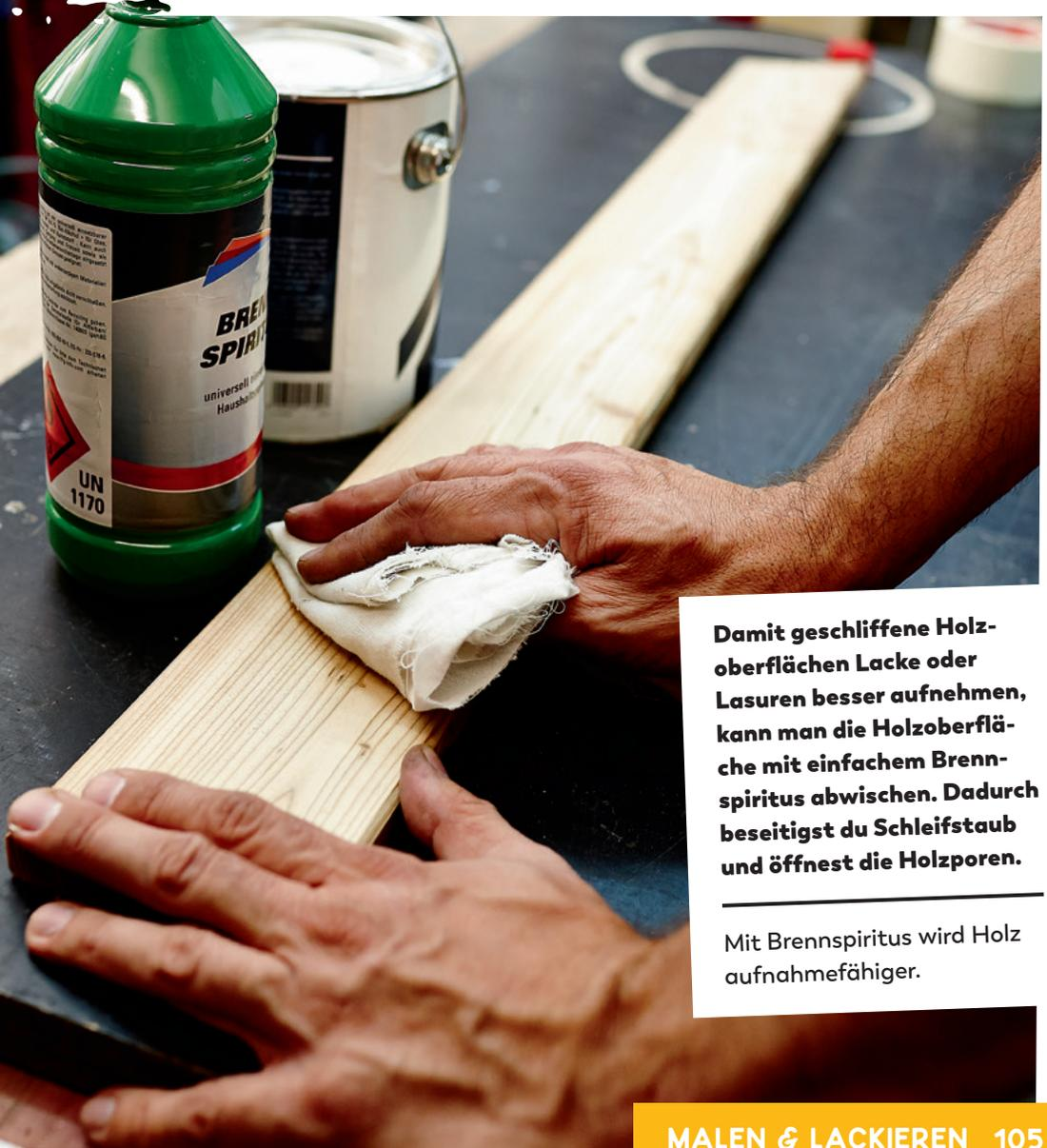
**Damit geschliffene Holzoberflächen Lacke oder Lasuren besser aufnehmen, kann man die Holzoberfläche mit einfachem Brennsprit abwischen. Dadurch beseitigst du Schleifstaub und öffnest die Holzporen.**
