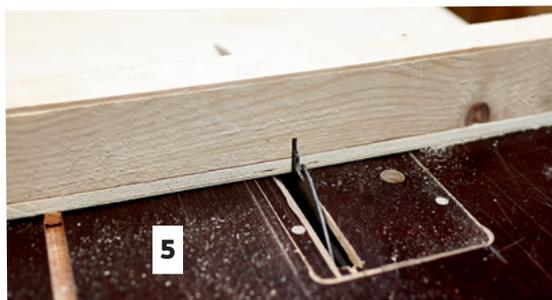
**6** Richte die Leiste mit einem Anschlagwinkel an der Schnittkante bzw. dem Sägeblatt aus und schraube sie mit einer Schraubzwinde von unten mit langen Schrauben fest.
