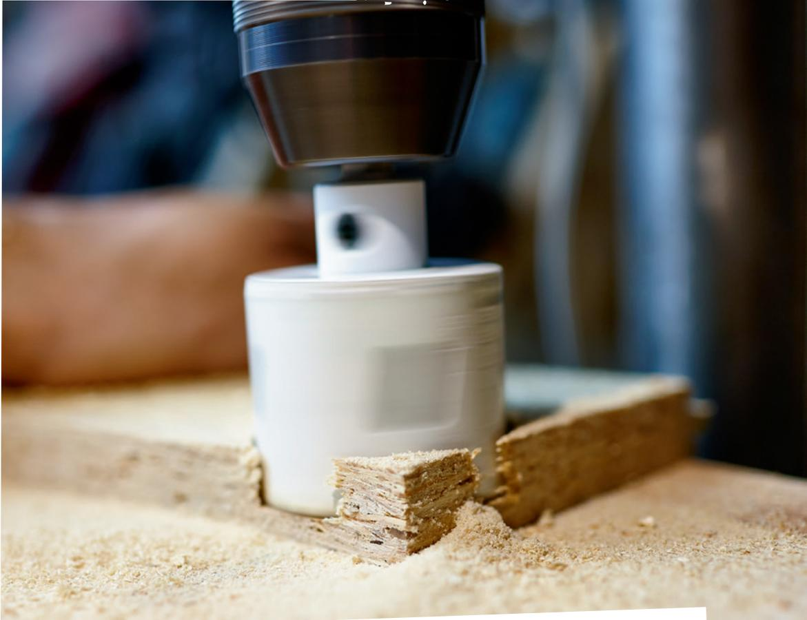
**Sägst du mit der Lochsäge Scheiben aus einem Brett, sollte am Rand des Lochbohrers immer etwas Platz für das Sägemehl vorhanden sein, damit die Späne wegfliegen können. Einfach direkt am Rand des Brettes sägen, sodass das Sägeblatt leicht übersteht. Dadurch wird die Lochsäge nicht so heiß und das Sägen verläuft deutlich schneller.**
