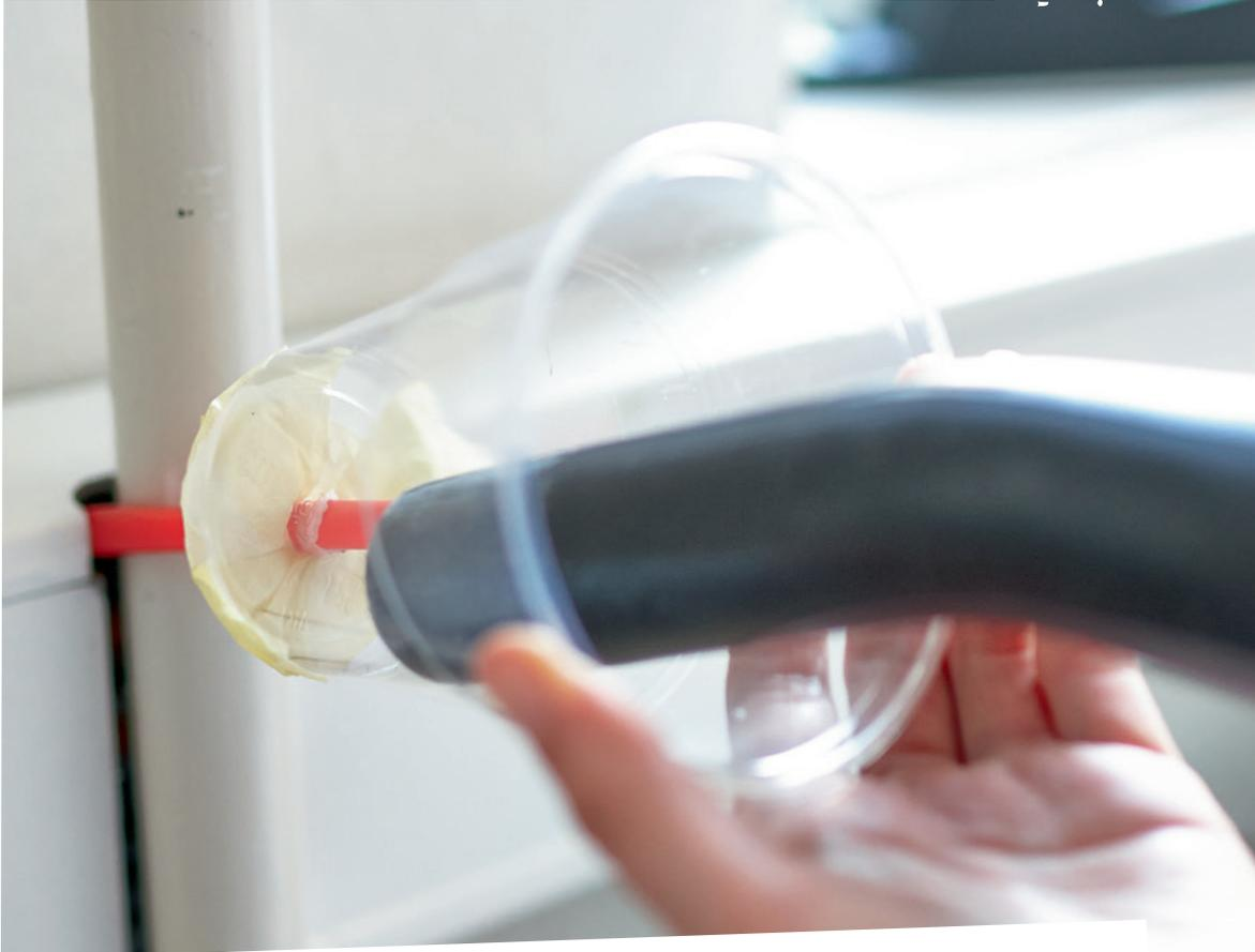
**Manchmal ist das normale Rohr des Staubsaugers zu breit, um die engste Stelle oder die hinterste Ecke zu erreichen. Dann braucht dein Staubsauger einen Minisaugadapter - und zwar aus einem Plastikbecher und einem Strohhalm. Mache ein Loch in den Becher, durch das du den Strohhalm steckst. Den Becher stülpst du nun über das Staubsaugerrohr, sodass das hintere Ende des Strohhalms im Rohr verschwindet.**
