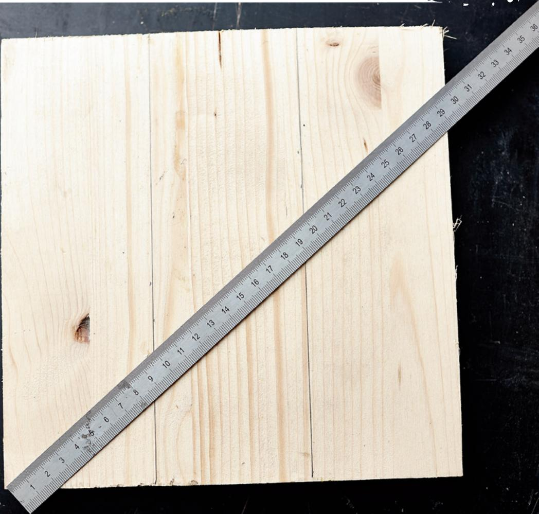
**Ein Werkstück lässt sich ganz einfach in mehrere gleichgroße Stücke teilen. Lege einen Zollstock oder ein Maßband quer an, sodass eine einfach zu teilende Zahl entsteht, z. B. 30 cm bei drei Teilen). Dann jeweils ein Drittel anzeichnen, also jeweils bei 10 cm eine Markierung setzen.**
