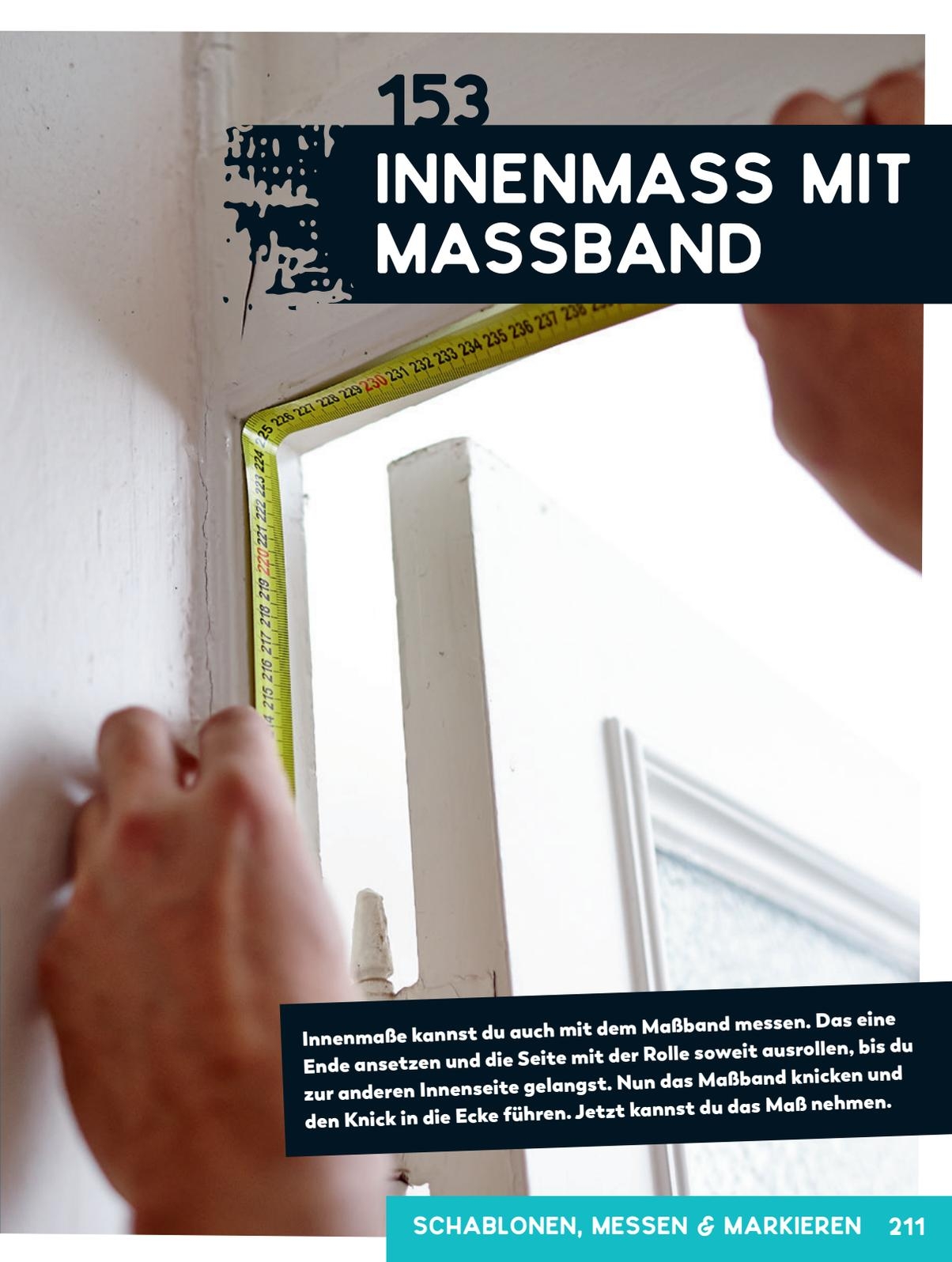
Innenmaße kannst du auch mit dem Maßband messen. Das eine Ende ansetzen und die Seite mit der Rolle soweit ausrollen, bis du zur anderen Innenseite gelangst. Nun das Maßband knicken und den Knick in die Ecke führen. Jetzt kannst du das Maß nehmen.
