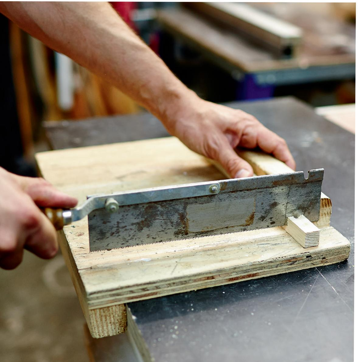
Anwendung: Lege die Sägehilfe nun mit der unteren längeren Leiste an die Tischkante. Zum Sägen legst du die zu sägende Leiste an die kürzere Leiste an und sägst sie ab. Achte darauf, dass du die Stirnseite der Anschlagleiste als Führung für die Säge nimmst, um einen geraden Schnitt zu erzielen.
