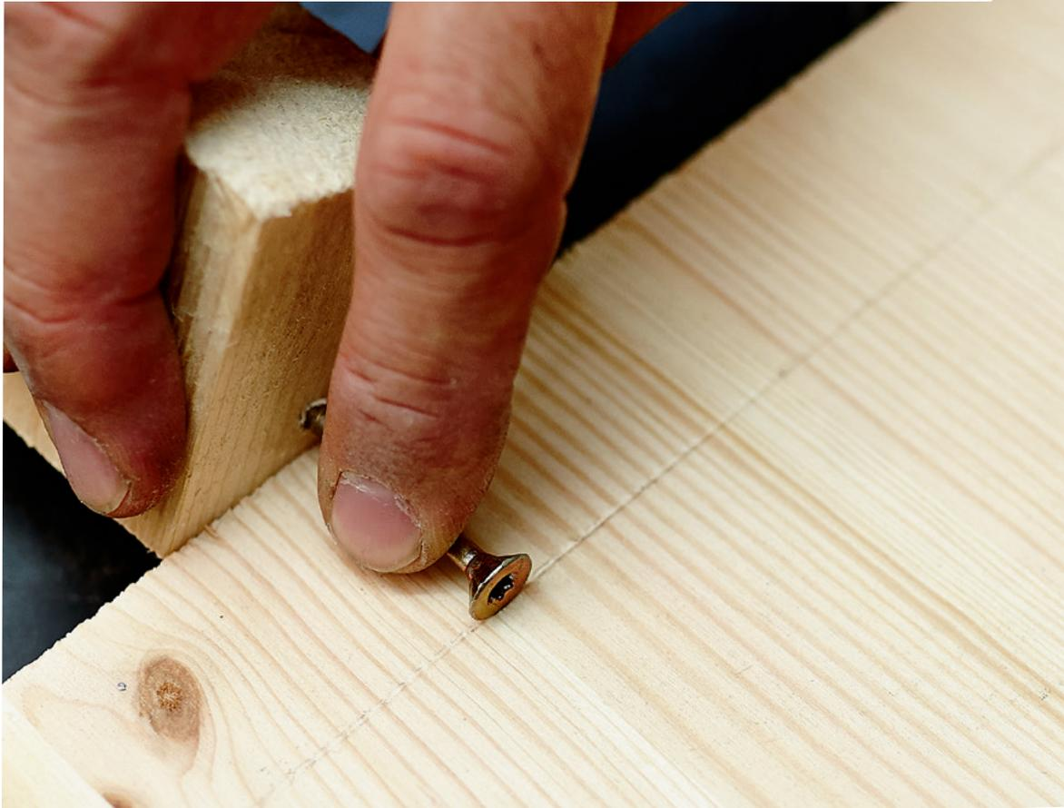
**So baust du dir im Handumdrehen ein Streichmaß: Drehe in einen Holzblock mit gerader Kante eine Schraube in die gewünschte Tiefe ein. Mit der Holzblockkante streichst du nun am Werkstück entlang. Der Schraubenkopf setzt die Markierung.**
