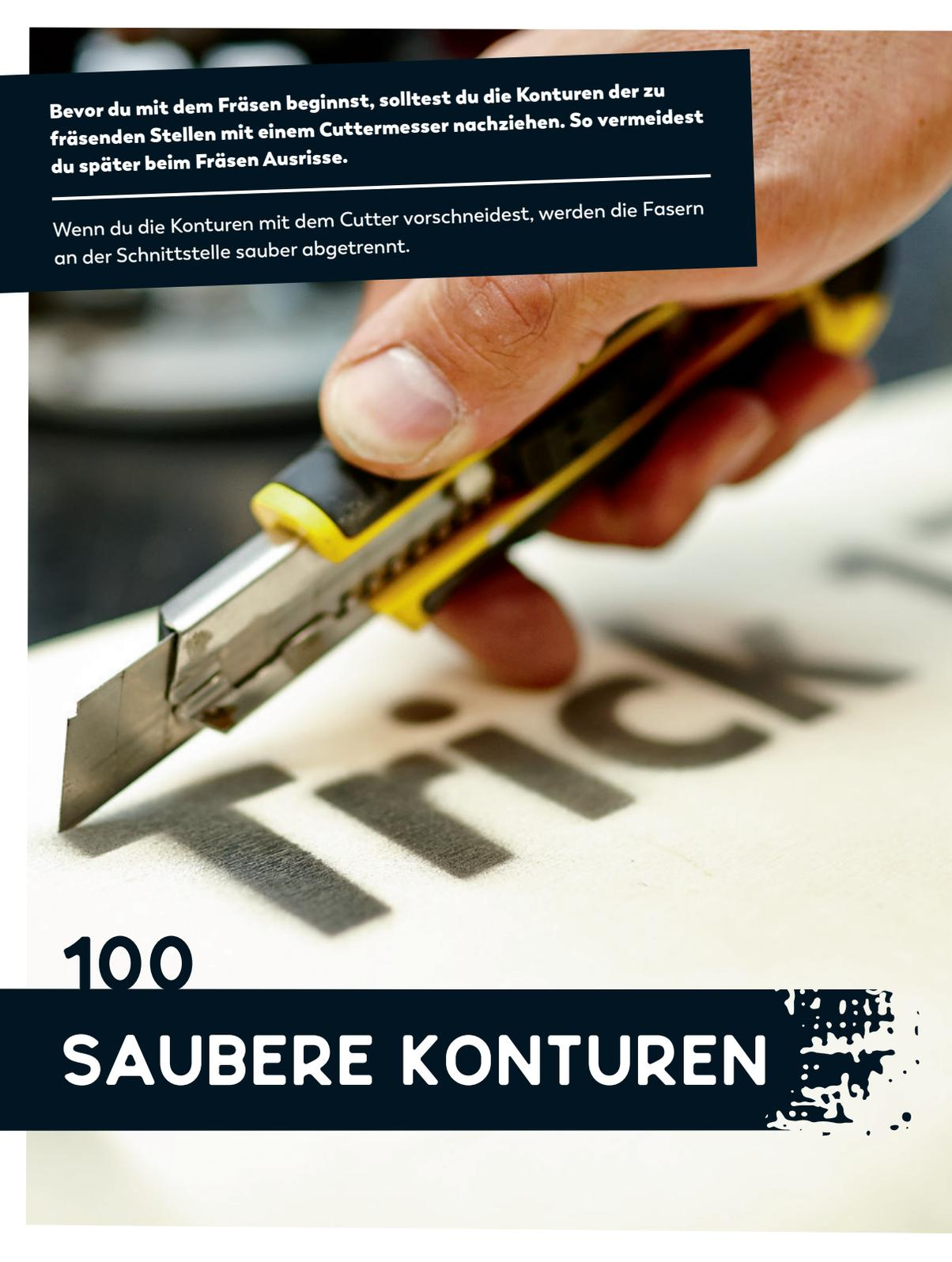
**Bevor du mit dem Fräsen beginnst, solltest du die Konturen der zu fräsenden Stellen mit einem Cuttermesser nachziehen. So vermeidest du später beim Fräsen Ausrisse.**
