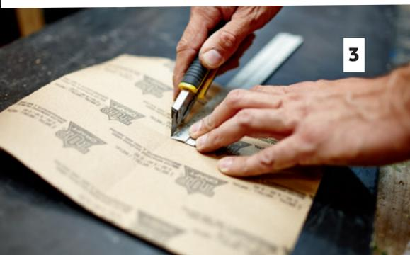
**3** Mache mit einem Cuttermesser und einem Lineal einen Schnitt von der Mitte bis zum Ende einer Falte.
