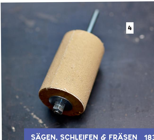
**Alte Schleifbänder, z. B. vom Bandschleifer, sind durchaus noch zum Handschleifen zu gebrauchen. Einfach die alten Bänder auf einen passenden Holzklötz aufbringen und nach und nach weiter ziehen, um zugesetzte Stellen, die keine Schleifqualität mehr haben, zu übergehen.**
