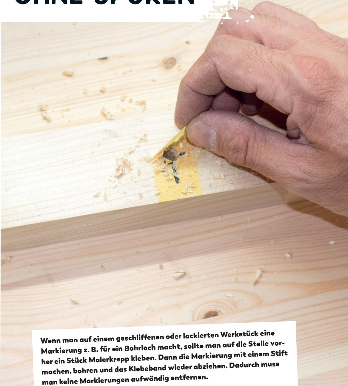
**Wenn man auf einem geschliffenen oder lackierten Werkstück eine Markierung z. B. für ein Bohrloch macht, sollte man auf die Stelle vorher ein Stück Malerkrepp kleben. Dann die Markierung mit einem Stift machen, bohren und das Klebeband wieder abziehen. Dadurch muss man keine Markierungen aufwändig entfernen.**
