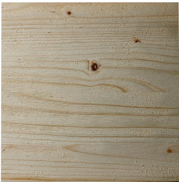
**Wenn bei einem Holzstück die härteren Jahresringe herausgearbeitet werden, wirkt es gleich viel älter. Dafür wird das Holz einfach mit einer weichen Messingbürste bearbeitet, wodurch die Jahresringe betont werden. Je härter die Bürste, desto stärker der Abnutzungseffekt.**
