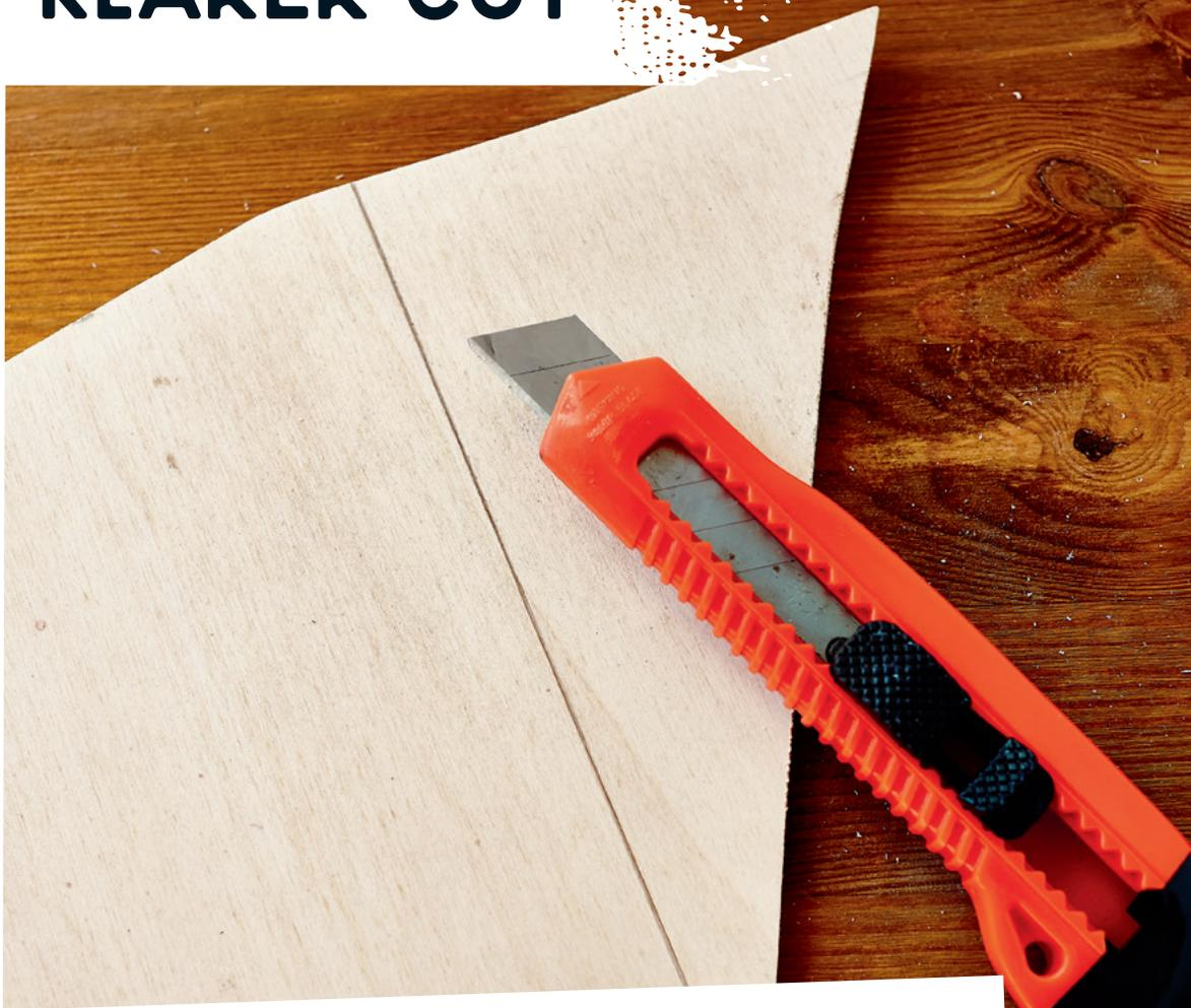
**Dünnes Sperrholz (z. B. 4 mm Pappel) lässt sich hervorragend mit dem Cuttermesser schneiden. So bekommst du sauberere Längsschnitte als mit der Säge.**
