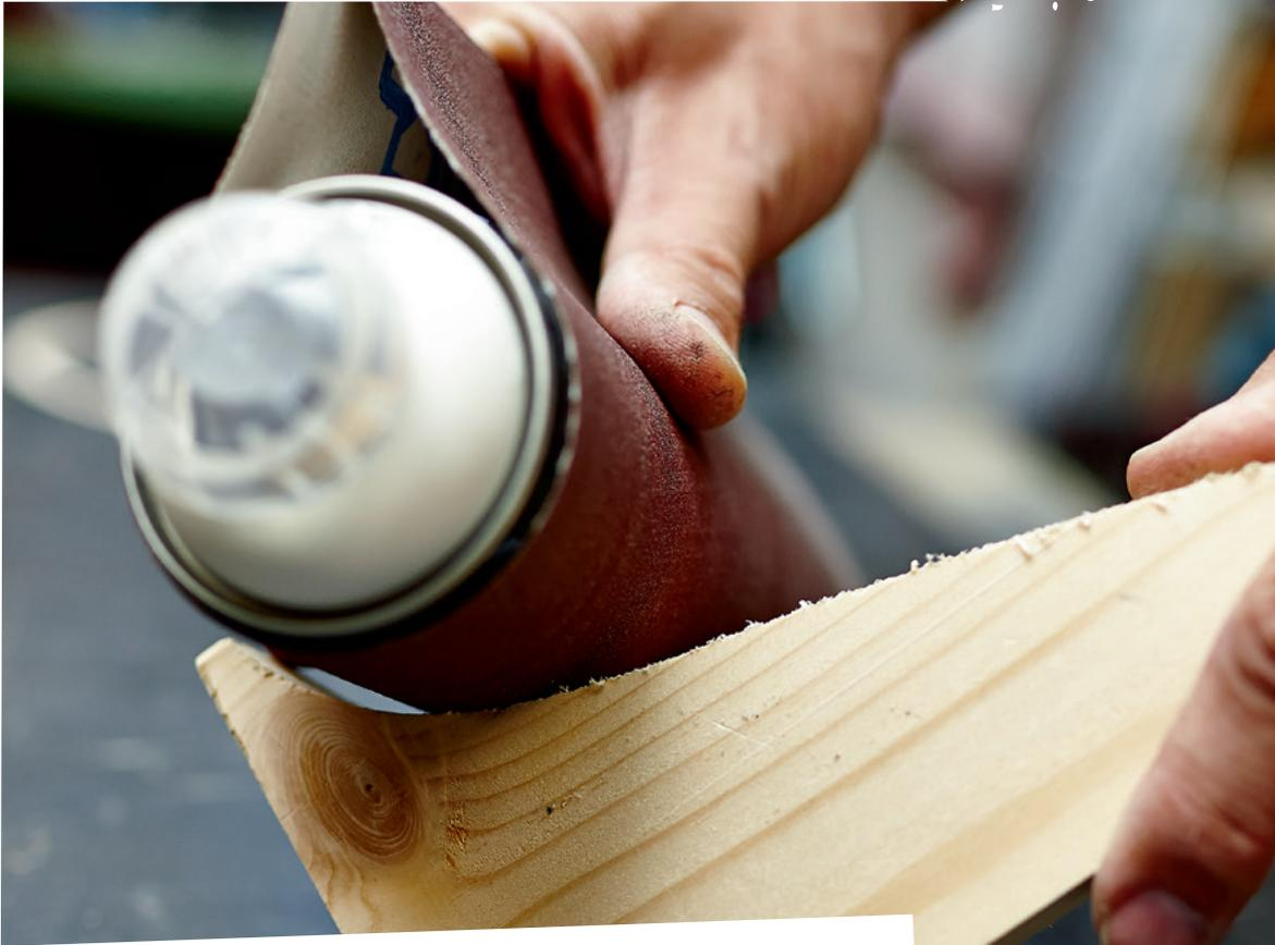
**Um Rundungen zu bearbeiten, bietet es sich an, Schleifpapier um einen runden Gegenstand zu wickeln und so das Werkstück zu bearbeiten. Als mögliche Schleifpapierhalter eignen sich alle runden Gegenstände, z. B. Sprüh- oder Farbdosen, Stifte usw.**
