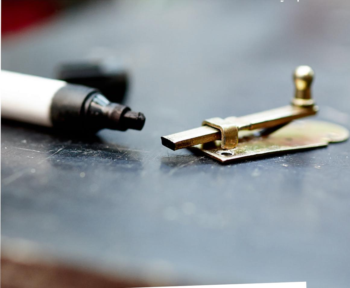
**Um das Schließblech eines Riegels einfach montieren zu können, wird die Stirnseite des montierten Riegels mit einem Filzstift eingefärbt. Den Riegel dann sofort gegen die Fläche drücken, wo das Schließblech montiert werden soll. Jetzt hast du den passenden Punkt gefunden!**
