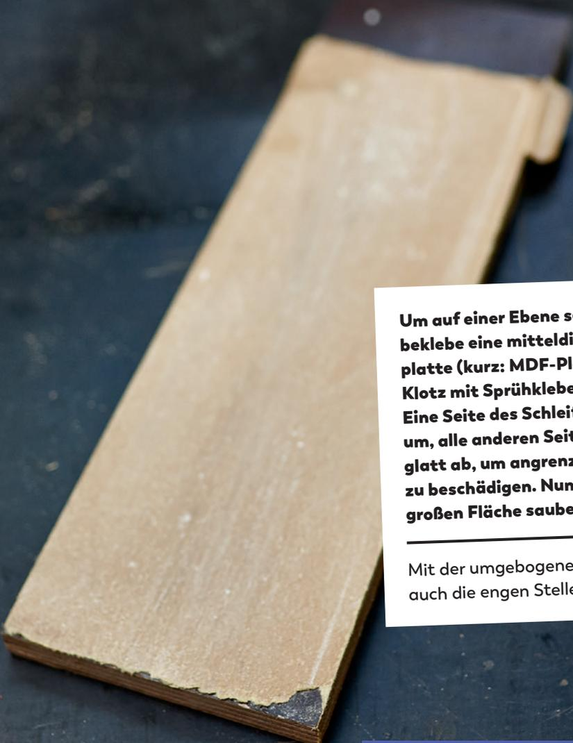
Um auf einer Ebene sauber zu schleifen, beklebe eine mitteldichte Holzfasertafel (kurz: MDF-Tafel) oder einen Klotz mit Sprühkleber und Schleifpapier. Eine Seite des Schleifpapiers biegst du um, alle anderen Seiten schneidest du glatt ab, um angrenzende Flächen nicht zu beschädigen. Nun kannst du mit der großen Fläche sauber schleifen.
