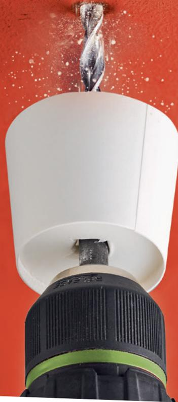
**Wenn du Löcher in die Decke bohren willst und auch hier keinen Staubsauger zur Hand hast, kannst du einen Papp- oder Plastikbecher von unten durchbohren und ihn auf den Bohrer stecken. So lässt sich der Bohrer mit der einen Hand halten und mit der anderen führen.**
