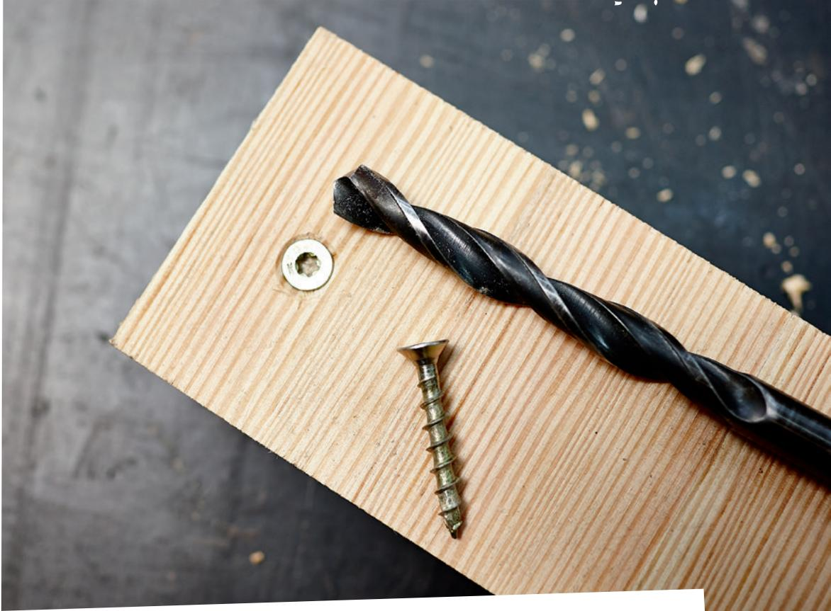
**Löcher für Schrauben solltest du immer senken, damit der Schraubenkopf beim Einschrauben bündig im Werkstück sitzt und nicht die Holzfasern aufstellt.**
