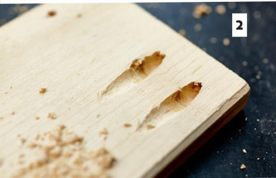
**3** Die zu verbindenden Werkstücke werden aneinander gelegt, mit Leim versehen, fixiert (ggf. mit einer Schraubzwinde) und verschraubt. In den schräg eingebrachten Bohrlochern verschwinden die Schrauben nun auf Nimmerwiedersehen.
