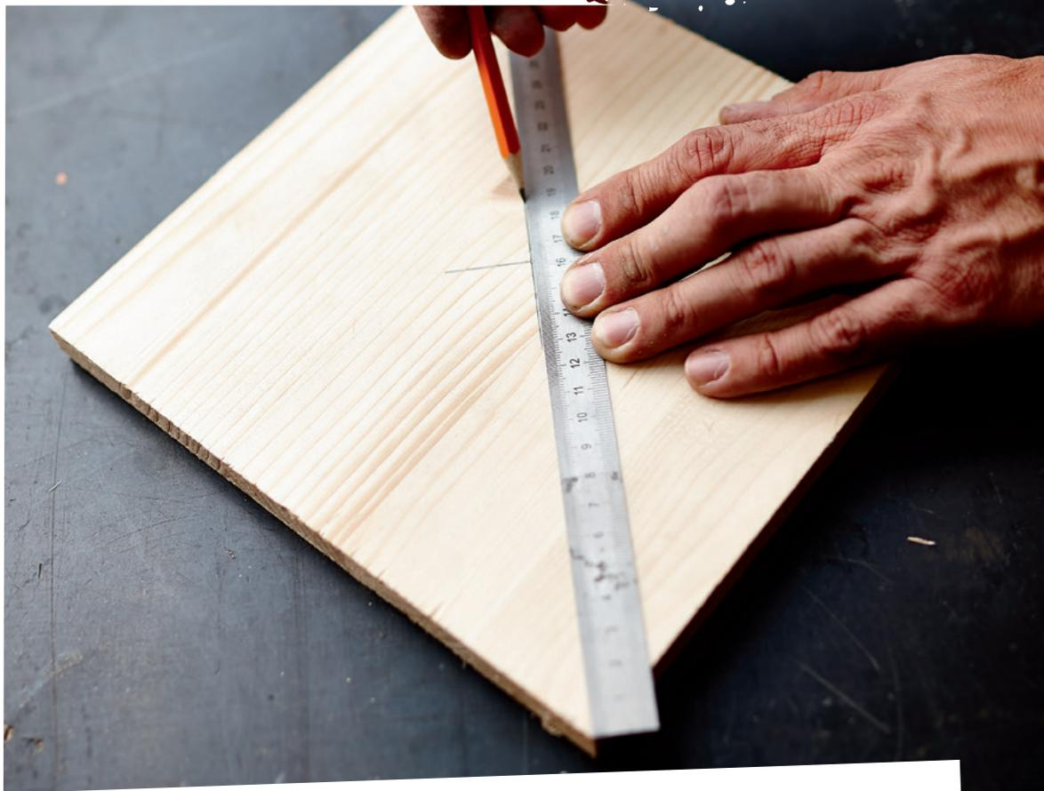
**Die Mitte eines quadratischen Brettes nach Augenmaß zu bestimmen, klappt selten. Gut, dass du immer ein Lineal oder einen Zollstock griffbereit hast, denn damit findest du die Mitte in Sekundenschnelle. Verbinde mit Bleistift und Lineal jeweils die gegenüberliegenden Ecken. Der Schnittpunkt beider Linien ist die Mitte.**
