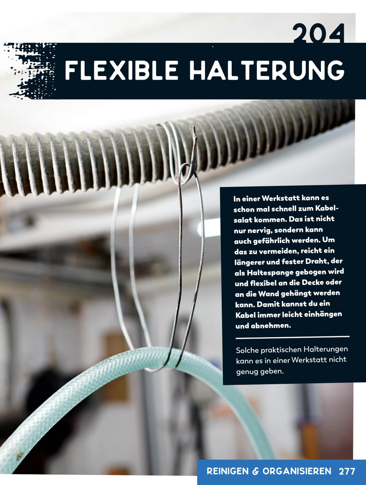
**In einer Werkstatt kann es schon mal schnell zum Kabelsalat kommen. Das ist nicht nur nervig, sondern kann auch gefährlich werden. Um das zu vermeiden, reicht ein längerer und fester Draht, der als Haltespange gebogen wird und flexibel an die Decke oder an die Wand gehängt werden kann. Damit kannst du ein Kabel immer leicht einhängen und abnehmen.**
