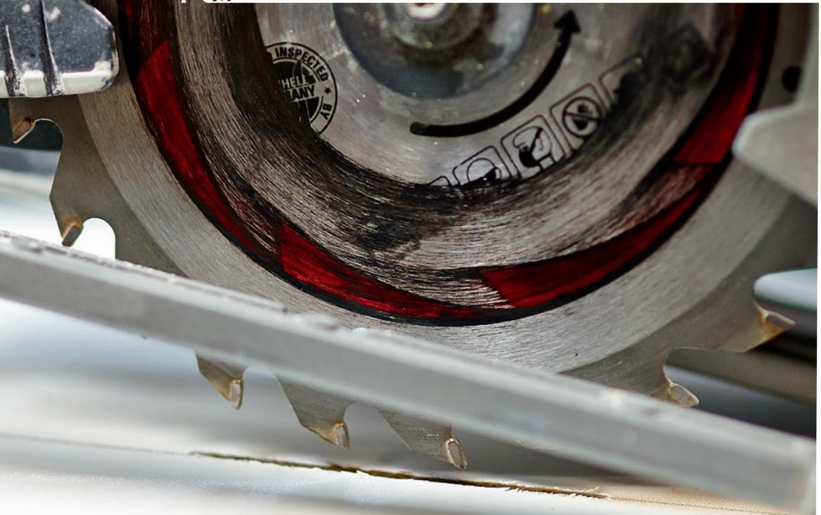
**Ausschnitte in dicke Sperrholz-Arbeitsplatten machst du am besten mit einer Handkreissäge: Ausschnitt anzeichnen, mit der Handkreissäge einen Tauchschnitt machen und bis zur Markierung sägen. Die letzten Millimeter, die aufgrund des runden Sägeblattes unten stehenbleiben, mit der Sticksäge nachsägen.**
