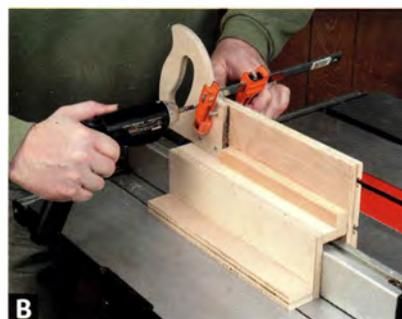
mit den Maßen 30 x 250 mm mit zwei kurzen Hammerschrauben befestigen, die in entsprechend gebohrte Löcher gesteckt werden (D). Bringen Sie unten am Anschlag ein kurzes Querstück an, das als Handstütze und -schutz dient. Richten Sie den Anschlag rechtwinklig am Kreissägetisch aus, und arretieren Sie ihn mit kleinen Drehgriffen. Nach Wunsch können Sie ihn durch eine Exzenterklemme ergänzen, mit der das Werkstück während der Arbeit gehalten wird (E).
