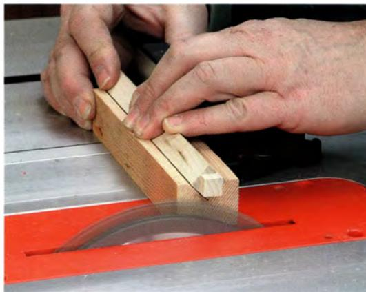
Ein V-Block ist in Verbindung mit dem Gehrungsanschlag an der Tischkreissäge nützlich, um Zapfen, die um 90° versetzt sind, an quadratische Leisten zu schneiden.
