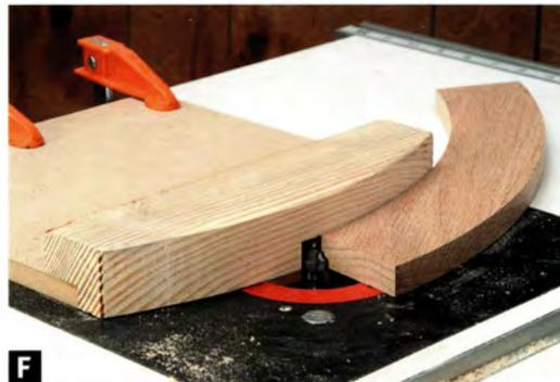
Müssen Sie ein noch komplexeres Teil bearbeiten? Vielleicht den Handlauf einer Wendeltreppe? Sie können einen gebogenen Anschlag für fast jede Situation herstellen, indem Sie zwei gebogene Blöcke miteinander kombinieren. Nehmen Sie ein starkes Stück Vollholz, und schneiden Sie den unteren Anschlag passend für die Krümmung der Unterseite des Werkstücks zu. Bohren Sie zuvor (wie oben) eine Öffnung für den Fräser in den Rohling.
