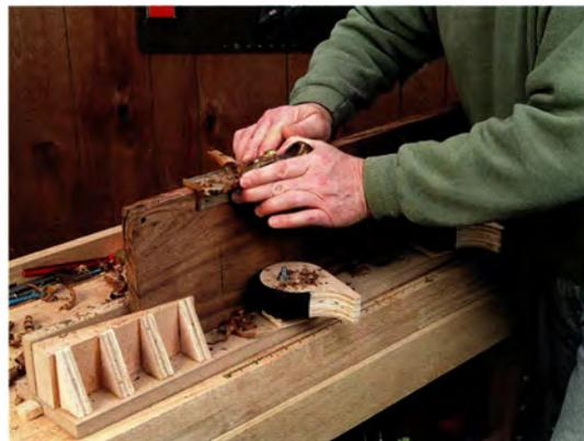
Bei dieser Vorrichtung wird ein Brett mit einer Anlage, einem Keilanschlag und zwei Exzenterklemmen hochkant gehalten, um es zu hobeln, zu fräsen, zu profilieren oder zu schleifen.
