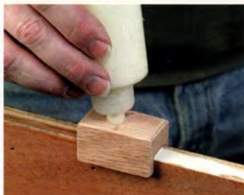
dem Querschnitt 100 x 100 mm einen kurzen Streifen zu, der etwa 10 mm breiter ist als das Material, das Sie verleimen wollen. Schneiden Sie einen Schlitz mittig in den Streifen, der eine Haaresbreite breiter ist als das Material. Zersägen Sie den Streifen zu mehreren
