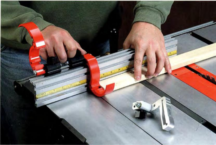
Umlegbare Endanschläge lassen sich in einem Anschlag mit T-Nut an einer Maßskala einstellen, um Material präzise auf Länge zu schneiden.
