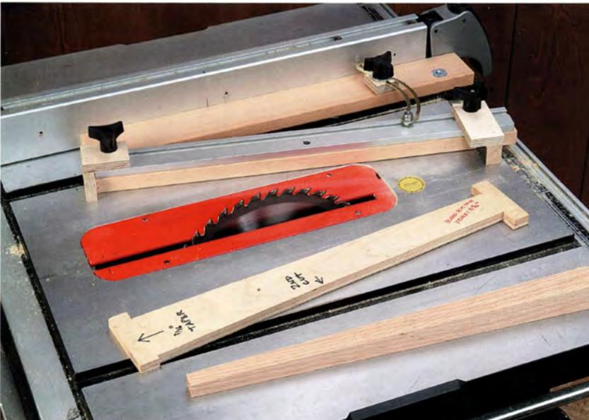
Diese beiden Vorrichtungen dienen dazu, an der Tischkreissäge Verjüngungen zu schneiden. Die hintere ist verstellbar, während die vordere auf einen bestimmten Winkel festgelegt ist.
