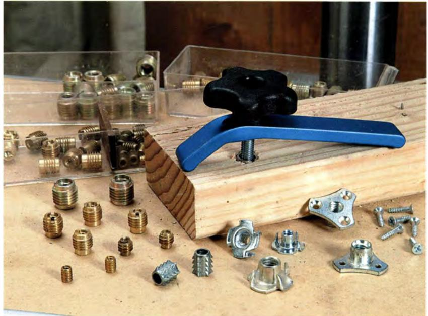
Mit Einschraub- und Einschlagmuttern kann man in Holz oder Kunststoff Gewinde anbringen, um als Aufnahme für Gewindeschrauben, Drehgriffe und Ähnliches zu dienen.
