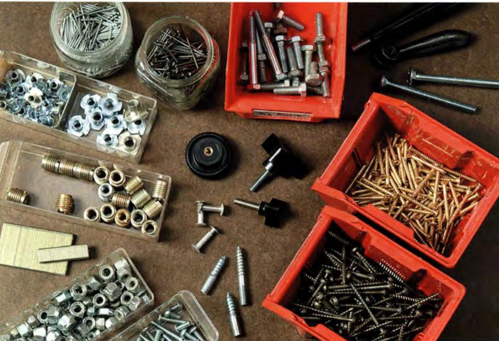
Zur Grundausstattung des Vorrichtungbauers gehören viele Befestigungsbeschläge: Nägel, Holzschrauben, Gewindeschrauben, Muttern, Stockschrauben und vieles mehr.
