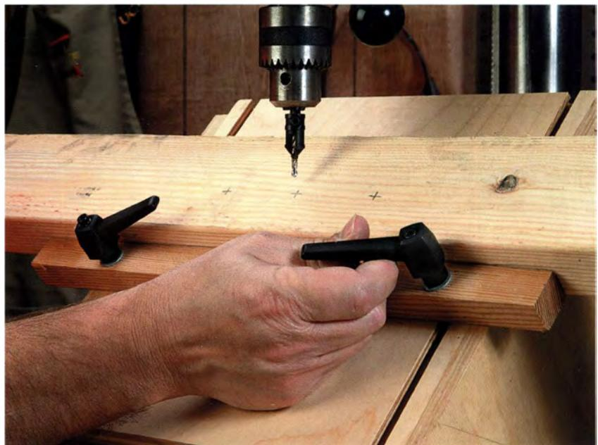
Der Handgriff dieser Verschlüsse kann gegen einen Federwiderstand angehoben werden, um sie so zu drehen, dass sie nicht gegen das Werkstück stoßen, das gegen den Anschlag am geneigten Arbeitstisch der Ständerbohrmaschine gehalten wird.
