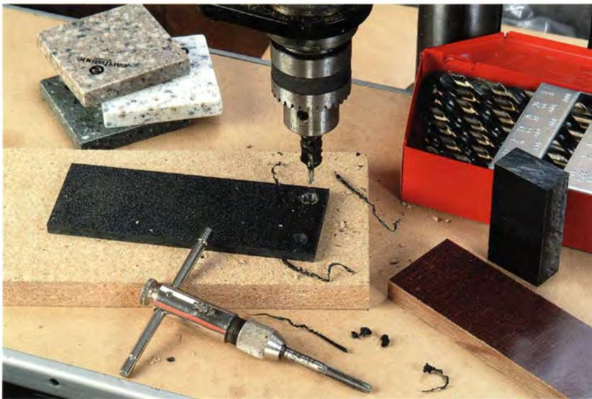
Undurchsichtige Kunststoffe für den Vorrichtungsbau: Mineralwerkstoffe (hinten), ABS (vorne links), Micarta (vorne rechts) und Phenoplast (hinten rechts).
