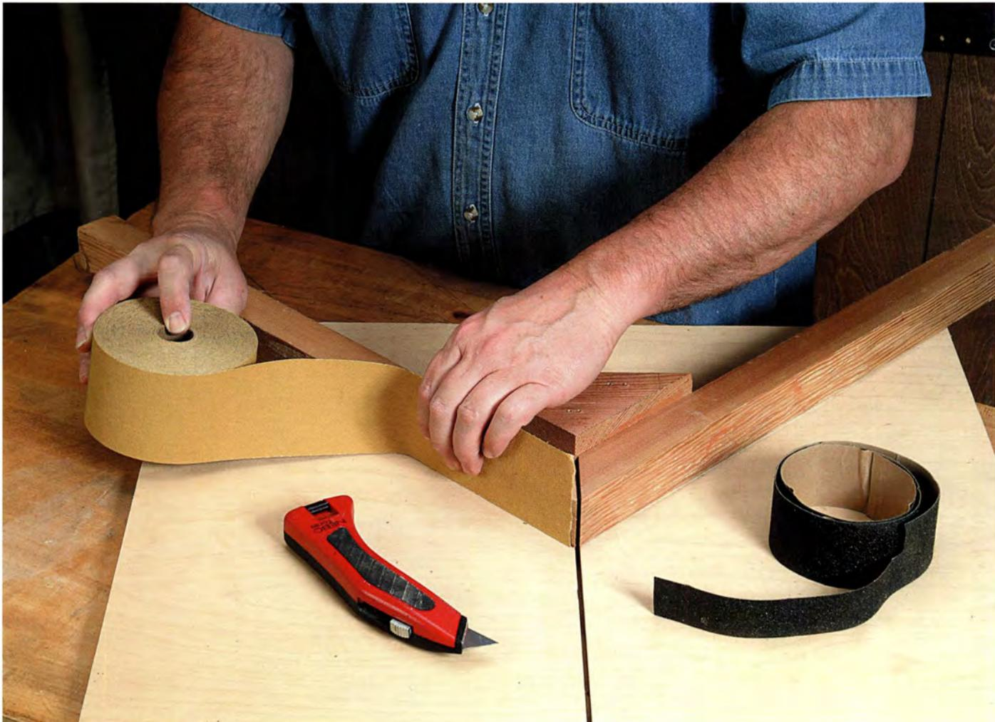
Anschläge und andere Oberflächen von Vorrichtungen können mit selbstklebendem Schleifpapier (so in der Abbildung) oder rutschhemmenden Belägen für Treppenstufen versehen werden, um ihre Reibung zu erhöhen.
