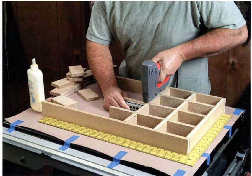
Die MDF-Teile dieses selbsttragenden Kastens müssen lediglich mit Leim und Klammern an den Kanten benachbarter Teile aneinander befestigt werden.
