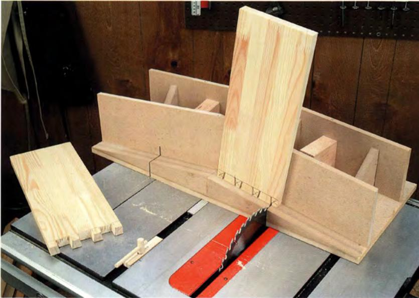
Dieser Schiebeschlitten zum Schneiden von Schwalbenschwanzzinkungen wird in der Nut des Arbeitstisches geführt und kann in vier verschiedenen Positionen verwendet werden, um die rechten und linken Seiten von Zinken und Schwalbenschwänzen zu schneiden.
