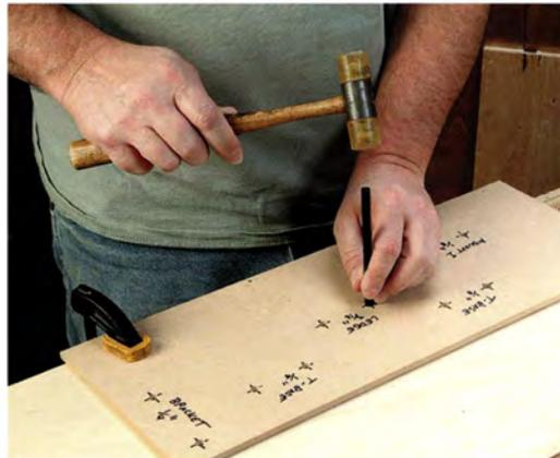
Verwenden Sie eine dünne Hartfaserschablone und einen Transfer-Körner, um bei Kleinserien die Lage von Bohrlöchern für Schrauben und Beschläge genau anzureißen.
