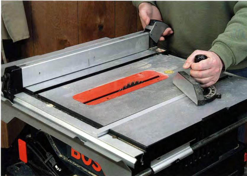
Ein guter Parallelanschlag und Queranschlag sind unabdingbar für genaues Arbeiten an der Tischkreissäge und gehören deshalb zur Serienausstattung.
