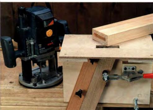
Diese vielseitige Vorrichtung zum Schlitzeln besteht aus einer oben liegenden Schablone und einem Fräser mit Anlauftring. Man kann mit ihr Schlitz in gerade, gewinkelte oder gekrümmte Kanten und Flächen schneiden.
