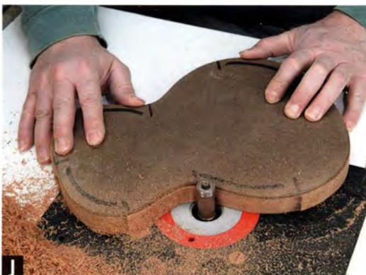
Schneiden Sie das Werkstück grob vor, damit Sie mit dem Fräser nicht Unmengen von Verschnitt entfernen müssen. Bringen Sie dann die Schablone mit doppelseitigem Klebeband, Drahtstiften oder einer anderen Methode an (siehe „Befestigungsmethoden für Schablonen“ auf der gegenüberliegenden Seite) (G). Bei dicken oder schweren Werkstücken halten Schrauben am besten.
