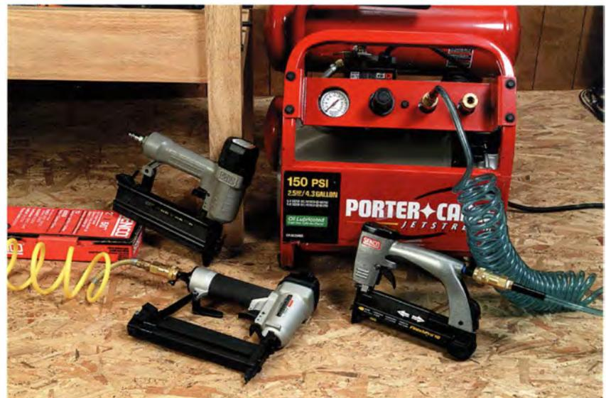
Die meisten Druckluftnagler lassen sich mit einem kleinen Kompressor betreiben. In der Abbildung sind vor dem Kompressor verschiedene Modelle für unterschiedliche Nägel, Drahtstifte und Krampen zu sehen.
