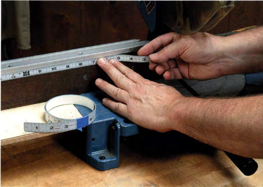
Selbstklebende Maßbänder machen es sehr leicht, Anschläge oder Vorrichtungen mit beweglichen Teilen mit einer Maßskala zu versehen.
