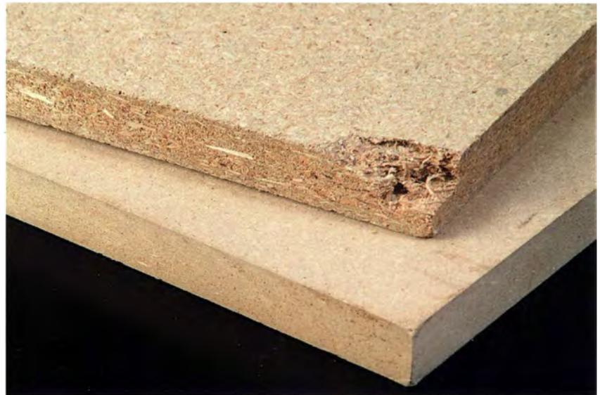
Verlegespanplatte (oben) ist strukturell schwächer als die mitteldichte Faserplatte (MDF), die unten zu sehen ist.
