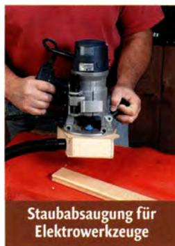
Staubabsaugung für Elektrowerkzeuge
