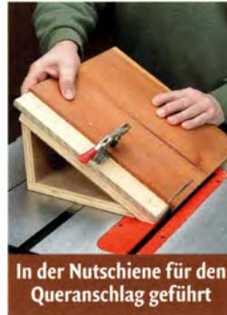
In der Nutschiene für den Queranschlag geführt
