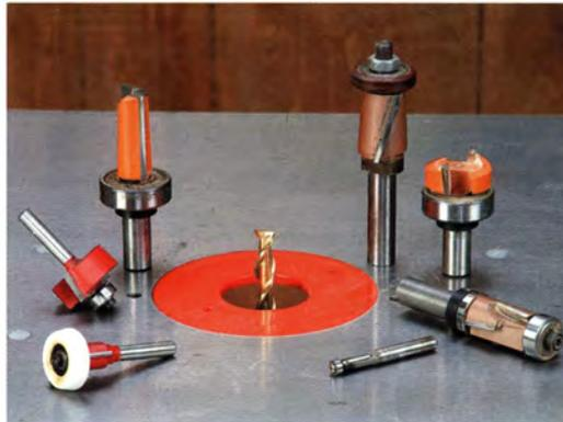
Verschiedene Fräser mit Anlaufring: Bündigfräser, Fräser mit Anlaufring am Ende und am Schaft. Die Anlaufringe können den gleichen Durchmesser wie der Fräser haben, aber auch kleiner oder größer sein.
