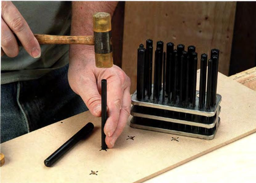
Transfer-Körner können durch eine Bohrung in einer Schablone gesteckt werden, um die Lage der Bohrung sehr genau auf das Werkstück darunter zu übertragen.
