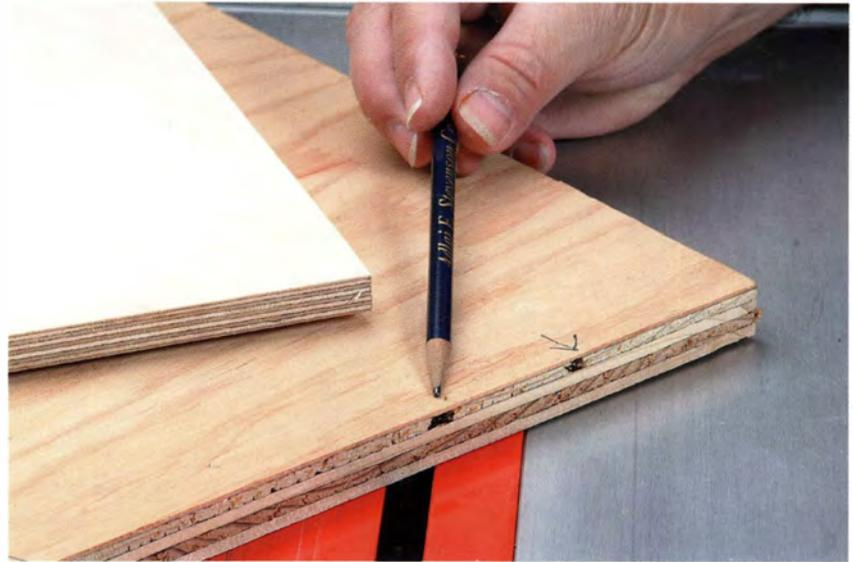
Innenlagen des Sperrholzes mit Ästen oder Hohlräumen wie hier, können bei Bausperrholz zu Schwächungen des Materials führen.
