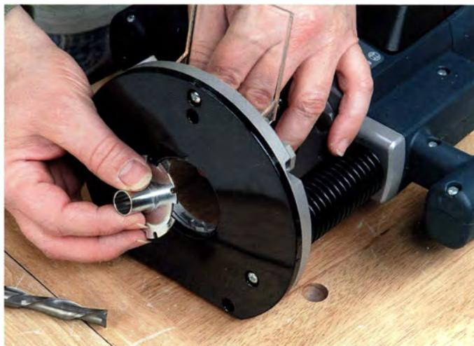
Eine Kopierhülse aus Metall wird in die Grundplatte der Handoberfräse eingesetzt. So kann man sehr effektiv den Fräser an einer Schablone entlang führen, um die Kante eines Werkstücks zu profilieren, eine Verbindung zu schneiden oder Aussparungen für Beschläge oder Einlegearbeiten zu fräsen.
