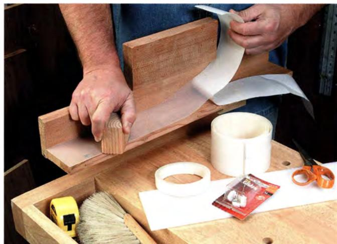
Ultrahochmolekularer Kunststoff (UHMW) ist in Stangen- und Plattenform und als Band mit Klebeseite zu bekommen. Mit dem Band lässt sich der Reibewiderstand von Anschlägen gut reduzieren.
