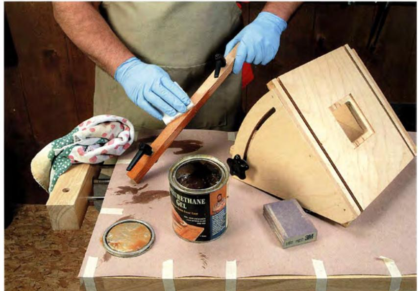
Polyurethanlacke sind sehr einfach aufzutragen und schützen Vorrichtungen gegen Schmutz, Abnutzungen und die Auswirkungen von Veränderungen der Luftfeuchtigkeit.
