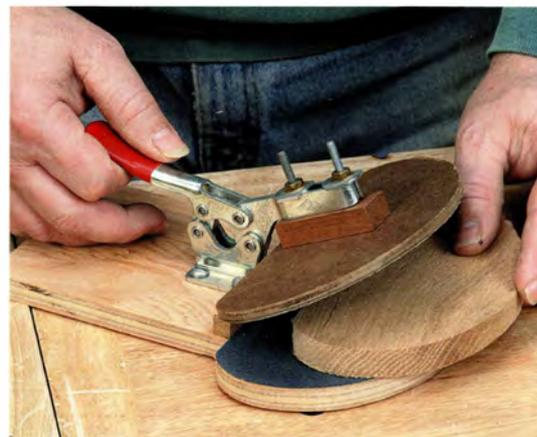
Mit seiner eingebauten Knebelklemme und der Schablonenplatte ist diese Vorrichtung im Stil eines Waffeleisens nützlich, wenn man Kleinserien an der Tischfräse oder am Handoberfräsentisch bearbeiten muss.
