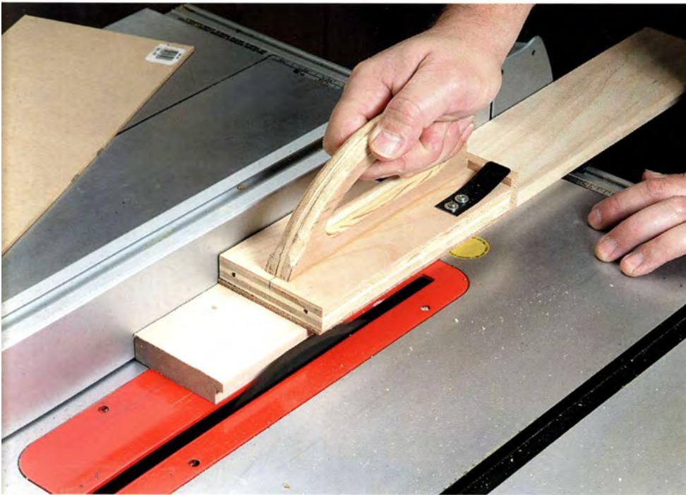
Ein Falz lässt sich an die Kante eines Werkstückes mit zwei Schnitten der Tischkreissäge anschneiden.
