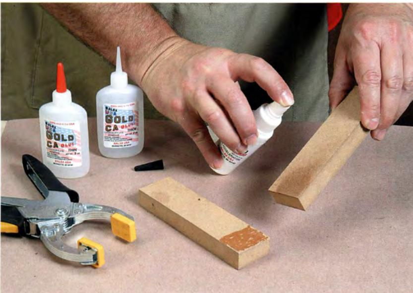
Cyanacrylatkleber wird meist als ‚Sekundenkleber‘ bezeichnet. Er zeichnet sich durch hohe Haltekraft und kurze Trockenzeiten aus, die noch durch einen Beschleuniger verkürzt werden können.
