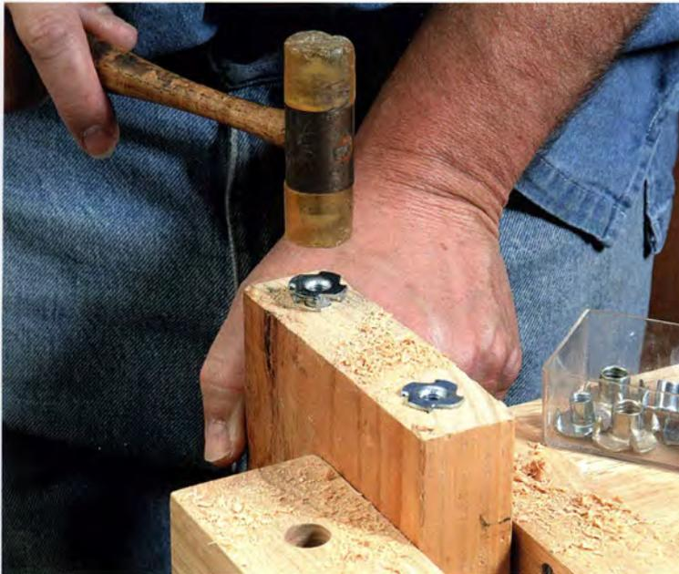
Einschlagmuttern lassen sich mit einem Kunststoffhammer in das vorgebohrte Hirnholz eines Werkstücks eintreiben.
