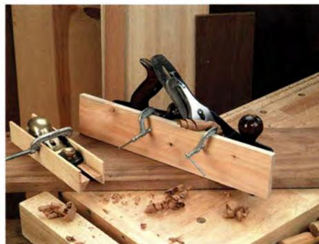
Eine einfache Holzführung, die man an einem Handhobel festspannt, erleichtert das Abrichten und Anfasen von Kanten.
