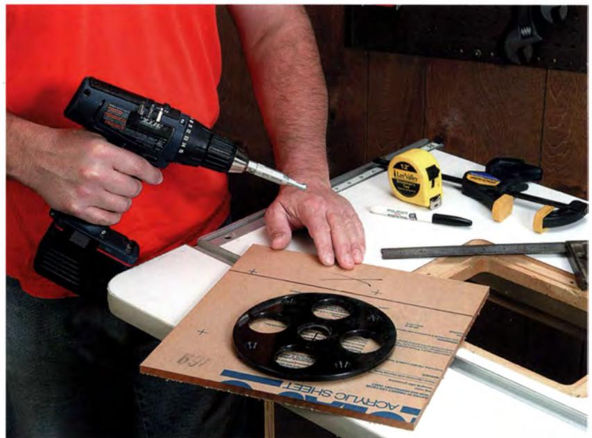
3 mm starker Acrylkunststoff ist wegen seiner Steifigkeit gut für die Herstellung von Grundplatten für Handoberfräsen geeignet.
