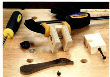
Die U-förmige Klemme des Feineinstellers wird aus drei kleinen Stücken Sperrholz verleimt.
