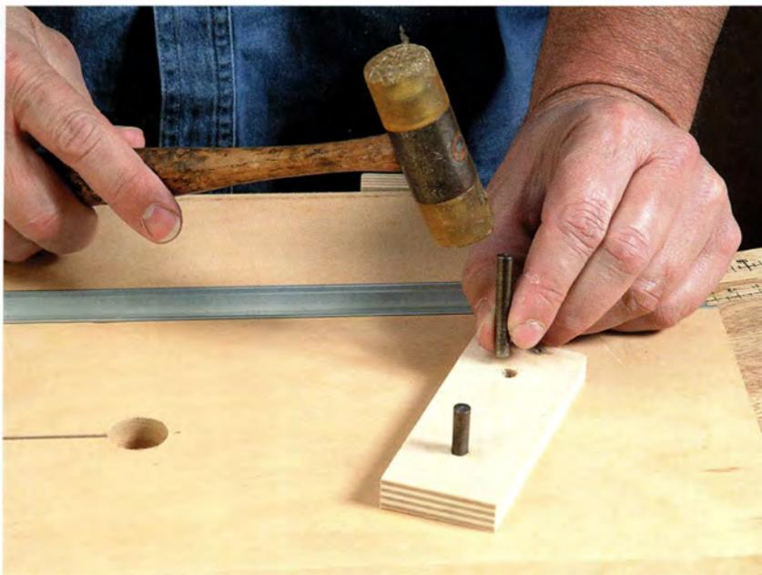
Ein leicht eingeschlagener Kegelstift wird durch Reibungswiderstand in seiner Aufnahme gehalten, das genügt oft, um einen Anschlag oder ein anderes Vorrichtungsteil sicher zu halten, ohne auf Schrauben oder andere Beschläge zurückgreifen zu müssen.
