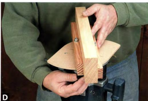
Stellen Sie aus Vollholz zwei Anschläge mit den Maßen 30 x 300 x 20 mm her, und bohren Sie mittig durch die 20 mm breite Seite ein 5-mm-Loch. Bringen Sie in 21 mm Entfernung von einem Ende jeweils eine 5-mm-Stockschraube an, die Sie mit Unterlegscheiben und kleinen Drehgriffen versehen. Leimen Sie neben den Stockschrauben an jedem Anschlag eine kleine Zulage aus Hartfaserplatte an, und befestigen Sie die Anschläge mit 50 mm langen M5-Flachkopfschrauben an der Grundplatte (C).
