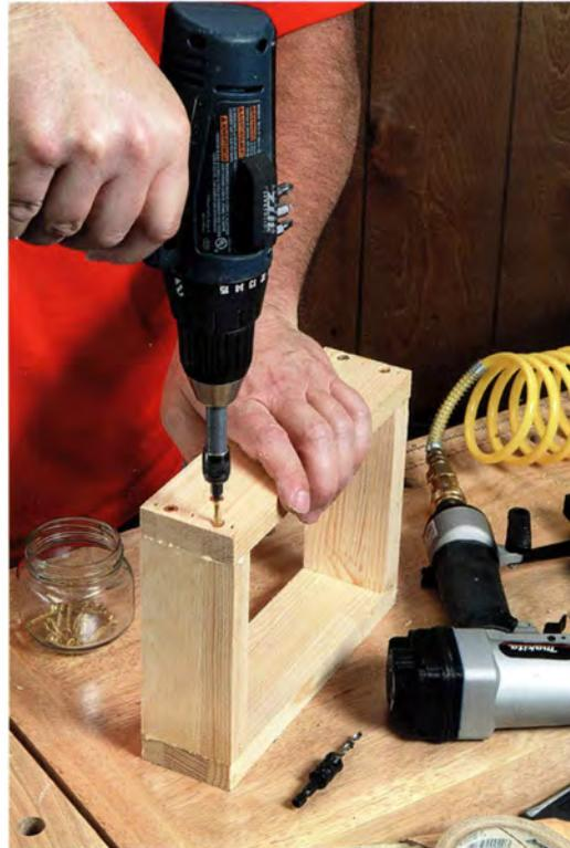
Wenn man zuerst einige Nägel mit dem Druckluftnagler in die geleimten Verbindungen einreibt, kann man hinterher die Verbindung mit Schrauben verstärken, ohne dass die Teile verrutschen.
