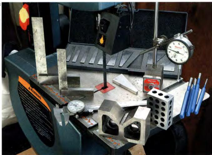
Beim Bau von Vorrichtungen kann man mit Vorteil für die Genauigkeit auf das Werkzeug des Werkzeugmachers, Metallbauers und Feinmechanikers zurückgreifen.
