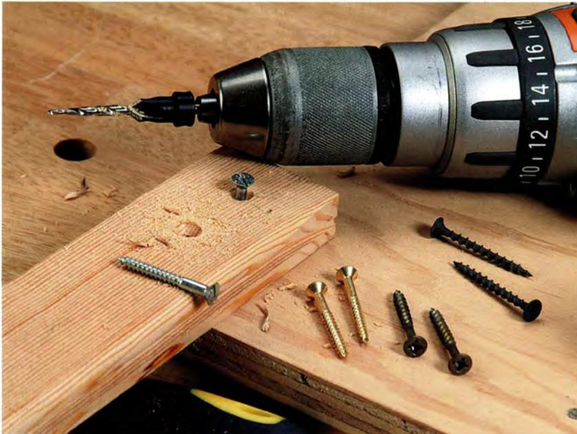
Traditionelle Holzschrauben aus Stahl oder Messing (links) laufen konisch zu, während die moderneren Trockenbau- und Spanplattenschrauben (rechts) gleichbleibend stark sind.
