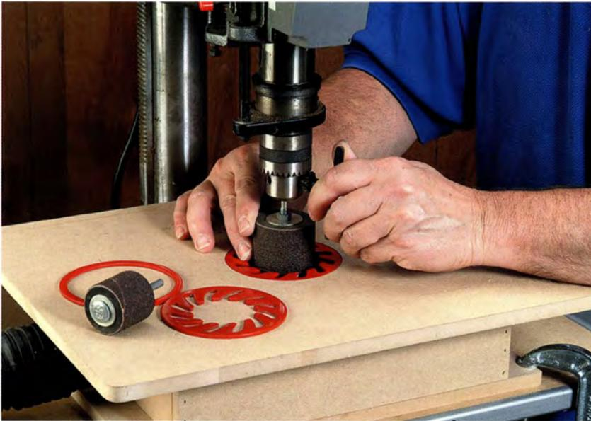
Der Arbeitstisch für diesen Trommelschleiftisch ist als hohler Kasten ausgeführt, der Schleifstaub kann durch einen Staubsaugerschlauch abgeführt werden.
