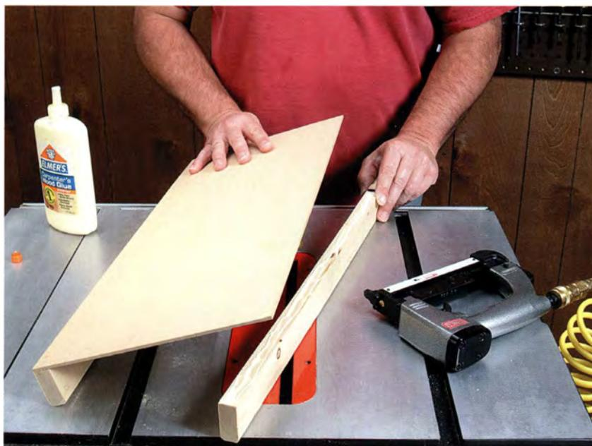
Dünne Hartfaserplatte ist ein sehr preisgünstiges und praktisches Material, um die Grundplatten von Schiebeschlitten herzustellen.
