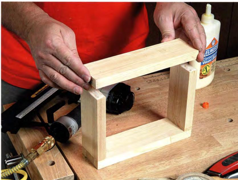
Eine Verbindung auf Stoß muss mit Leim und Nägeln oder Schrauben verstärkt werden, wenn sie dauerhaft sein soll.
