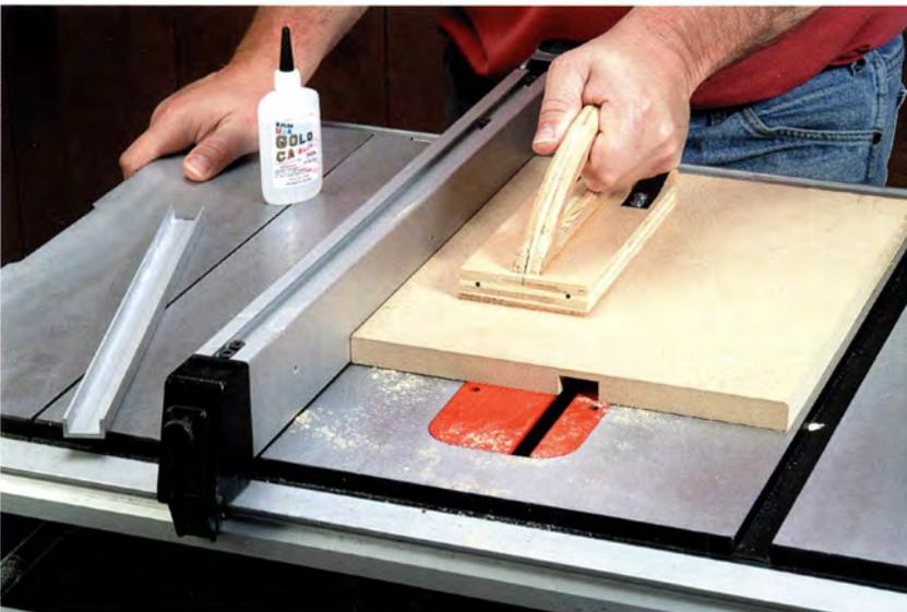
Profilschienen, die in die Nuten von Arbeitstischen eingelegt werden können, sind in unterschiedlichen Breiten erhältlich. Für eine Vorrichtung schneidet man die Nut an der Tischkreissäge oder mit der Handoberfräse passend zu.
