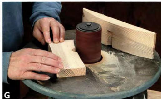
Schneiden Sie einen zweiten Anschlag zu, der der Kante des Werkstücks entspricht, um dieses am Fräser vorbeizuführen. Fräsen Sie eine Kante des unteren Anschlags so, dass er an den anderen Anschlag passt (G). Schrauben Sie die beiden Anschläge zusammen, und bringen Sie sie auf dem Arbeitstisch an, indem Sie sie mit einer Grundplatte daran festspannen oder am Anschlag der Maschine befestigen (H).
