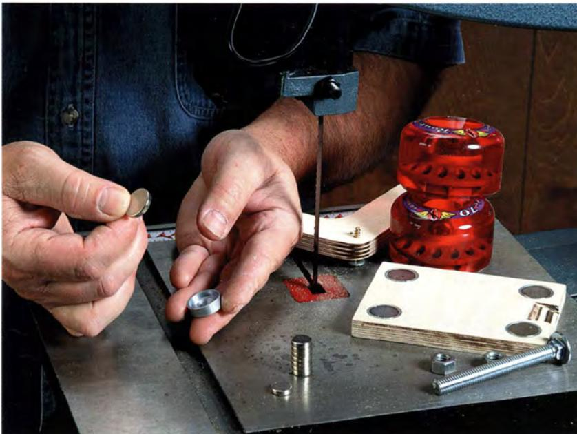
Kraftvolle Magneten aus Seltene-Erden-Legierungen können Anschläge, Niederhalter und andere Vorrichtungen vorübergehend an Stahl- oder Gusseisenflächen befestigen.
