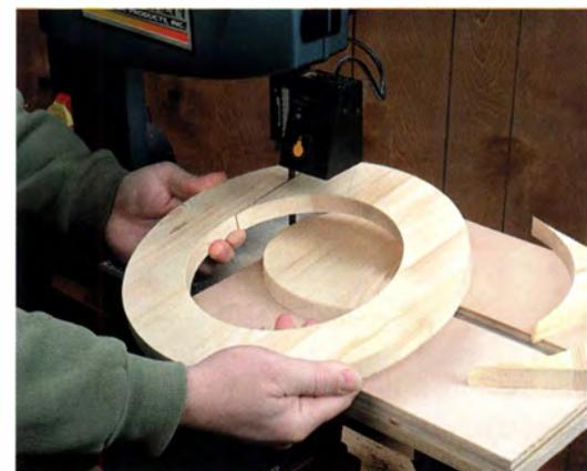
Dieser Anschlag zum Schneiden von Kreisen wird an der Bandsäge verwendet, wo er ein rechteckiges Werkstück auf einem verstellbaren Stift an dem Sägeblatt vorbeiführt, so dass man perfekte Scheiben und Ringe ausschneiden kann.
