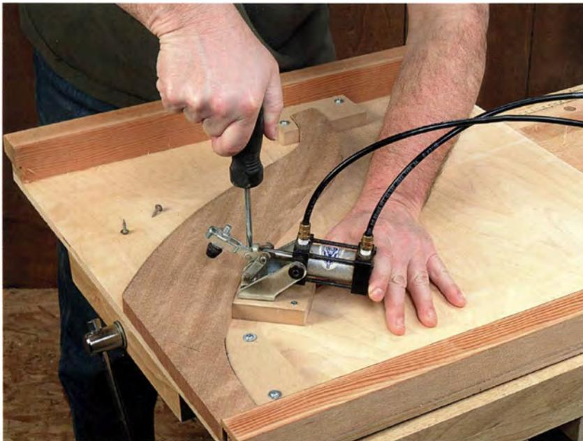
Für die schnelle Anfertigung von Kleinserien kann diese Vorrichtung zum Verputzen von Werkstückkanten mit einem Druckluft einspanner ausgestattet werden.
