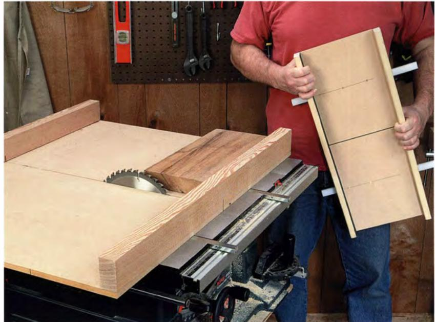
Die meisten Vorrichtungen wie etwa diese Schiebeschlitten für die Tischkreissäge können kleiner oder größer hergestellt werden, um sie an Ihre Maschinen und an Ihre Vorhaben anzupassen.
