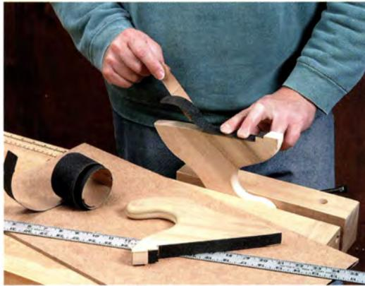
Rutschhemmender Belag, wie er für Treppenstufen verwendet wird, kann auf der Unterkante eines Schiebestocks aufgetragen werden, um die Kontrolle über das Werkstück zu vergrößern.
