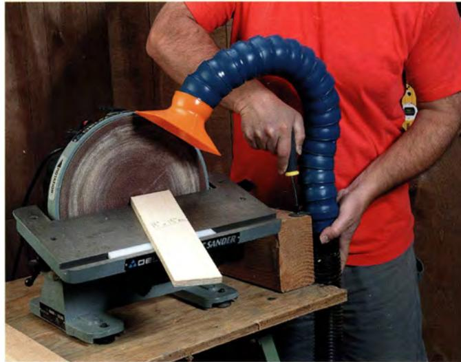
Schleifmaschinen verursachen Unmengen sehr feinen Staubs, der am besten schon an der Quelle eingefangen werden sollte. In diesem Fall sorgt eine Absaughaube dicht an der Schleifscheibe dafür.
