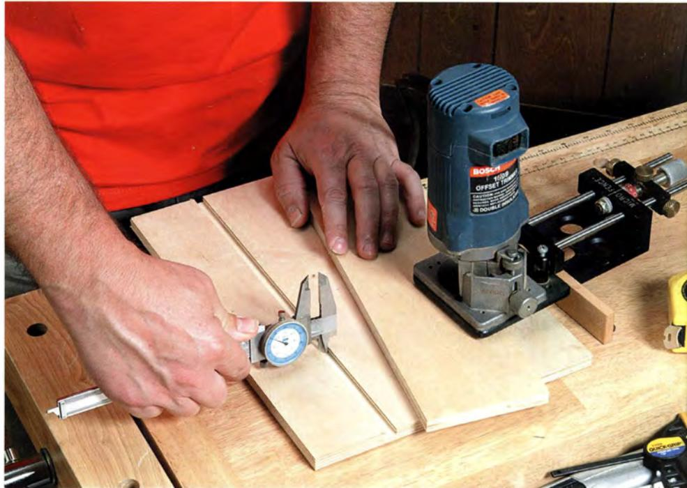
Nuten und Schlitze mit ungewöhnlichen Breiten lassen sich leichter schneiden, wenn man einen guten Parallelanschlag für die Handoberfräse hat, der sich präzise einstellen lässt.
