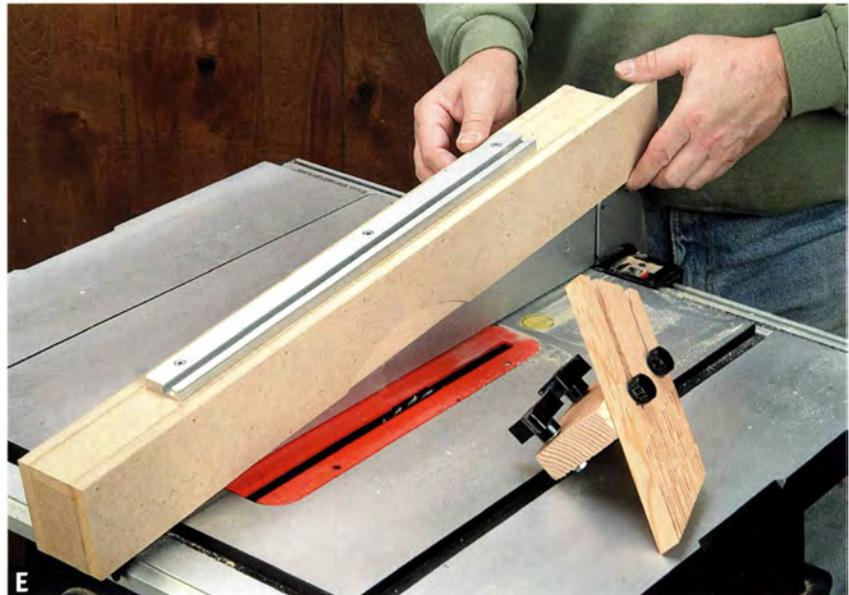
**Variante:** Ein kastenförmiger Hilfsanschlag kann noch vielseitiger gestaltet werden, wenn man von Fall zu Fall Zubehör anschraubt. So kann man zum Beispiel einen kleinen Hartfaserstreifen in einer Nut an der Vorderseite des Anschlags anbringen (A), um dünnes Material wie Kunststoffplatten, Furniere und dünnes Sperrholz daran zu hindern, sich beim Schneiden vom Arbeitstisch abzuheben. Bringen Sie die Nut so hoch an, dass das Sägeblatt den Hartfaserstreifen nicht berührt.
