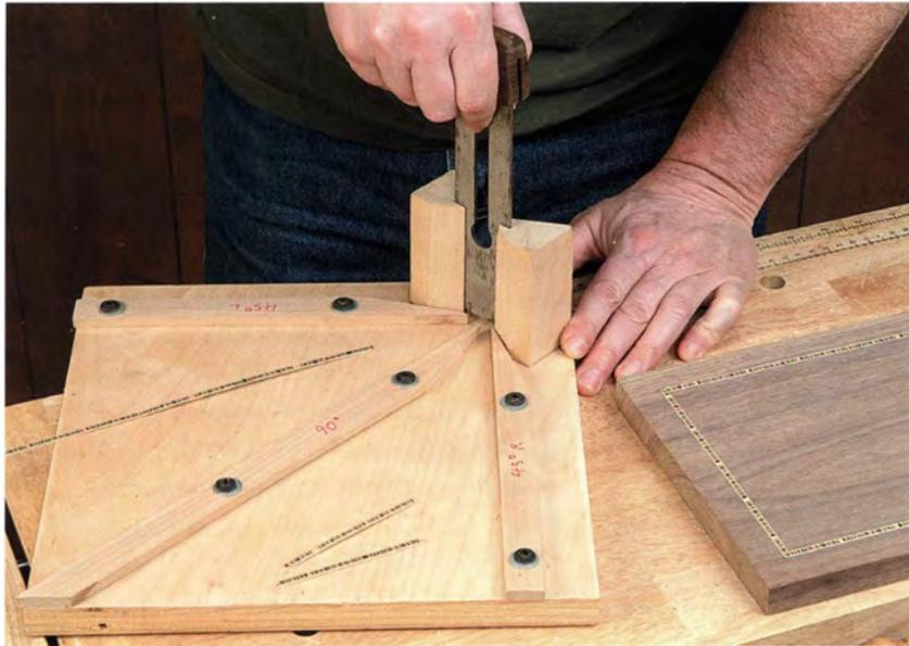
Ein einfaches Hobelmesser wird in dieser Vorrichtung dazu verwendet, Schnitte im 45°- oder 90°-Winkel an Furnieradern auszuführen.
