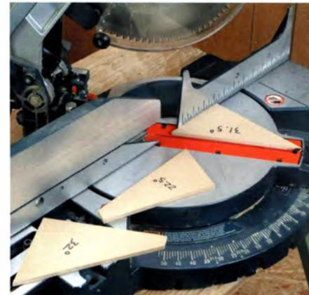
Dreiecke aus Hartfaserplatte mit verschiedenen Winkeln helfen beim schnellen und genauen Einstellen der Gehrungssäge.
