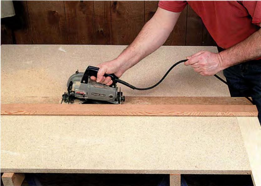
Am besten lassen sich große Bretter, Bohlen oder Platten aufteilen, indem man sie an Ort und Stelle mit der Handkreissäge an einer Führung sägt.
