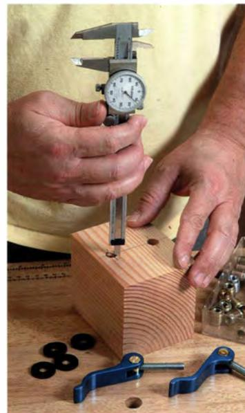
Mit dem Messschieber lassen sich Außen- und Innenmaße von Bauteilen ebenso überprüfen wie die Tiefe von Bohrlöchern und Nuten.
