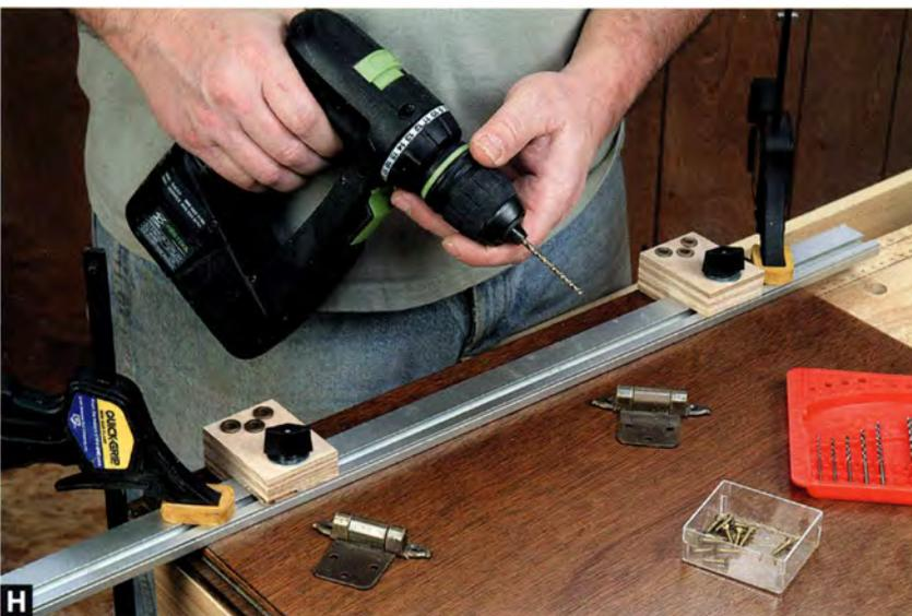
Werkzeug- oder Versandhandel sind solche Hülsen mit Innendurchmessern zu erhalten, die zu den meisten Bohrerdurchmessern passen. Bohren Sie einfach ein Loch in die Lehre, das dem Außendurchmesser der Hülse entspricht, und treiben Sie die Hülse mit einem Klüpfel ein.
