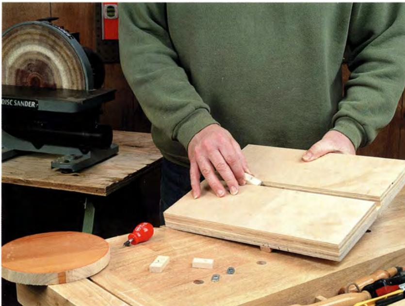
Diese Vorrichtung zum Sägen von Scheiben entstand ursprünglich für die Bandsäge, aber mit ein paar Änderungen kann man sie auch verwenden, um an der Scheibenschleifmaschine die Kanten einer Scheibe zu schleifen.
