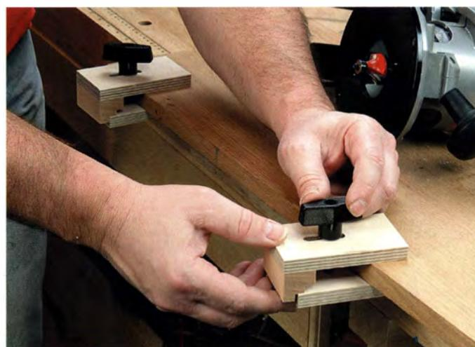
Diese verstellbaren Endanschläge für das Fräsen lassen sich an der Kante des Werkstücks befestigen, um die von der Fräse zurückgelegte Strecke zu begrenzen und damit auch die Länge des profilierten Teiles.
