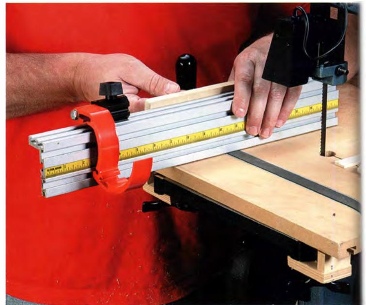
T-Nutschienen, Profilschienen und Anschläge aus Metall sind bei der Herstellung verschiedener verschiebbarer Vorrichtungen sehr nützlich.
