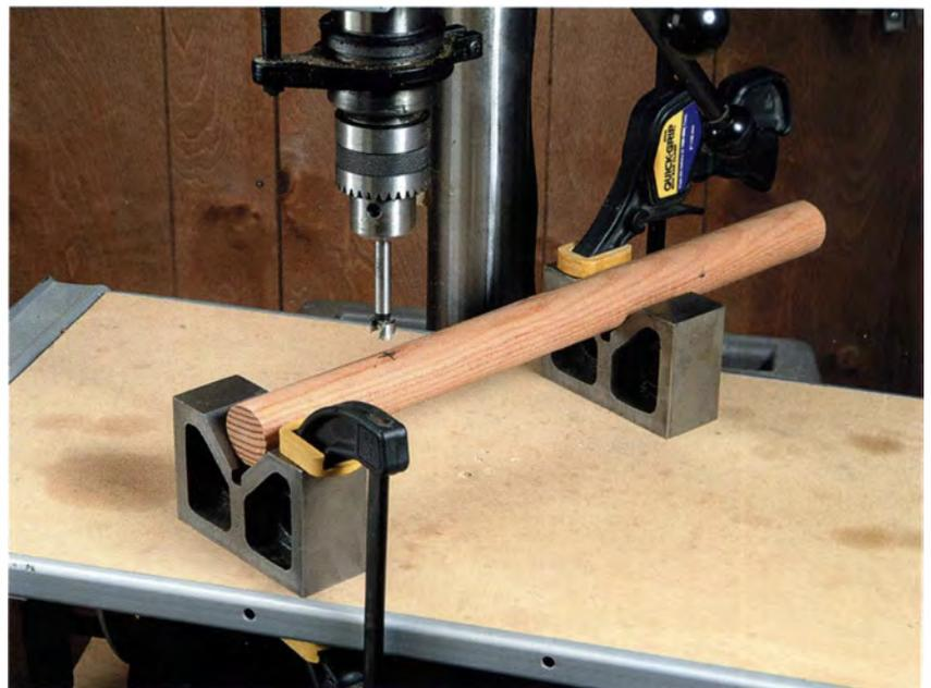
Ein schwerer V-Block hält Rundmaterial beim Bohren und anderen Arbeiten sicher.
