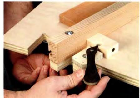
Der Feineinsteller wird an der Kante des Arbeitstisches an der Ständerbohrmaschine befestigt und erlaubt so sehr präzise Einstellungen des Anschlags.
