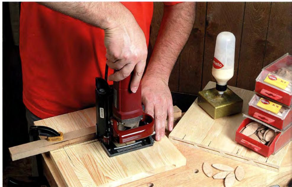
Um ein Bauteil senkrecht auf einem anderen zu befestigen, werden die Schlitz auf der Innenseite des einen Teils und die Kante des anderen gefräst.
