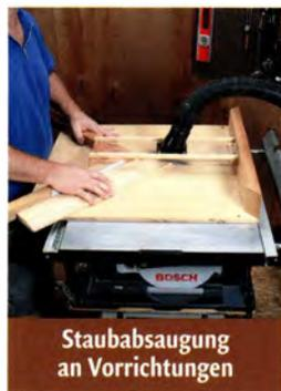
Staubabsaugung an Vorrichtungen
