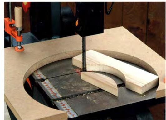
Mit dieser einfachen Führung für die Bandsäge lassen sich schnell geschwungene Rahmenfriesen in größerer Anzahl herstellen.
