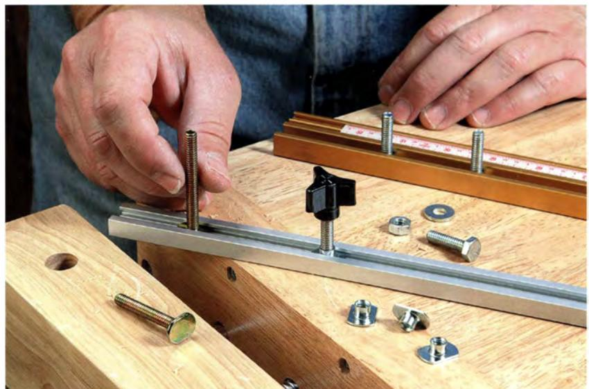
Manche T-Nutschienen nehmen Schrauben mit normalen Sechseckköpfen auf (hinten), während man bei anderen auf Hammerschrauben oder andere Spezialanfertigungen zurückgreifen muss.
