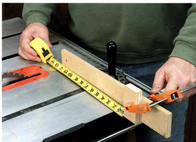
Ein Holzblock, den man am Anschlag der Tischkreissäge festspannt, legt die Länge des zu schneidenden Teils fest.
