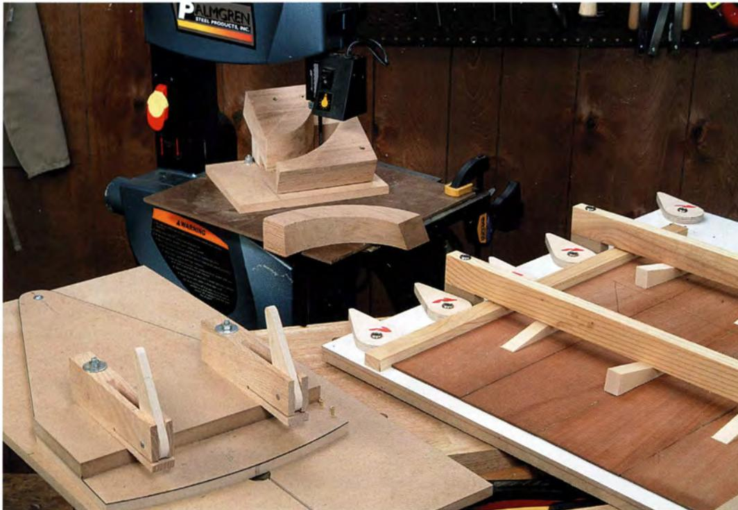
Hier sieht man eine Vorrichtung zum Sägen dreidimensionaler Krümmungen (auf der Bandsäge, hinten), eine schwenkbare Vorrichtung zum Sägen von Kreisbögen (links) und eine Vorrichtung für Längsverleimungen (rechts)
