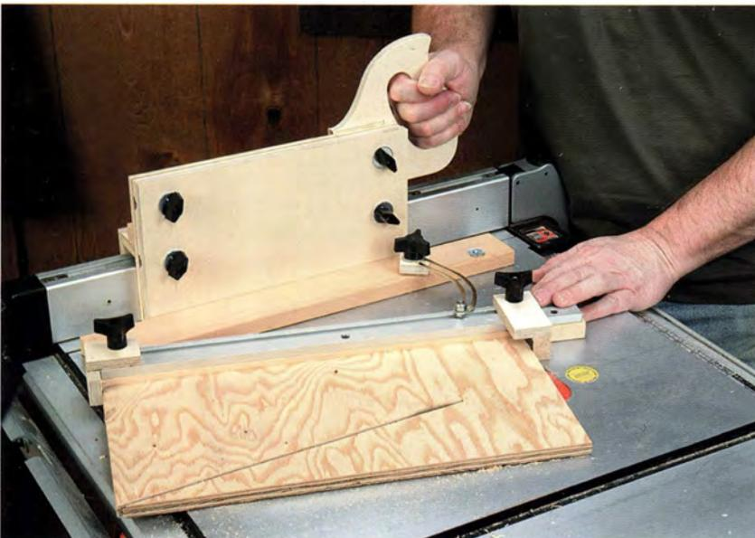
Diese Vorrichtung für Winkelschnitte wird am Parallelanschlag der Tischkreissäge geführt. Sie ist verstellbar, mit einem praktischen Handgriff ausgestattet und erlaubt sogar das Zuschneiden von Dreiecken.
