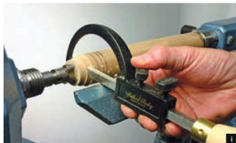
Cut 7 Sizing the tenon.
