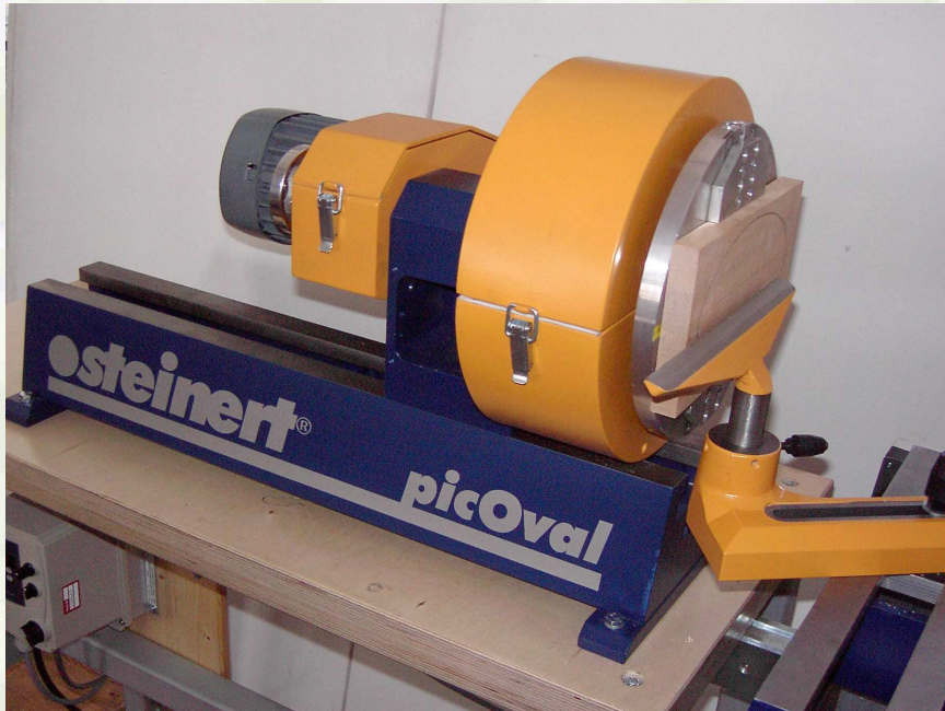
Figure 3406 Ovalturning lathe picOval (Drechselzentrum Erzgebirge Steinert ®, 2006)
