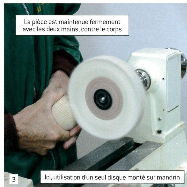
Pour appliquer la pièce à polir contre les disques en rotation, tenez-la fermement, si possible les mains près du corps, pour avoir un bon contrôle.
