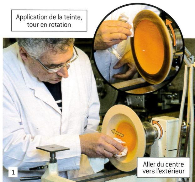
Logiquement, avec cette teinte hydro, il ne doit y avoir ni débordement ni infiltration dans les fibres en dehors de la zone à teinter et ce, pour la bonne raison que cette teinte hydro, très concentrée, est appliquée en faible quantité, sans humidifier le support (Photo 2).
