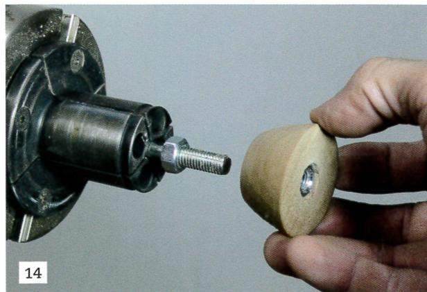
Vissez fermement le deuxième écrou pour que le tampon soit bridé entre les deux écrous. Un peu de colle contact sur les deux écrous bloquera l'ensemble.
