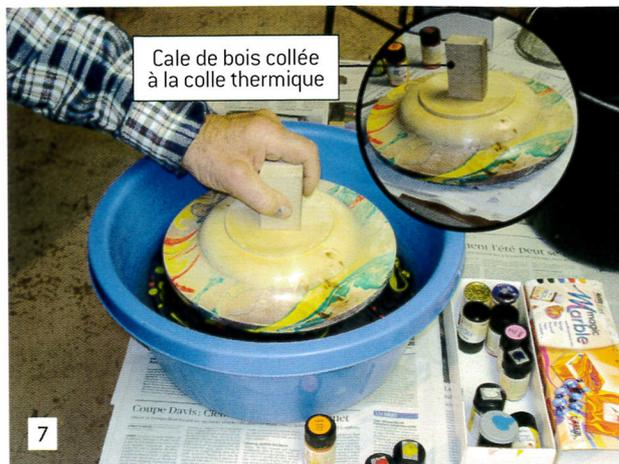
Retirez votre pièce de la colle et trempez-la immédiatement dans le seau d'eau en l'agitant dans le sens vertical. Vous pouvez compléter cette phase de rinçage par un passage sous le robinet.
