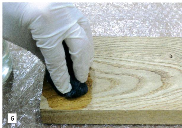
Afin de bien maîtriser la couleur, il est préférable de faire un essai sur une pièce martyre. Pour des temps de trempage différents de la pelote (par exemple trois heures, quatre heures, onze heures...), tracez une ligne avec la pelote sur la pièce de bois, en notant le temps de trempage à côté de cette ligne (Photo 7). Vous aurez ainsi un aperçu des couleurs obtenues en fonction du temps de trempage.
