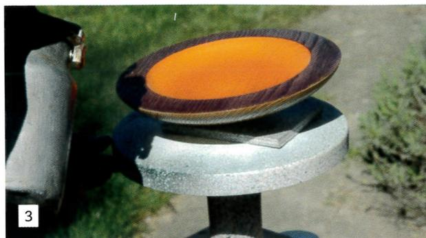
Diluez le fond dur selon les prescriptions du fabricant (généralement 10 à 20 % voire plus, sur un bois à pores creux, pour assurer une meilleure tension du film). Dans le cas d'une forte dilution, une à deux couches supplémentaires seront nécessaires.
