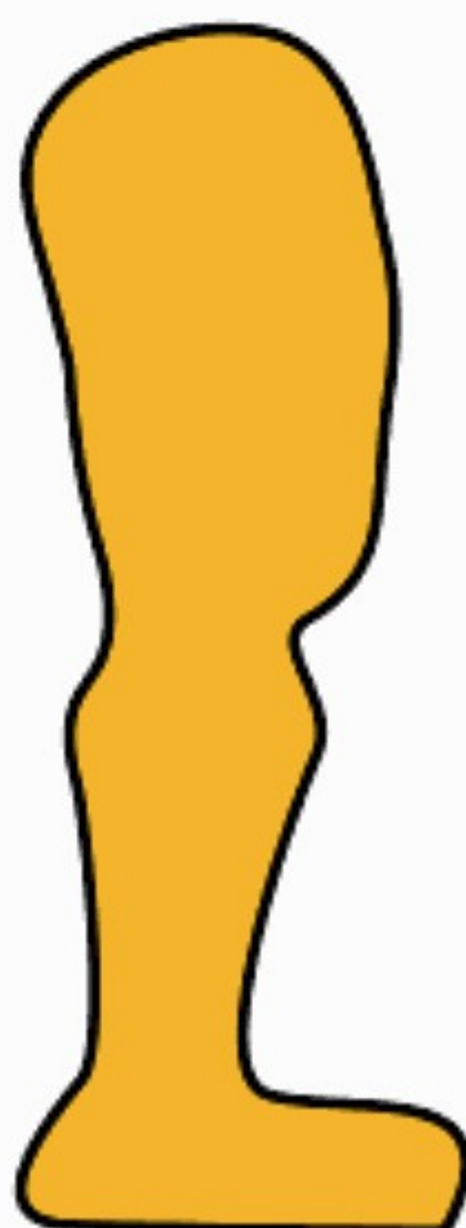
LEG ACTUAL SIZE MAKE 2 1/2" thick wood
