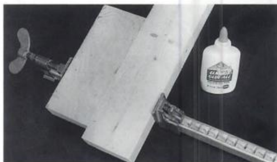
Abbildung 12 Sie können größere Holzflächen schaffen, indem Sie Hölzer mit den Maßen 50 x 100 mm Kante an Kante aneinanderleimen. Dadurch lassen sich Verwerfungen und die inneren Spannungen größerer einteiliger Massivhölzer vermeiden.
