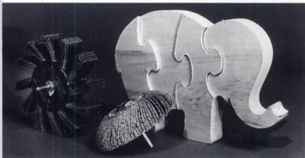
Abbildung 70 Mit Fächerschleifern geht das Abrunden scharfer Kanten rasch vonstatten.
