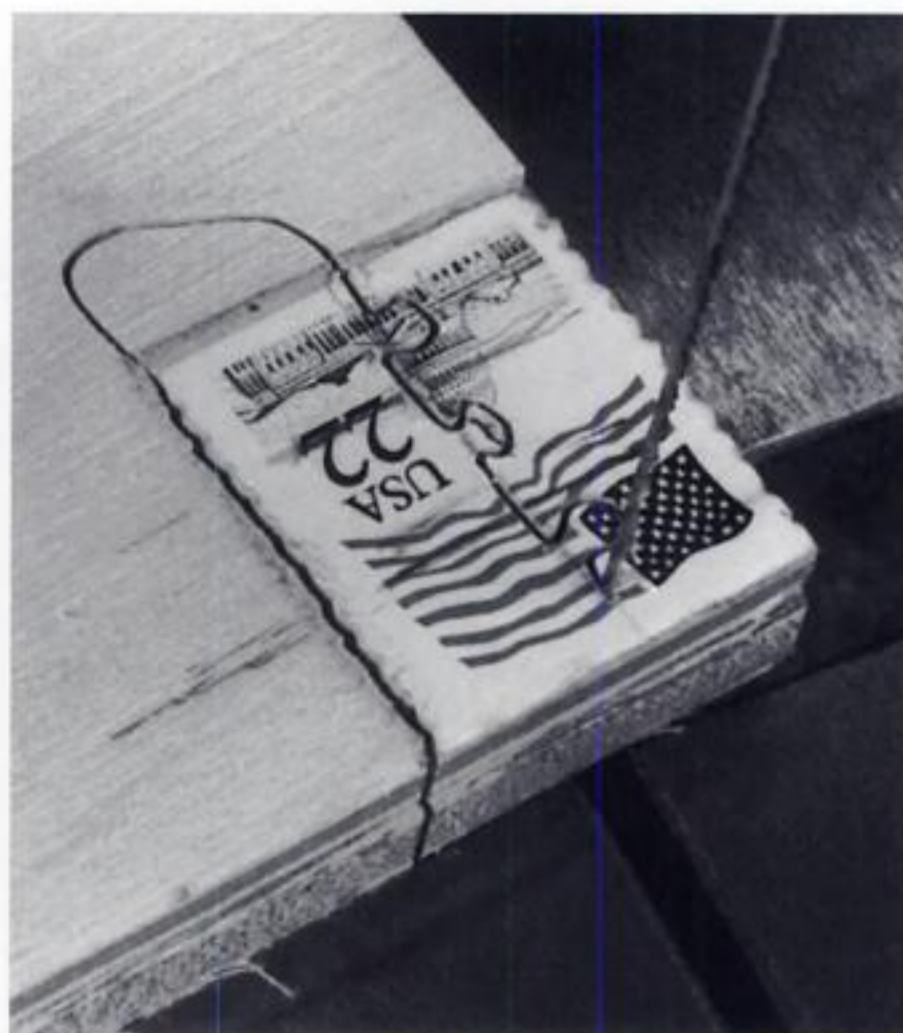
Abbildung 260 Sägen Sie entlang dem zweiten perforierten Rand, gehen Sie dann zurück, indem Sie senkrecht durch die Mitte der Briefmarke sägen.
