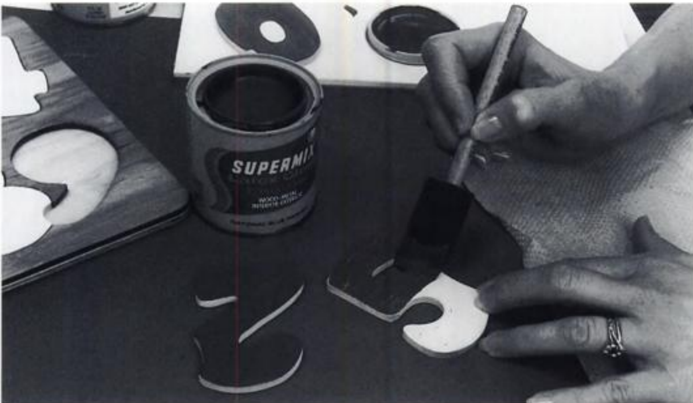
Abbildung 290 Mit einem Schwammtupfer können Sie verschiedene Farben schnell und sehr sauber auftragen.
