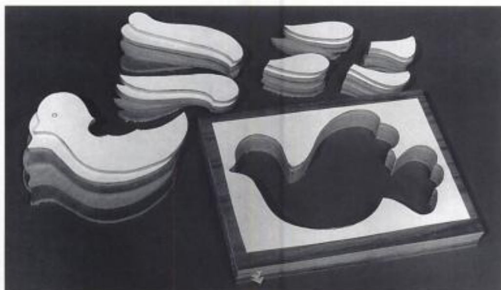
Abbildung 86 Damit eine gewerbsmäßige Puzzleherstellung rentabel wird, müssen Sie Stapelschnitte ausführen können.
