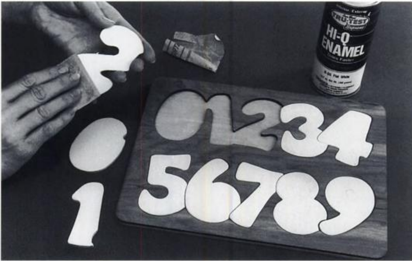
Abbildung 289 Sie erzielen eine besonders glatte Oberfläche durch leichtes Schleifen mit feinkörnigem Sandpapier nach der Grundierung und zwischen dem Aufbringen der einzelnen Lackschichten. Das nimmt natürlich etwas Zeit in Anspruch.
