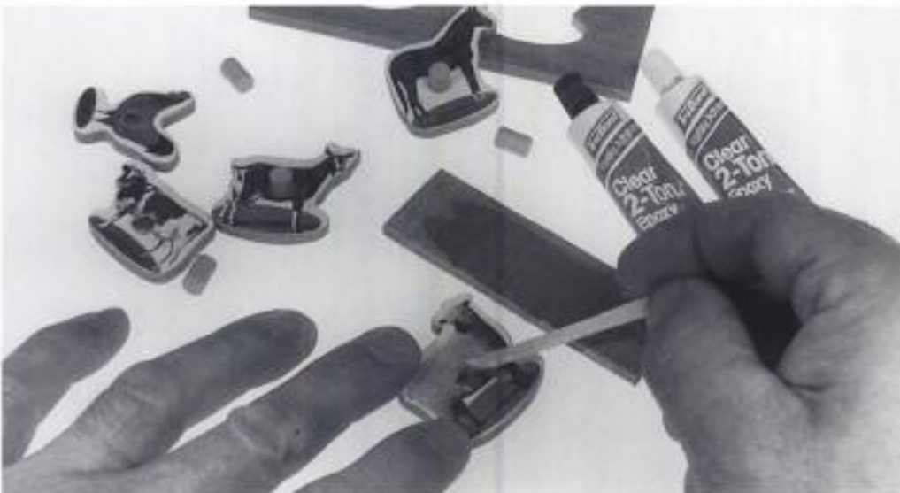
Abbildung 75 Epoxidharz (Zweikomponentenkleber) ist der stärkste Kleber, den Sie für das Befestigen der kurzen Dübel in den Bohrlöchern verwenden können.
