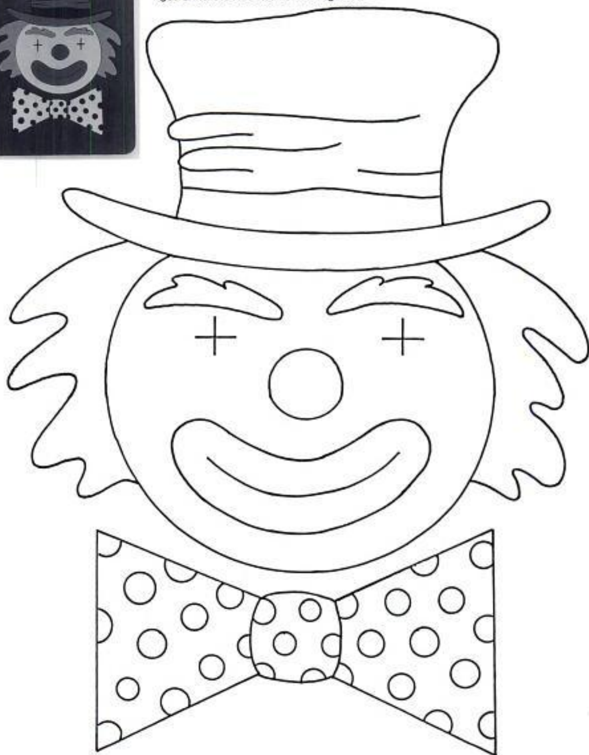
Abbildung 187 Das Clownsgesichtspuzzle wird aus einer Nußbaum-Furnierplatte gemacht. Der Hut besteht aus zwei Teilen. Das ganze Puzzle besitzt 10 Teile, diese Zahl können Sie aber leicht erhöhen. Die Lippen werden einfach durch einen Sägeschnitt getrennt. Die Hutfalten sind aufgemalt.
