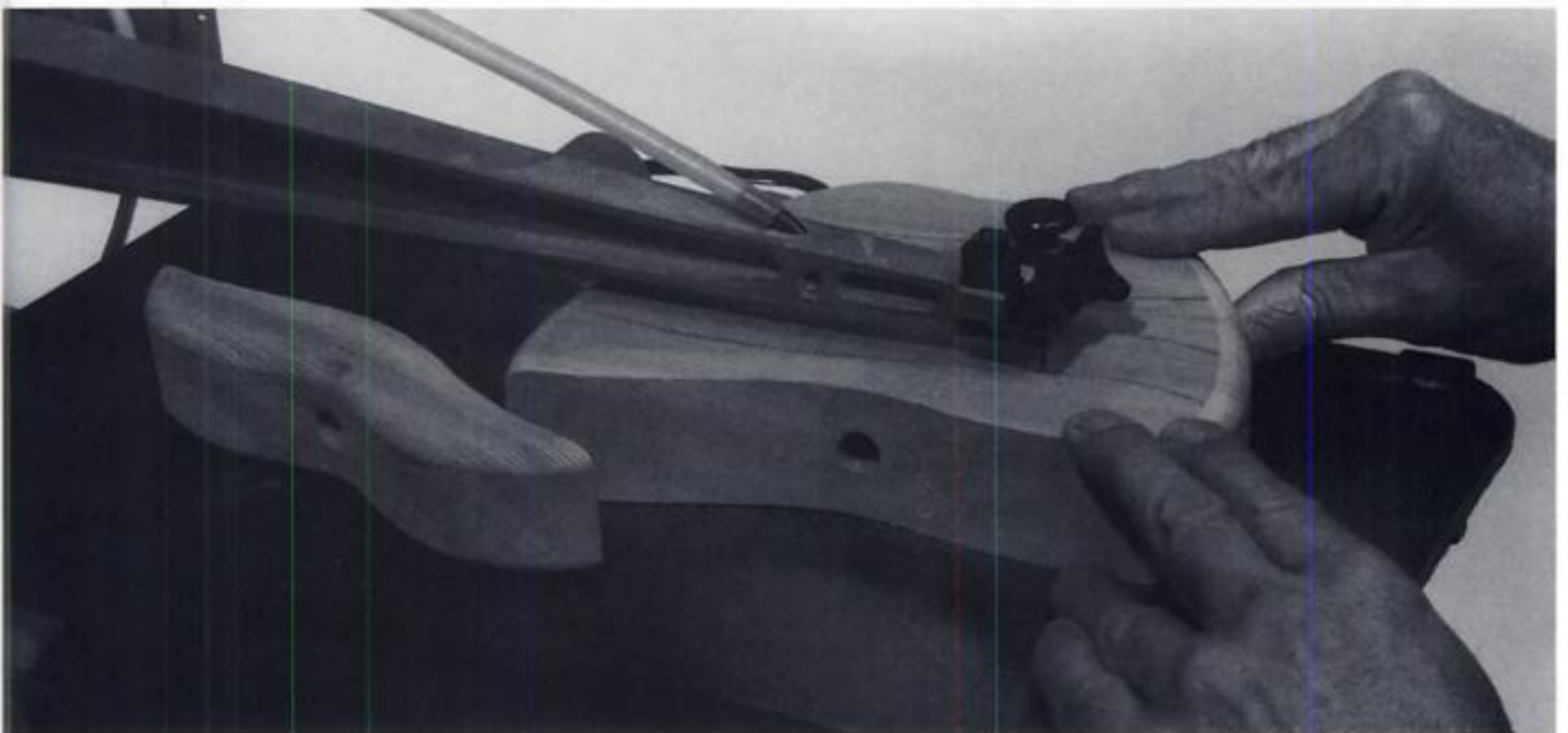
Abbildung 154 Bohren Sie das vertikale Loch, bevor Sie die Form in Einzelteile zersägen. Hier sehen Sie das Apfelpuzzle mit einer Bohrung von 13 mm Durchmesser. Das Apfel- und das Birnenpuzzle werden aus einem 45 mm starkem Brett gesägt und ihre Kanten mit einer Oberfräse gerundet. Bei beiden werden Dübelhölzer mit 12 mm Durchmesser verwendet.
