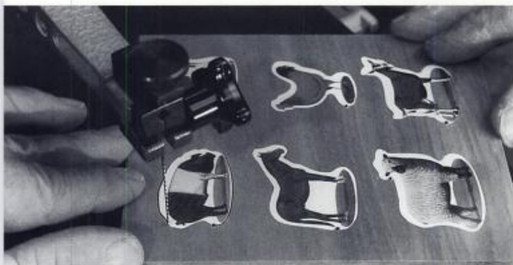
Abbildung 71 Hier sehen Sie, wie man rund um die Aufkleber herumsägt. Dieser Sägeschnitt wurde an einem kleinen Einfädelloch begonnen.
