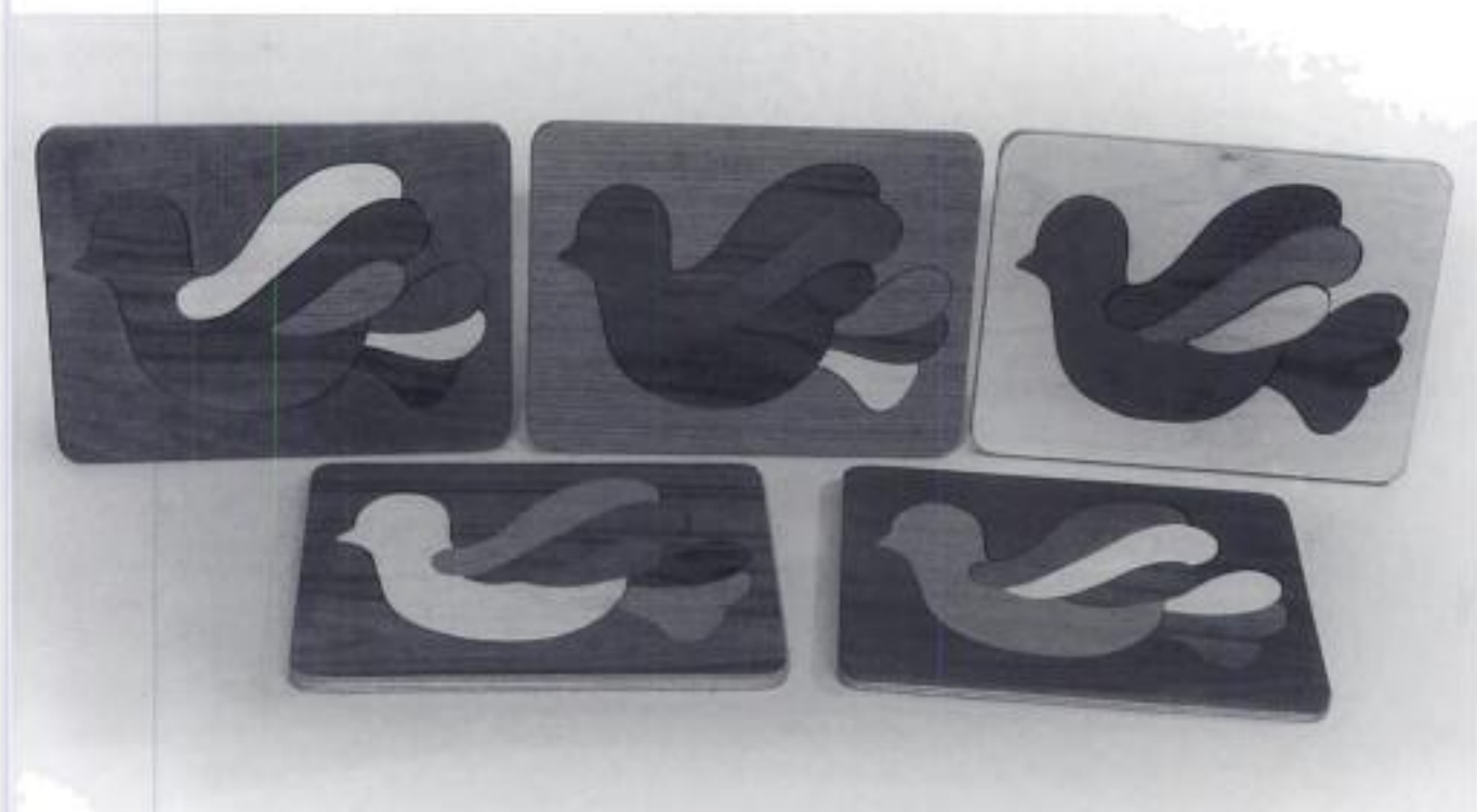
Abbildung 88 Die Teile dieser fünf Puzzles wurden alle zur gleichen Zeit im Stapel gesägt. Bei dieser Methode können Sie die aus verschiedenen Hölzern gesägten Teile untereinander austauschen.
