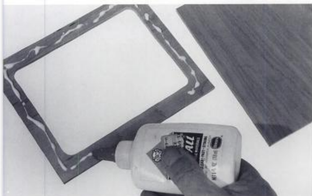
Abbildung 52 Hier sehen Sie, wie Leim auf die Rückseite der obersten Lage (dem Puzzlerahmen) aufge- bracht wird.
