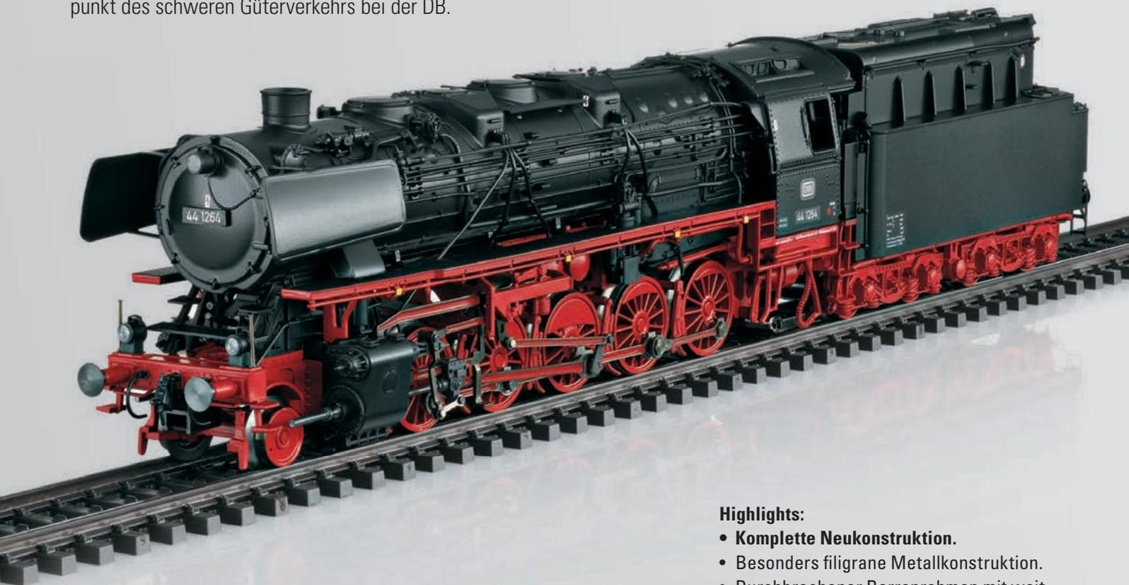
**Vorbild:** Schwere Güterzug-Dampflokomotive Baureihe 44, mit Öl-Tender der Grundform 2'2'T34 der Deutschen Bundesbahn (DB). Schwarz/rote Grundfarbgebung. ÜK-Führerhaus mit nur einem seitlichen Fenster, mit Witte-Windleitblechen der Regelausführung, Vorlauf-Radsatz mit Vollrädern, ohne Rauchkammer-Zentralverschluss, mit Indusi-Magnet einseitig. Lok-Betriebsnummer 44 1264. Betriebszustand um 1962/63.
