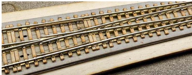
Die Gussteile der Gleise und Weichen werden in gelaserte Kartonschablonen eingelegt. Die Schwellen sind einzeln gelasert.
