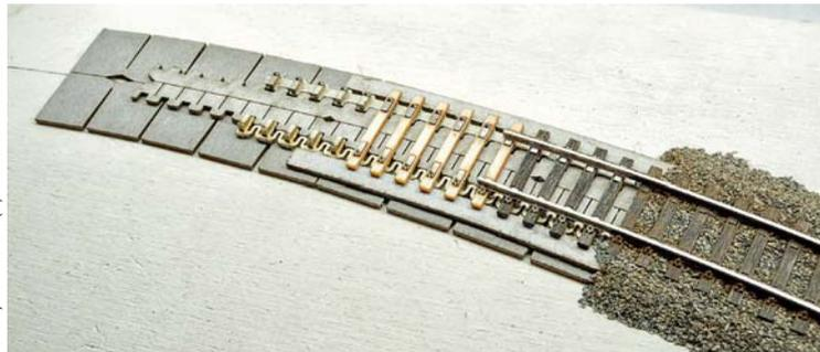
Die Bauschritte in Kürze: Anlegen der Gussteile an die Schablonen, Aufsetzen der Holzschwellen, Verlöten der Schienenprofile, Einschottern.
