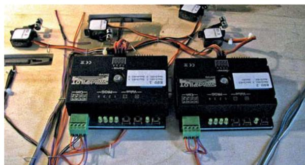
Die ESU-Decoder steuern mehrere Servos für die Entkupp-
