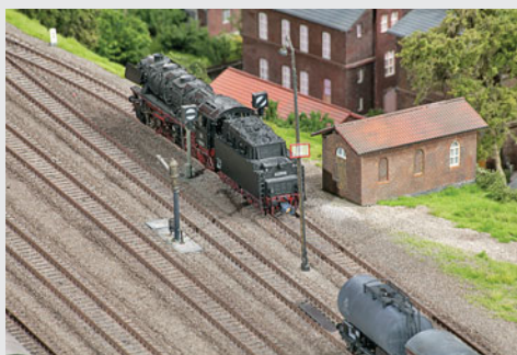
Das Signal zeigt Sh 1, die Lok fährt bis ungefähr Punkt 9 und über die gestellten Weichen zurück an den Zug auf Gleis 53.
