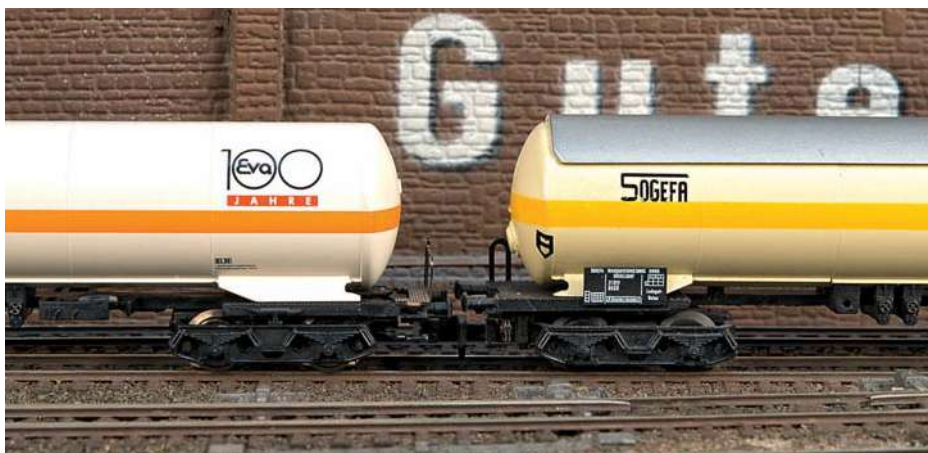
Das Arnold-Modell wurde 1984 erstmals vorgestellt. Rechts ist eine frühe Ausführung noch ohne Kurzkupplung und mit deutlich zu hoch liegenden Puffern zu sehen.
