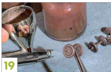
19 Kleine Gummiringe dienen dazu, die Laufflächen der Räder beim Lackieren vor Farbe zu schützen.
