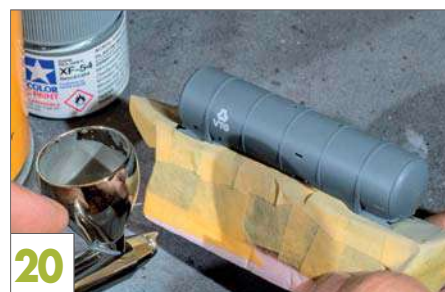
20 Nach dem Abkleben des Fahrgestells wird der Kessel mit sehr stark verdünnter hellgrauer Farbe eingenebelt.
