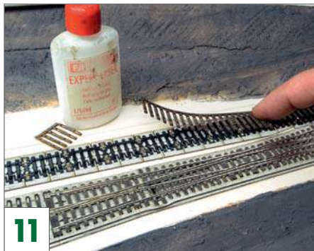
11 Nun können dort die aus Lindenholz gelaserten Schwellenbänder aufgesetzt werden. Die Bänder beschleunigen den Bau.
