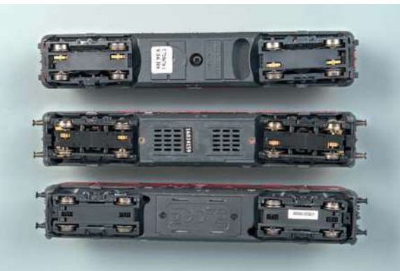
Bei Minitrix (Mitte) und Piko (unten) sitzen die Lautsprecher in der Bodenwanne.
