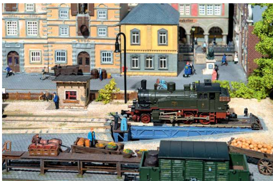
Mit Hilfe von Segmentdrehseiben lässt sich im kleinen Hafen sehr gut Platz sparen. Das Modell mit Servoantrieb entstand in Handarbeit aus dem, was die Bastelkiste hergab.
