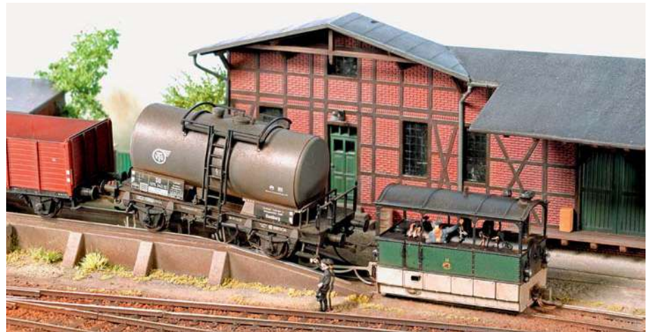
Langsam wird der Kesselwagen über einen Zwischenwagen über den ersten Rollbock geschoben. Der Rollbock unter der ersten Achse des Kesselwagens nimmt alle weiteren Rollböcke mit. Durch einen feststehenden Entkupplungsblock entkuppelt dieser exakt an der Stelle, an welcher der nächste Rollbock die zweite Kesselwagenachse aufnimmt.
