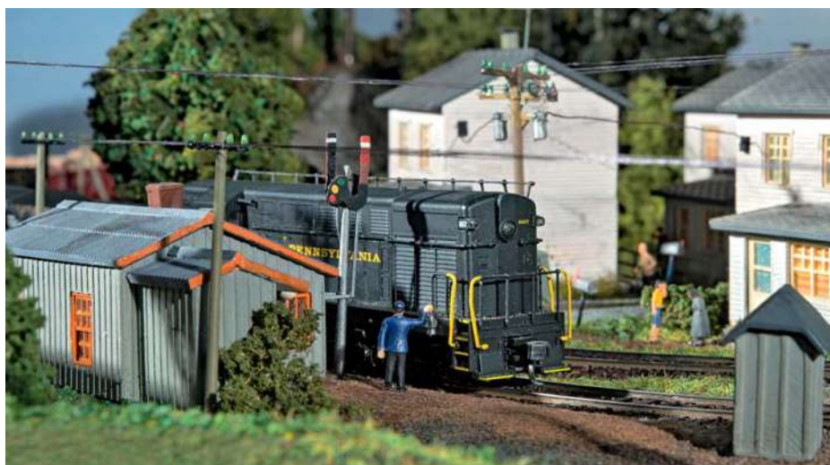
Ein Hingucker ist das selbst gebaute Trainorder-Signal, mit dem das Vorhandensein von Fahrbefehlen angezeigt wird. Laut Signalstellung liegt gerade kein besonderer Befehl vor.
