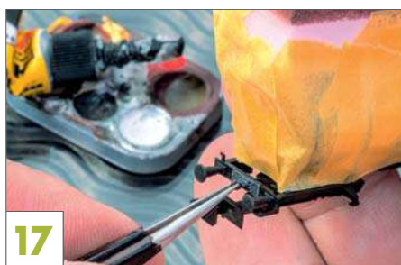
17 Die Aussparung im Pufferträger lässt sich mit einem 3D-gedruckten Teil füllen, will man den Wagen als Schlussläufer einsetzen.
