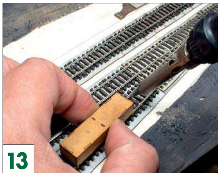
13 Beide Schienenprofile werden mit der Schienenlehre festgehalten und wechselseitig verlötet.
