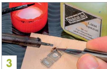
3 Das knifflige Verlöten der fünf Querträger an der Arbeitsbühne gelingt mit Lötöl und sehr wenig Lot.
