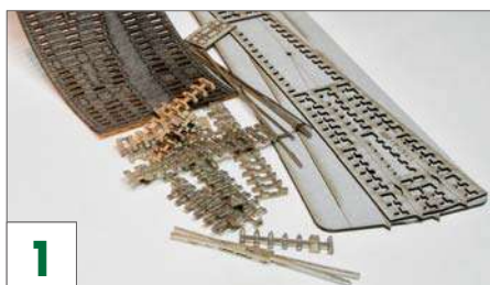
1 Der Bausatzinhalt für eine N40-K-Weiche: Gelaserte Schwellen und Schablonen, Kleisen und Herzstück als gegossene Teile.
