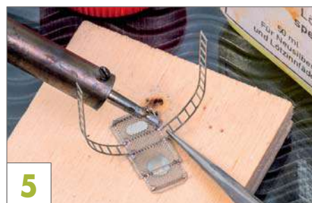
5 Auch um die vorgebogenen Leitern an der Arbeitsbühne zu fixieren, wird nur sehr wenig Lot benötigt.
