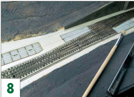
8 Zuerst werden die Weichen verlegt, dann die Gleis-Unterlagen. So entsteht für die Schwellenrost-Verlegung eine feine Mittellinie.
