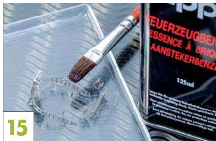
15 Vor dem Lackieren müssen alle Verschmutzungen an den fertig verlöteten Zurüstteilen entfernt werden.
