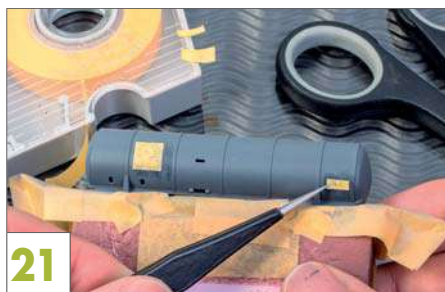
21 Mit etwas Cleaner werden die Anschriften zunächst gesäubert und dann vor dem zweiten Lackauftrag mit Maskierband abgedeckt.
