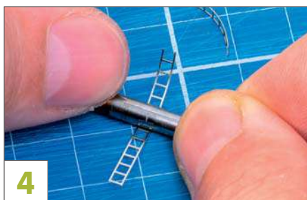
4 Ein 6-mm-Bohrer auf einer weichen Unterlage hilft, die Leitern an die Rundung des Kessels anzupassen.
