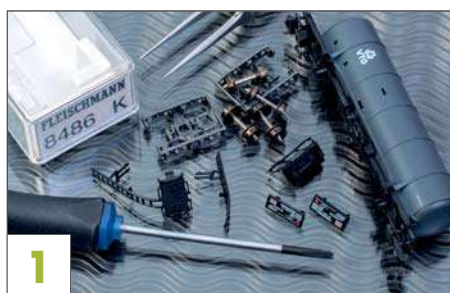
1 Zunächst wird der Wagen weitgehend zerlegt. Der nur schwer lösbare Langträger verbleibt samt Kulisse und Kupplung am Kessel.
