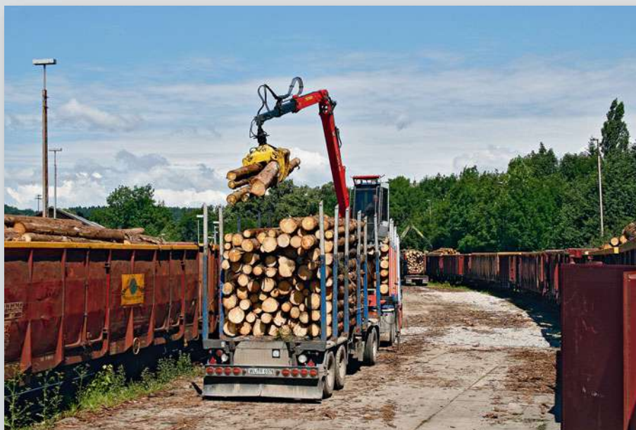
Die Greifarme an den heutigen Holztransportern machen Handarbeit und Umladekran am Ladegleis überflüssig. Foto: Carsten Petersen
