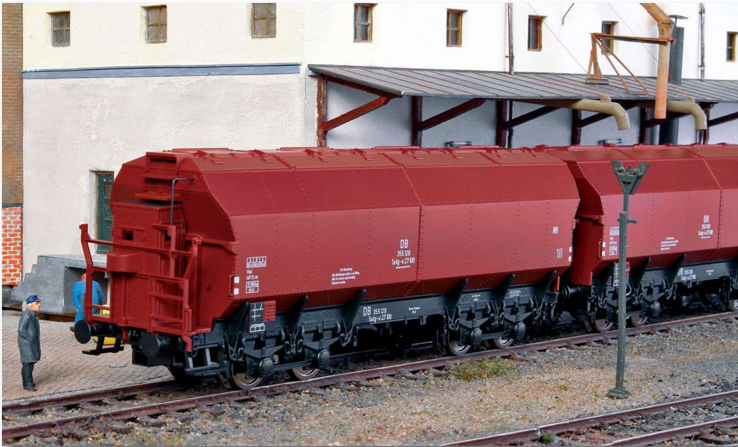
Für den Transport großer Getreidemengen entwickelte die DR den vierachsigen Behälterwagen Tdg-u-27 Kkt mit Klappdeckeln (H0-Modell von Fleischmann, jedoch in Epoche-III-Ausführung. H0-Anlage: Ton Janssen
