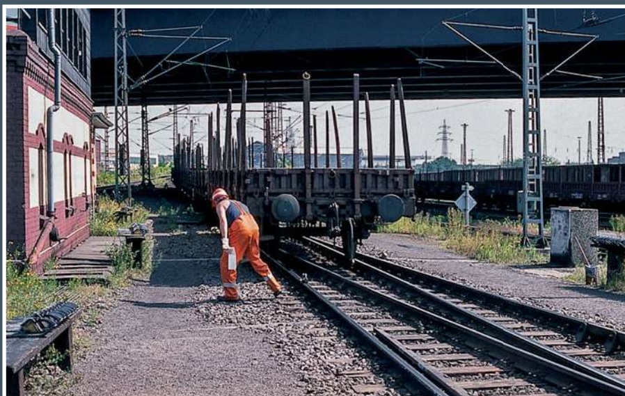
Soeben hat der Vorbremser seinen Hemmschuh gelegt. Unmittelbar danach heißt es, dem nahenden Wagen rasch auszuweichen. Foto: Volker Großkopf
