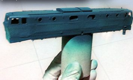
La mascheratura è completa e si procede con le prime passate di verde Pantone 329C
