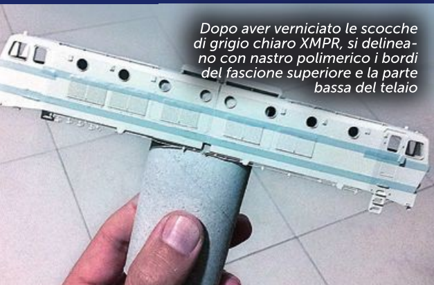
La mascheratura è completa e si procede con le prime passate di verde Pantone 329C
