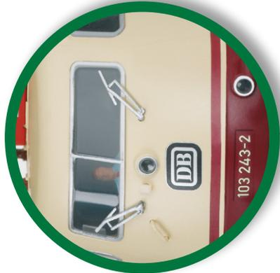
Front: Dreilicht-Spitzensignal, ange-setzte Scheibenwischer, im Führerstand bewegliche, digital schaltbare Lokführerfigur.
