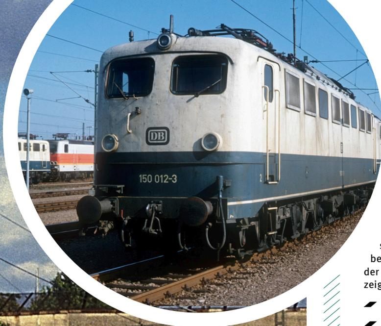
Führerstand 2: die Front der 150 012-3 in Mannheim mit den beiden Einfachlampen.
