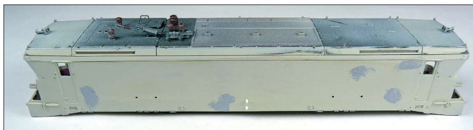
4 - Les trous de fixation du blason sont bouchés et les parois latérales sont retouchées avec du mastic, pour être parfaitement lisses.
