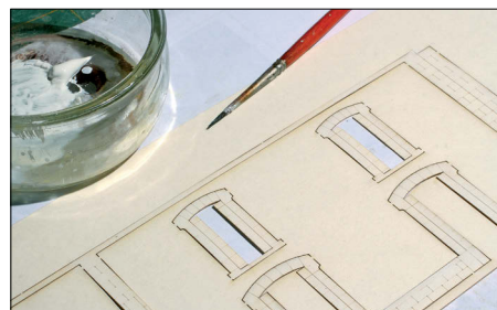
5-Les parements en pierre sont passés au blanc peu dilué.
