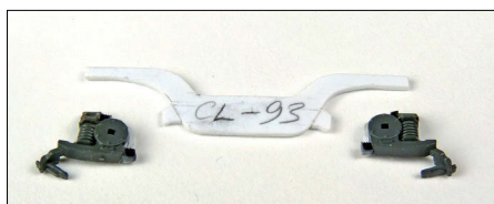
13 - Boîtes d'essieux et blocs « sandwich » sont récupérées du bogie d'origine, suspension primaire est en carte plastique.
