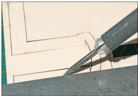
6-Les pliages sont validés au moyen d'un passage pas trop appuyé d'une pointe sèche.
