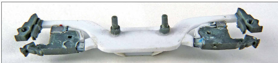
15 - Les tenons de fixation sont récupérés des flancs LSM et collés à l'arrière du nouveau flanc de bogie.
