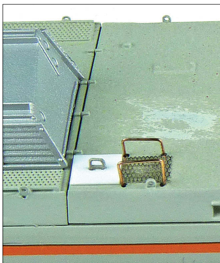
11 - Une nouvelle trappe prend place sur le toit avec un caillebotis en regard.
