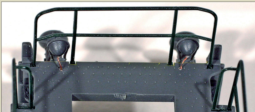
9-Feux de signalisation LS-Models + LED blanches CDF = feux fonctionnels.
