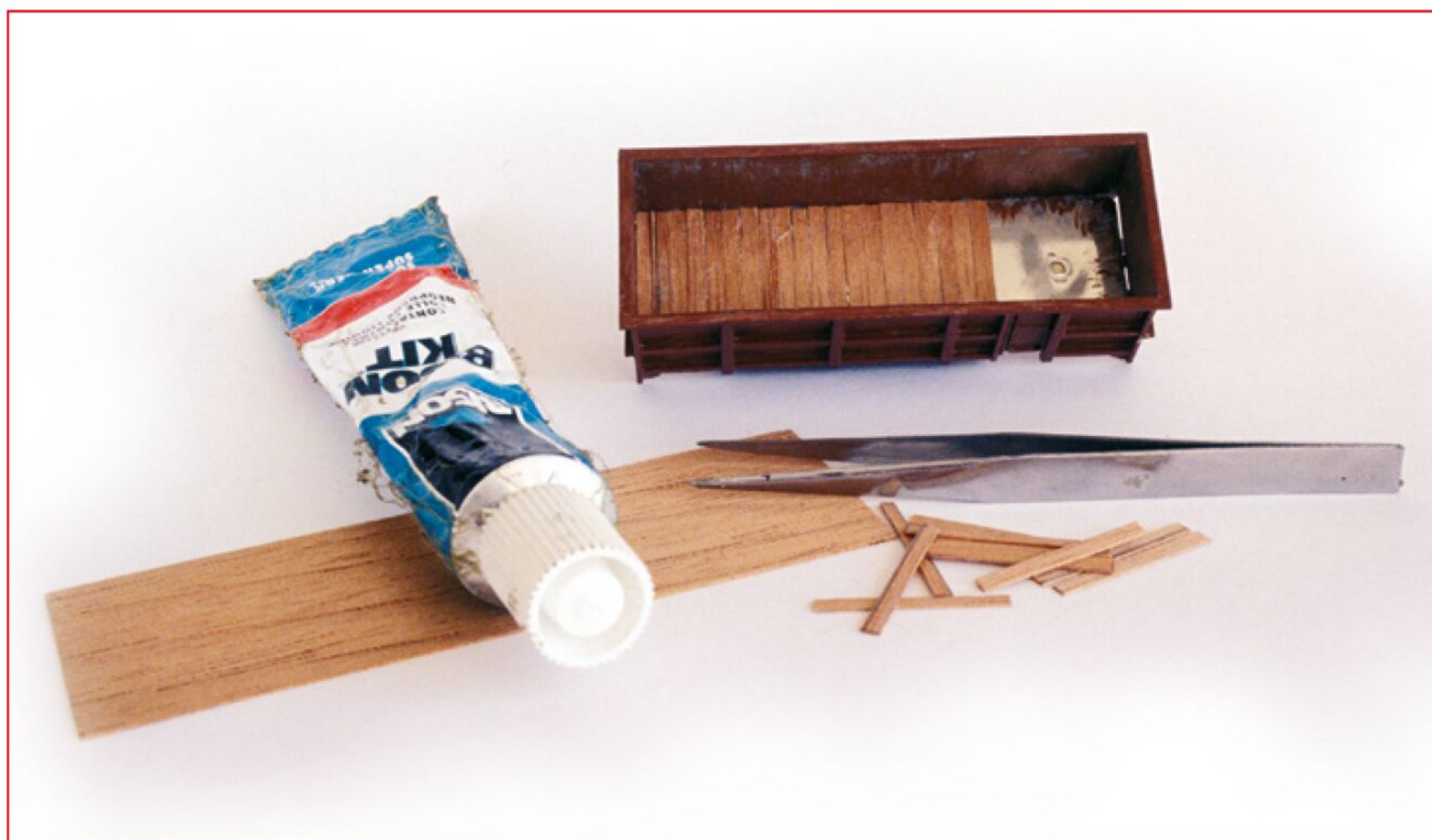
Het aanbrengen van de houten wagenvloer.
