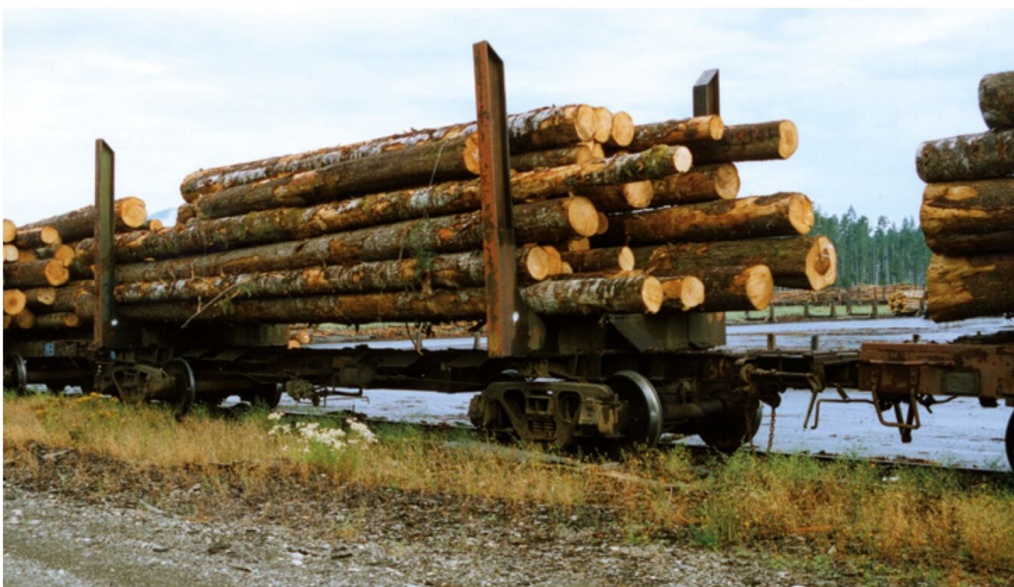
Een 'skeletoncar' voor boomstammen. Deze wagens zijn niet toegelaten op hoofdlijnen.
