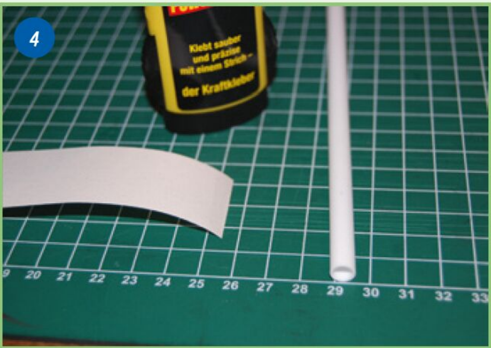
De basis van de coil is een polystyreen buisje.
