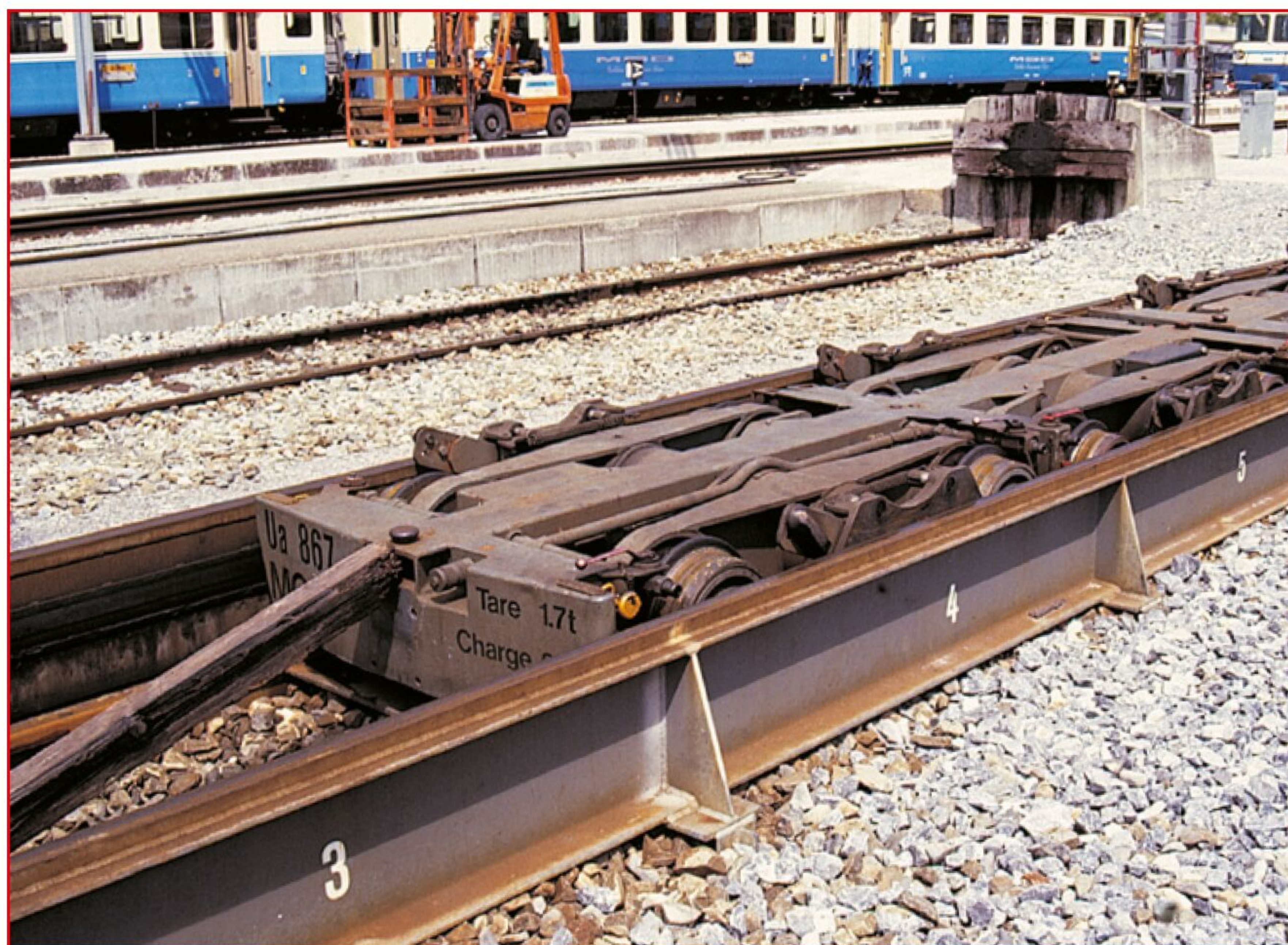
De voorste rolbok is voorzien van een koppelstang. Op de achtergrond de 'tuin' van de MOB in Zweisimmen, juni 2000.
