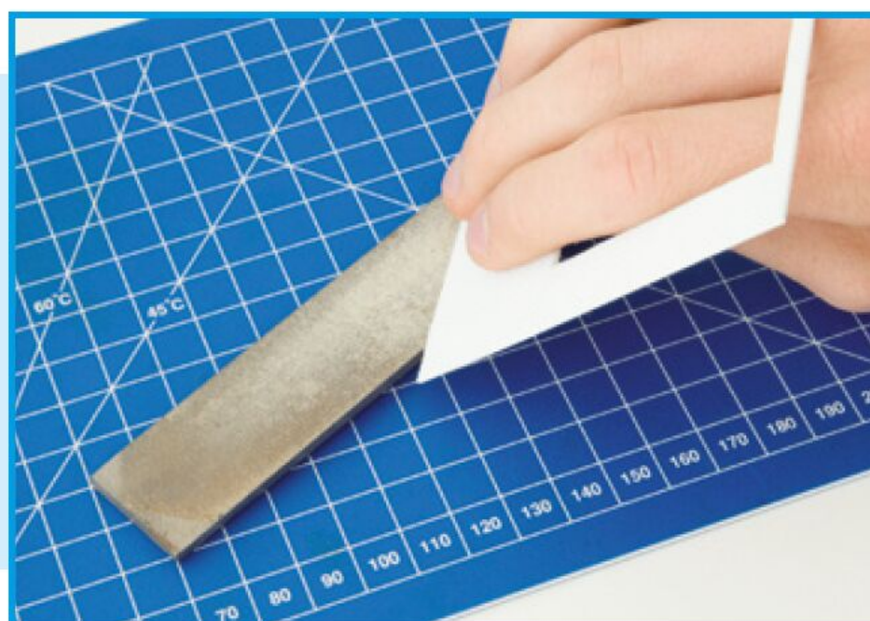
De kopse kanten van de muren worden schuin gemaakt door ze te schuren, zodat de muren straks in de hoeken netjes aan elkaar aansluiten.
