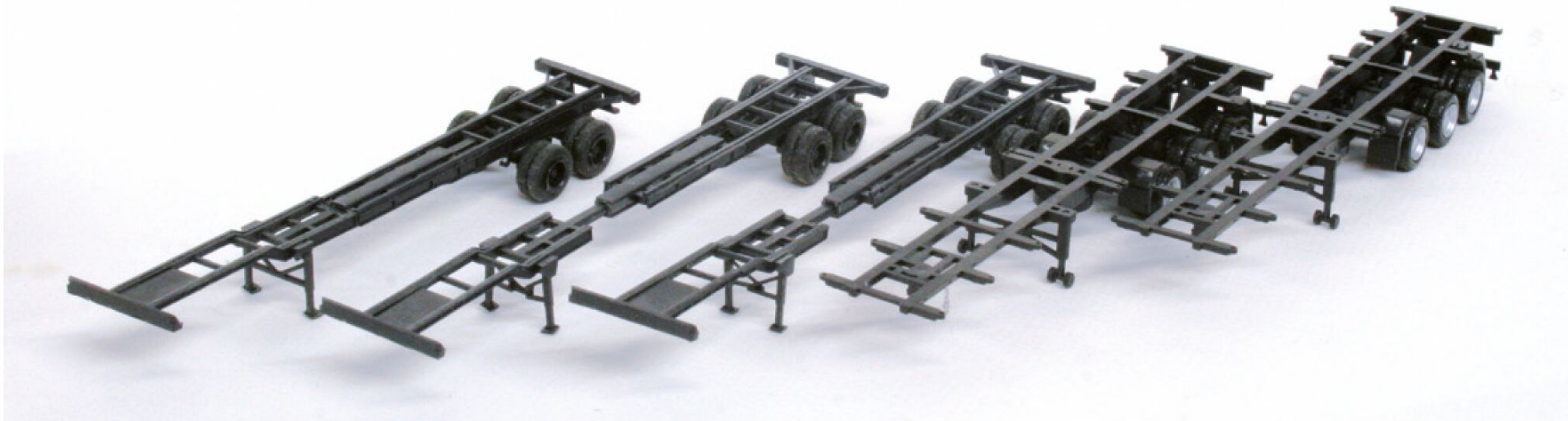
Diverse chassis voor het transport van containers. De tweeassige zijn uitschuifbare Amerikaanse chassis en worden hoofdzakelijk voor het interne vervoer gebruikt.
