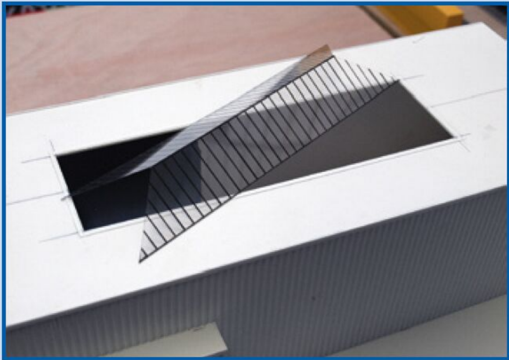
Na het uitsnijden is het daklicht op het dak gelegd om te zien of het past. Let op het randje van styreenstrips, dat is bedoeld om het daklicht vast te lijmen.
