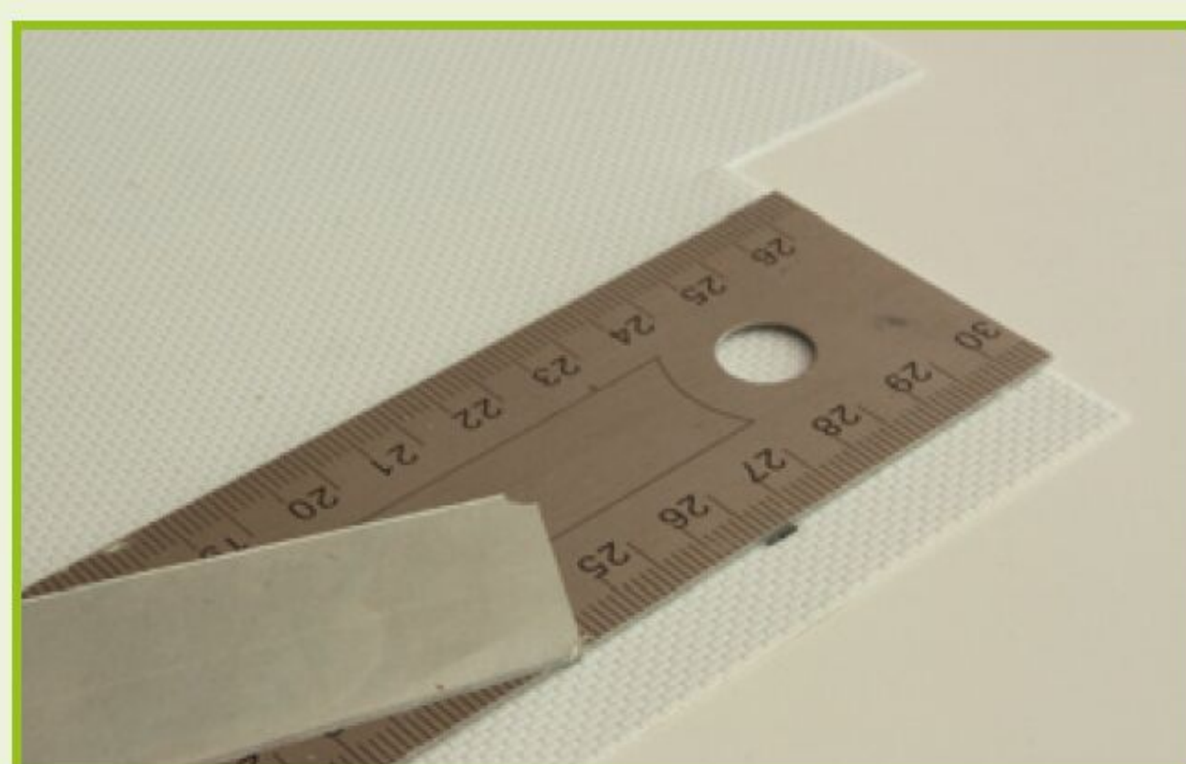
Snijd het stuk polystyreen af met behulp van een blokhaak en afbreekmes.
