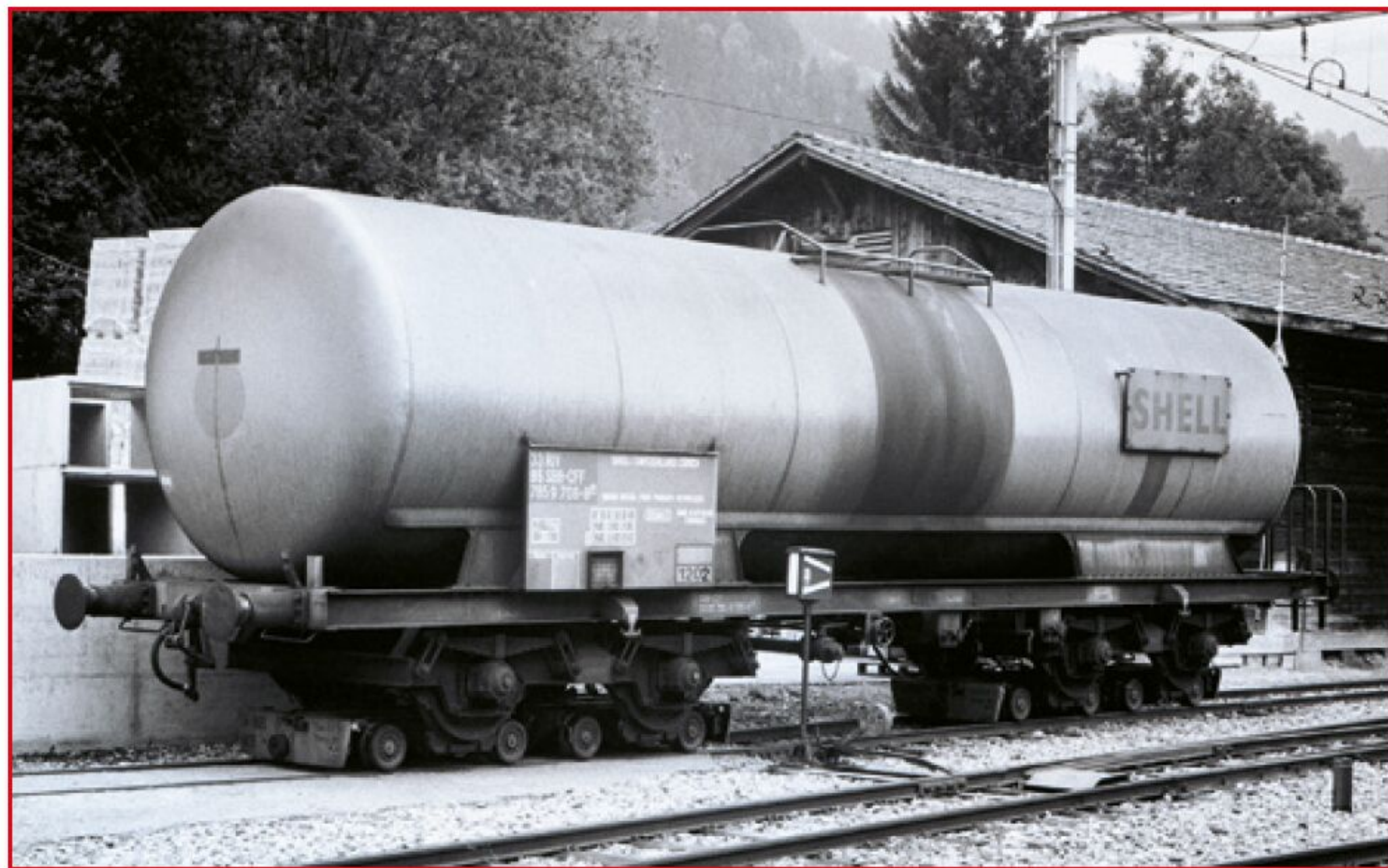
Voor de vierassige ketelwagen zijn vier rolbokken nodig. Station Lenk im Simmental (MOB), 1981. (foto Paul Kleyer)
