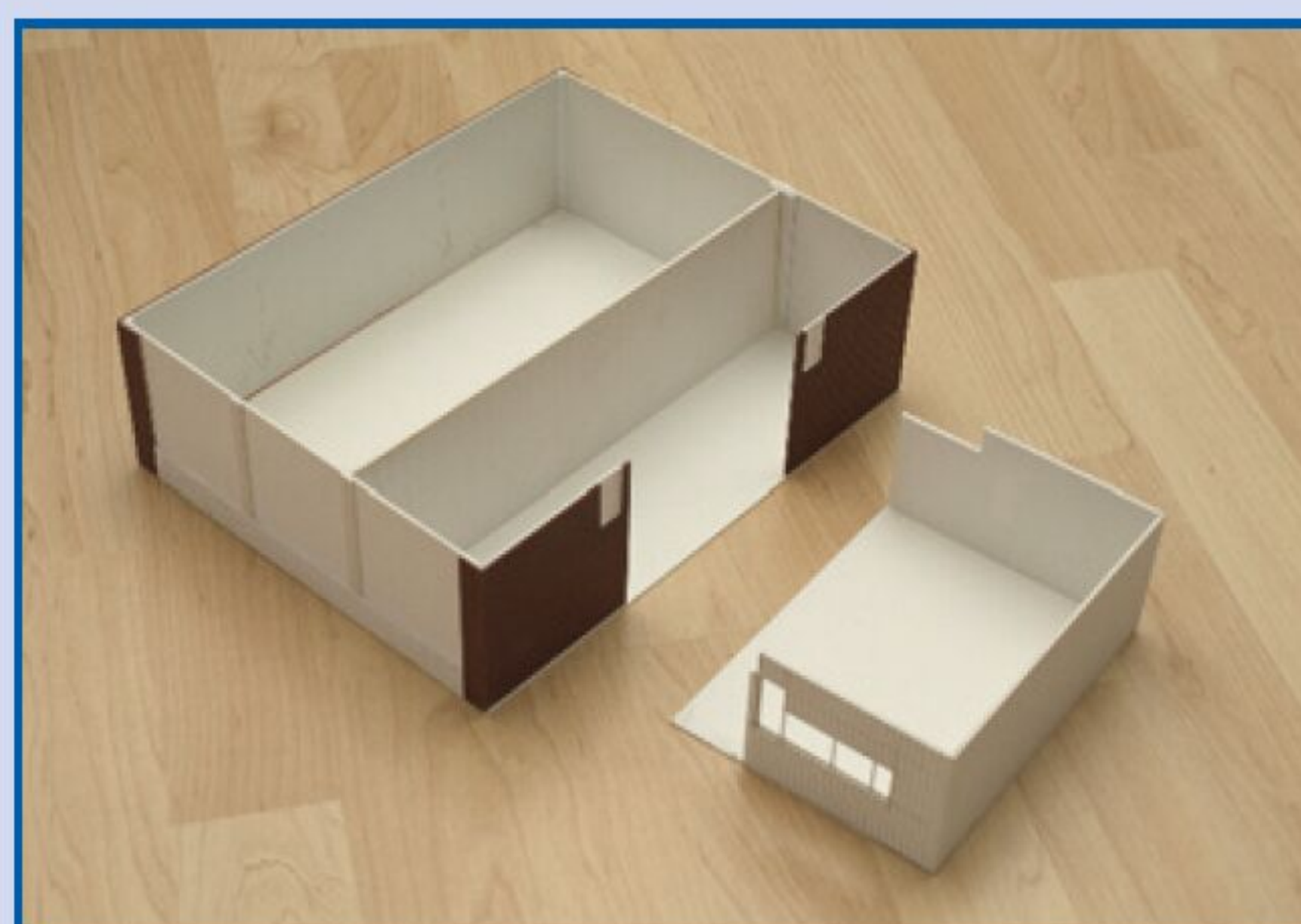
De eerste twee verdiepingen zijn 'op de kop' in elkaar gelijmd. Vervolgens zijn deze twee delen aan elkaar gemonteerd.
