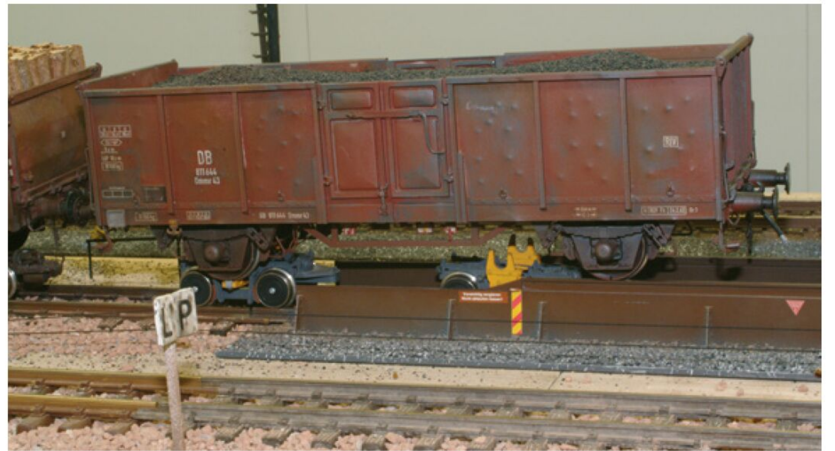
Afladen van opgebokt materieel. Van de kolenbak staat het eerste wielstel op de rolbokput. De loc drukt de trein langzaam verder de put op.
