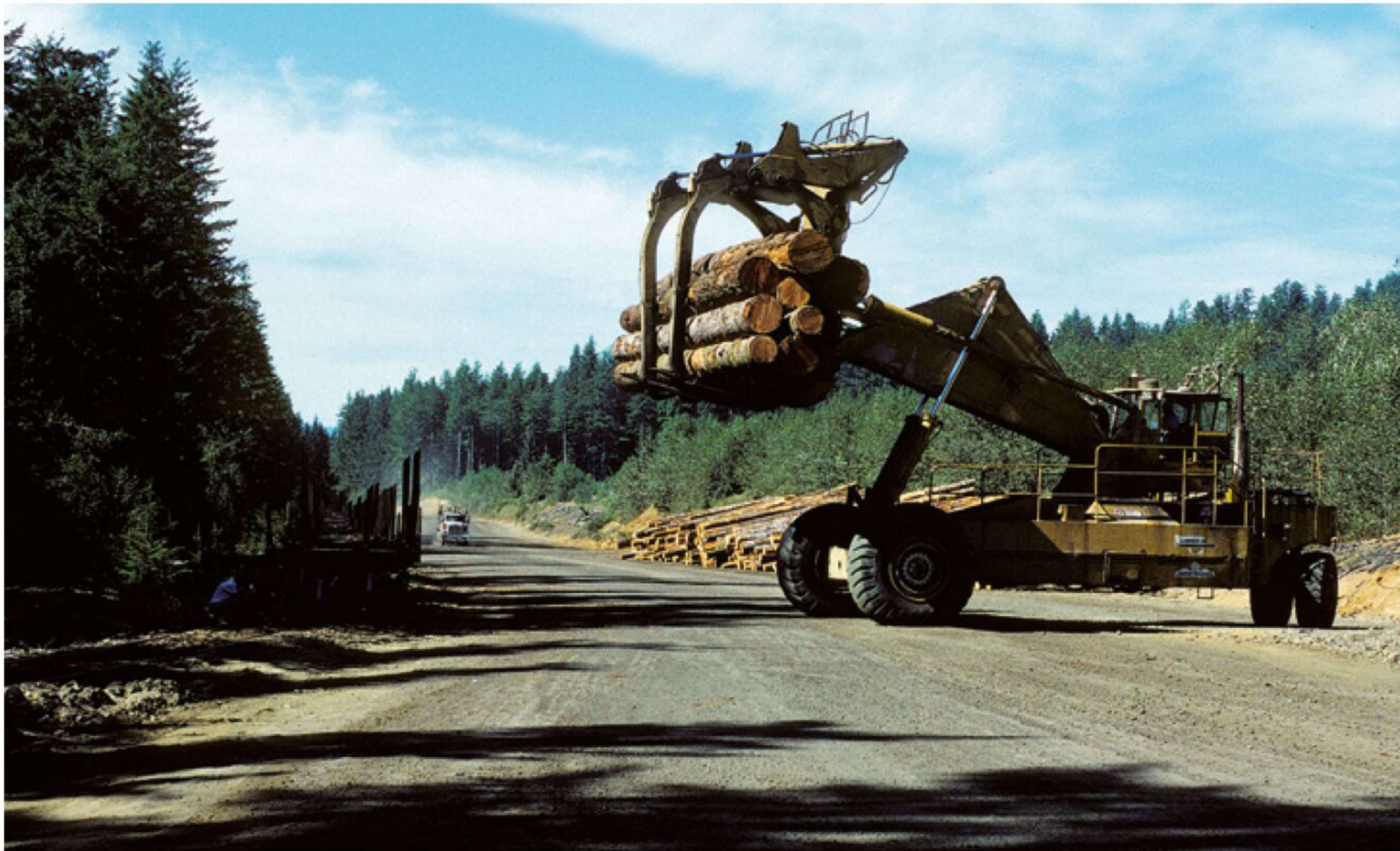
Met deze mobiele kraan worden boomstammen van de vrachtauto op de trein geladen.
