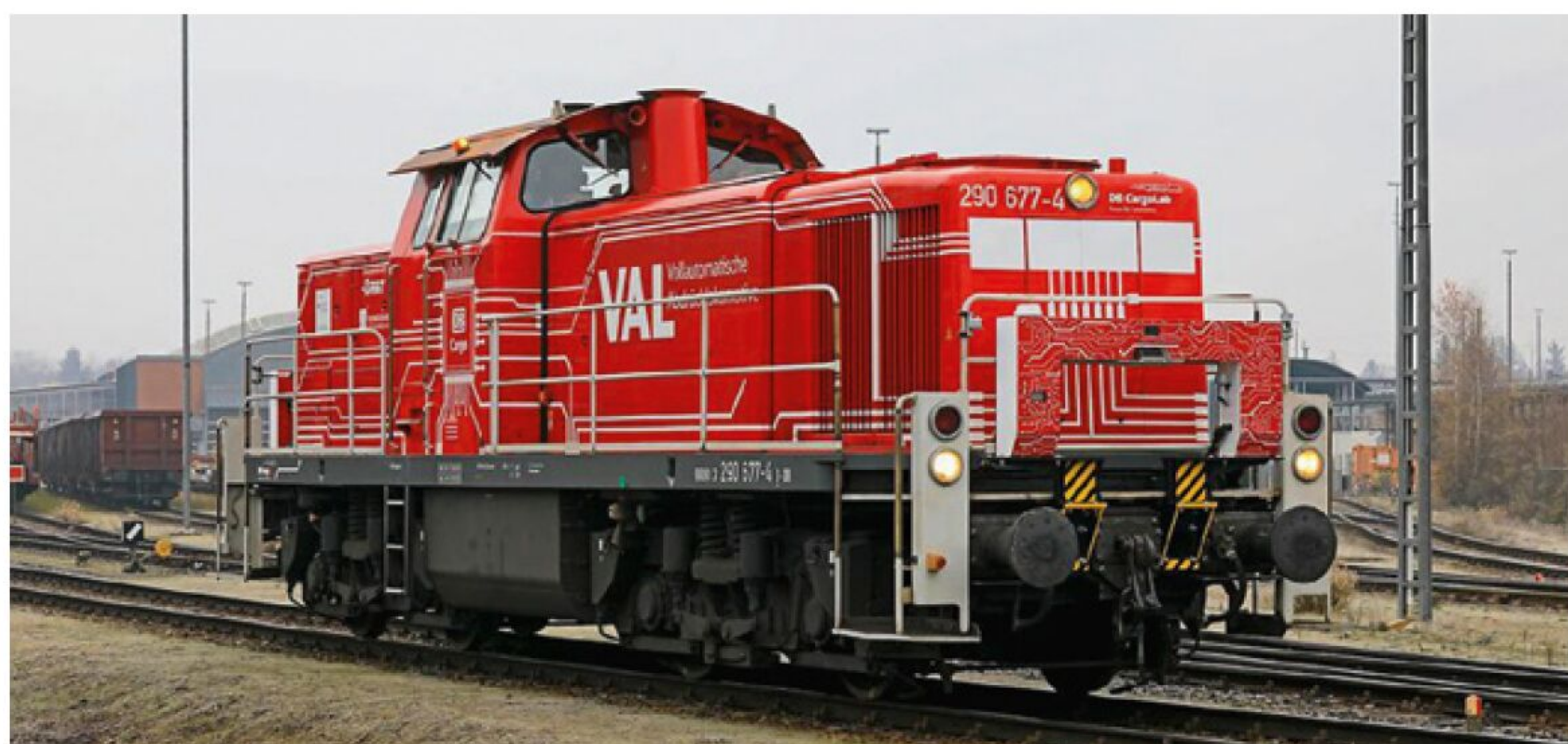
DB Cargo testloc 290 677 in München-Noord is een rijdend laboratorium voor het VAL-project. (foto DB Cargo)
