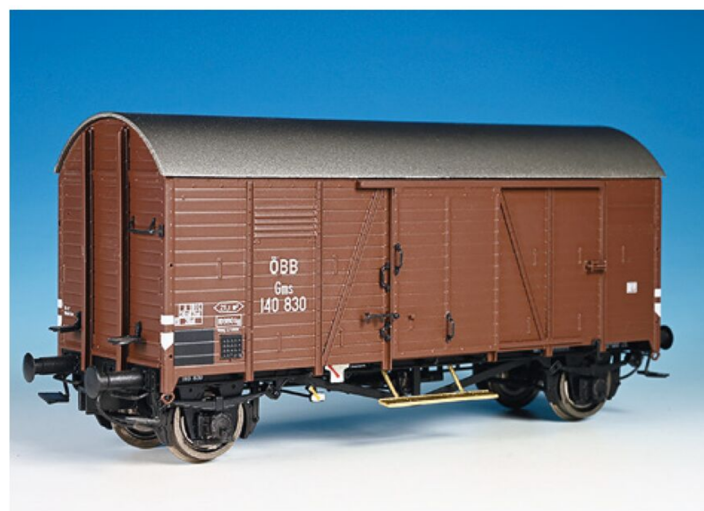
WAGENWERK: Gms met messing treeplanken.
