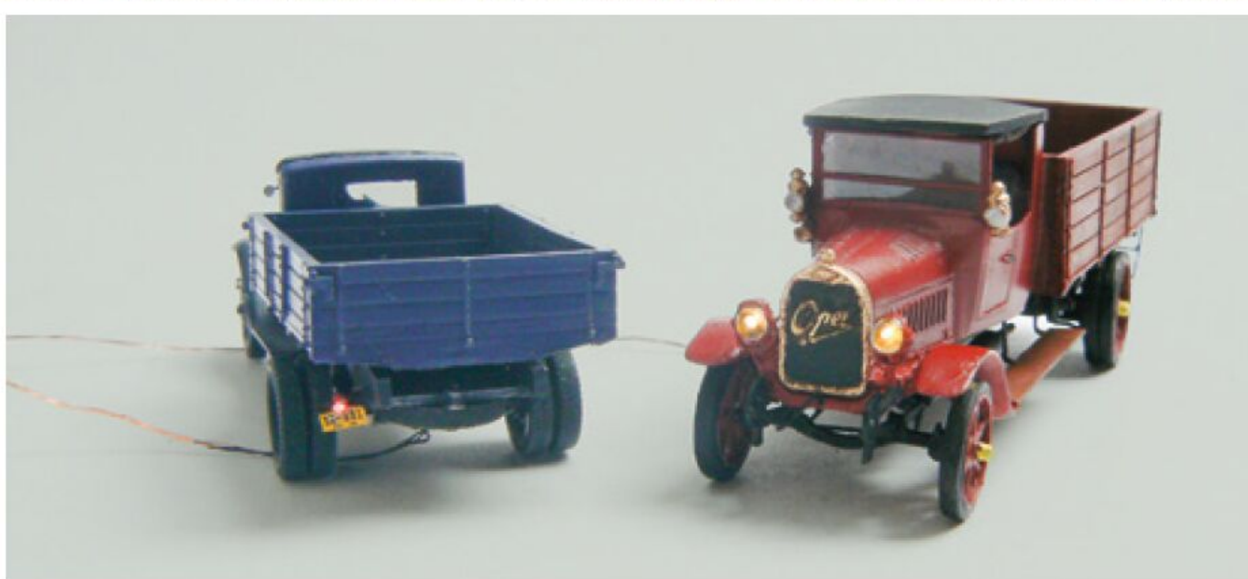
Techniek: Leds in auto's Smd-leds als kop- en achterlichten
