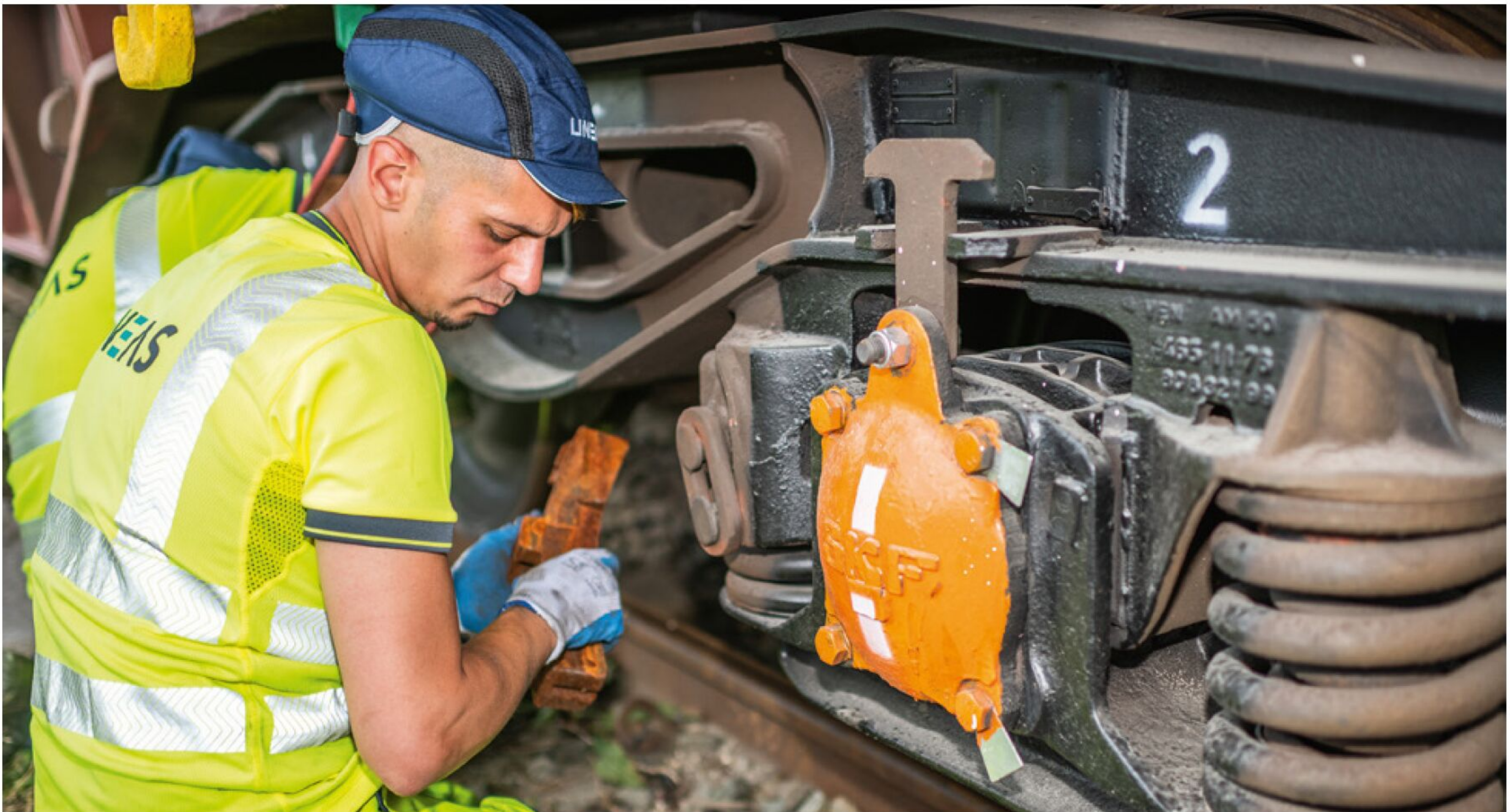
Medewerkers van Lineas monteren stille remmen in een goederenwagen. (foto Lineas)
