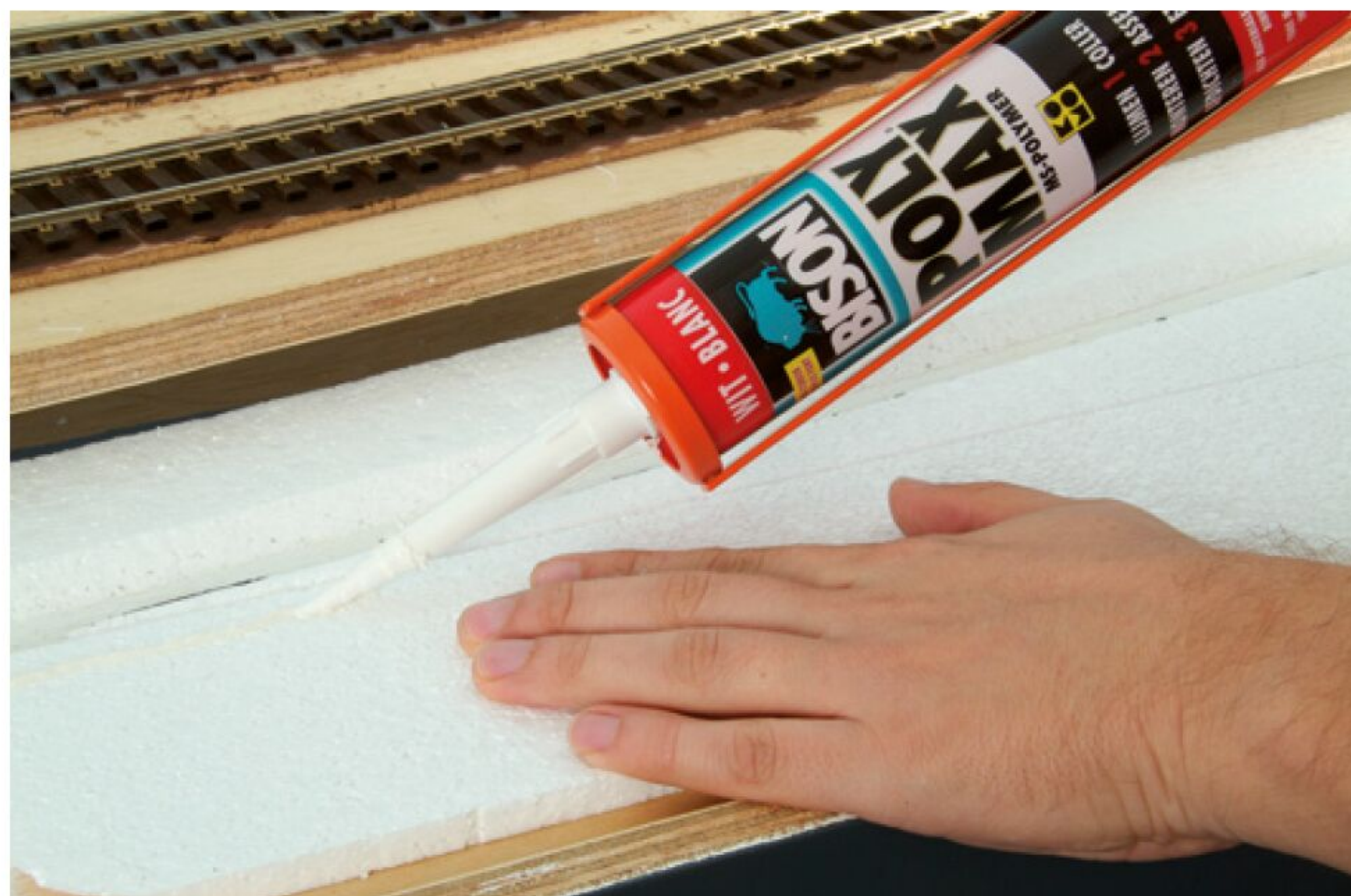
Piepschuim laat zich goed verlijmen met Poly-Max.
