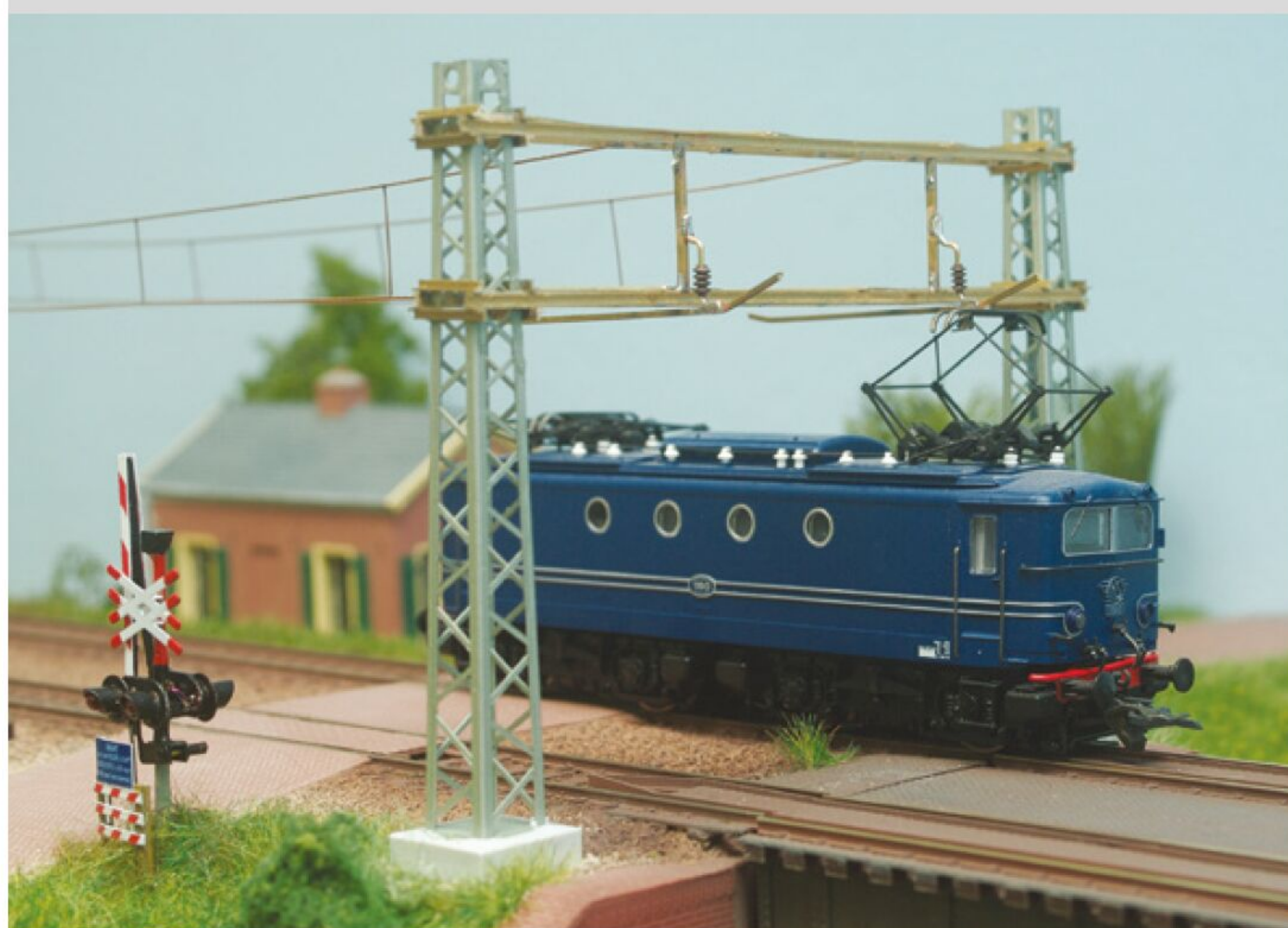
De eindportalen bestaan uit twee Sommerfeldt-masten met ertussen een zelfgebouwde dwarsverbinding.
