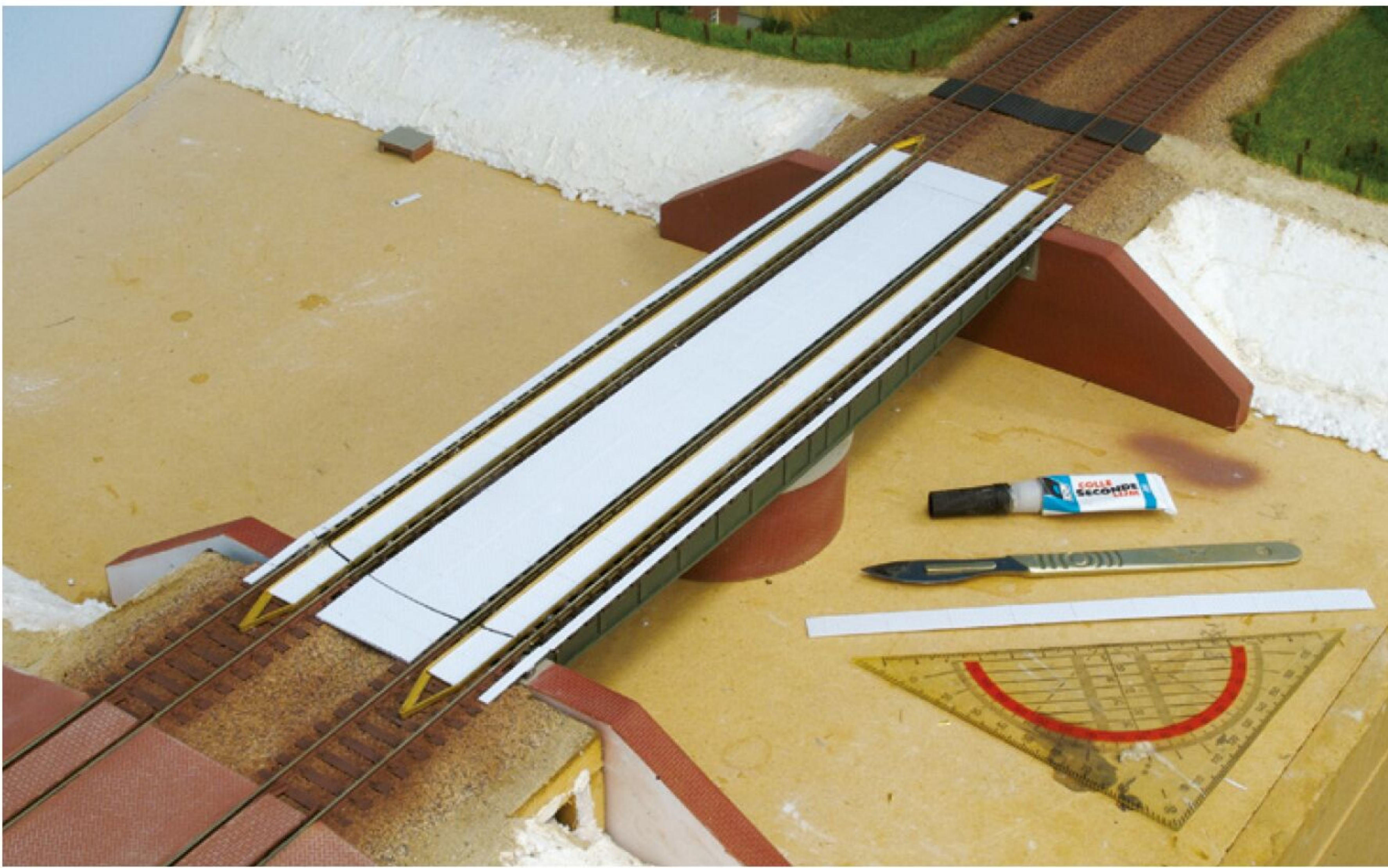
De geleidebalken en het brugdek worden aangebracht.
