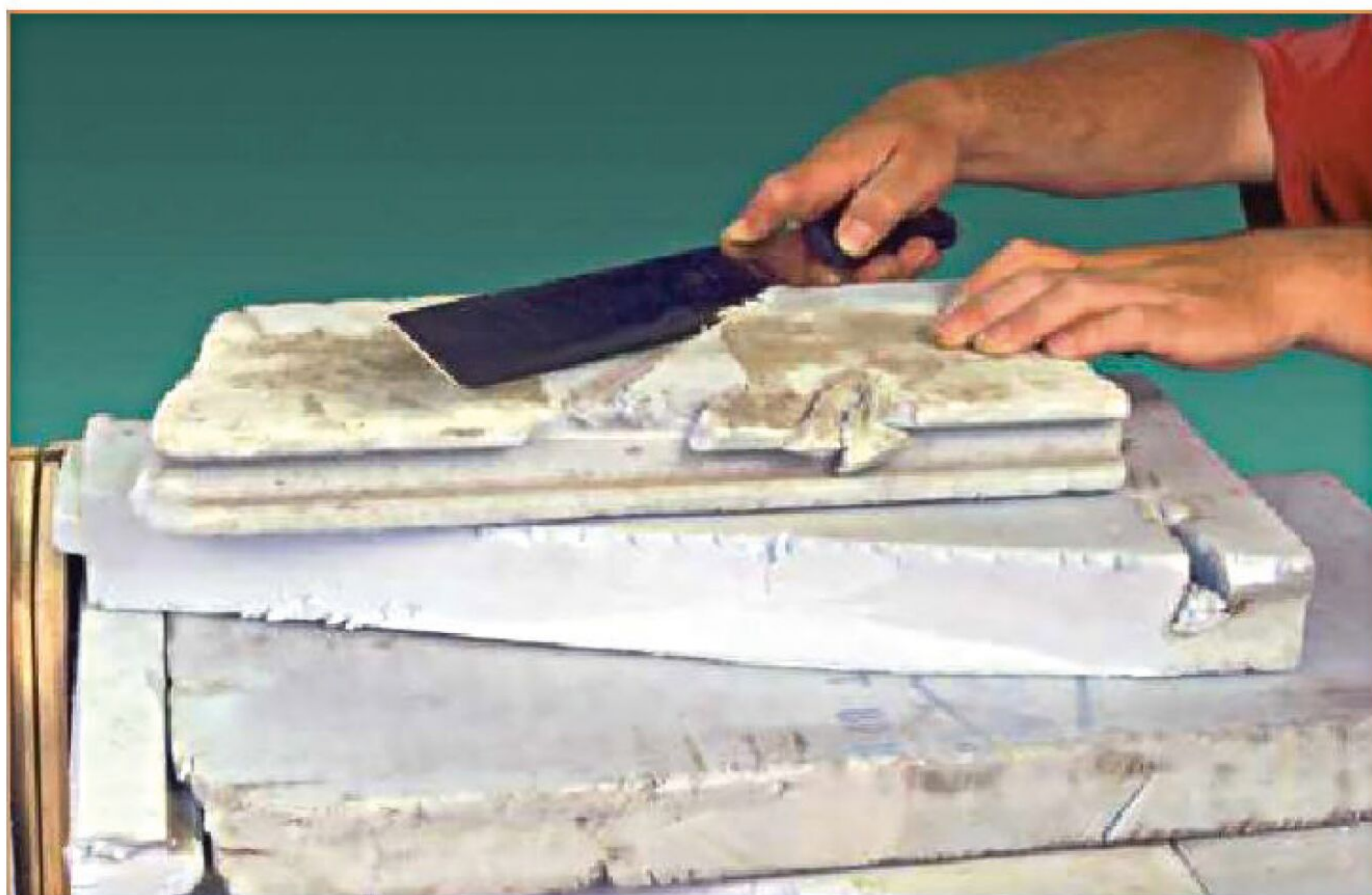
Met een mes of zaag wordt de helling verder gevormd.
