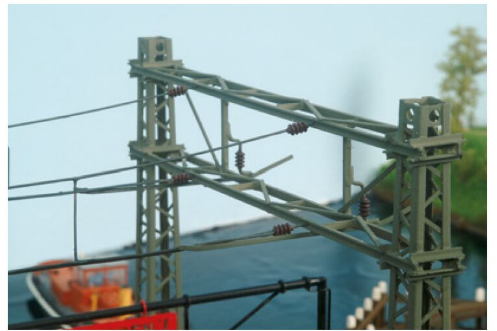
De draden van de bovenleiding zijn met isolatoren aan het portaal bevestigd.
