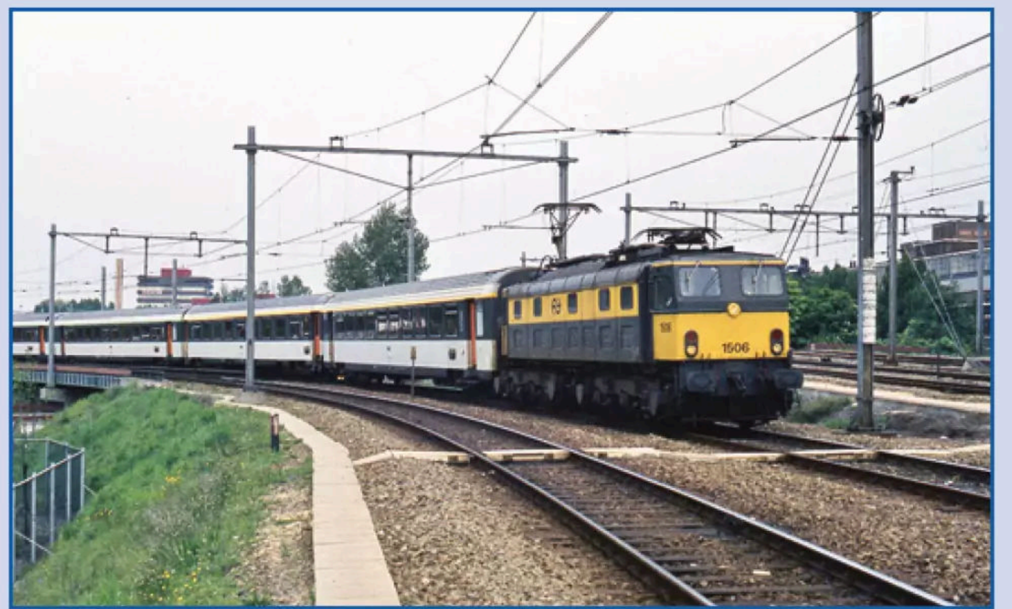
Behalve de Keulenaar reden de 1500'en onder meer ook de IC+ van Den Haag CS naar Heerlen. De 1506 in de verbindingsboog tussen Den Haag CS en Den Haag HS. Na een eerdere ontsporing mochten de 1500'en deze boog slechts met beperkte snelheid berijden. (foto Bert van der Kruk)
