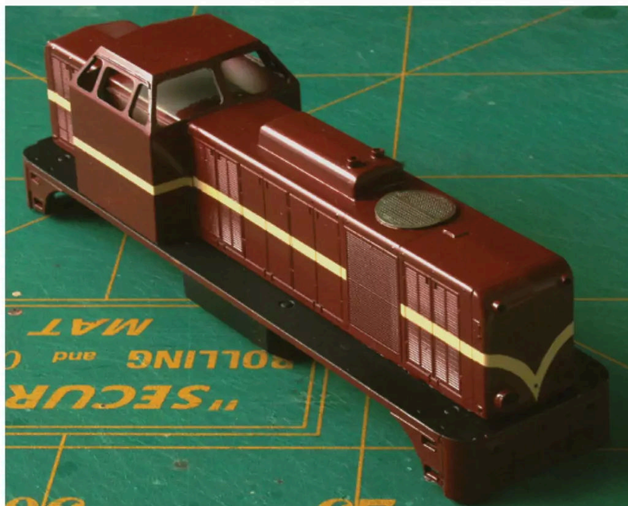
De vers gespoten kap. De zijkant van de omloop is ook geheel bruin. Voordat deze bruine laag er op gespoten is, is de eerder aangebrachte zandgele laag in een lauw sopje met afwasmiddel grondig ontvet.
