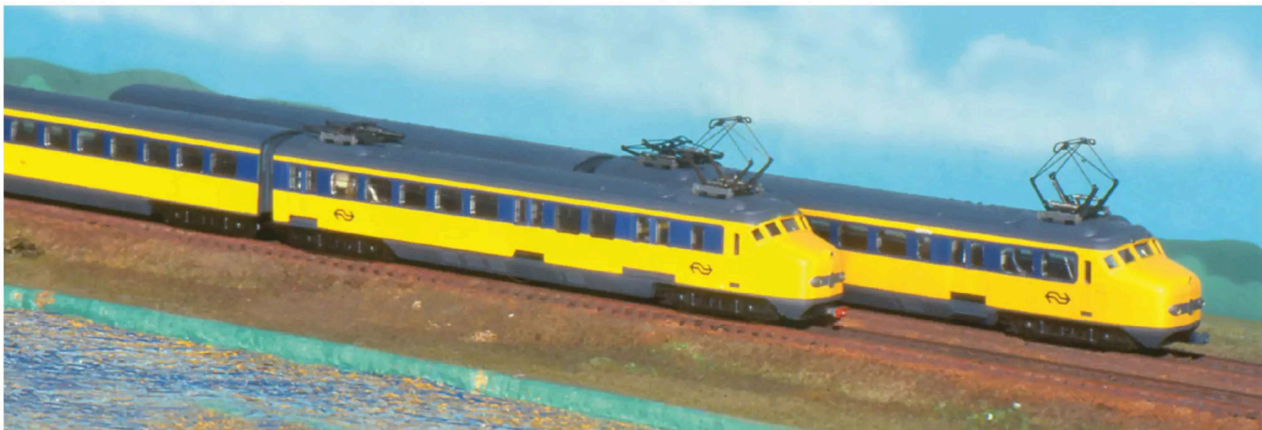
Vierwagenstel 741– een 'grote coach' – met doorlopende blauwe band. Dit stel heeft een verbouwde bagageafdeling met Sprinterramen.
