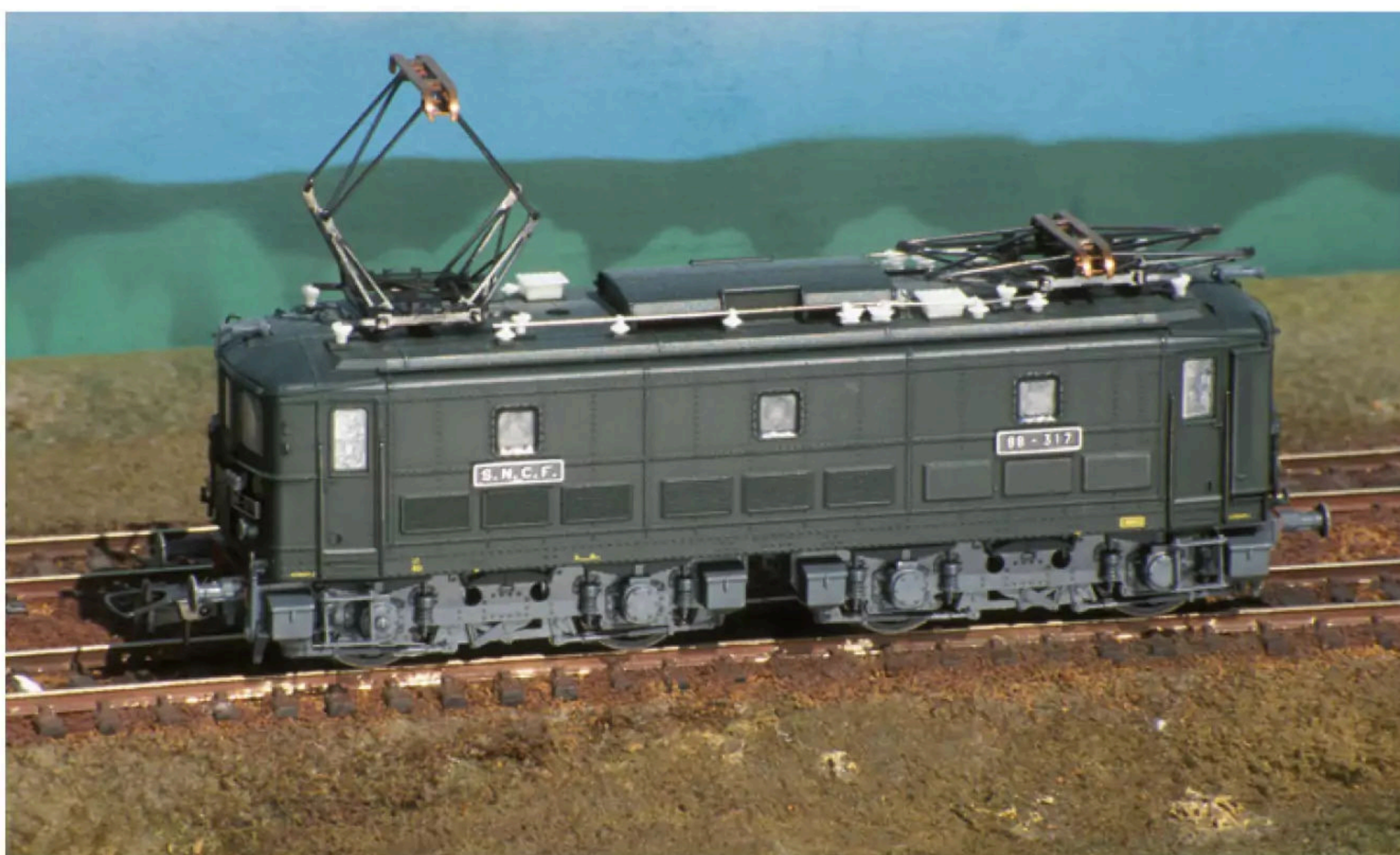
De Franse BB 317 van Roco. De van fabriekswege geblindeerde zijruiten zijn bij dit model vervangen door ingegoten exemplaren van 'Kristal Klear'.
