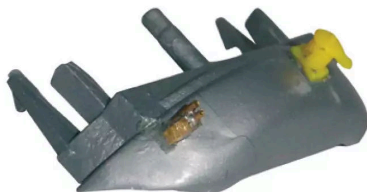
De frontschortplaat met de zelfgemaakte verwarmingskoppeldoos en de stuurstroomkoppeldoos van een Roco 2200.
