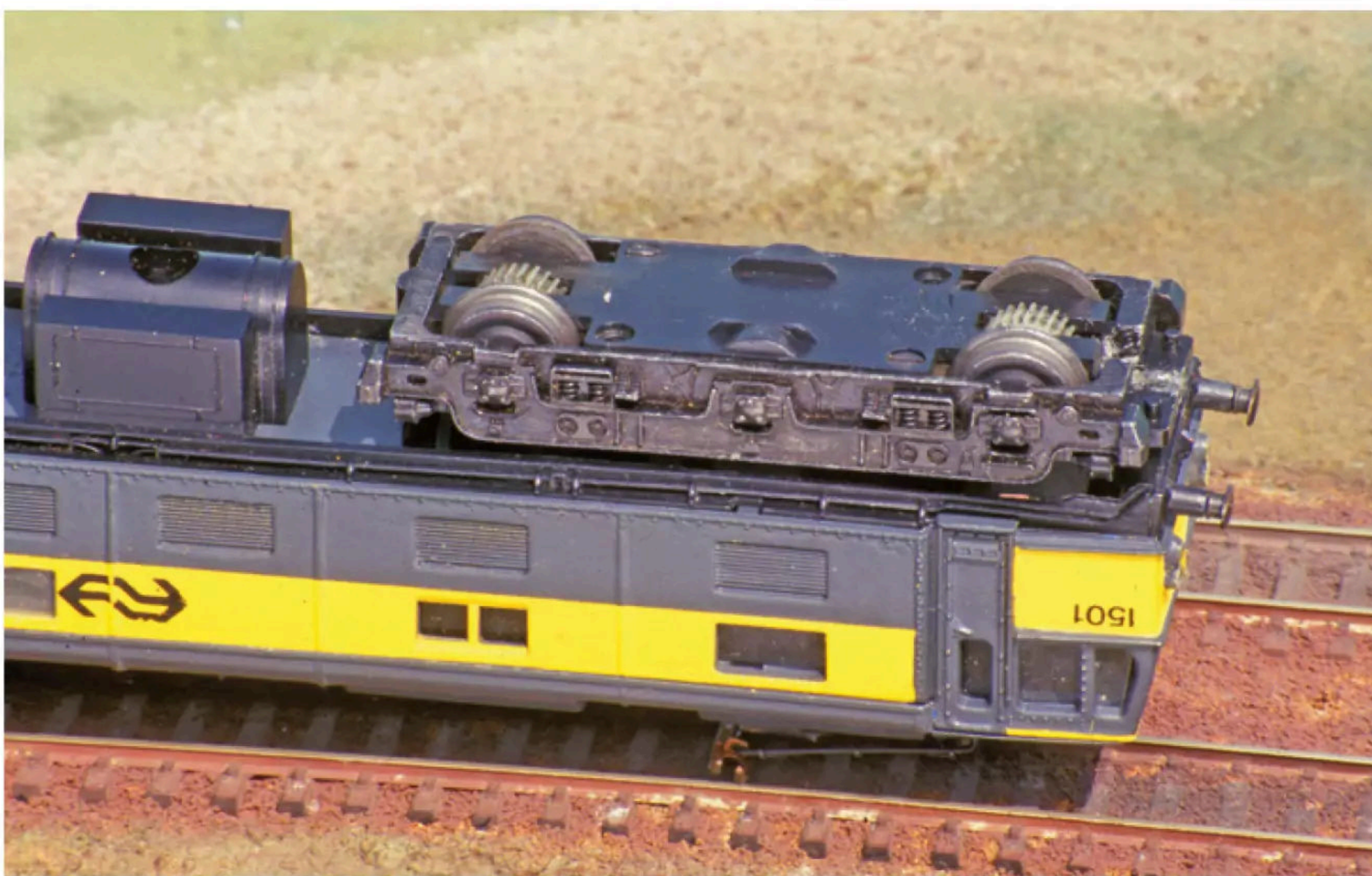
Het aangedreven draaistel van de Triang-Hornby loc heeft slechts twee assen. De middelste as is fake.
