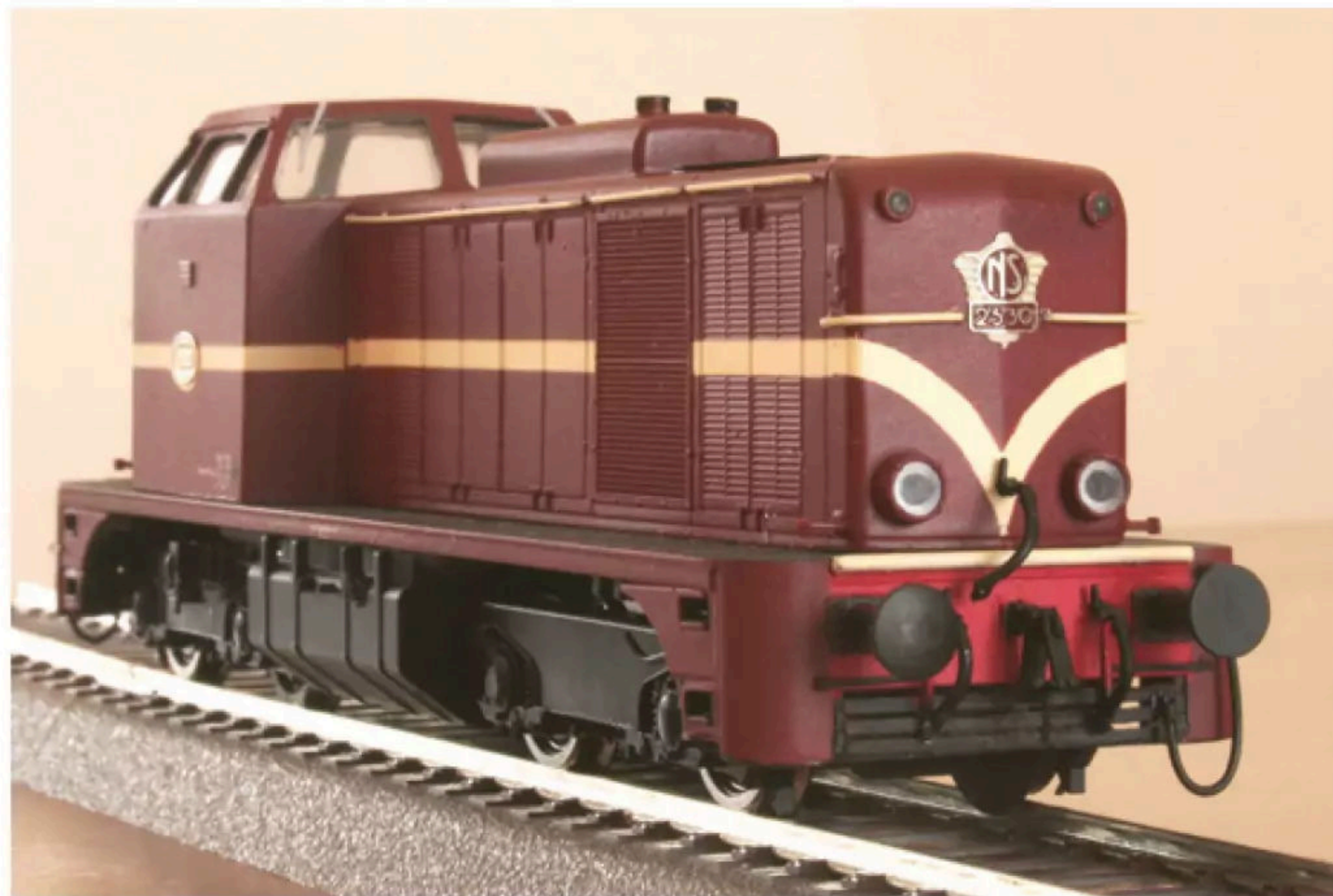
Het model tijdelijk gemonteerd. Ook zijn de accessoires op de bufferbalk aangebracht. Het beeld van de 1:1 'Bisschop' zit er al goed in. De loc is na het plaatsen van de transfers afgewerkt met Humbrol 135, gemengd met een druppeltje Kleinspoor zijdeglanslak.
