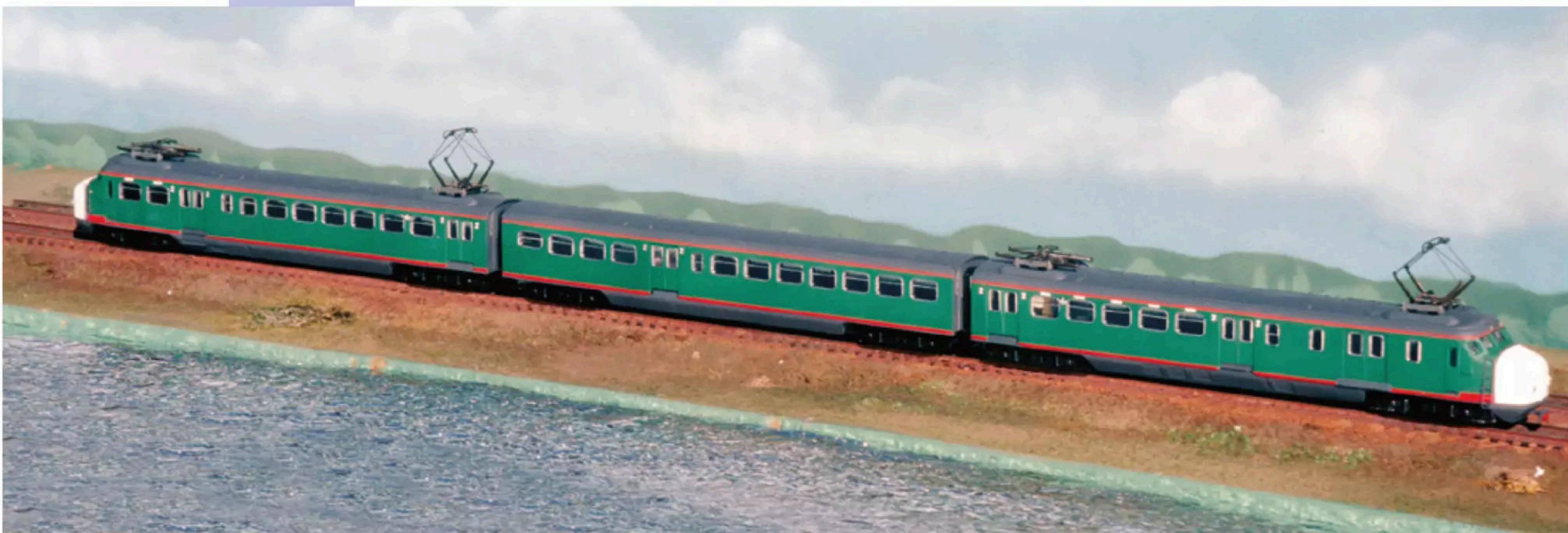
Hondenkop driewagenstel 757 met witte neuzen zoals gebruikt voor de bovenleidingsproeven bij hoge snelheden (tot 160 km/u) op het traject Venlo-Helmond in 1958.
