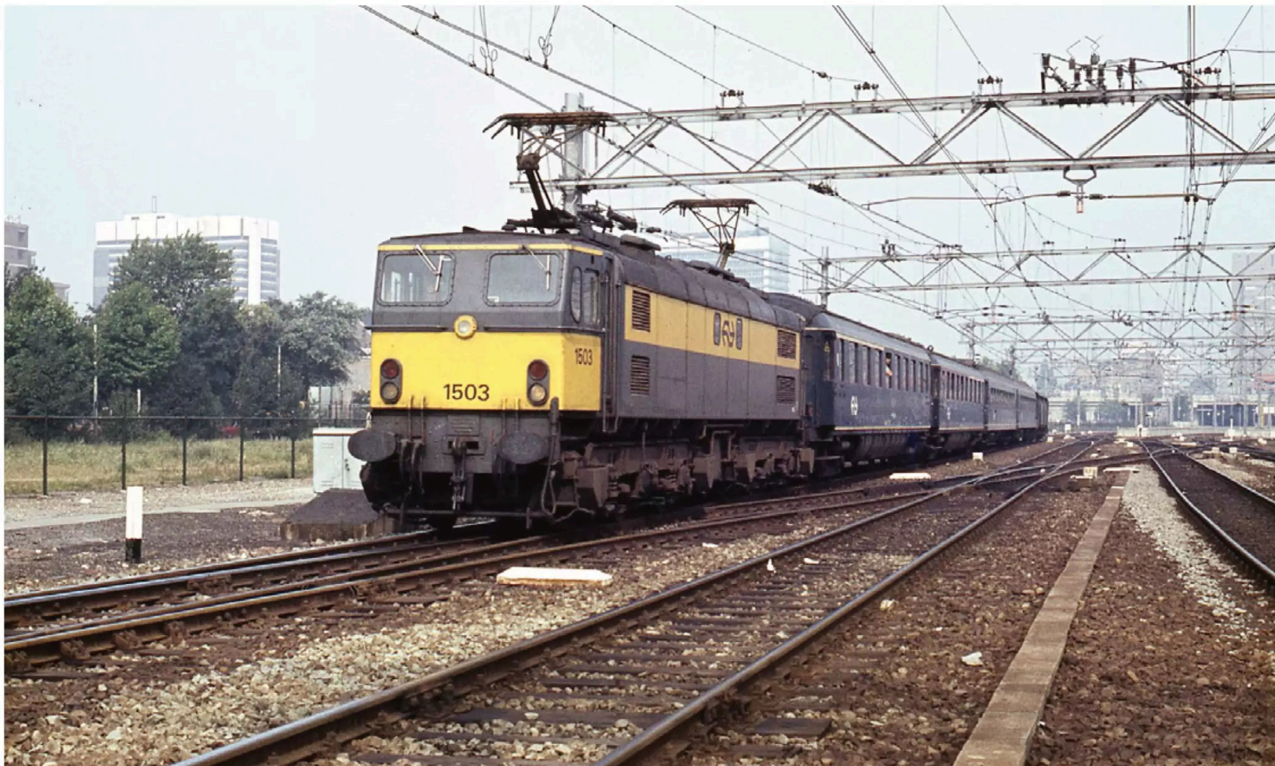
De ovale buffers werden later door de wat grotere rechthoekige vervangen. Loc 1503 verlaat met een 'Keulenaar' Den Haag Centraal. (foto Bert van der Kruk)
