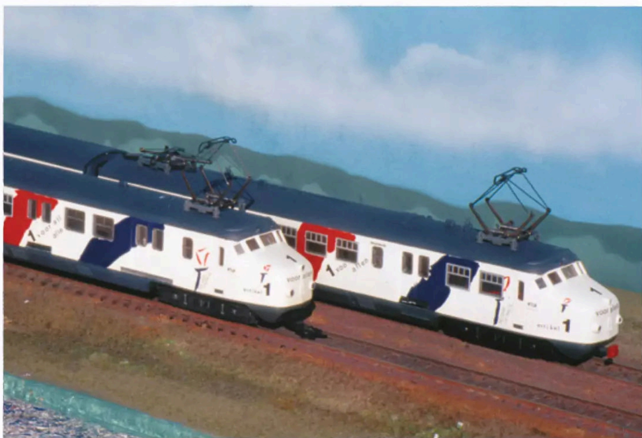
'Een voor Allen' luidde het motto van deze Hondekop-vier Bevrijdingstrein 763. Het model (behorend tot Plan P) is verbouwd met raampjes afkomstig van een Belgisch M2-rijtuig.
