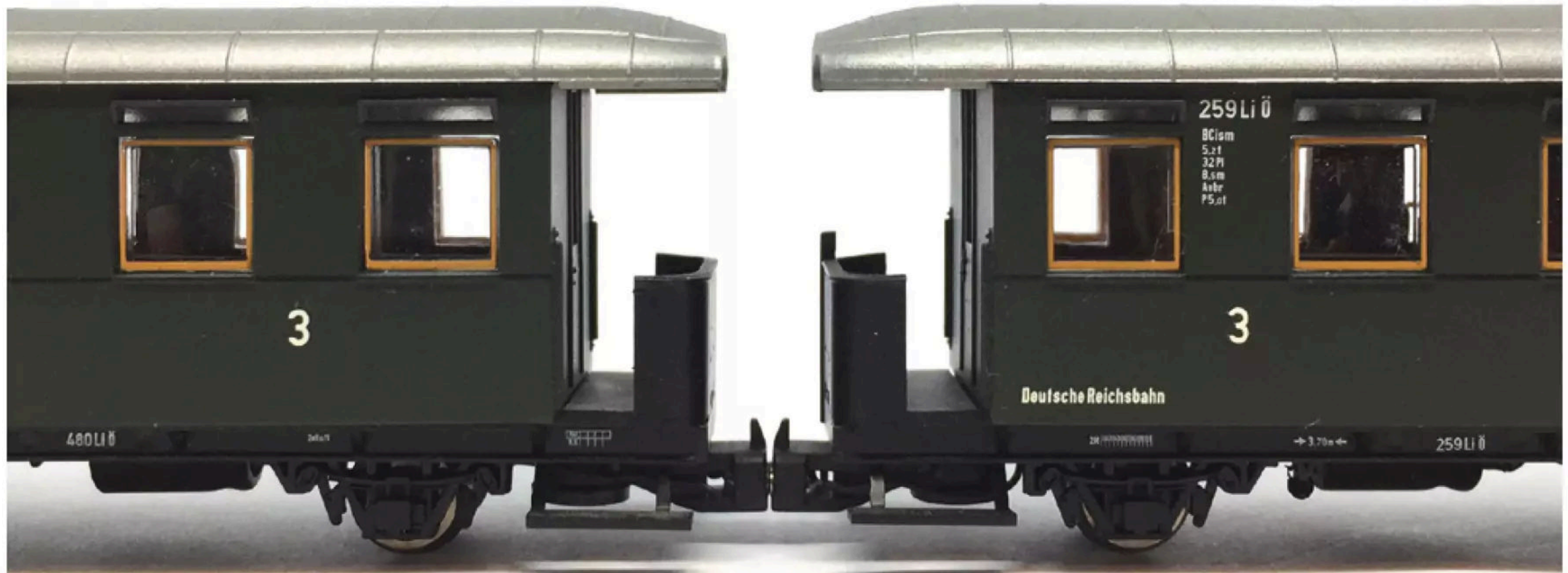
TRAMFABRIEK: magnetisch gekoppelde rijtuigen met stroomdoorvoer.
