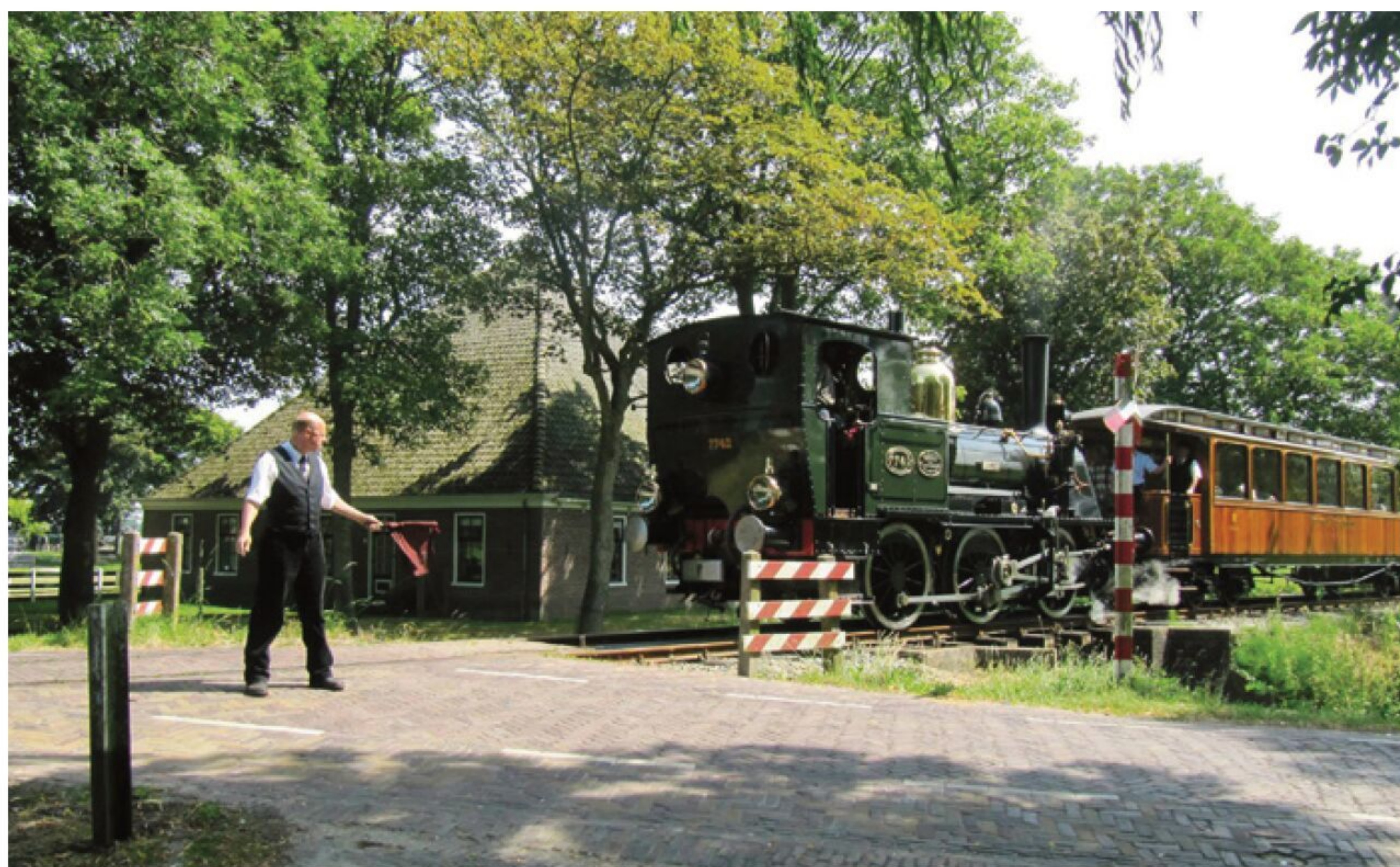
De lokaalspoorwegovergang wordt met een rode vlag gezekerd.
