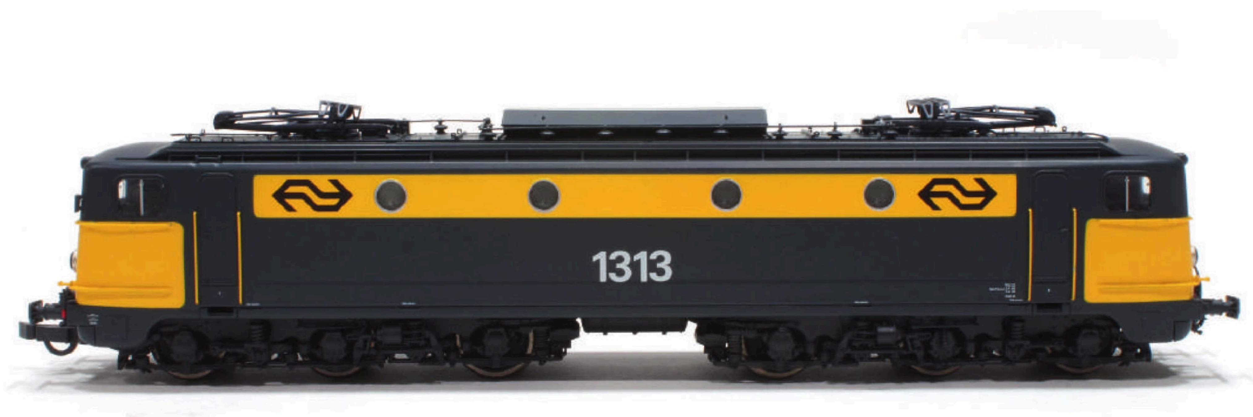
De nieuwe en reeds omgenummerde 1313 met eenbeenstroomafnemers. De nieuwe pantografen liggen goed plat op het dak.
