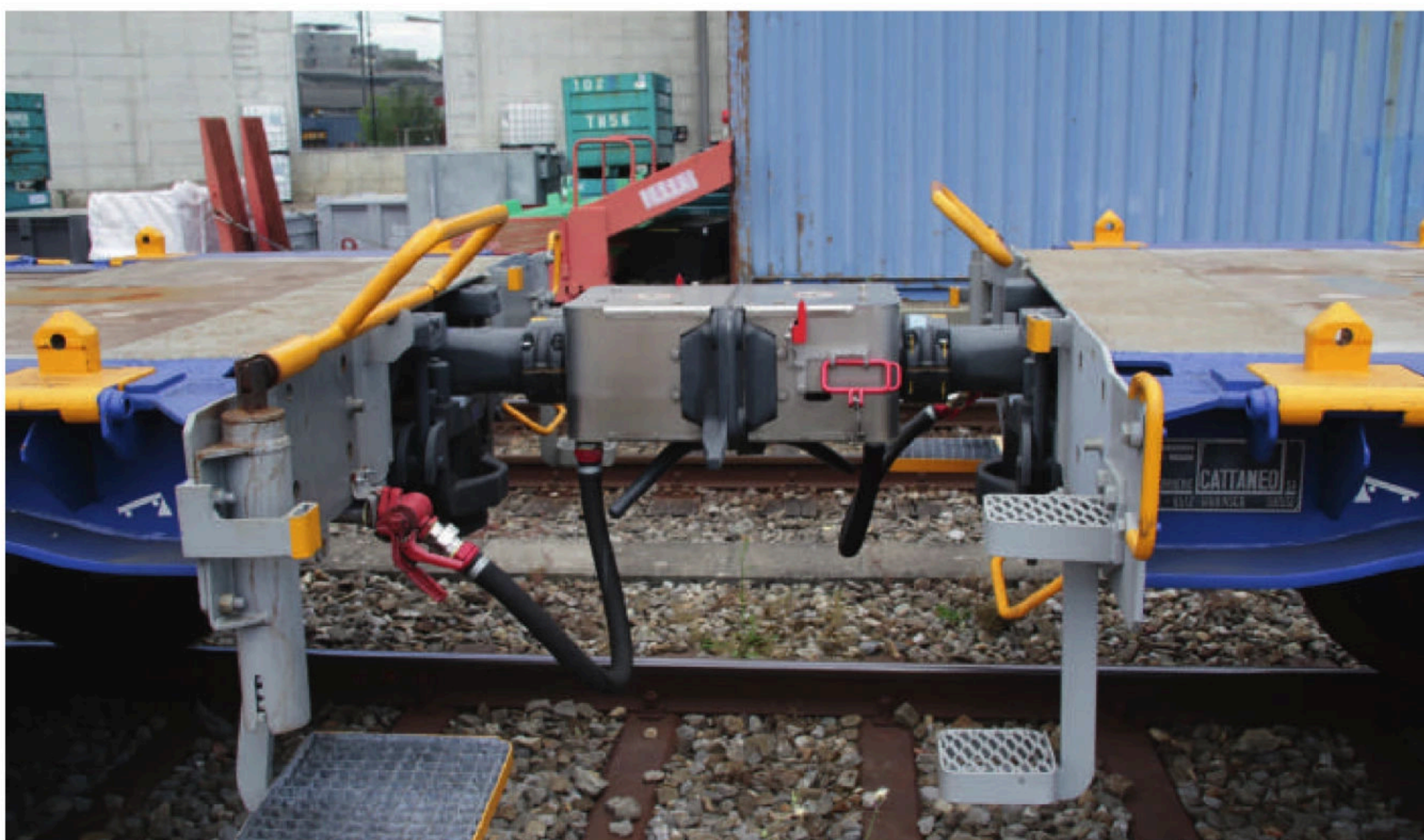
Met automatische koppeling gekoppelde Sgnss, de buffers zijn verwijderd. (foto SBB©)
