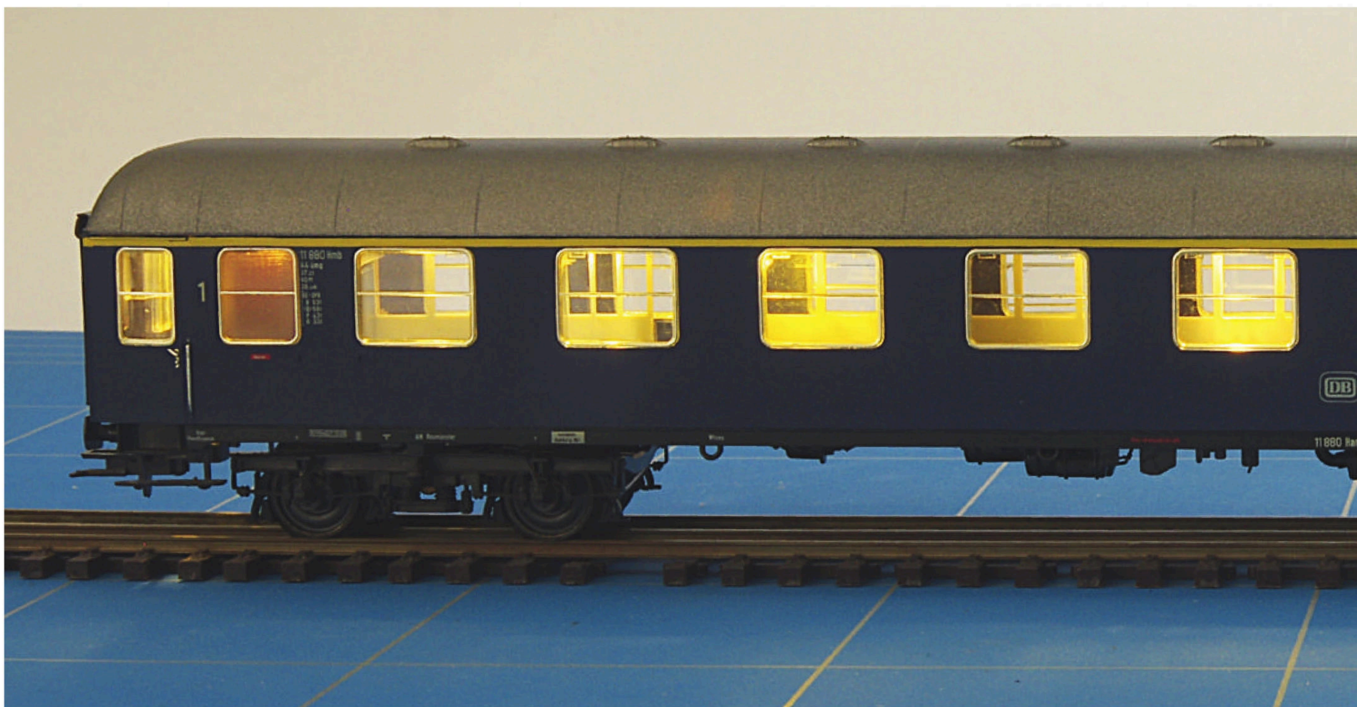
Stroombron-ledverlichting bij 4,4 volt in een Ade 1e klasse rijtuig.
