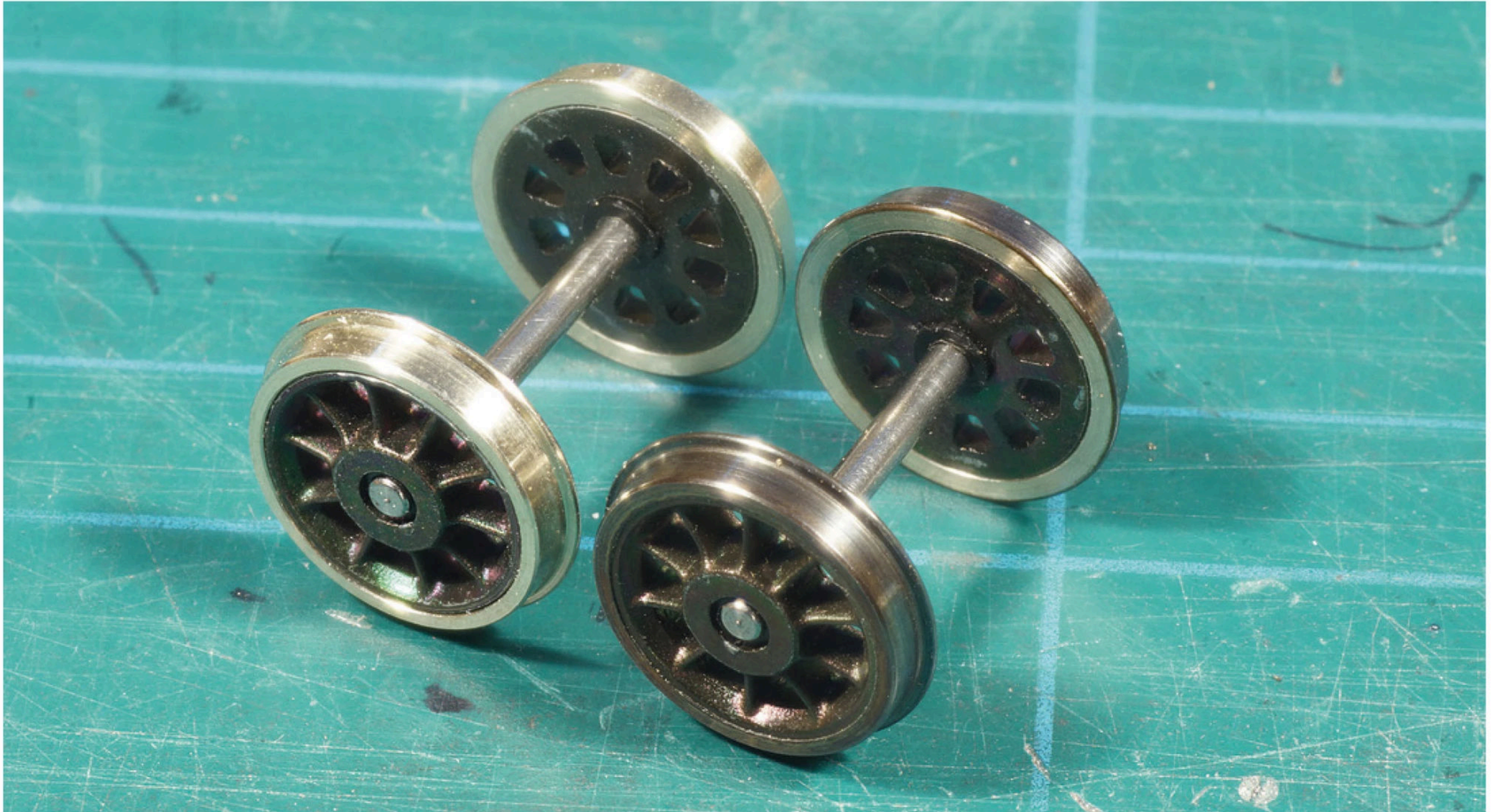
Een vergelijking van het gezwarte wiel (rechts) met een nog niet behandelde as laat het verschil goed zien.
