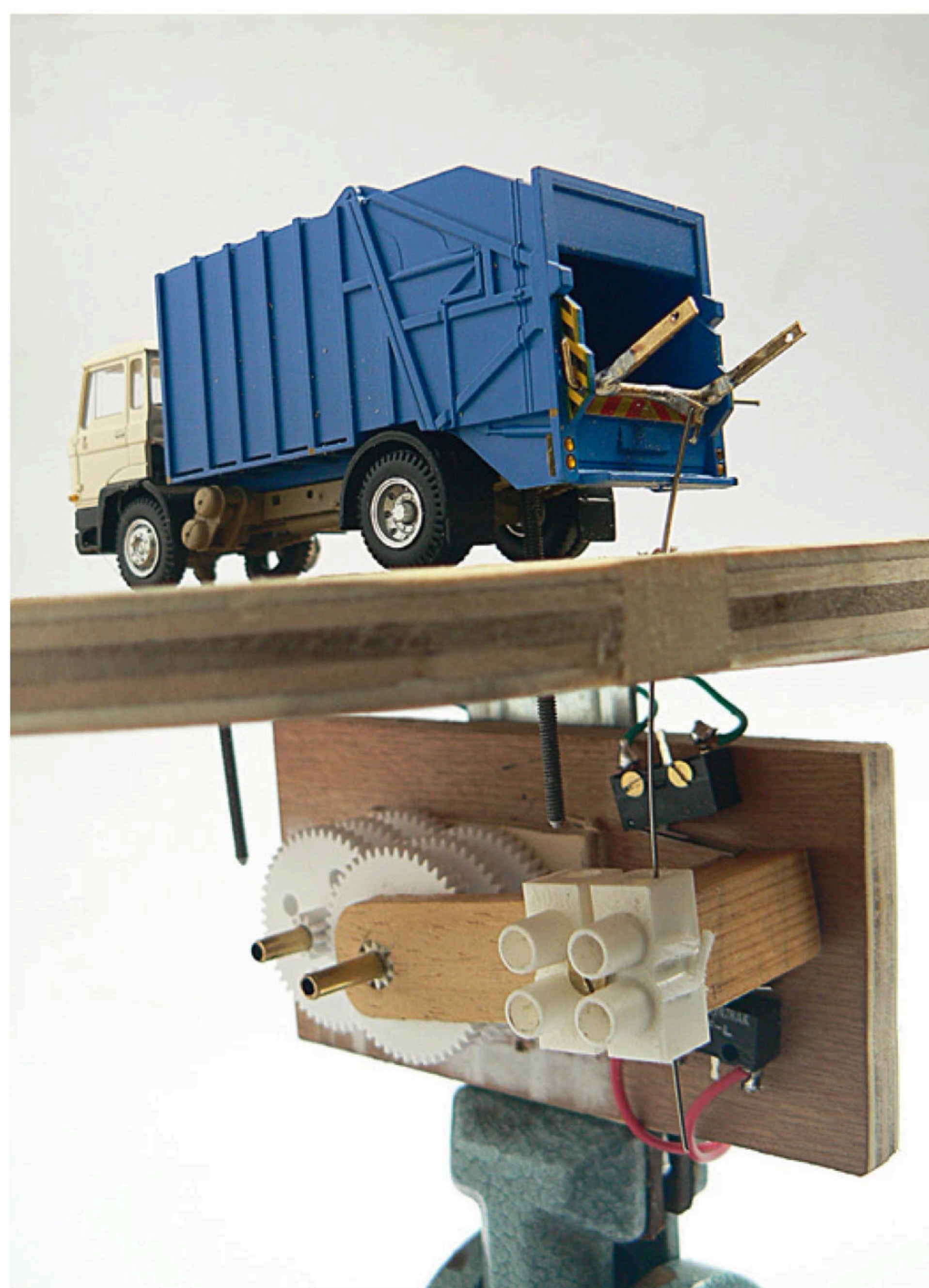
Hoe het technisch gezien zou moeten werken: de trek/duwstang is later door een dunnere vervangen.
