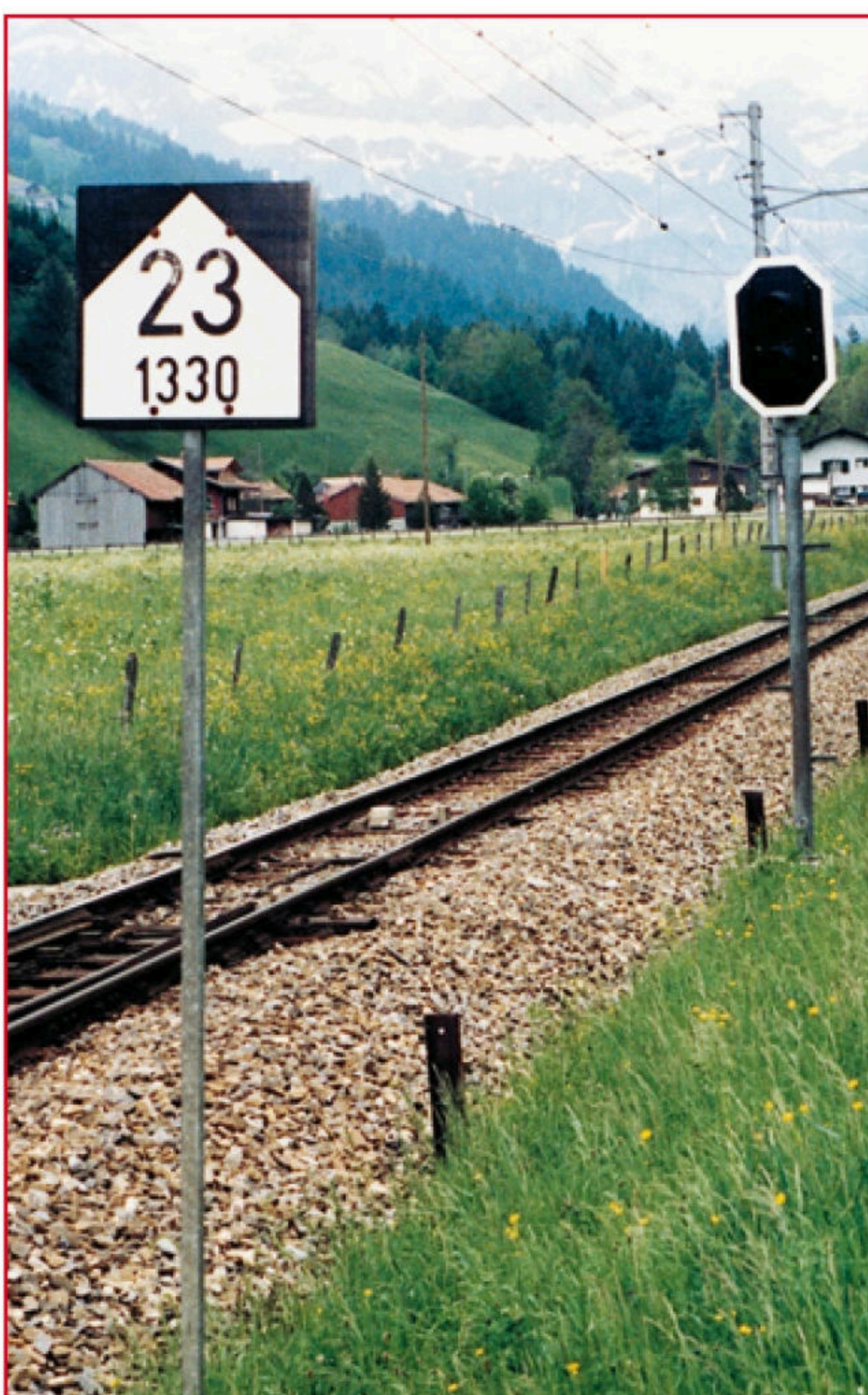
Hoofdsein (art. 7.7) met twee lichten voorafgegaan door een helling bord (art. 33). Het bord vertelt de machinist dat het traject over 1330 meter 23% gaat stijgen. Het lichtsein is gedoofd. Op sommige lokaallijnen doven de seinen als er in een vastgelegd traject geen trein aanwezig is.
