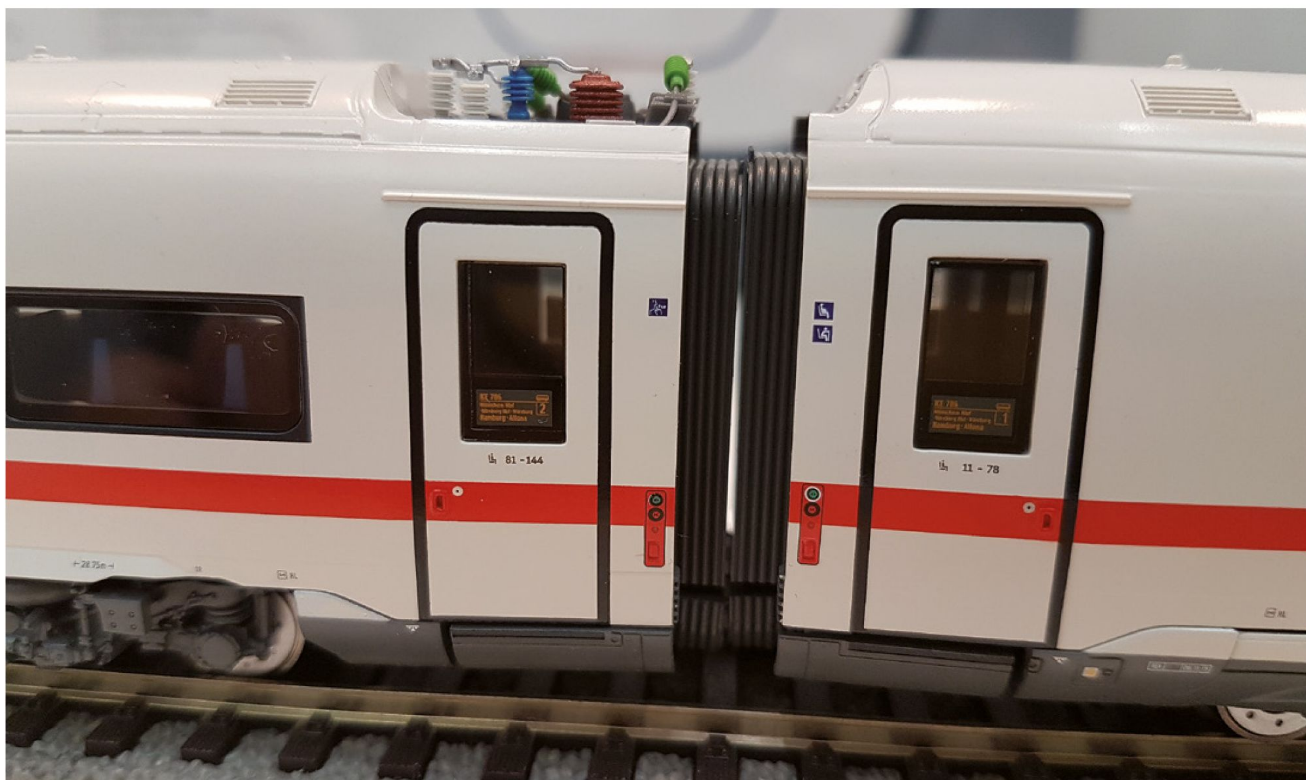
Aansluitende vouwbalgen en uitgebreide hoogspanningsinstallatie, ICE 4, Piko.
