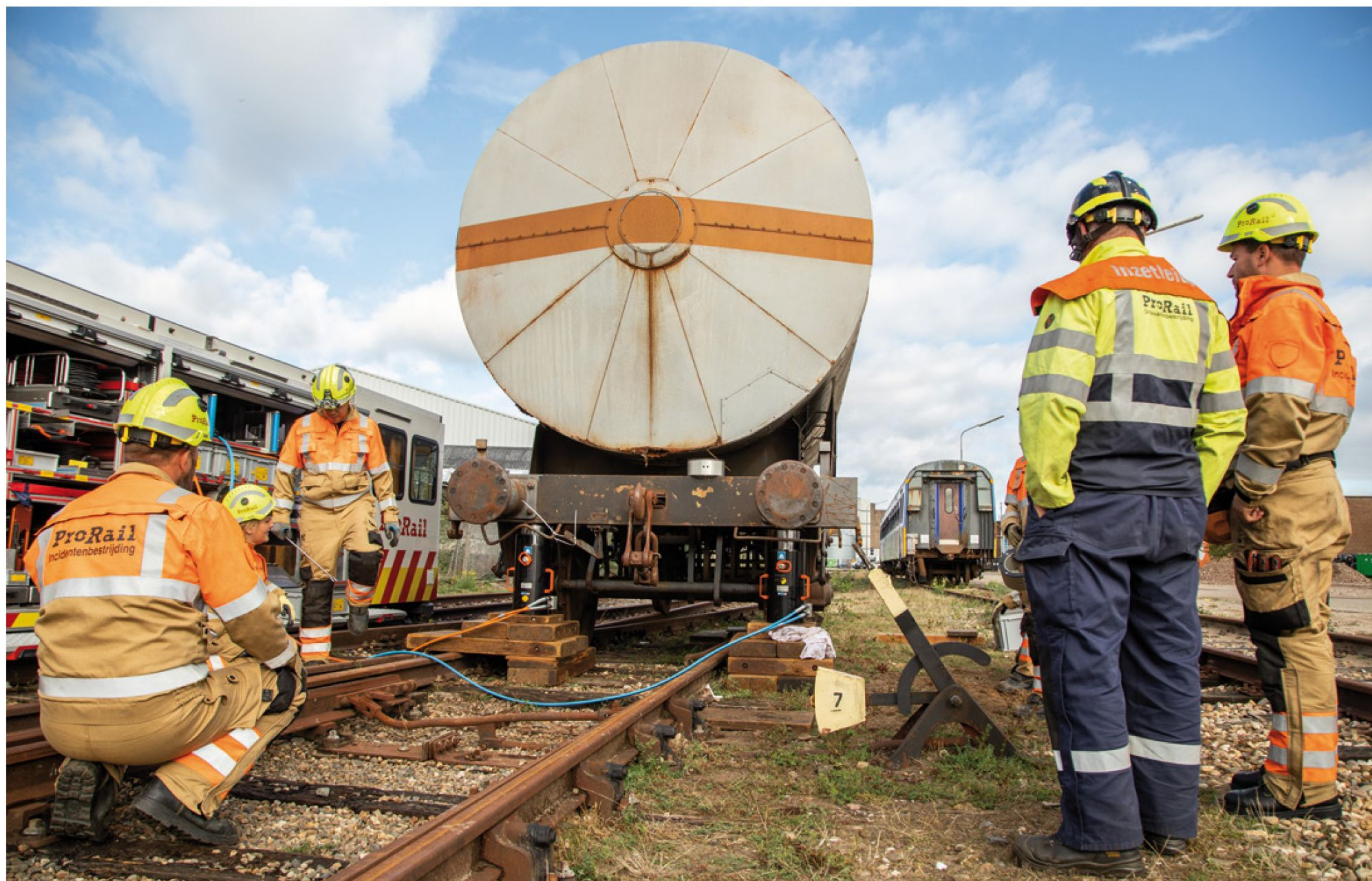
Een ketelwagen wordt door incidentenbestrijders terug op het spoor gezet, 24 september 2018.
