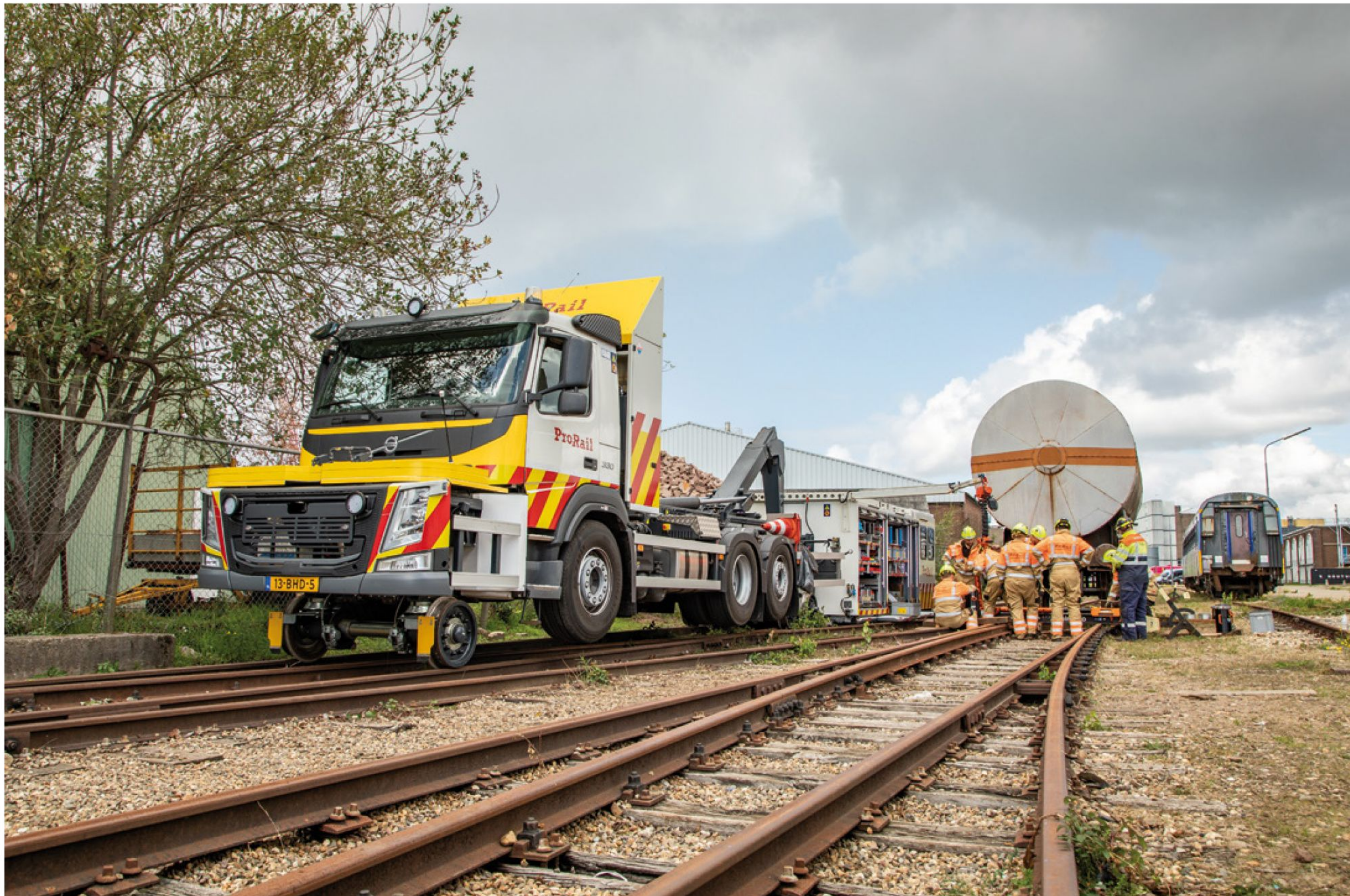
De Volvo FM 330 met spoorwielen heeft gereedschappen naar de werkplek gebracht.
