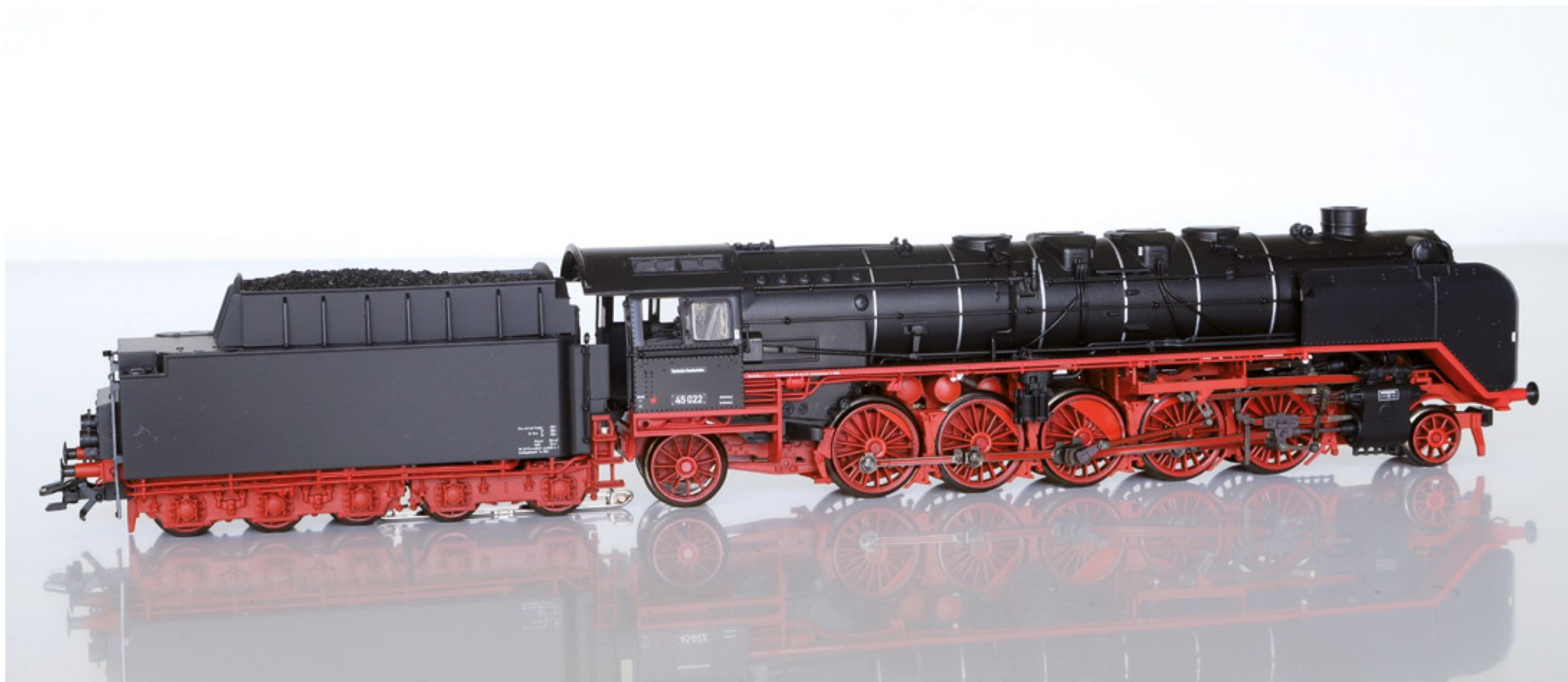
De 45 022 gezien aan de kant van de machinist. Let op het verschil in diameter van het voorste en achterste loopwiel.
