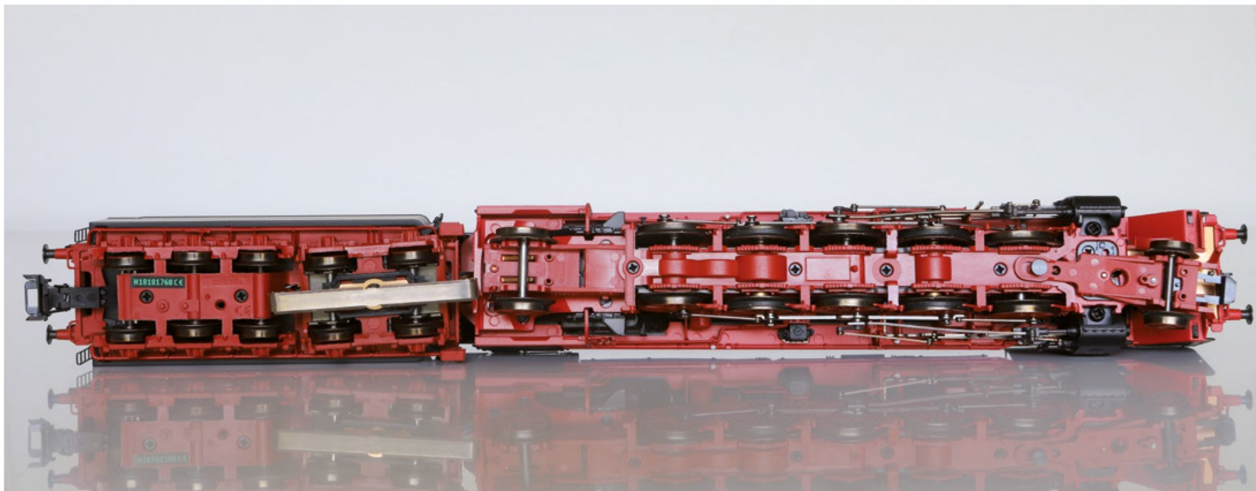
Onderkant van de 45 022. Goed is te zien dat het model vier antislipringen heeft.
