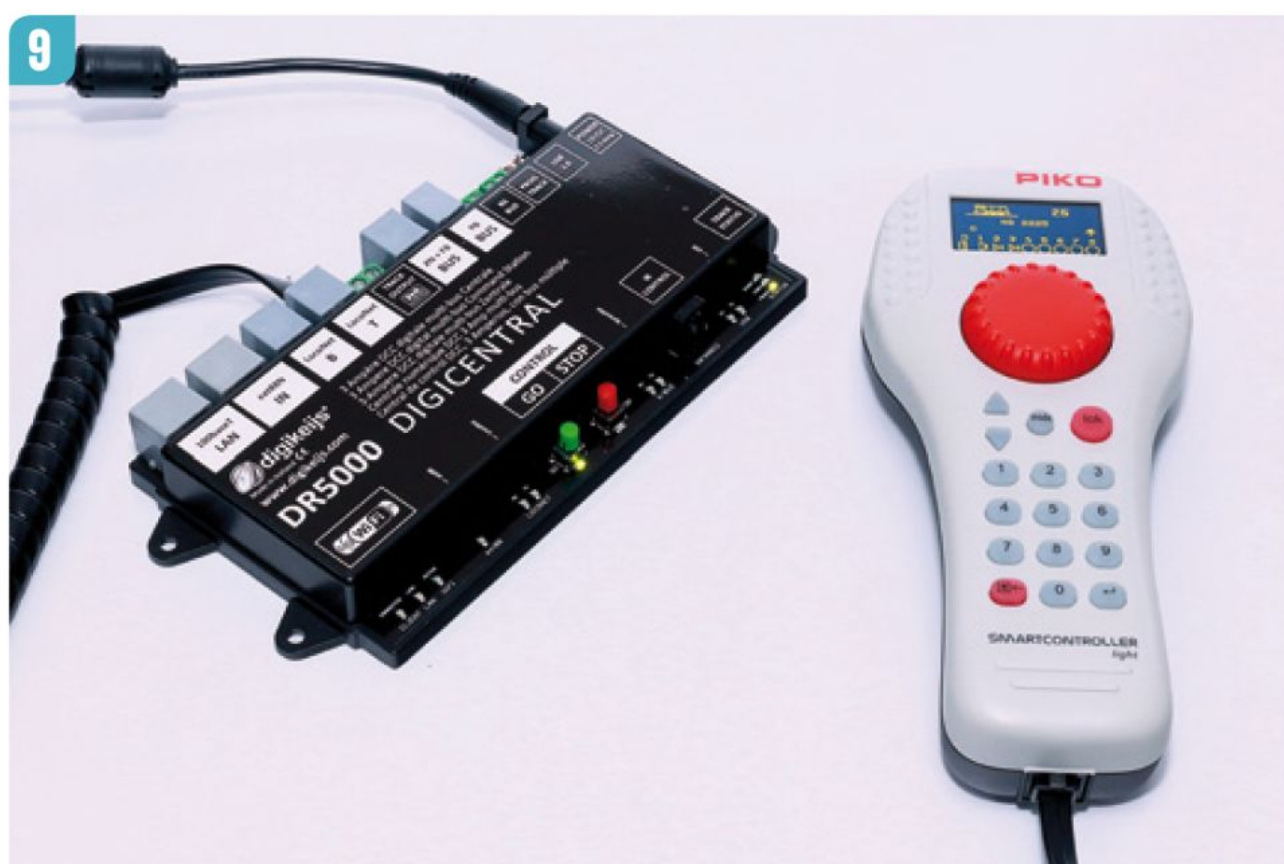
7. De handregelaar geopend. Duidelijk een eigen ontwikkeling van Piko, rechts de Daisy II. 8. Een voorbeeld van het aansluiten van een Fremo-Fred. 9. De SmartControl aan de Digikeijs DR5000. 10. De SmartControl aan de Intellibox I-IR. 11. De SmartControl aan het Fleischmann Twin-Center.
