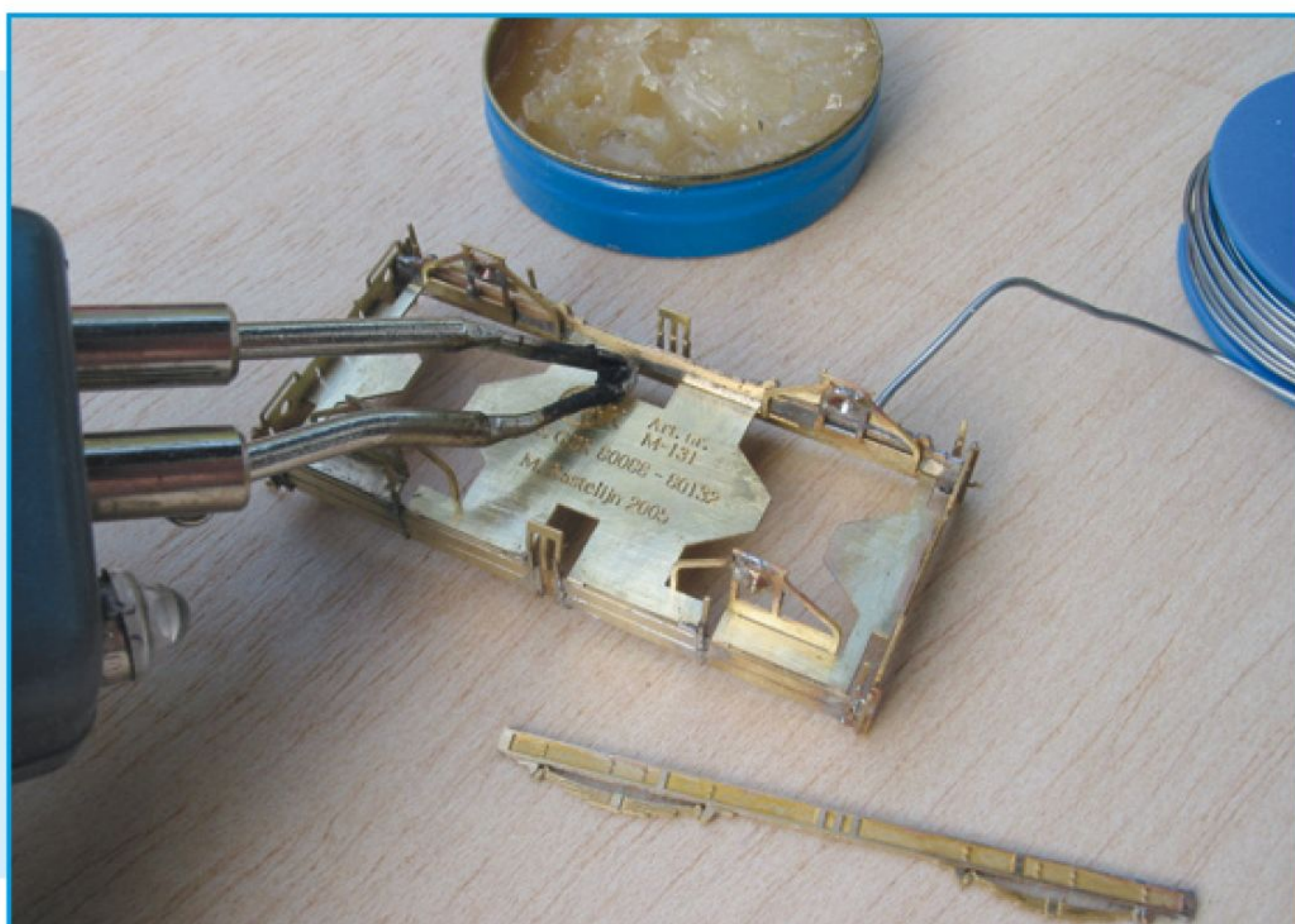
De stelbalken worden aan de bak en aan de balansijzers gesoldeerd.
