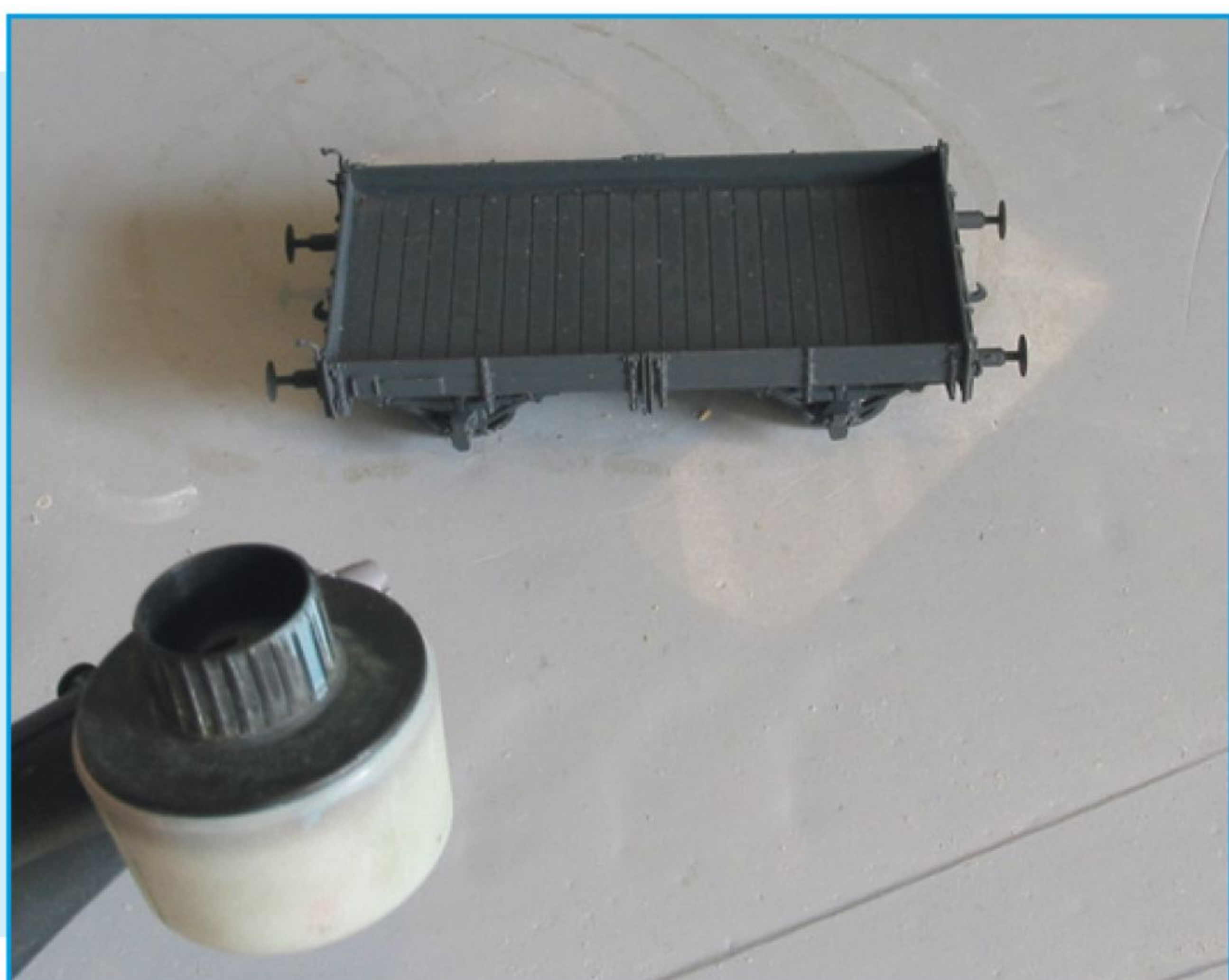
Na een primerlaag wordt de bovenbouw donkergrijs gespoten. U zou hiervoor ook een spuitbus kunnen gebruiken en eventueel zou het model ook uit de hand geschilderd kunnen worden. Pas op dat de details niet in de verf verdrinken.
