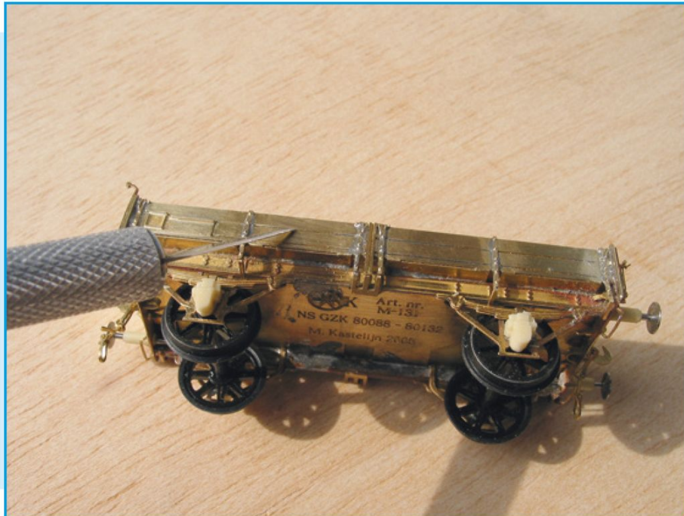
Met een mes kunnen resten soldeer uit de planknaden worden gestoken.
