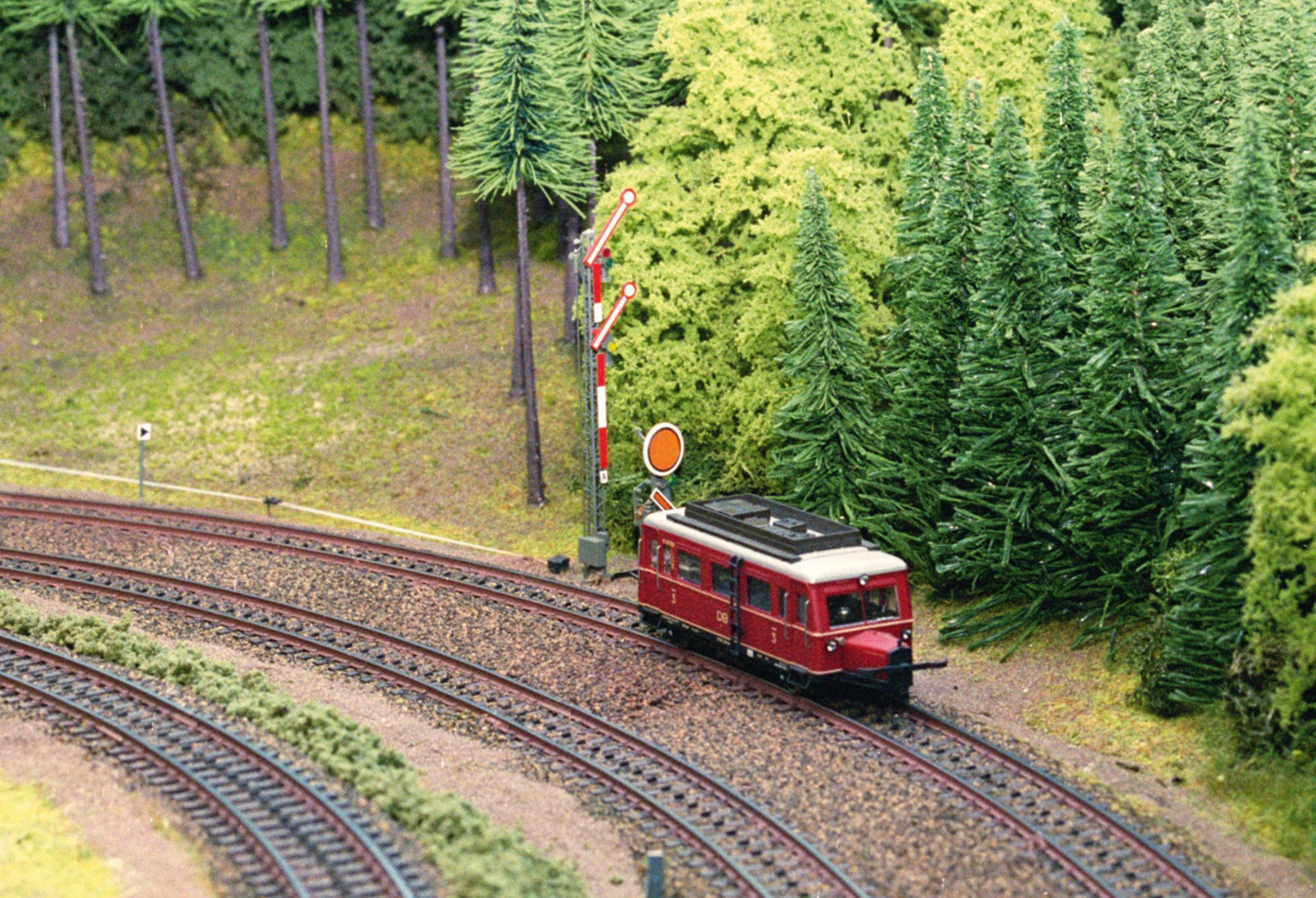
De Duitse armseinen van Viessmann worden met standaard wisseldecoders aangestuurd.
