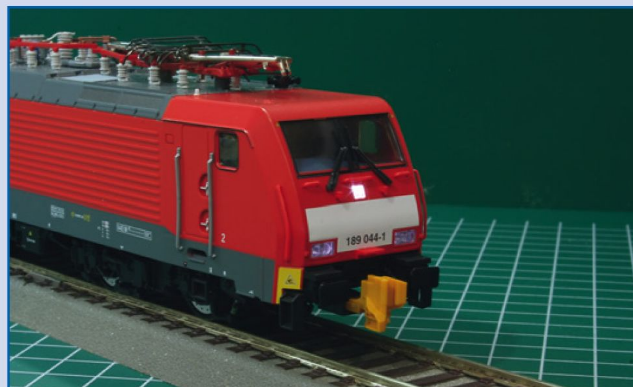
Roco: rangeerseinen. Heel licht zichtbaar het doorschijnen in de onderste seinen.
