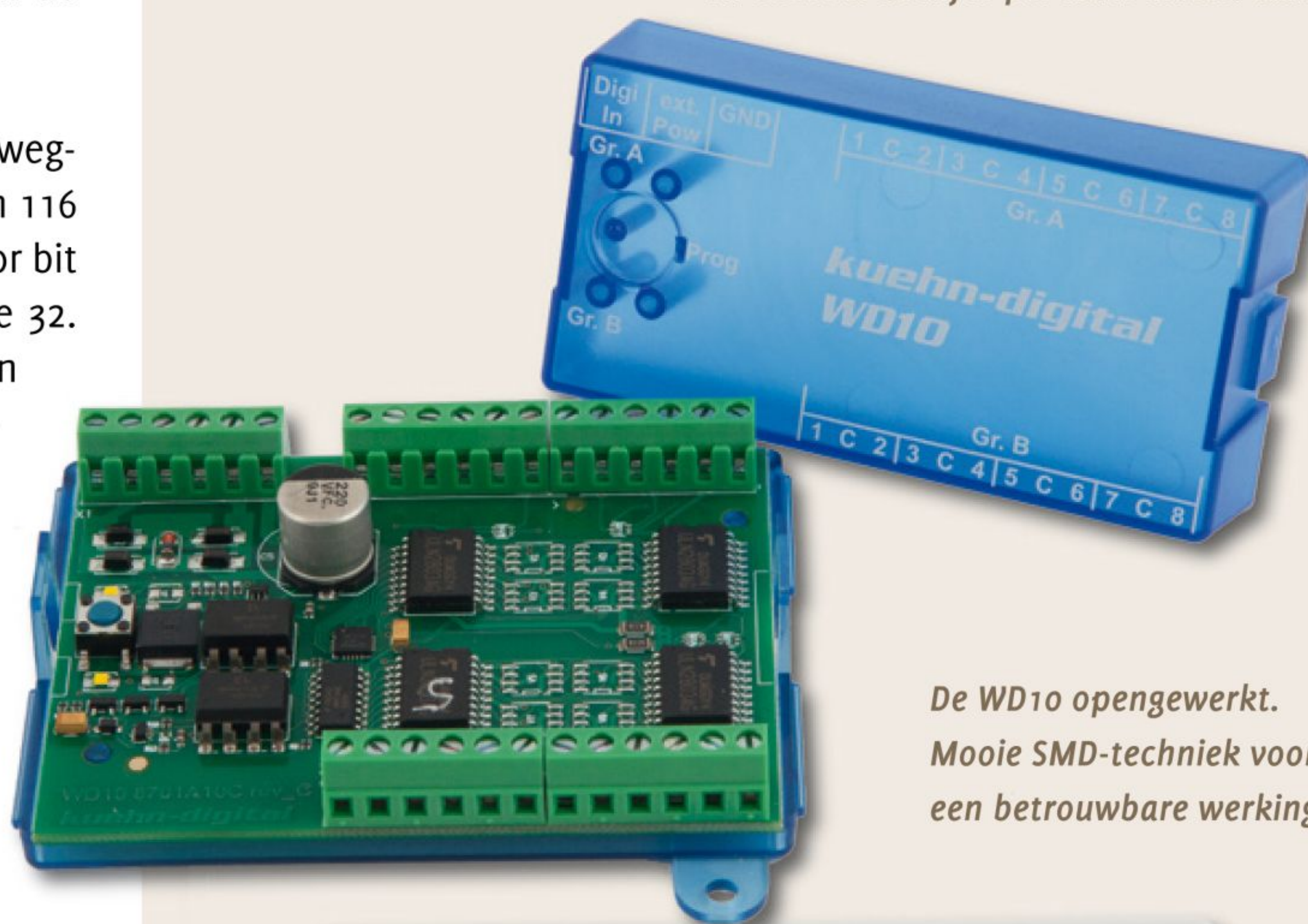
De WD10 van Kuehn kent aansluitingen voor 8 wissels. Eigenlijk zijn het 2 decoders in 1 behuizing. Decoder A en decoder B. Hij is per kant instelbaar.
