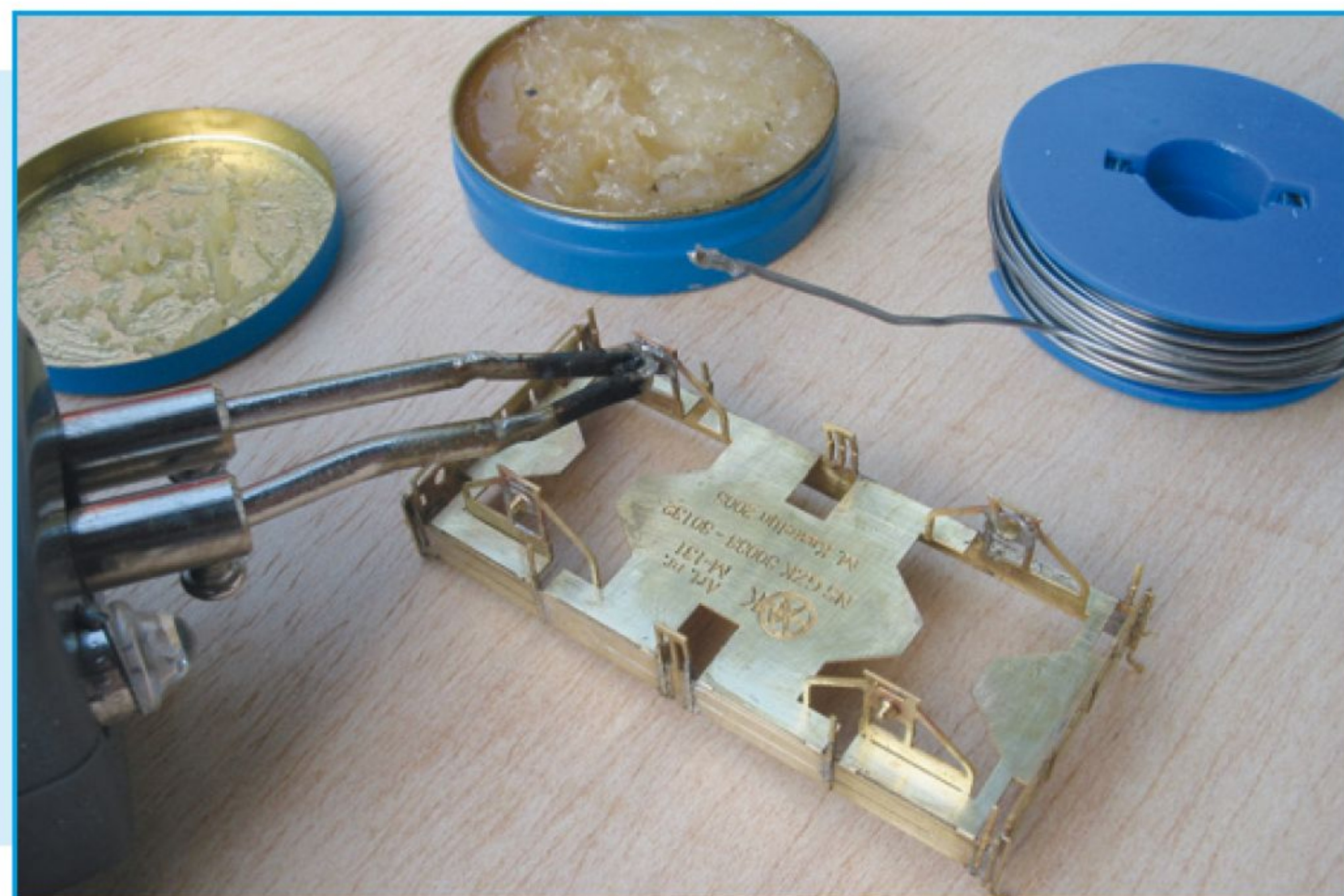
De aslagers worden in de schenen gesoldeerd.
