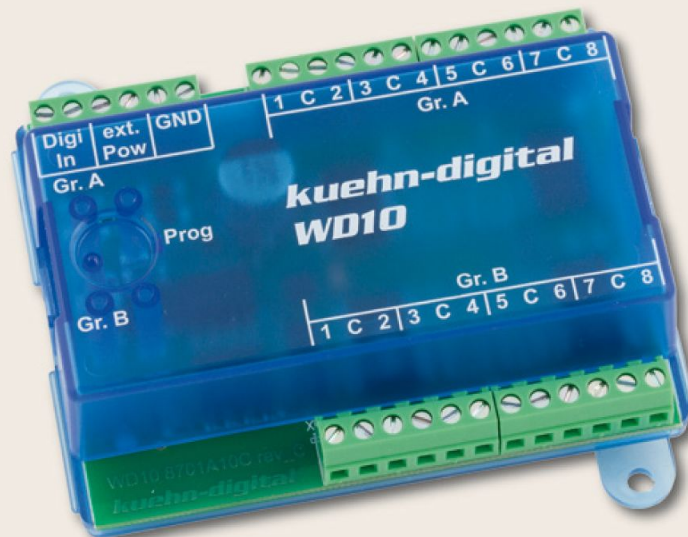
De WD10 van Kuehn kent aansluitingen voor 8 wissels. Eigenlijk zijn het 2 decoders in 1 behuizing. Decoder A en decoder B. Hij is per kant instelbaar.
