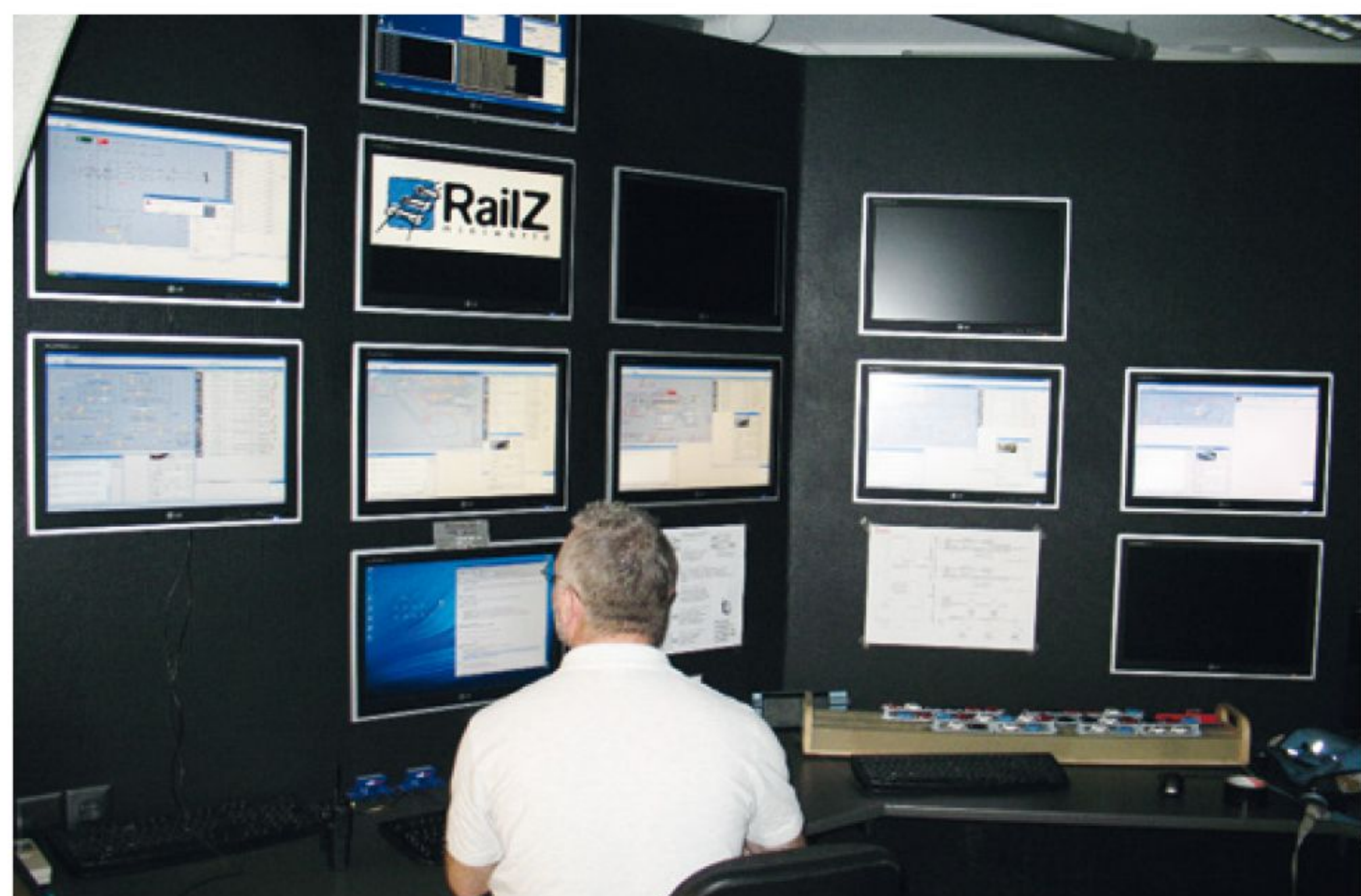
Het 'zenuwcentrum' van Miniworld Rotterdam, hier nog in de RailZ Miniworld-periode. Per monitor wordt een gedeelte van de spoorbaan getoond. De besturing van de treinenloop verloopt geheel automatisch, maar er kan uiteraard handmatig worden ingegrepen.
