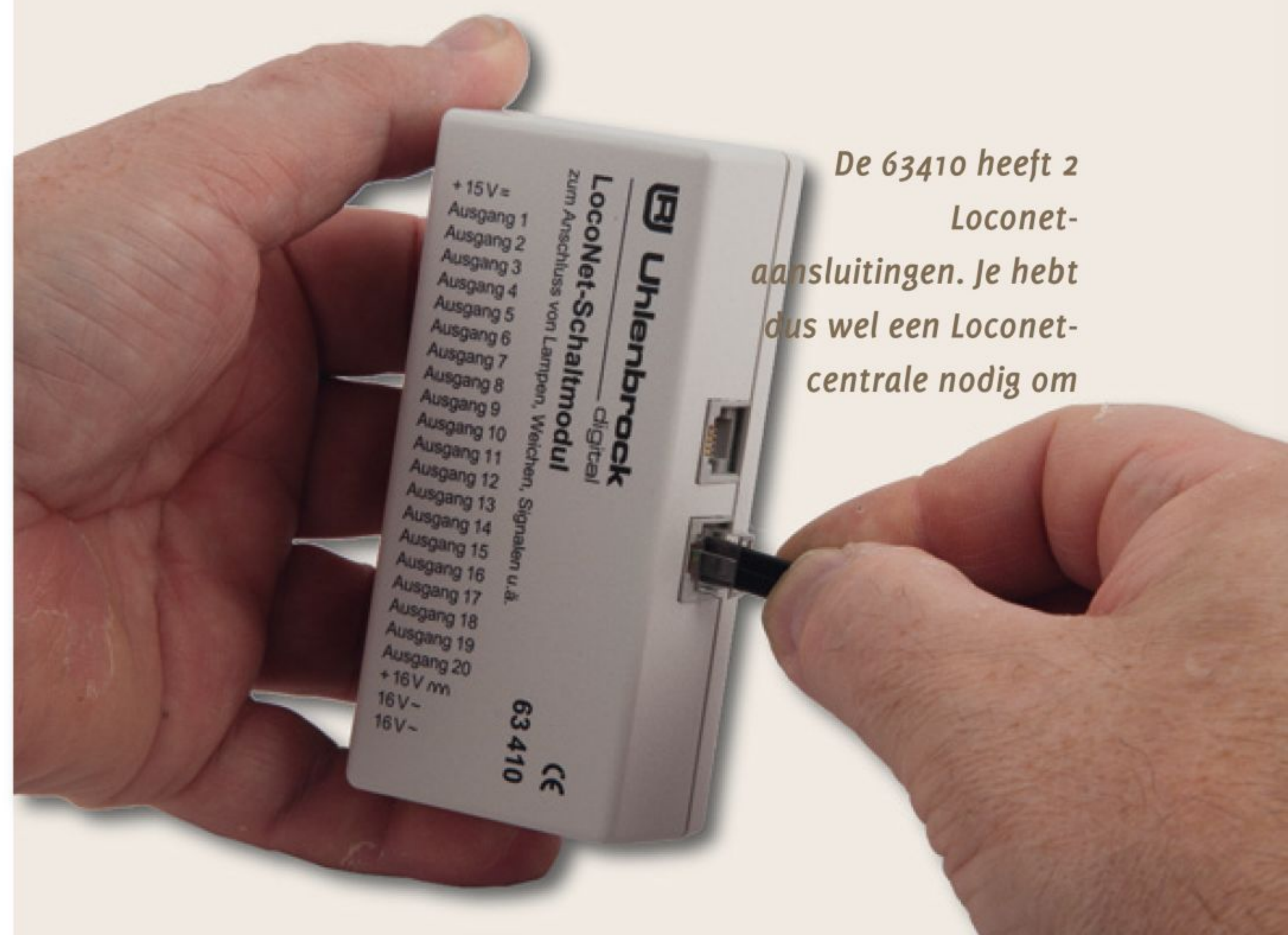
Uhlenbrock maakt een schakeldecoder met 20 uitgangen. Elke uitgang is apart instelbaar. De meest universele decoder tot nu toe.
