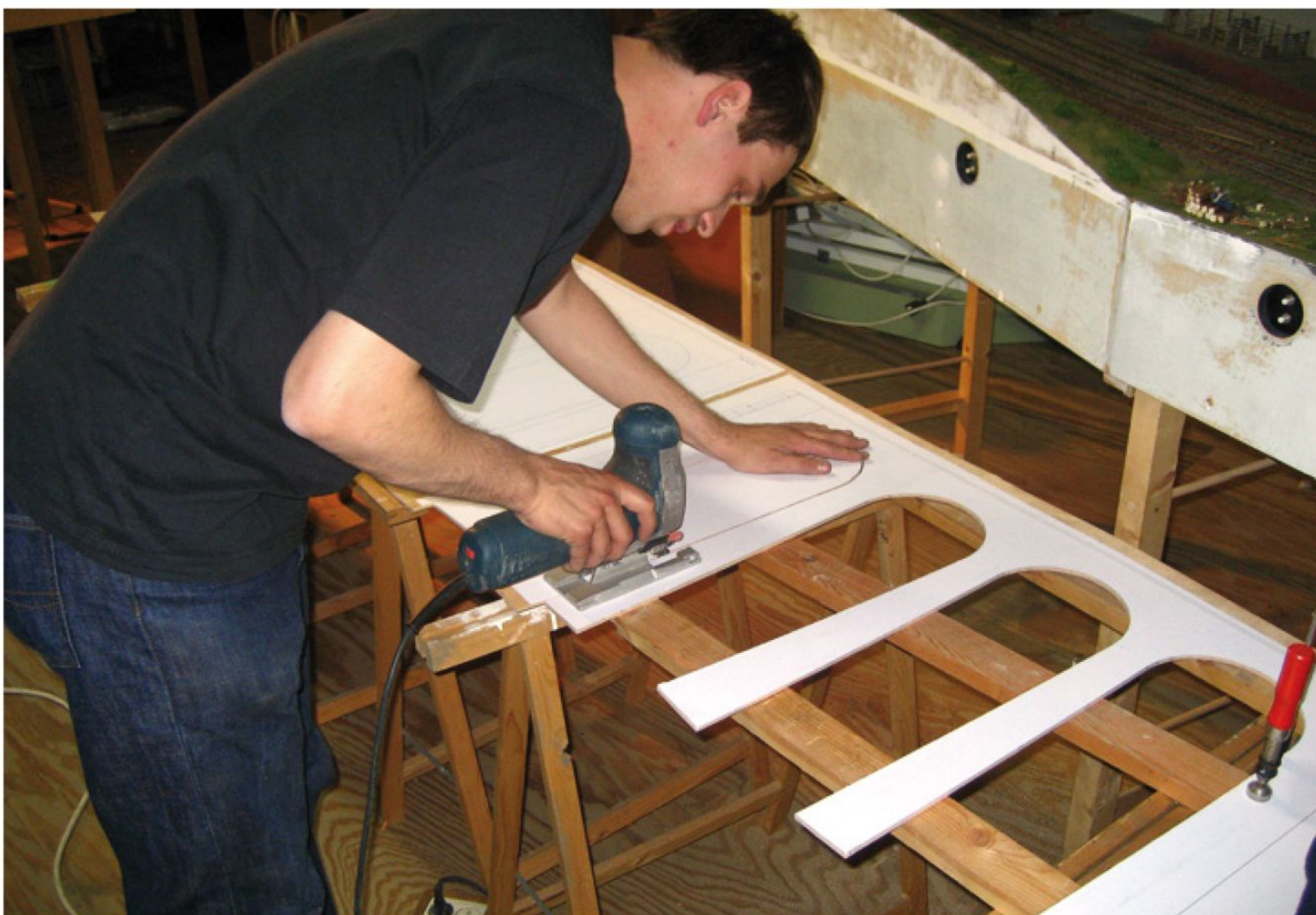
Een tekening op schaalgrootte van de pijlers en bogen is uit triplex gezaagd. Ook het draagvlak van de sporen en de bodem komen uit dezelfde plaat hout.
