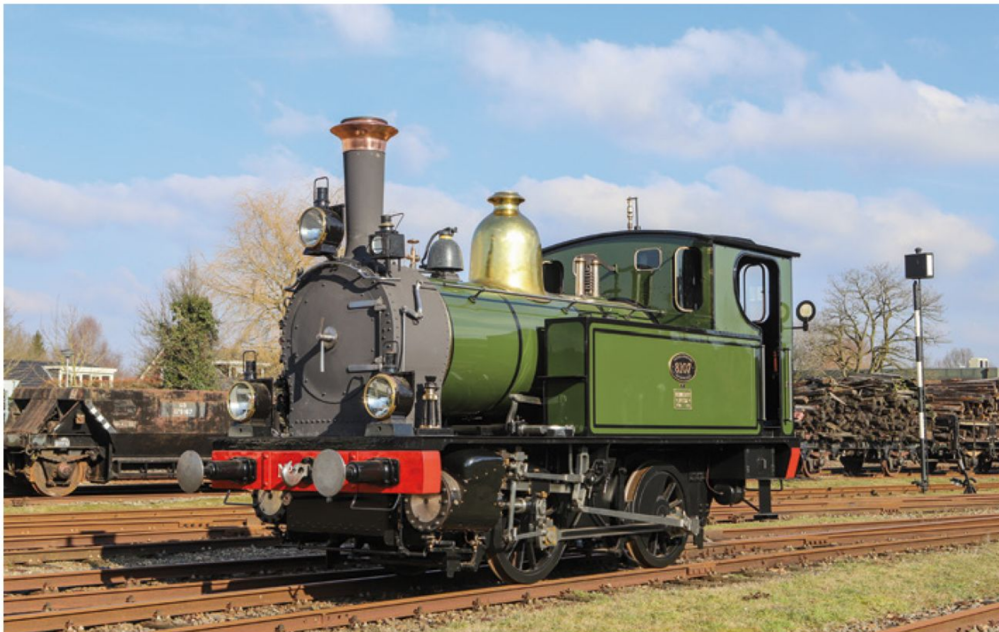
MBS loc 8107, kort voor de oplevering. De koppelstang en schroefkoppelingen moeten nog worden geplaatst. (foto Sevrien Ferrée)
