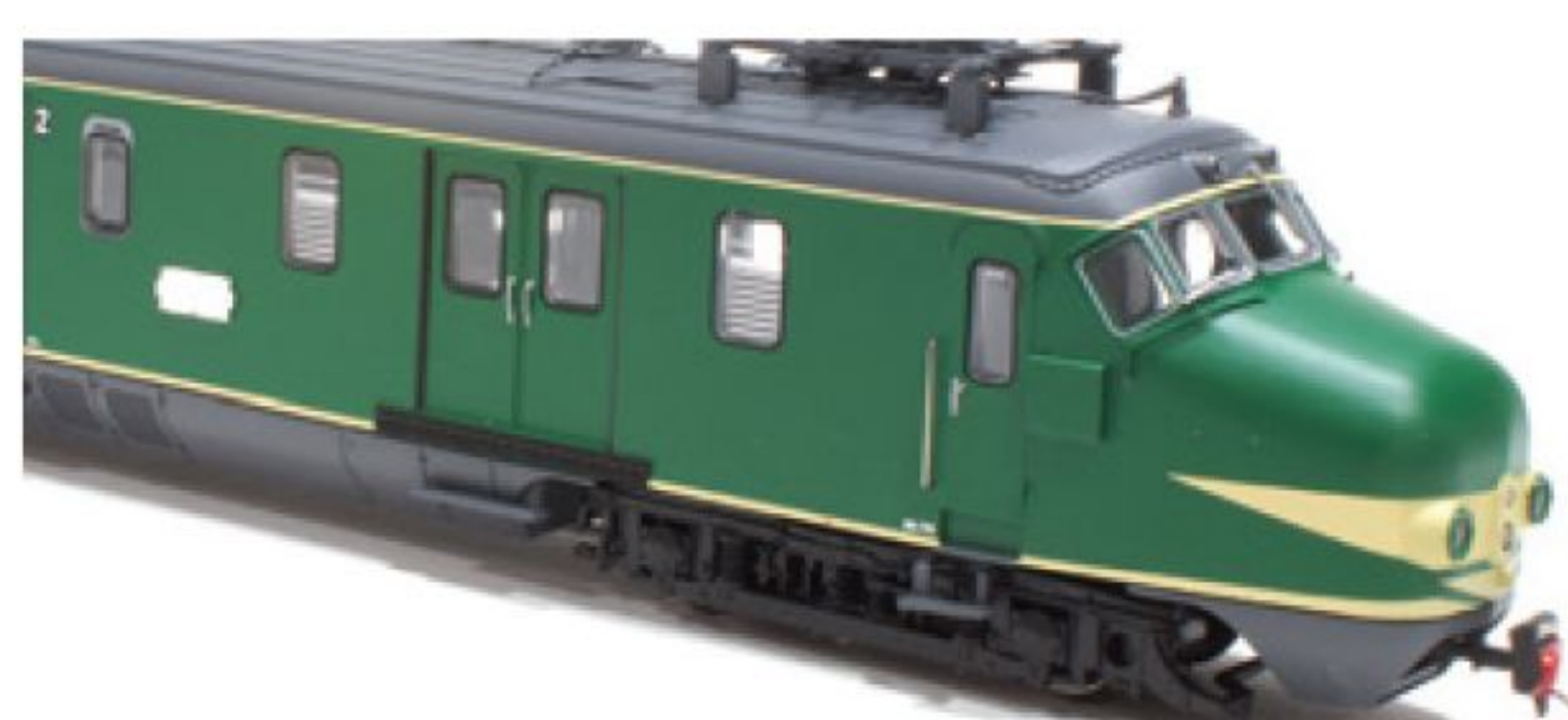
De rechterkant van de BDK. Stangen in de bagageruimte beschermen de ramen, rubbers de deuren tegen perronkarren.
