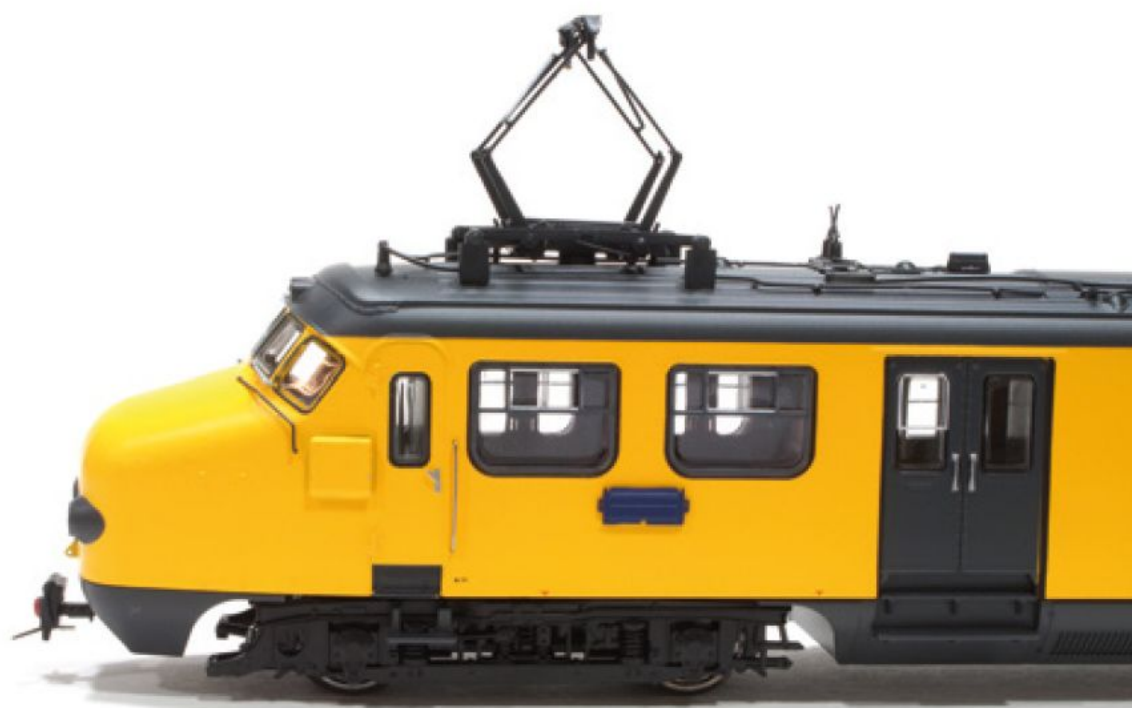
De neus van de Bk met messing sleepoog in profiel.
