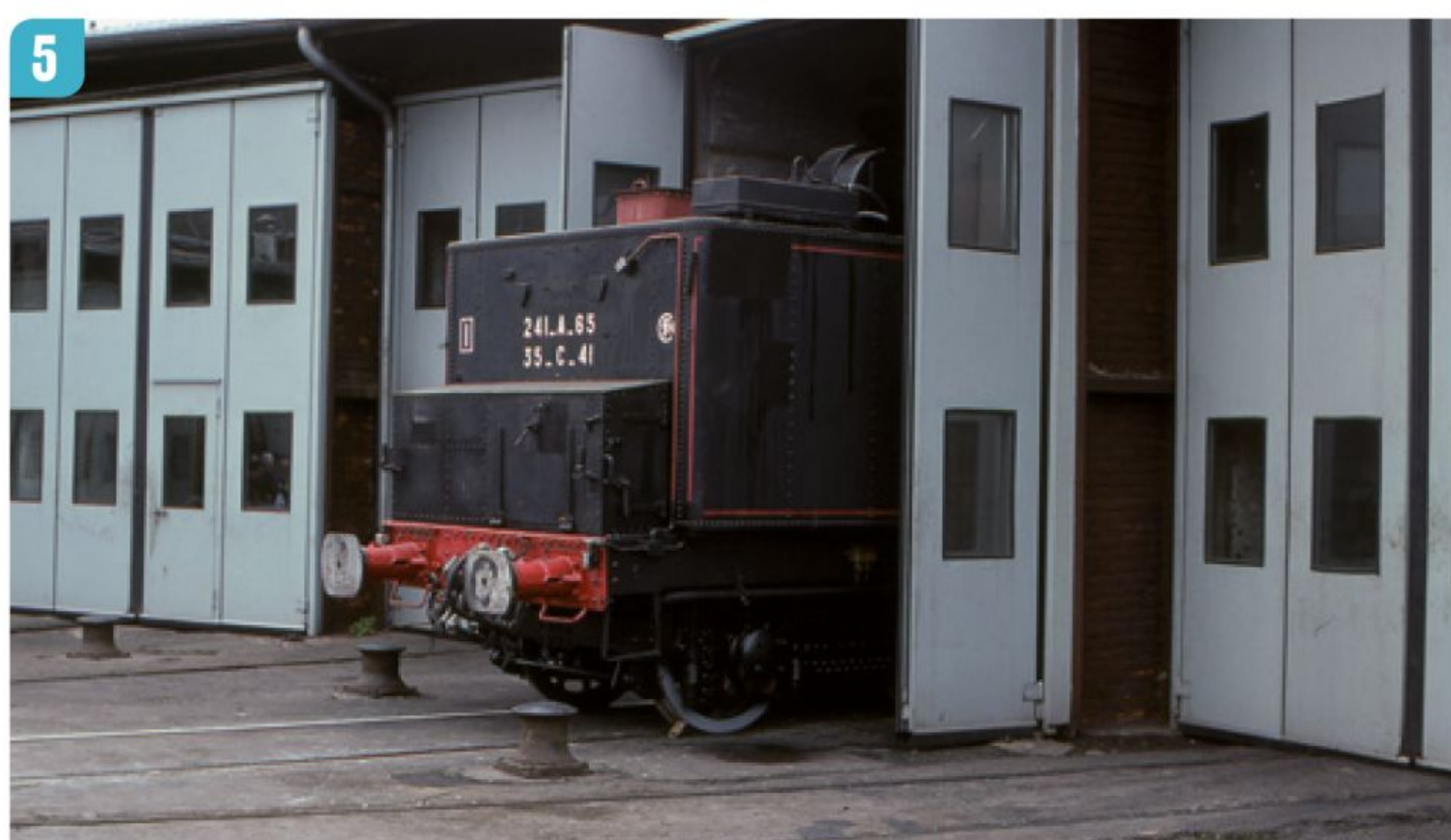
Museumloc 241-A-65 staat naast de 50 35. Het verschil in grootte is duidelijk zichtbaar. Op de tender is het schuifmechanisme te zien waarmee de kolen naar voren worden gedrukt. Meiningen, 29 februari 1997. (foto Guus Ferrée)
