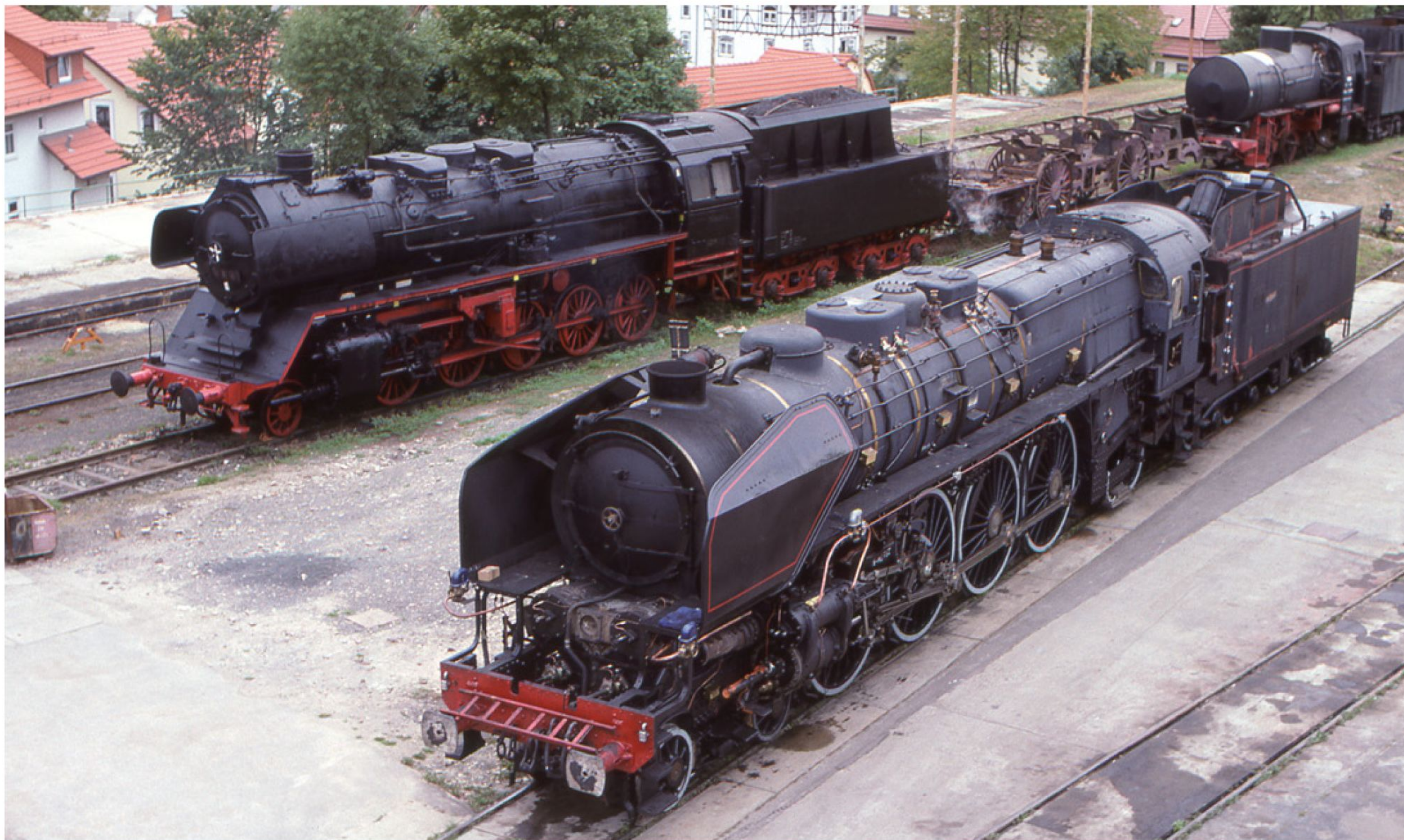
Museumloc 241-A-65 staat naast de 50 35. Het verschil in grootte is duidelijk zichtbaar. Op de tender is het schuifmechanisme te zien waarmee de kolen naar voren worden gedrukt. Meiningen, 29 februari 1997. (foto Guus Ferrée)
