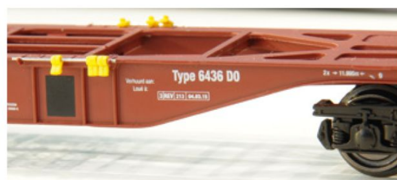
De klapsteunen van de Sggmrss 90 containerdraagwagen, B-Models.
