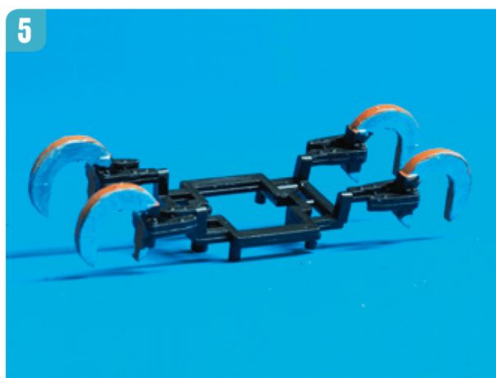
4. De beide veren zijn in het draaistelframe gemonteerd. 5. De 'gedecoreerde' schijfremmen voor de montage. 6. Het gemonteerde draaistel met de zandstrooiereservoirs.
