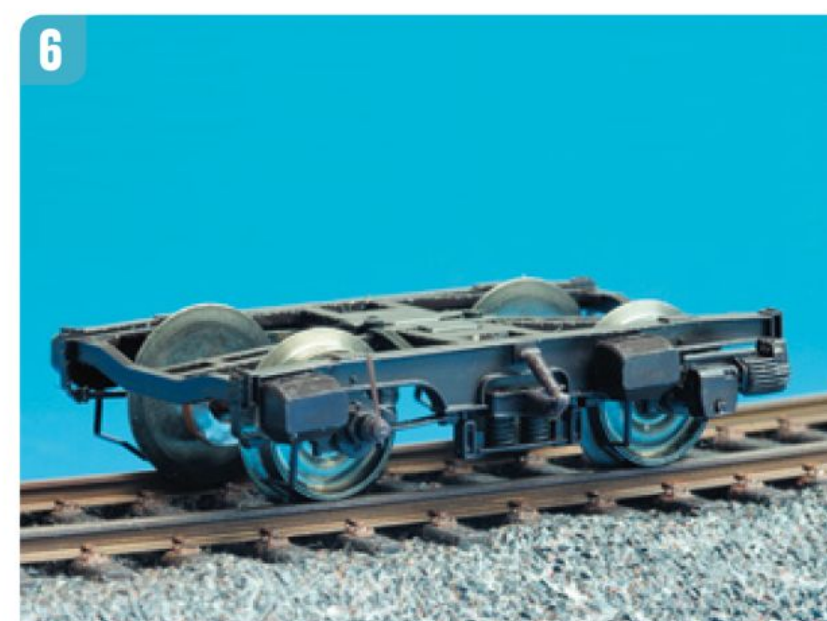
4. De beide veren zijn in het draaistelframe gemonteerd. 5. De 'gedecoreerde' schijfremmen voor de montage. 6. Het gemonteerde draaistel met de zandstrooiereservoirs.
