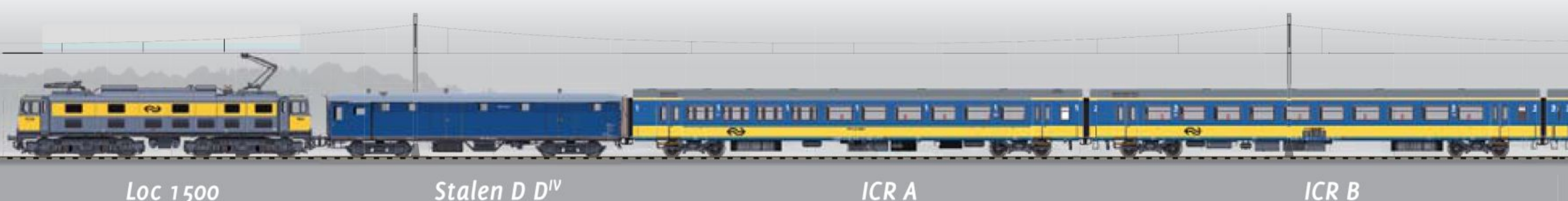
De eerste nieuwe ICR's gaan naar de verbinding Randstad – Venlo/Keulen. In de winterdienst 1980/1981 rijden de treinen nog zonder BKD, maar met een Stalen D, voorzien van een dakleiding.
