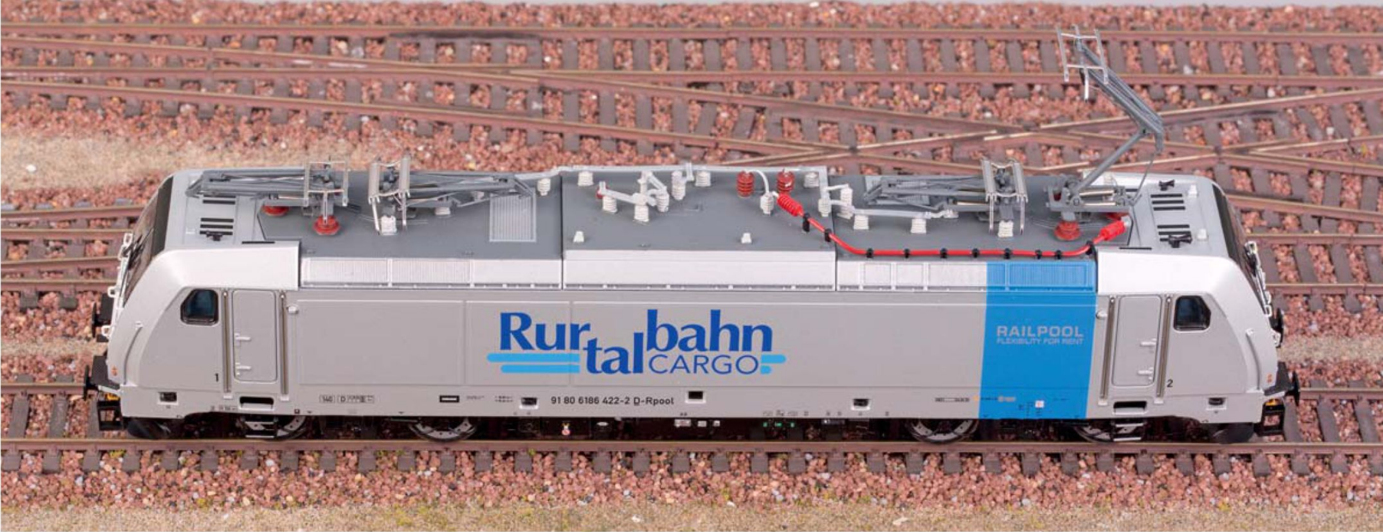
Veel details op het dak in de vorm van leidingen, isolatoren en schakelaars.
