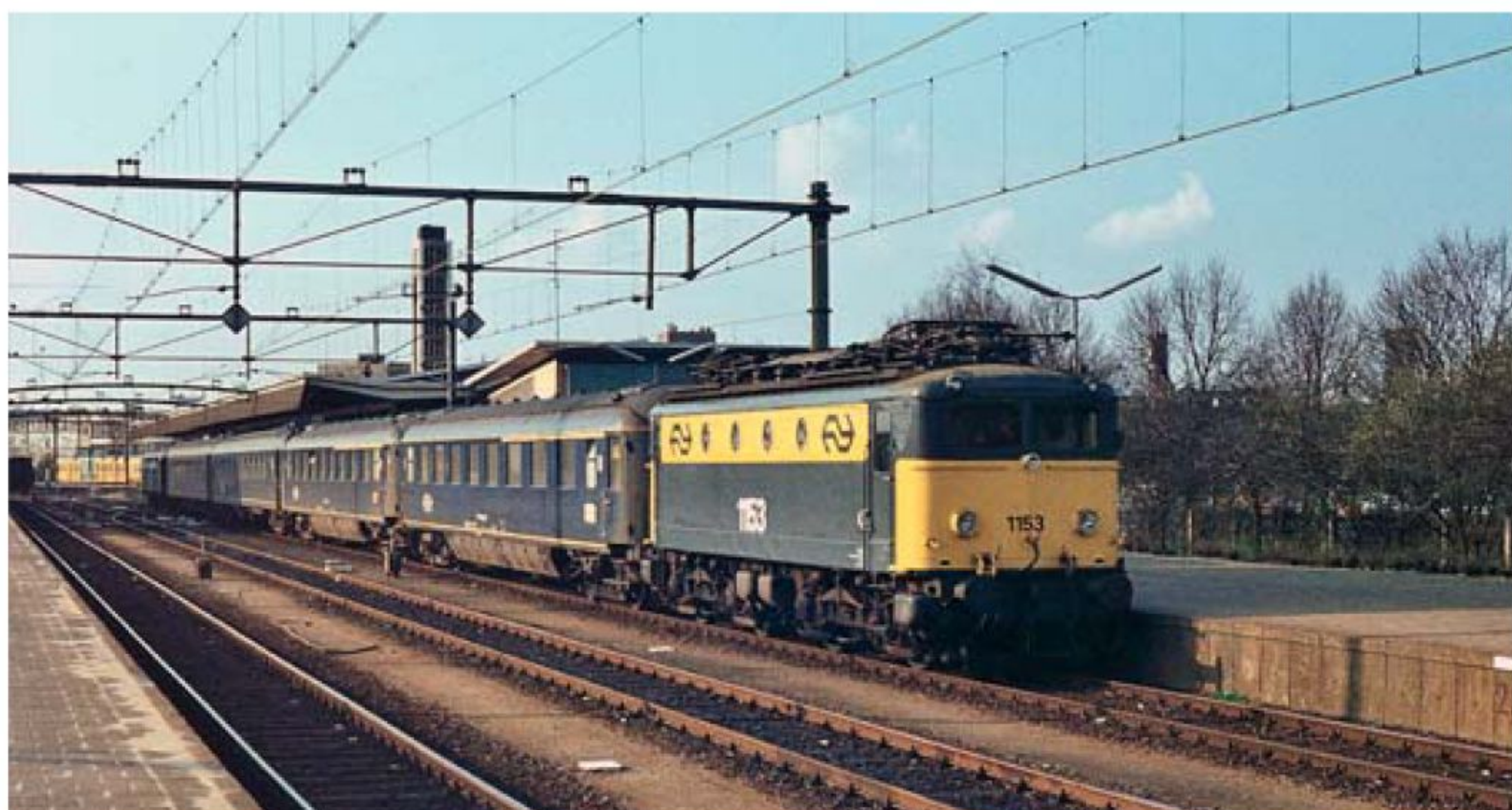
Loc 1153 komt met Intercity 2521 Den Haag – Köln aan in Venlo. De stroomafnemers zijn gestreken, omdat de loc al onder 25 kV rijdt. Sik 350 sleept de loc straks naar het 1500 V-deel van het Venlose station. De standaardstam bestaat uit twee K's en twee N's en een Stalen D, 30 maart 1980. (foto Bart van 't Grunewold)
