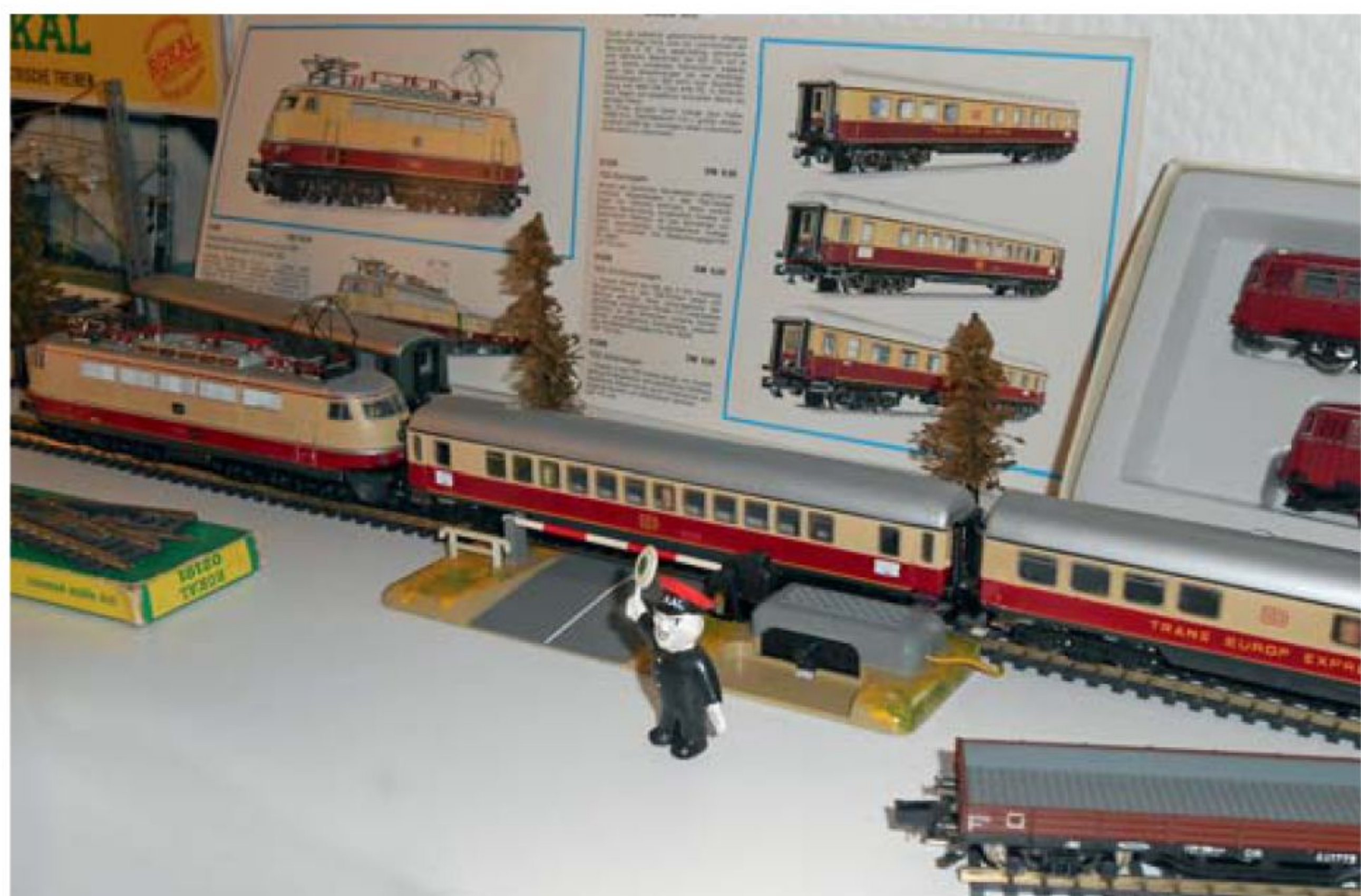
ROKAL TEE uit 1967. De rijtuigen werden ingekort om op wissels beter te kunnen afbuigen. (foto Rik Menting)
