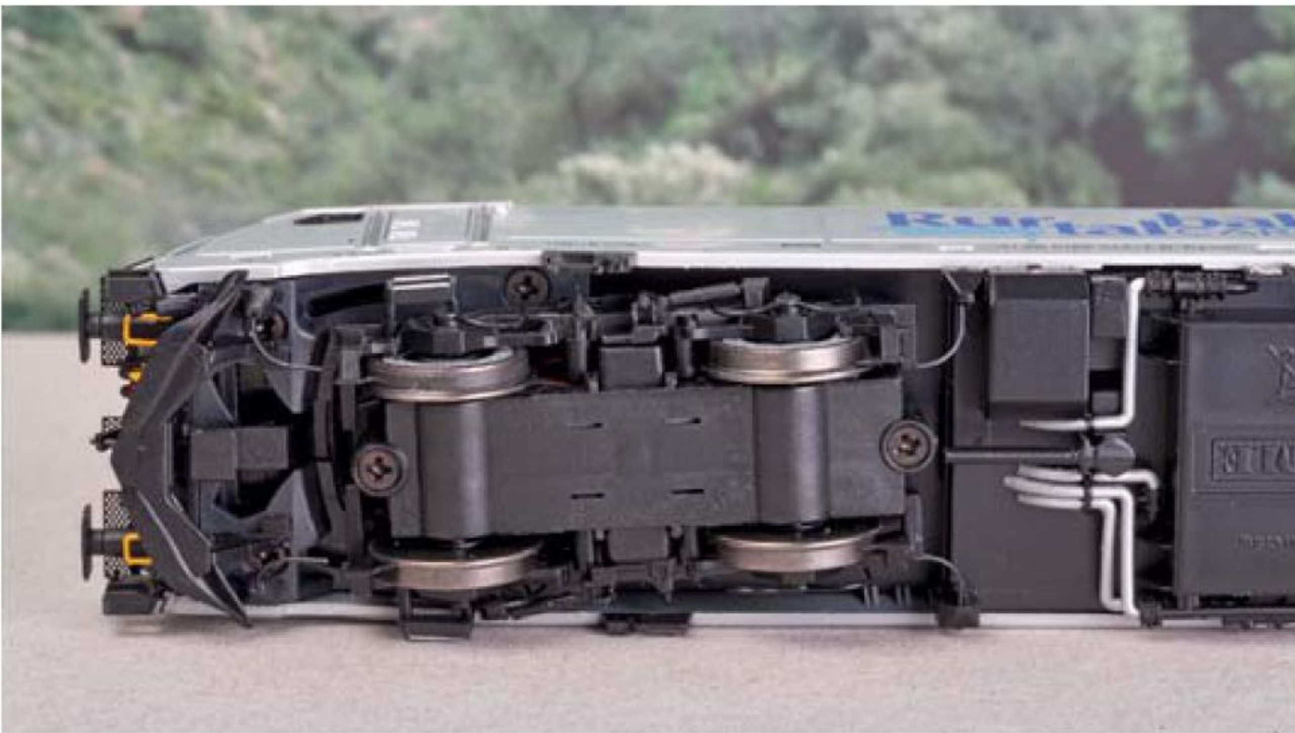
Een van de goed gedetailleerde draaistellen van de 186 met veel apart aangezette leidingen. Links is de NEM 362 koppelinghouder te zien. Net zichtbaar bij de wielen de stroomafnemers. Overigens kan de loc kan na omschakeling van dipswitches onder de kap ook van de pantografen voor de rijstroom gebruik maken, dat geldt echter alleen voor de analoge versie.
