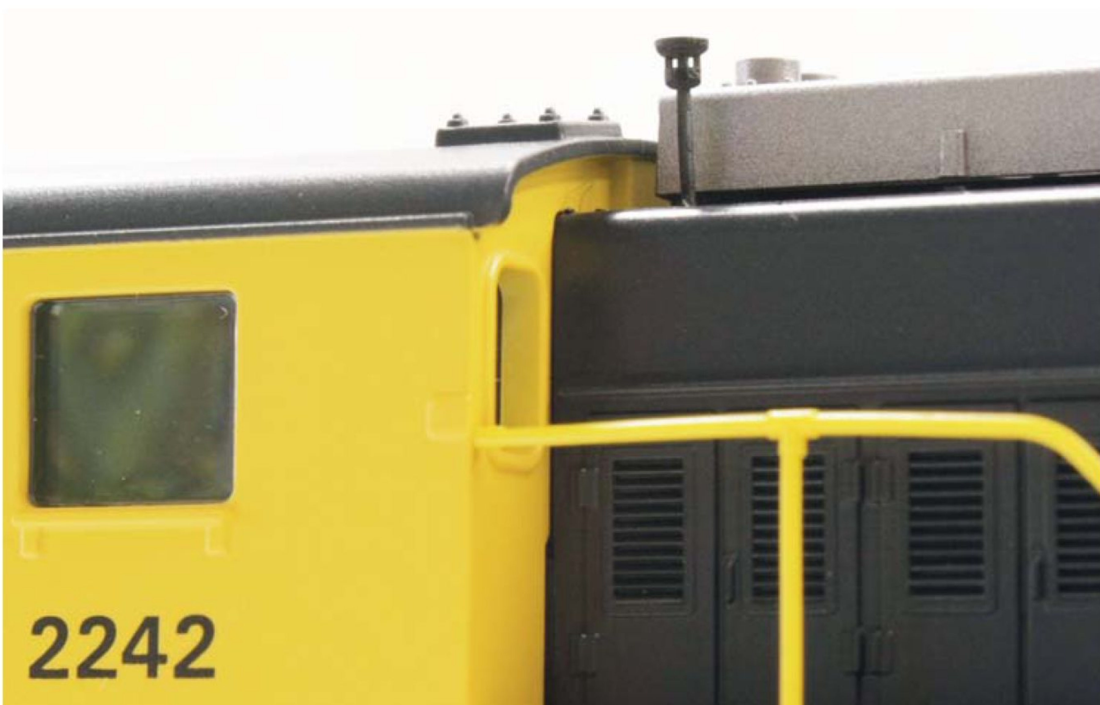
Schoorsteen voor de 2200 van Pijp-lines.
