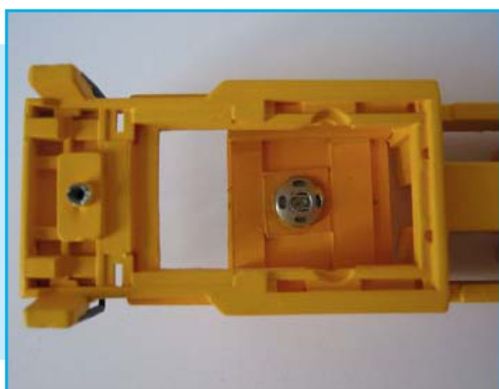
In de bak is een plaat styreen gemonteerd met daarop een simpele drukknop voor de bevestiging van het motordraaistel.
