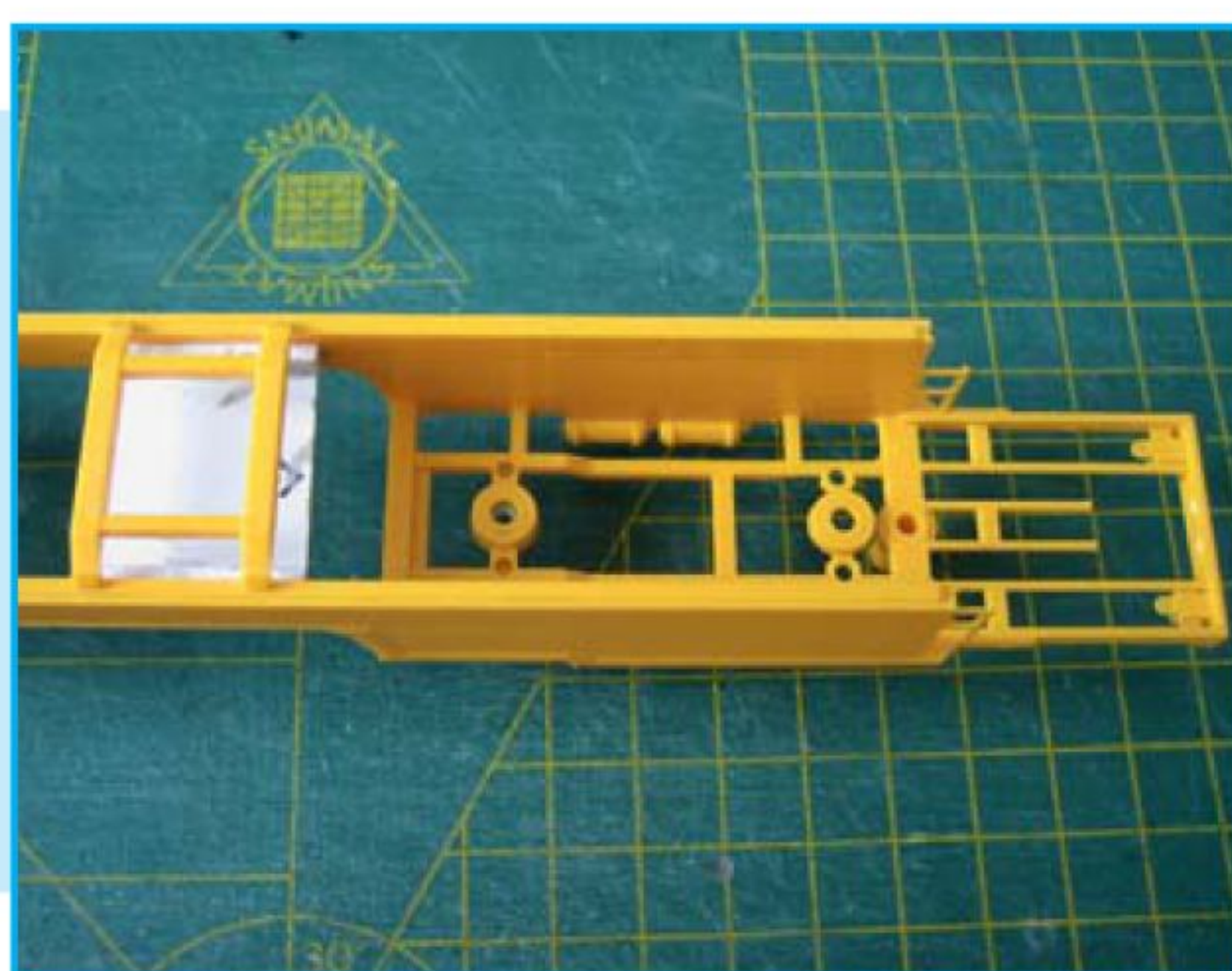
In de bak is een witte plaat gezet ten behoeve van de decoder.
