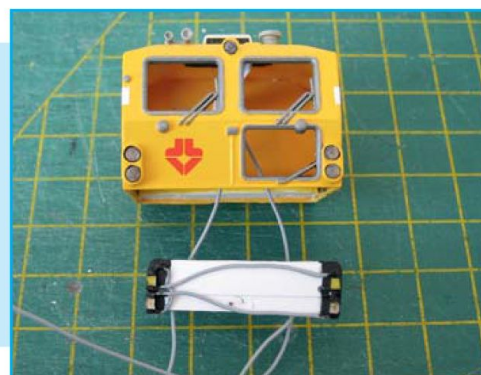
De ledbalk van cabine 1 met daarop 2 front- en 2 sluitseinen. Het derde, hoge frontsein zit op een aparte balk dat al in de cabine is bevestigd.
