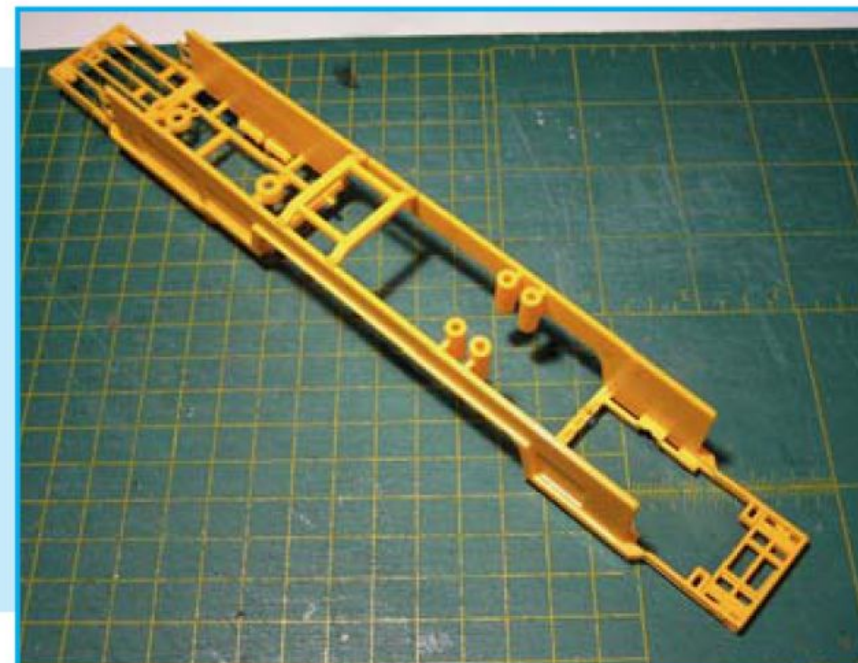
In het chassis van de stopmachine is de uitsparing voor het motordraaistel rechtsonder zichtbaar.
