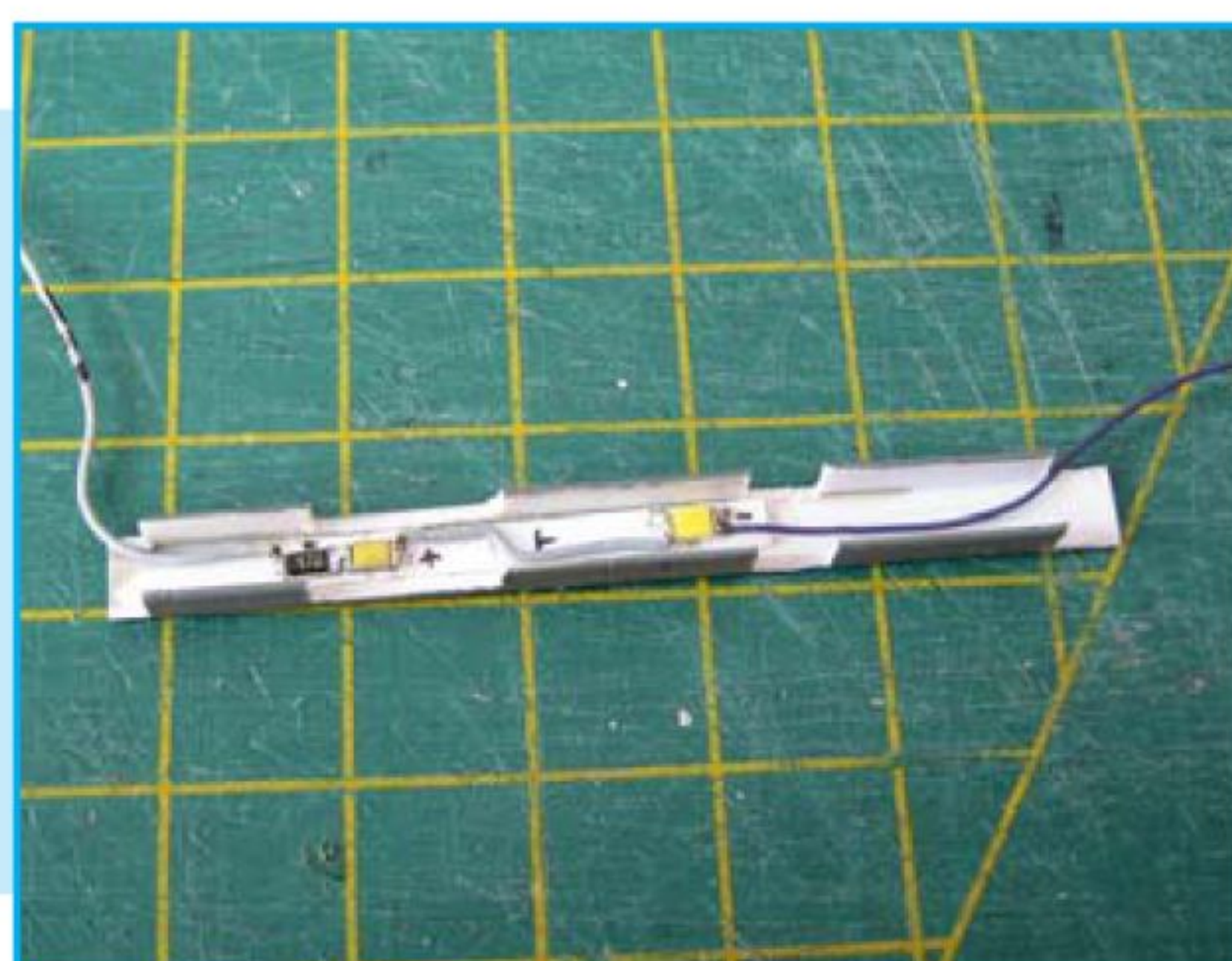
De balk met de werkverlichting zal boven de satelliet worden geplaatst.
