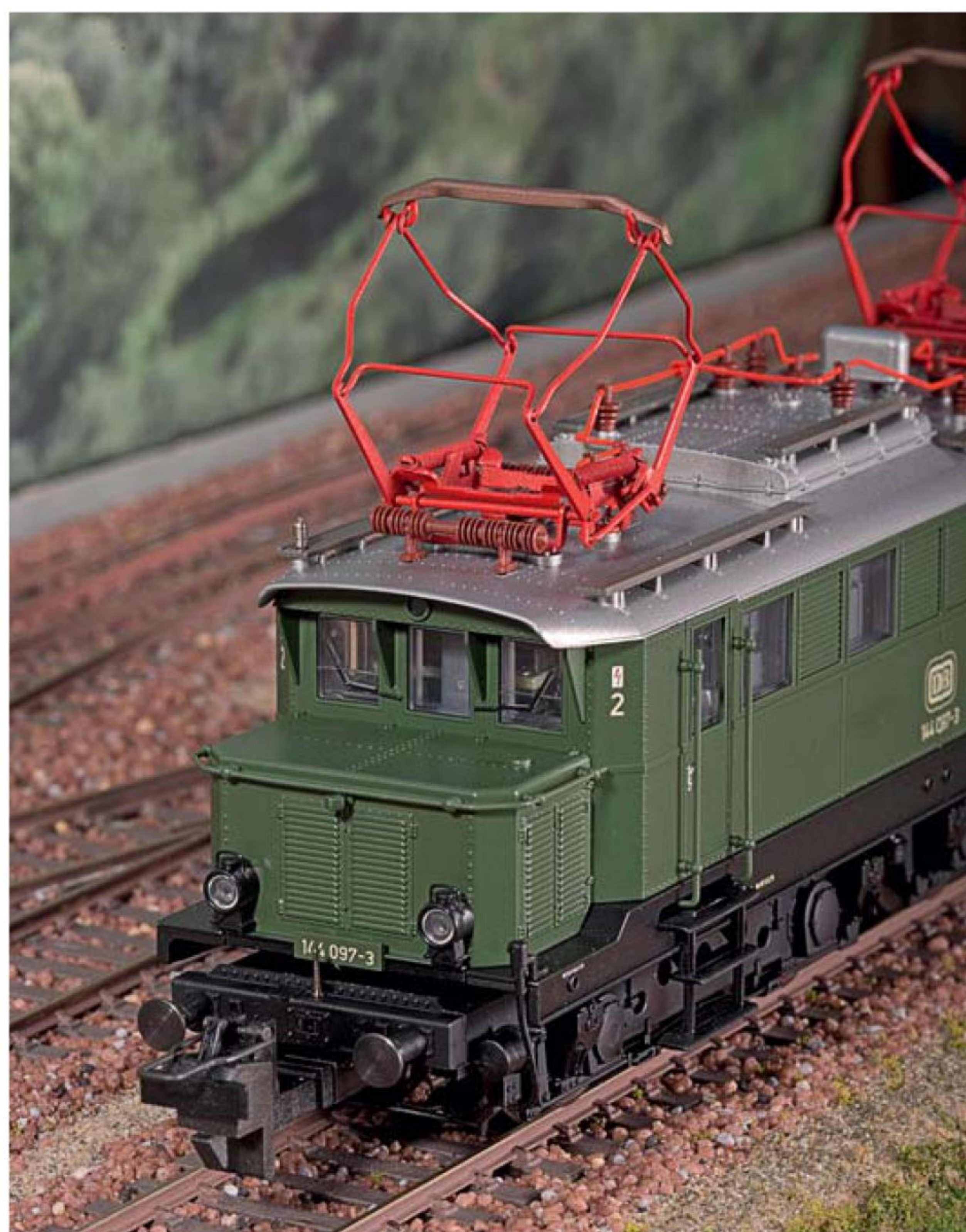
Los van het systeem, net als bij de Nederlandse NS 1100 zit de bufferbalk vast aan het draaistel.
