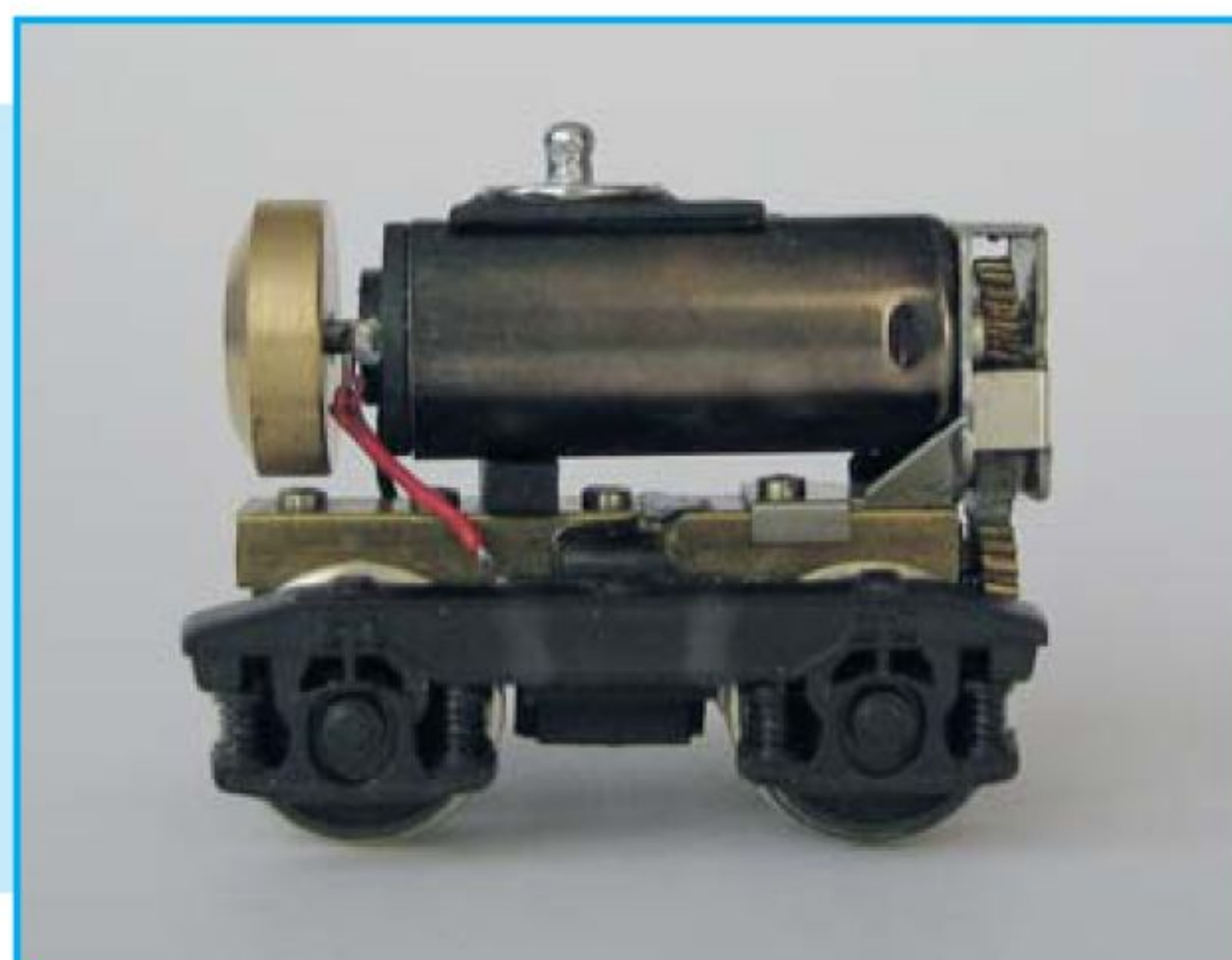
Het draaistel met gemonteerde Mashima-motor met bovenop de drukknop waarmee het kan draaien maar ook eenvoudig kan worden uitgenomen.
