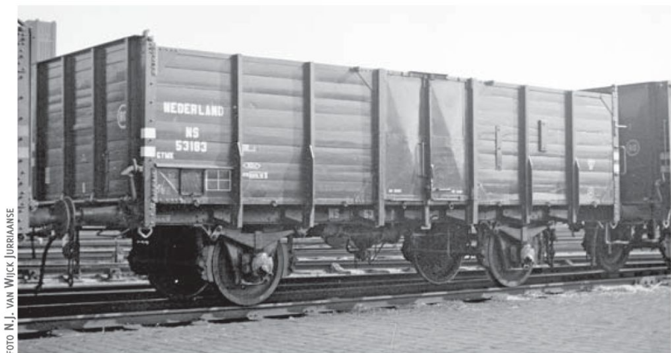
Ex-SS GTMK 53183 met verstijvingsplaten en nieuw aangebrachte Kkg-rem. Utrecht 7 maart 1949.
