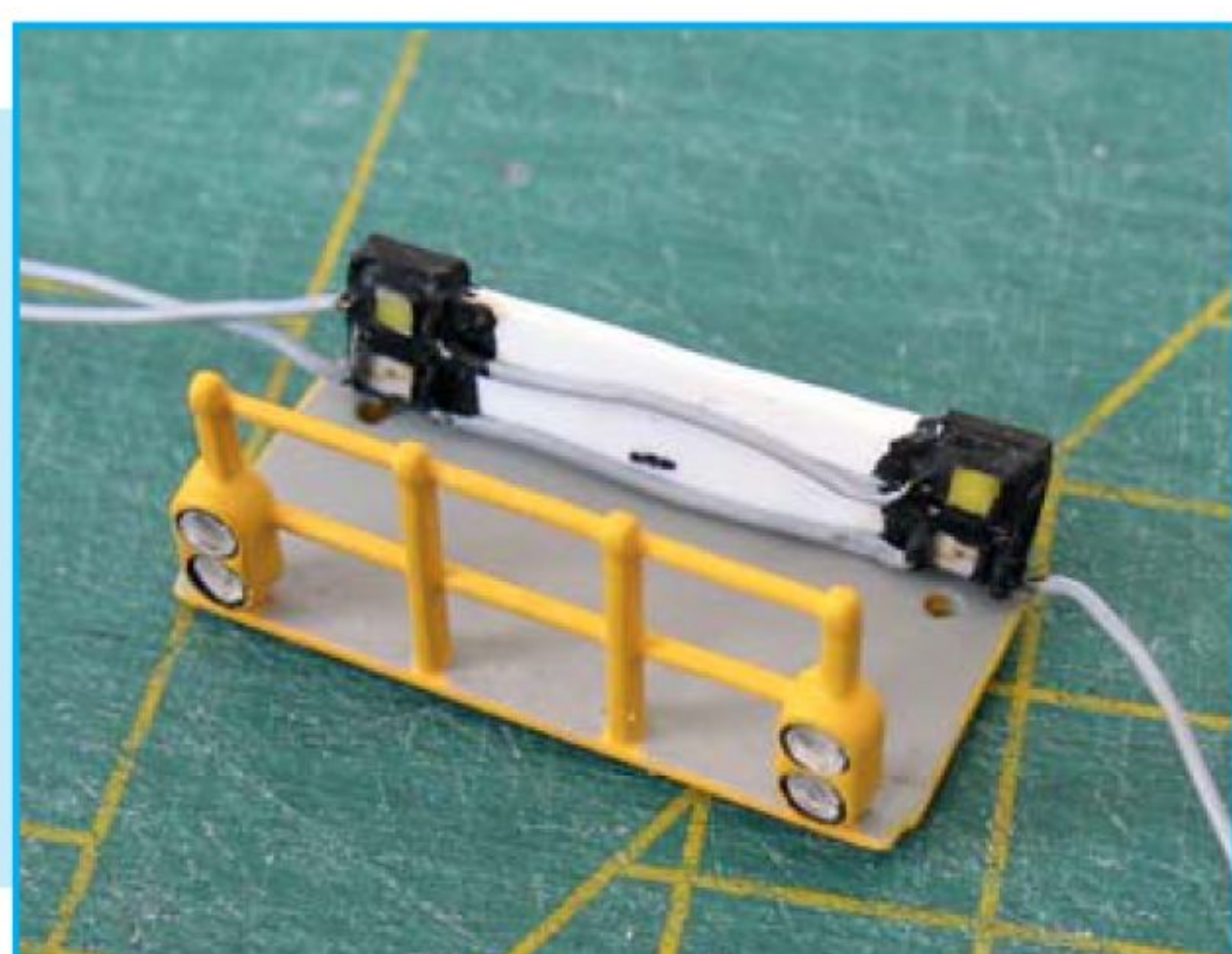
De balk met front- en sluitseinen voor cabine 2 wordt achter het hekwerk van de aanhanger geplaatst.
