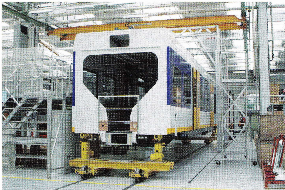
Bij Siemens in Krefel-Uerdingen worden de tussenbakken voor de zesdelige Sprinters van de serie 2600 gebouwd.
