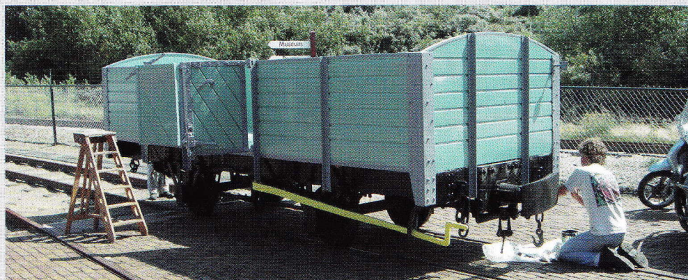
In een stralend zonnetje wordt voor de overdracht de laatste hand aan de 458 gelegd. Types aan deze bouw zijn de halfronde kopschotten en het Belgische remsysteem dat nog uit 1898 dateert, Ouddorp zomer 2007. (foto Mark Grotendorst)
