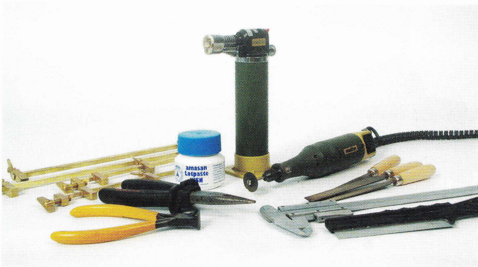
Het gereedschap: brander, messing klemmen, tangetjes, vijlen en een miniboormachine.
