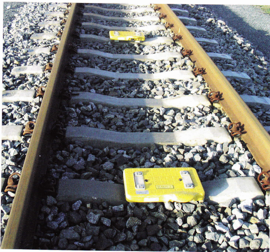
Een passieve Eurobalis, dus zonder aangesloten kabels, gefotografeerd op de Betuweroute.
