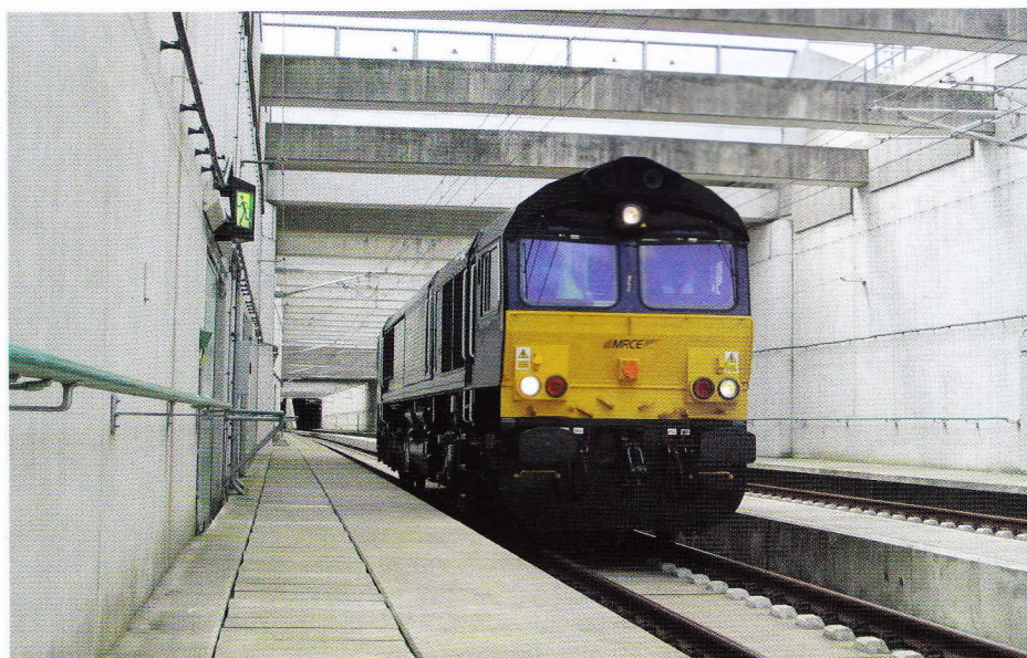
De ACTS-diesellocc 7104, type MaK G1206, voorzien van een door Alstom geleverde ETCS-installatie, is veel gebruikt voor het uitvoeren van duurtests.
