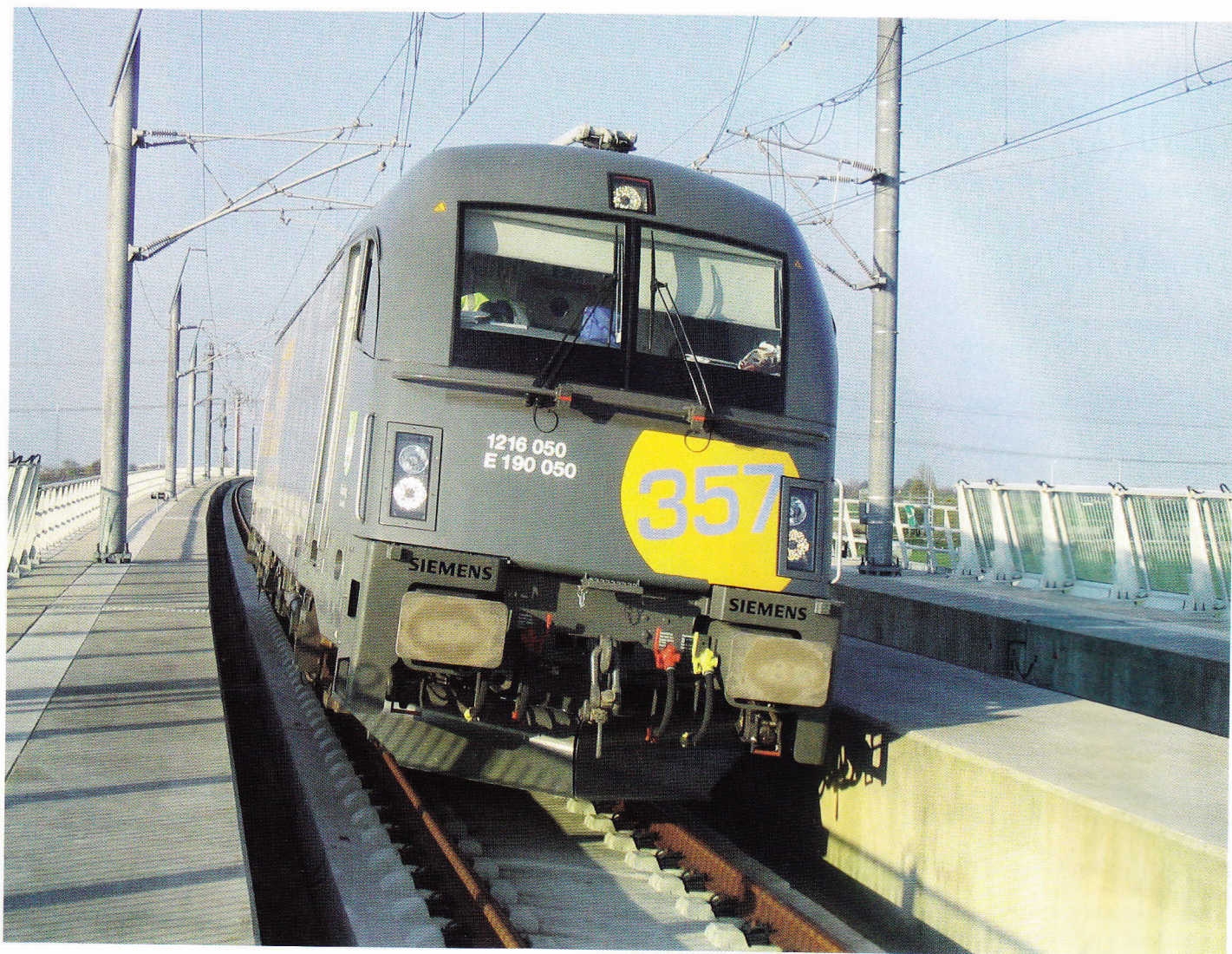
De Taurus onderweg naar Rotterdam. De loc staat tamelijk schuin door de sterke verkanting die bij de hoge snelheden nodig is.
