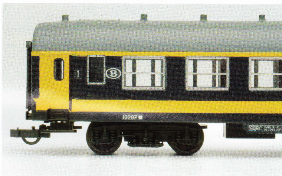
Detail van de Belgische rijtuigen: bij gebrek aan beter zijn de Franse draaistellen door Oostenrijkse Schlieren-draaistellen vervangen.
