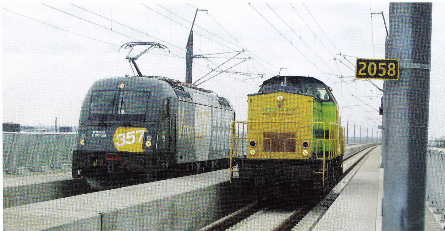
Twee testlocomotieven op de HSL: de ÖBB-Taurusloc E190.050, die het wereldsnelheidsrecord van 357 km/h voor locs op z'n naam heeft staan, naast de RRF18 diesellocc, een ex-BR 203 met slechts een maximumsnelheid van 100 km/h.
