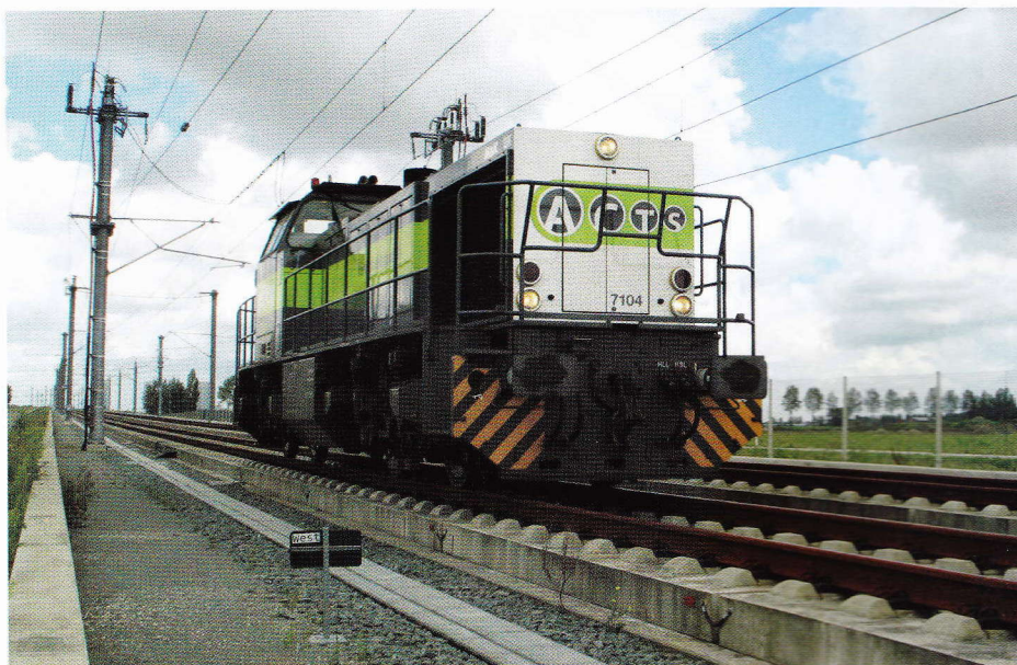
De ACTS-diesellocc 7104, type MaK G1206, voorzien van een door Alstom geleverde ETCS-installatie, is veel gebruikt voor het uitvoeren van duurtests.
