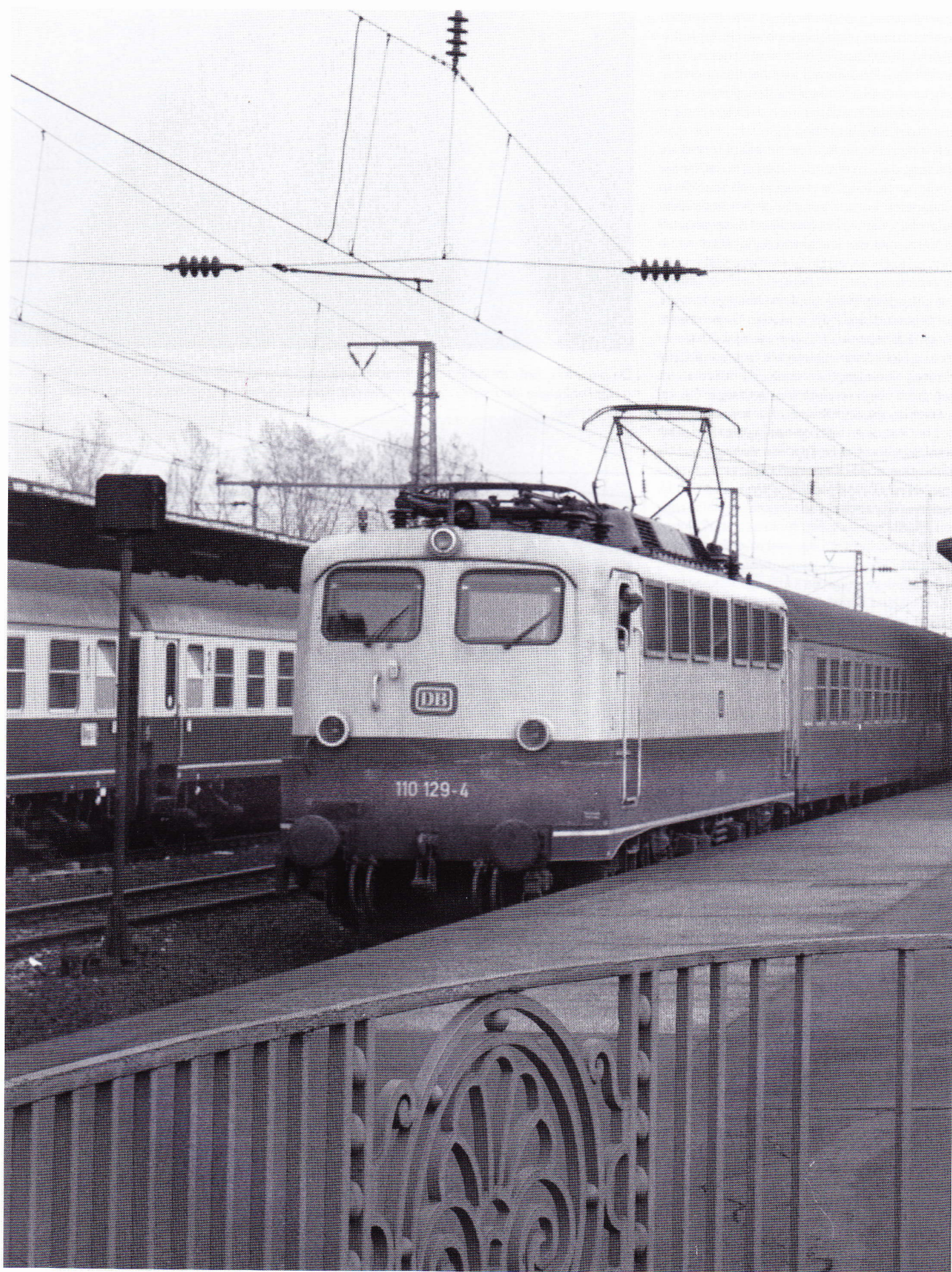
De 110 129-4 werd op 29 maart 1989 gefotografeerd in Keulen. In tegenstelling tot het Minitrix-model heeft deze loc gecombineerde front- en sluitseinen en geen handgrepen onder de ramen.
