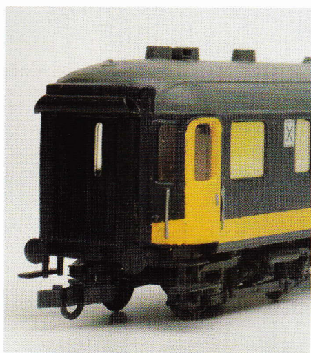
Aan de restauratiezijde is de ouderwetse vouwbalg door een buisbalg vervangen. De NS-werkplaats Tilburg bouwde hiervoor een speciale constructie op de kop.
