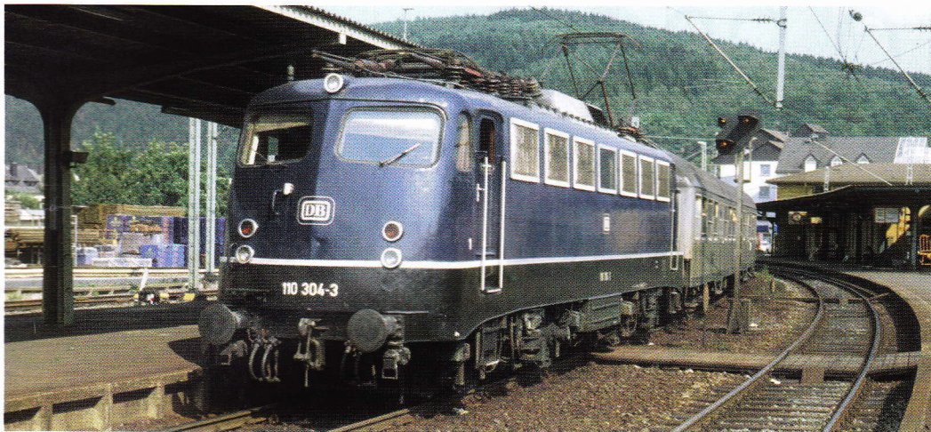
De 11 304-3 te Betzdorf op 2 augustus 1991. Let op de andere frontseinen en de iets gewijzigde omlijsting van de vensters. (foto Nico van Roon)
