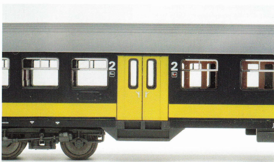
Na een grote revisie werden alle bewegende delen van de Plan W-rijtuigen geel geschilderd. Roco heeft dat ook op het model gedaan.
