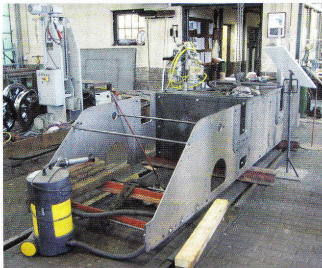
De basis van het vakkundig geconstrueerde frame van de toekomstige loc. Voordat dat er gereden wordt, zullen er waarschijnlijk nog wel wat jaren verstrijken. (foto RE)
