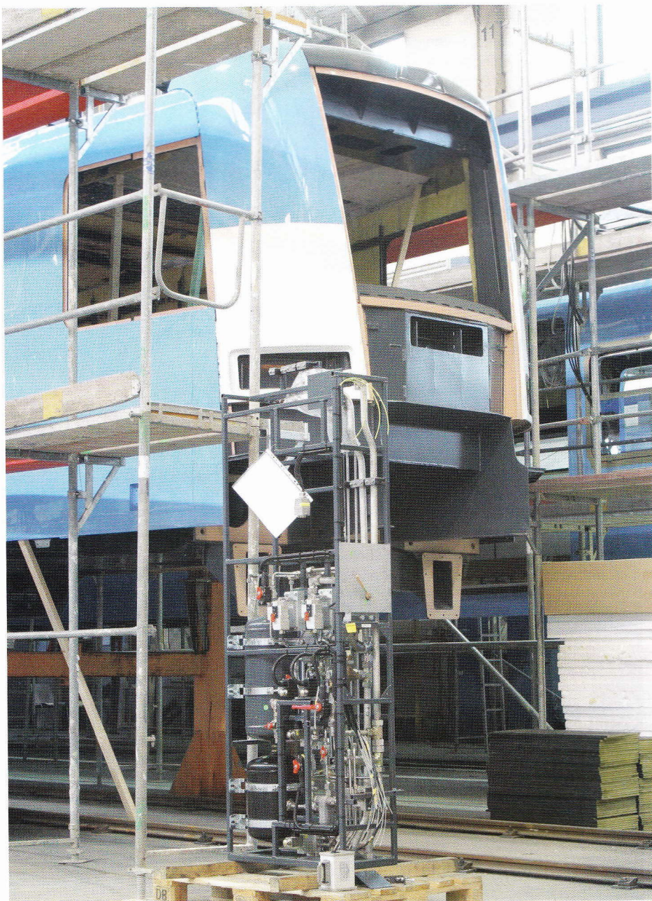
Tijdens de bouw staat de Protos stevig in de steigers. De reminstallatie wacht om te worden ingebouwd.
