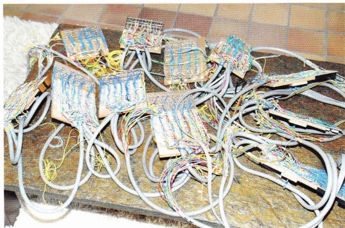
De 11 onderling reeds verbonden printplaten uitgesteld in de huiskamer en gereed voor montage in de kast.
