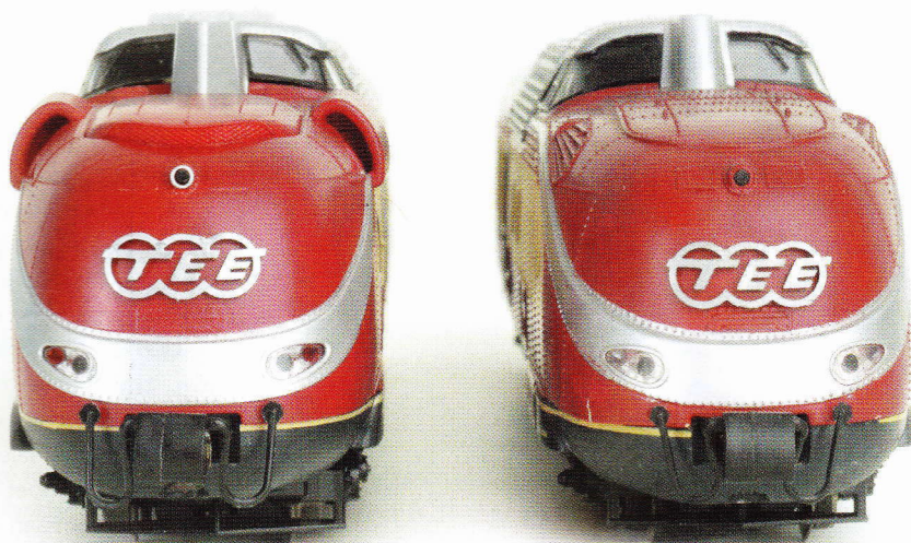
Het model van VT 602 en de VT 11.5 van voren gezien. Duidelijk verschillend zijn de grote luchtinlaten op de neus van de 602. Of het er allemaal mooier op is geworden is de vraag. Imposant is het wel...
