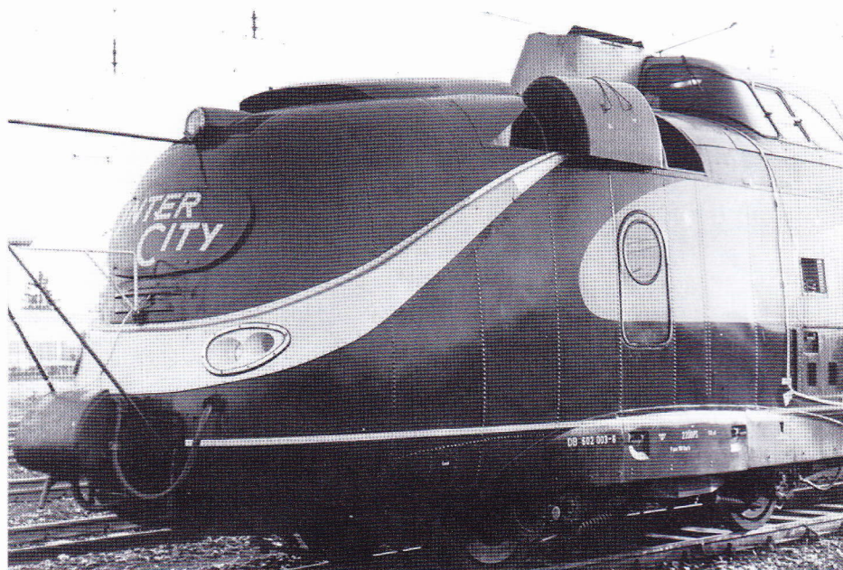
Na de verbouwing tot gasturbinemotorwagen zag de kop van de 602 003-6 er uiterlijk heel anders uit. (foto DB, collectie Eisenbahn Magazin)
