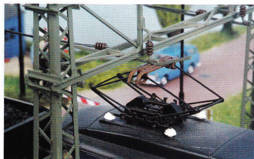
De omhoog gebogen strip vangt de pantografen op.
