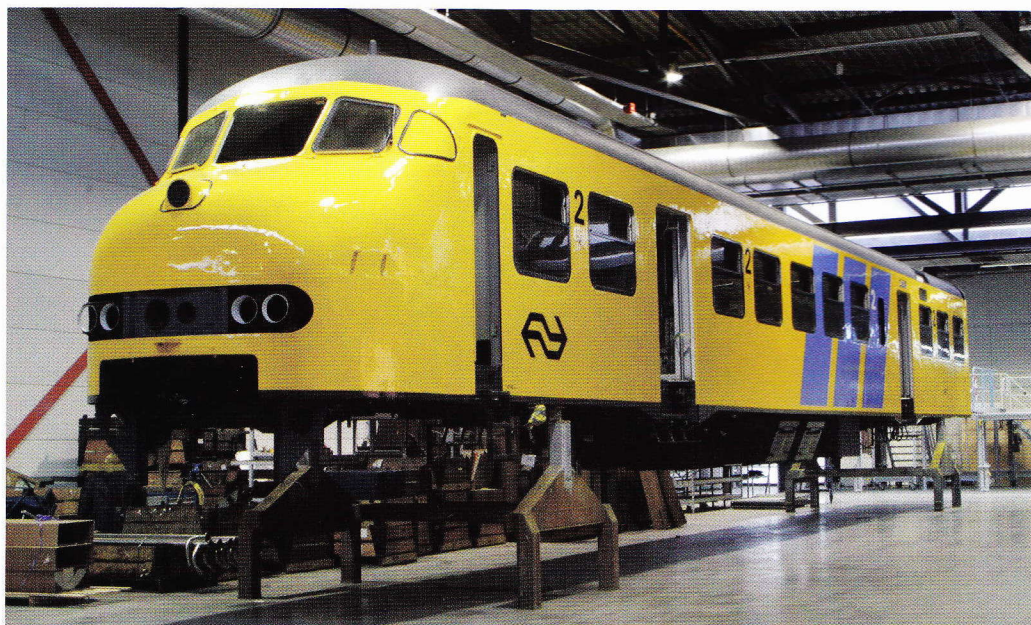
Het stuurstandrijtuig ontstaat na het wegsnijden van dit deel van het ICR-rijtuig. (foto Guus Ferrée)
