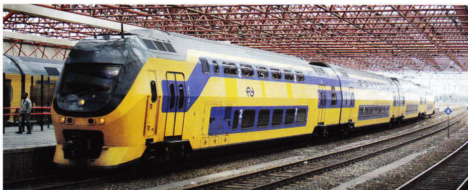
De VIRM-vierwagenstellen onderscheiden zich van de DD-IRM-viertjes o.a. door de plaatsing van de pantografen op een van de tussenbakken. Zaandam, 14 augustus 2005. (foto Peter Wijshake)
