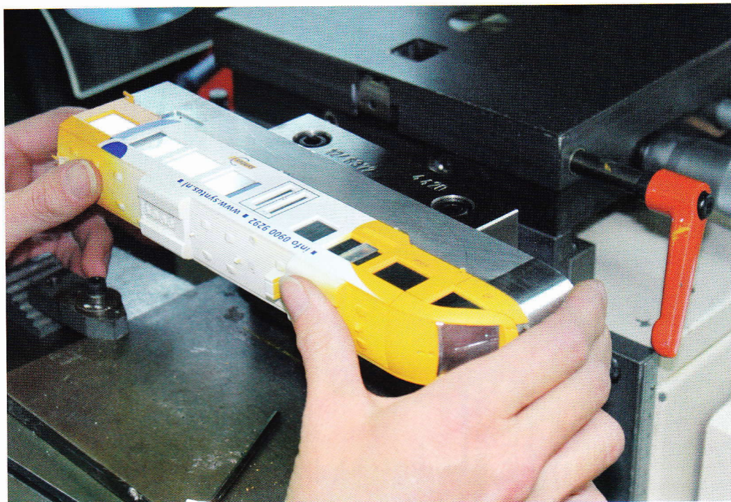
Een bak van Syntus wordt onder een tamponneermachine geschoven. Elk model wordt twintig keer bedrukt alvorens het klaar is.
