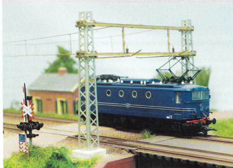
De eindportalen bestaan uit twee Sommerfeldt-masten met ertussen een zelfgebouwde dwarsverbinding.
