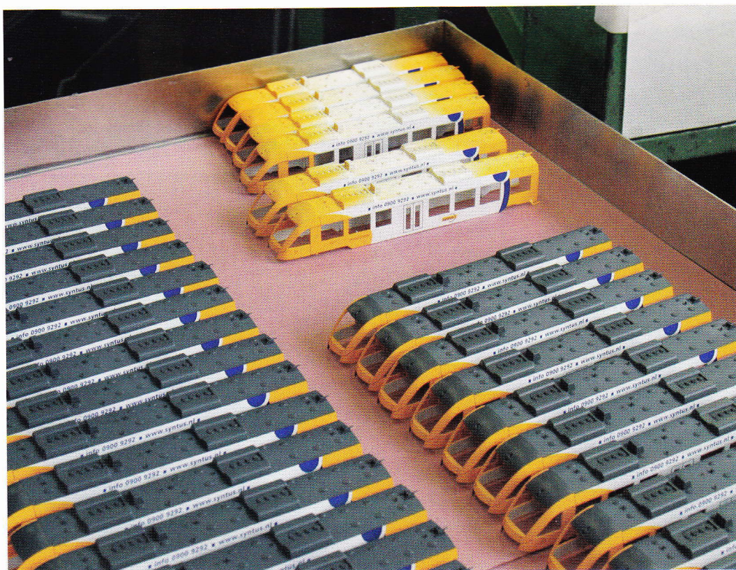
Een groot deel van de daken is inmiddels gespoten. Slechts drie vrouwen in Heilsbronn zijn deze techniek machtig.
