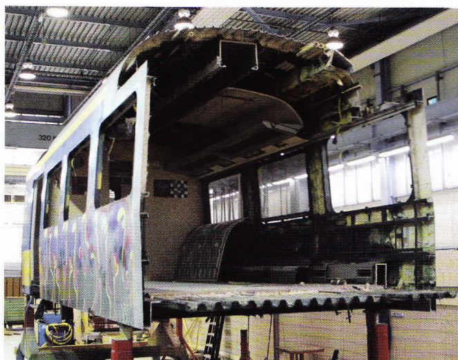
Het stuurstandrijtuig ontstaat na het wegsnijden van dit deel van het ICR-rijtuig. (foto Guus Ferrée)
