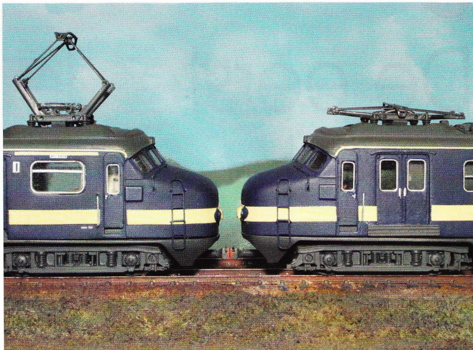
Op de ABKk (links) staat de 'Nederlandse' pantograaf, op de Bk de 'Belgische'. Let op de rubberen stootstrip onder de deuren van de kleine bagageruimte van de Bk (geen BDk, daarvoor was de bagageruimte te klein).
