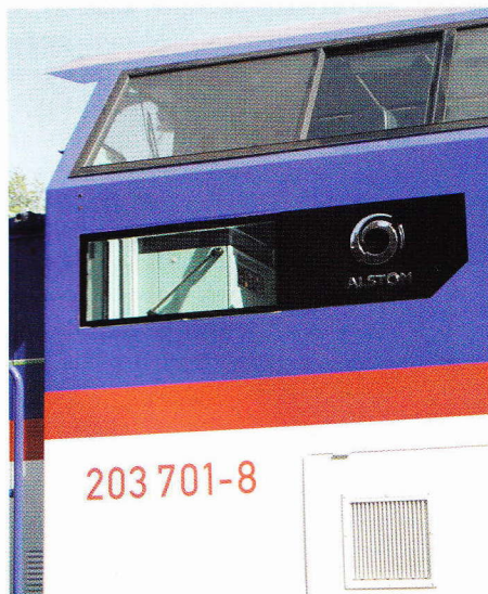
Duidelijk is te zien dat er een extra zijraam in de cabine is aangebracht. Dat voorkomt een dode hoek voor de rangerende machinist.
