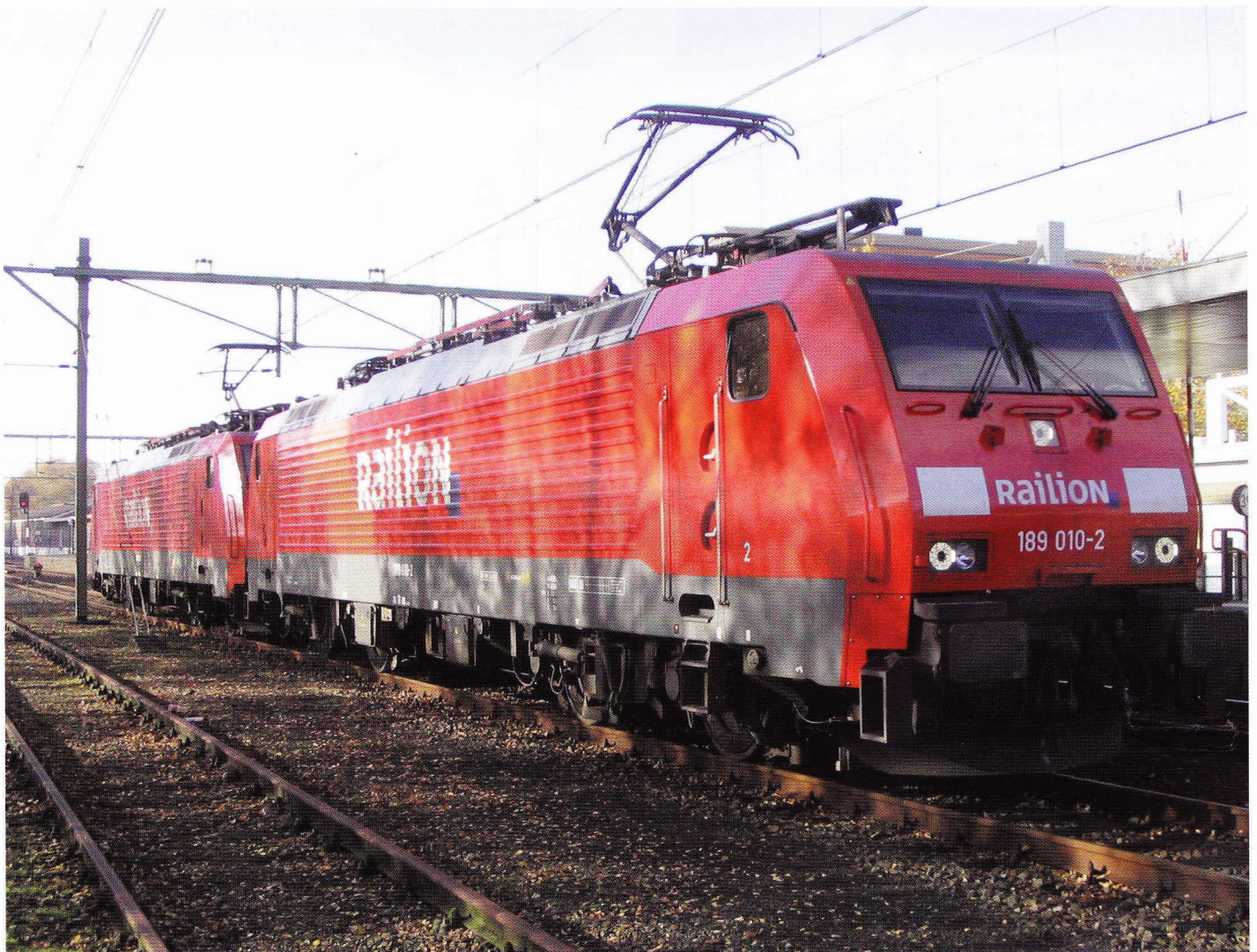
De proeven werden gehouden tussen Helmond en Horst-Sevenum. Hier de twee locs BR 189-010 en 013 vlak voor vertrek uit Helmond. De stroomafnemers staan hier in de configuratie 1-3.
