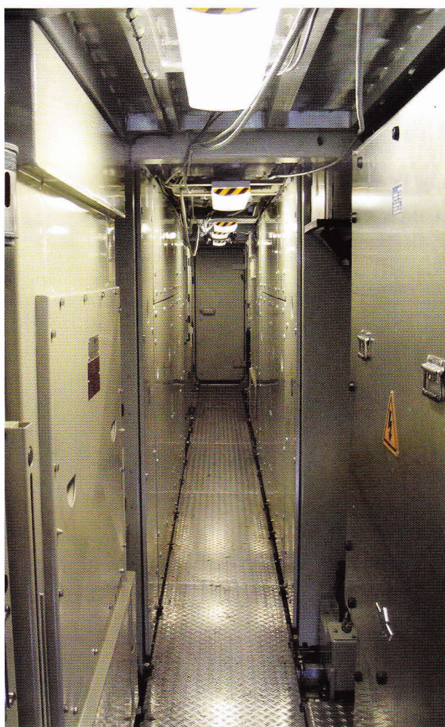
De middengang van de BR 189. Wie wel eens een eloc 1600, 1700 of 1800 van binnen heeft gezien, valt direct op hoe keurig hier alles achter panelen is weggewerkt, dit in tegenstelling tot een loc van Franse makelij. Het kastje van de ATB-installatie was te vinden links aan het eind van deze gang, achter een kast. Langs het plafond lopen enkele kabels van het ATB-kastje.
