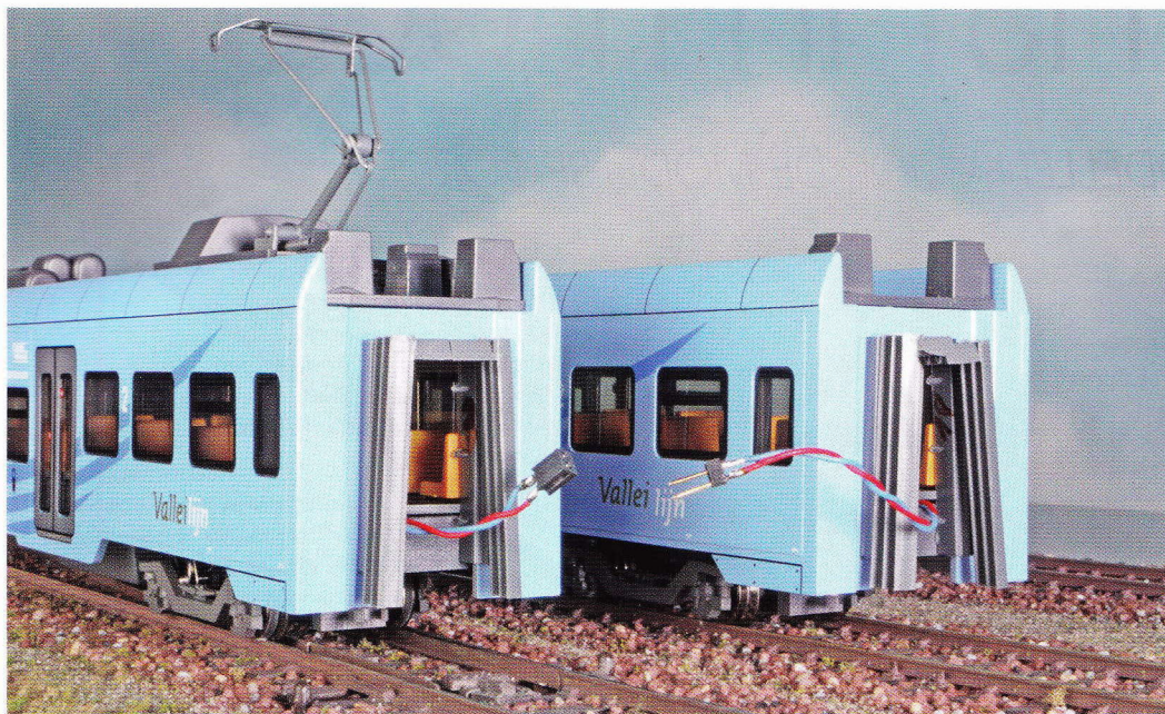
De bakken zijn met een stang, zonder kortkoppelgeleiding, aan elkaar vastgekoppeld. Een flexibele overgangsbalk aan beide bakken zorgt ervoor dat de trein als eenheid op de rails staat.
