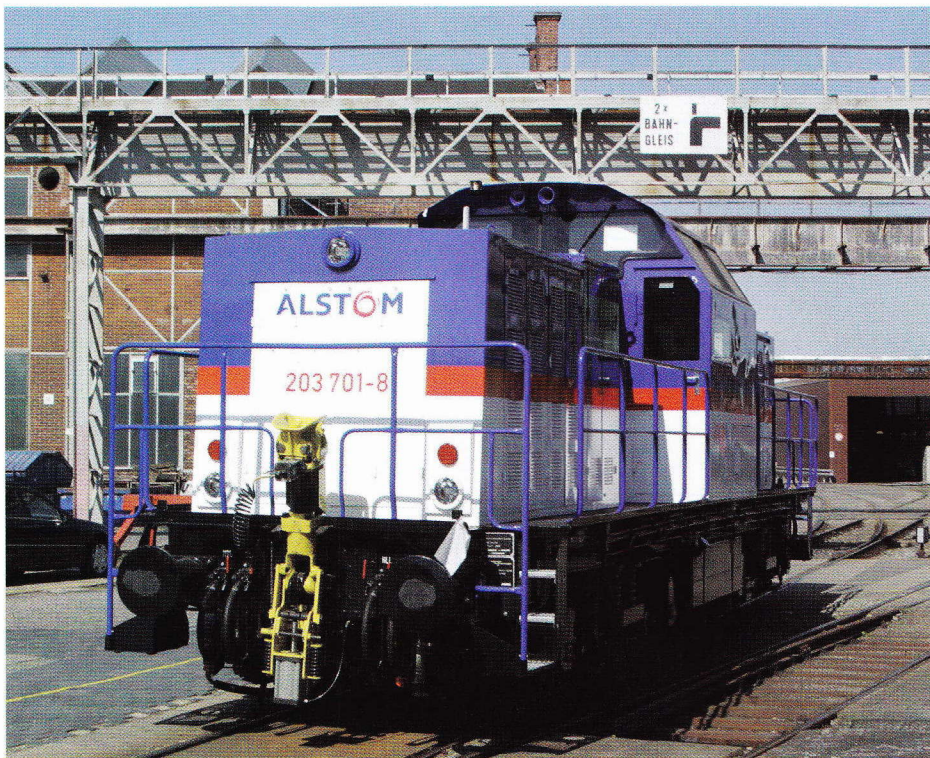
De cabine van de nieuwe hybride locomotief verschilt aanzienlijk van de gewone gemoderniseerde V100'en. De cabine is enkele centimeters breder gemaakt.
