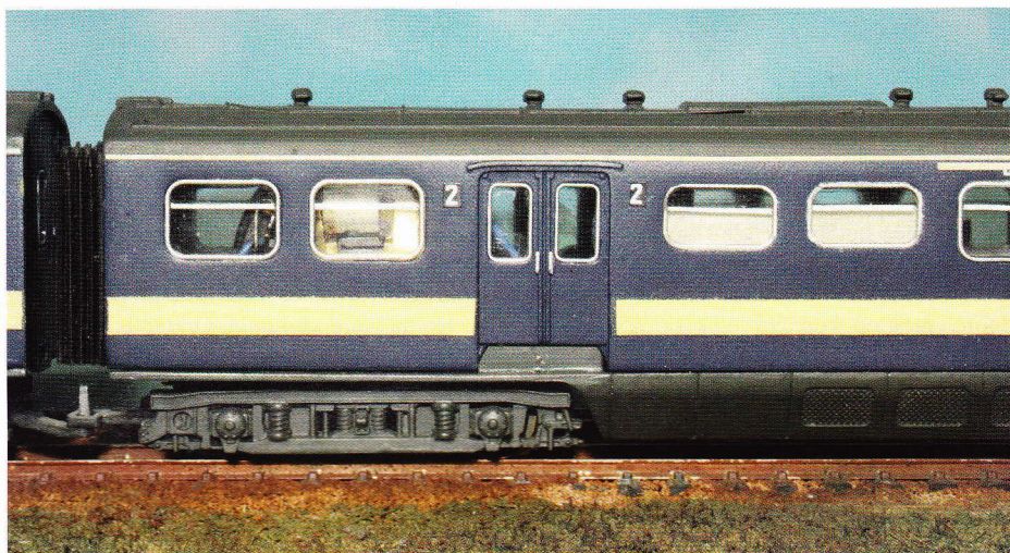
Tot medio jaren '70 waren de Benelux-treinstellen voorzien van een keuken. Twee ramen waren hiertoe kleiner uitgevoerd (direct rechts van de deuren), de onderzijde was wit. Wie niet wil slijpen en vijlen kan voor dit deel van het dak gebruikmaken van een tussenrijtuig.
