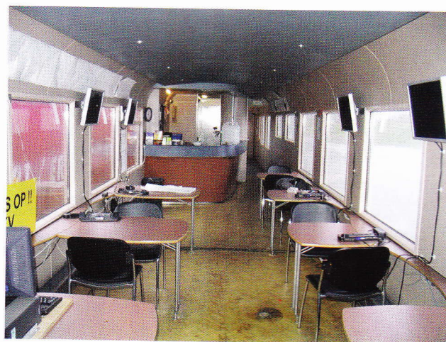
Het interieur van het testcentrum. Goed te zien is, dat het hierbij gaat om een voormalig buffetrijtuig van NS. In het rijtuig zijn grote beeldschermen opgehangen en kunnen diverse laptops worden aangesloten. Beelden van camera's in de cabine kunnen hier bekeken en geregistreerd worden.
