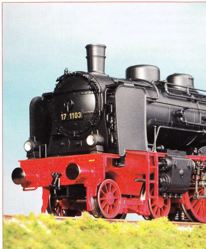
De BR 17.1 heeft een opvallend hoge bufferbalk, de frontseinen worden door een goed afgeschermd gloeilampje erg zwak verlicht. Let op de apart aangezette leidingen en handgrepen.
