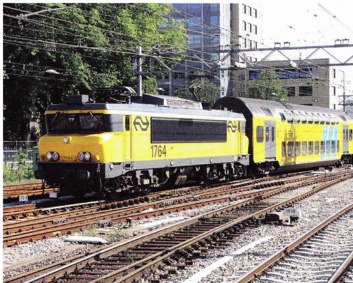
Op drukke stations als Utrecht CS is het een wirwar van wissels, seinen, enz. Op dit stukje spoor niet minder dan vijf genummerde wissels.
