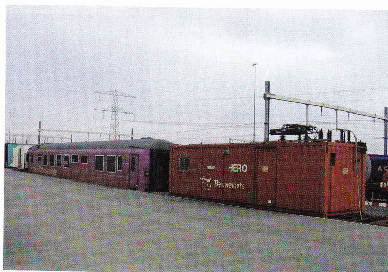
Bij veel testen rijdt het testrijtuig, ook wel testcentrum genoemd, mee. Rechts van dit rijtuig is de meetcontainer te zien, waarmee testen van de bovenleiding uitgevoerd kunnen worden.
