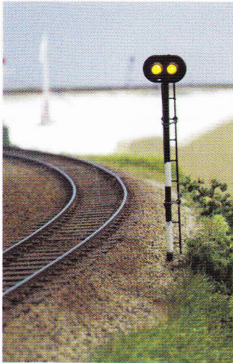
Leuk voor erbij: een naderingssein of Wubo. Het sein gaat knipperen wanneer er een trein nadert.
