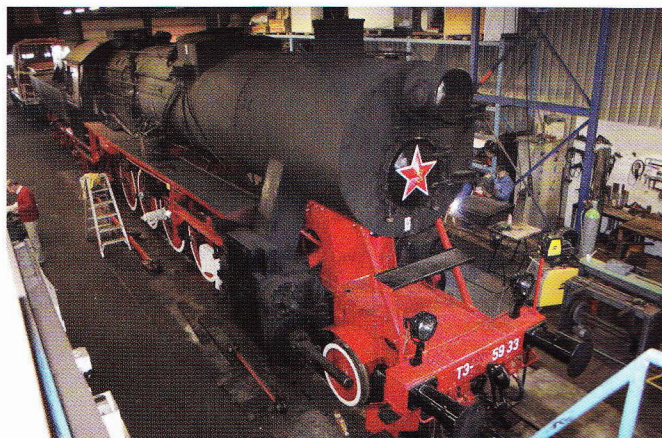
Het wonder dat T3 5933 heet, compleet mét rode ster met hamers en sikkels; zo ziet de T3 5933 ex 52 5933 er dus nu uit! Het wachten is op een goede frees uit Meiningen voor het uitfresen van de loodnagel (in de bovenkant vuurkist) voordat aan de proefritten kan worden begonnen. (foto Peter Wijshake)
