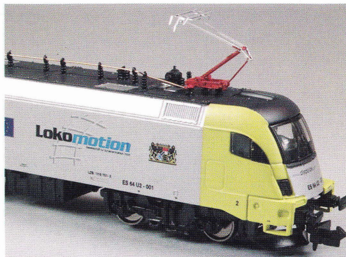
Ook deze Taurus in schaal N is uitgerust met een voorbeeldgetrouwe stroomafnemer van Hammerschmidt, in dit geval een eenbenig exemplaar van het type SSS 87.
