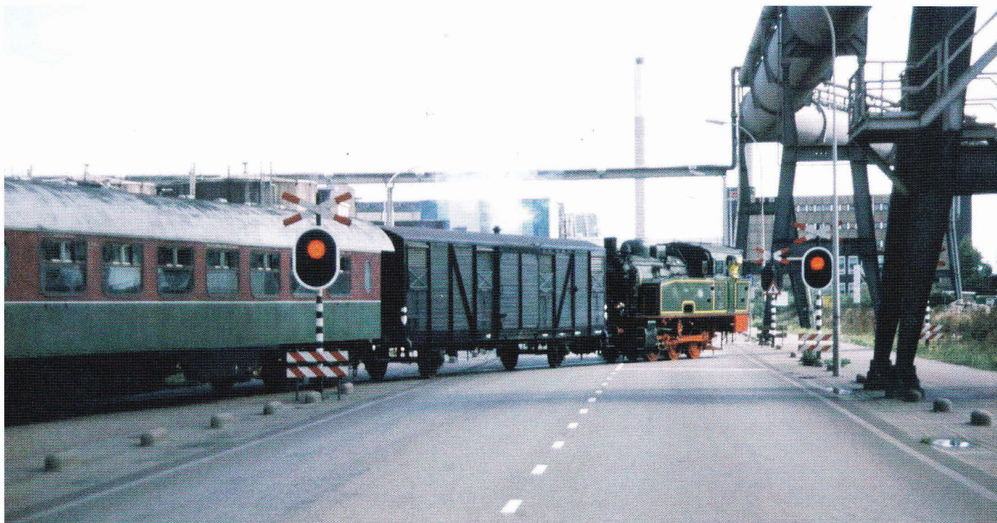
Voor het beveiligen van de overwegen bij Corus in IJmuiden wordt gebruik gemaakt van zogeheten AVIO's, automatische verkeersinstallaties voor overwegen, waarvan er momenteel zo'n kleine 70 stuks in bedrijf zijn. (foto Peter Wijslake)
