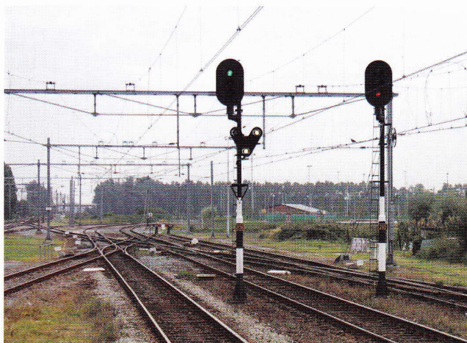
Bij vertrek naar Beverwijk (rechtsaf) brandt onder groen knipperend sein 208 een wit vertakkingsein (ofwel richtingaanwijzer) dat aangeeft dat het seinbeeld voor het rechtsbuigende spoor geldt. Voor de richting Zaandam brandt het linkerlampje boven in combinatie met het onderste. 23 september 2006.
