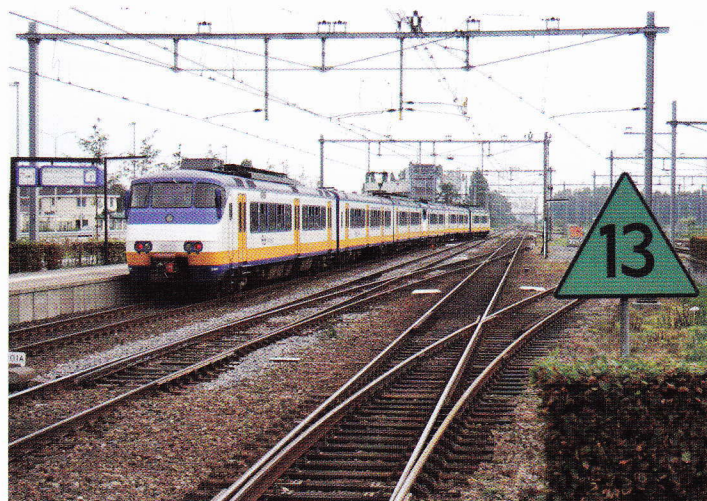
Vertrek van de stoptrein naar Utrecht. Twee Sprinters 2941 en 2981 vertrekken als trein 7357 van spoor 1b. Ze rijden hierbij een kort stukje over het linker spoor, waarna ze via de wissels 231A en 231B het juiste spoor bereiken. Het groene driehoekige bord met '13' erop geeft de verhoging van de baanvaksnelheid weer (tot 130 km/u). 23 september 2006.
