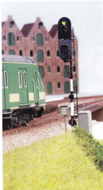
Het inrijsein toont groen flikker. De trein mag met 40 km/h het station binnenrijden om te stoppen op spoor 3.
