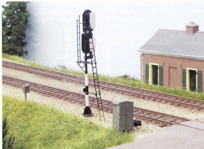
Een sein staat nooit alleen. Voor het sein vinden we een telefoonkastje, na het sein een relaïskast, een aansluitpotje en een trafokastje.
