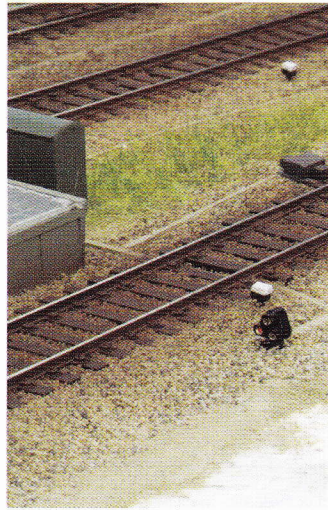
Het dwergsein aan het einde van spoor 1. Dwergseinen mogen met maximaal 40 km/h worden gepasseerd.
