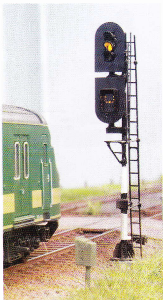
Geel plus het cijfer '4'. De machinist moet voor het volgende sein de snelheid verlagen tot 40 km/h.
