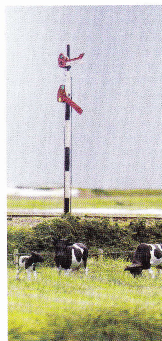
Het inrijsein A met voorsein C1/2V voor het stationnetje van Magerveen.
