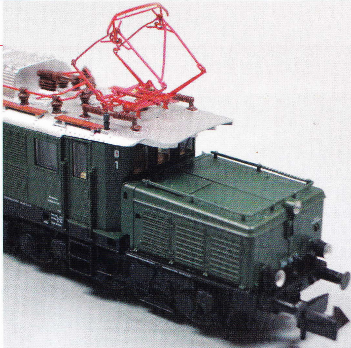
Deze Duitse elektrische loc van de serie 94 in schaal N is dankzij Hammerschmidt uitgerust met een voorbeeldgetrouwe stroomafnemer van het type SBS 39.
